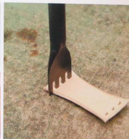
8 接下來在固定皮上也鑽出縫線孔。用邊線器在兩端畫線，並將菱斬的一根刀刀架在桌上敲打。
