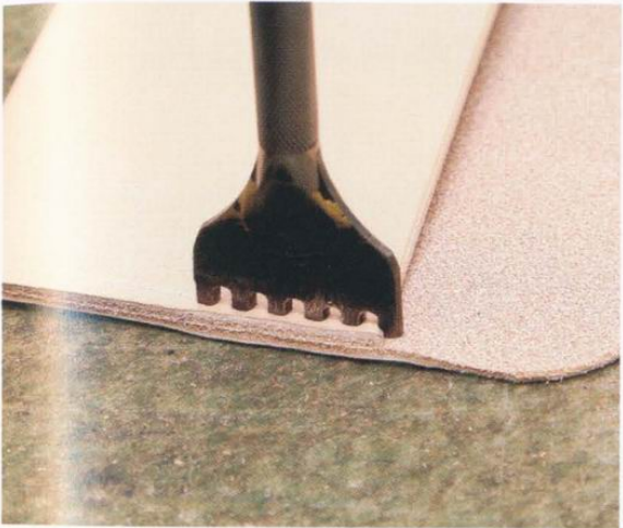
7 鑽出縫合內袋用的縫線孔。將菱斬的一根刀刀架在內袋口上開始敲打。
