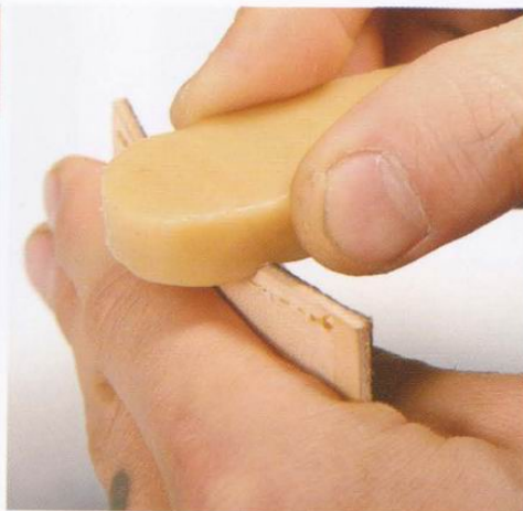
14 縫製完成之後，請確認有沒有高低差。如果有高低差的話，就用削邊器削掉高低差，並塗上磨邊蠟來潤飾。
