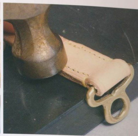
16 鉤子和鉤環穿過的部分要覆蓋邊緣並縫上雙重縫線。縫製的最後要用電燒器燒烙固定，再用槌子敲打讓針腳安定。
