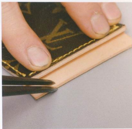
20 這裡要在邊皮的粗糙面貼上雙面膠帶，然後在光滑面上用2mm寬的間矩規畫線。兩個邊皮都要進行同樣的工作。
