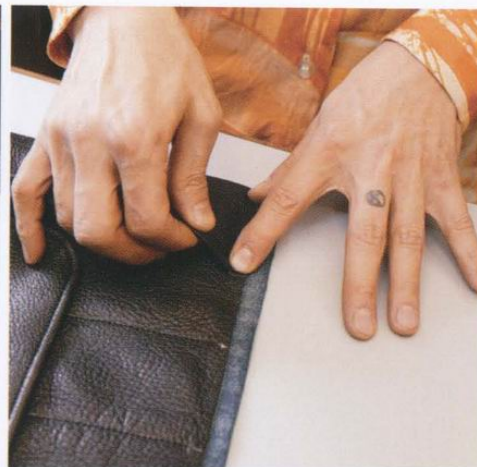
25 在袋身的反折部分貼上雙面膠帶後再貼合起來。使用曲尺等工具就可以筆直地貼合。
