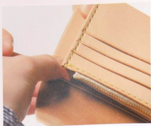
10 將袋身和零錢包的邊緣對齊，塗上3mm寬的橡皮膠並緊密地粘著在一起。
