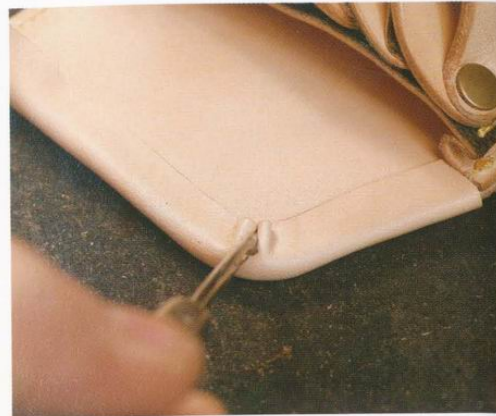
16 曲線部分的皮革會多出，所以可以用錐子碾壓。
