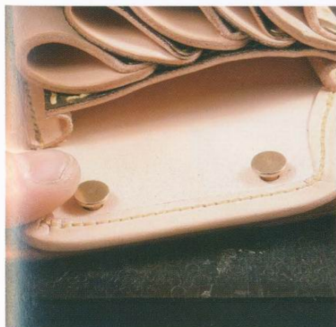
19 在這裡要使用彈簧釦。將彈簧釦公的部分從袋身插入，壓在皮帶上並做出記號，然後再用丸斬在做記號的位置上鑽孔。
