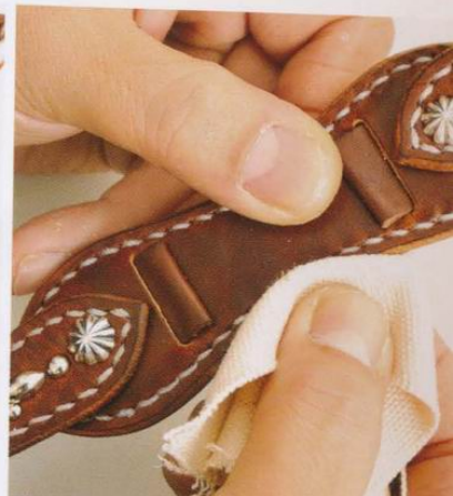
19 毛邊沾水濕潤之後塗上背面處理劑，在擦掉多餘的背面處理劑之後，用乾燥的菜瓜布和帆布打磨。
