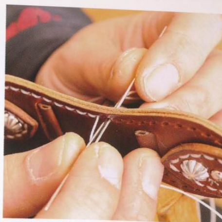
17 用平縫技巧縫製帶身，在背面燒烙固定。
