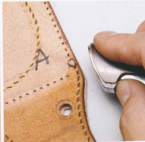
22 用平縫技巧縫製，將線結隱藏在袋身的零錢包裏面。這裡也是皮革很厚的部分，所以可以使用手縫固定夾具來幫助。
