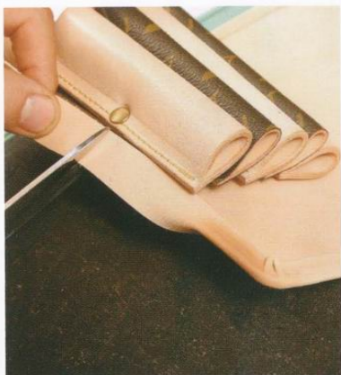
17 一周貼合完成之後，切割到靠近口袋台座極限的地方。全部貼合完成之後，接下來要進行縫合的工作。
