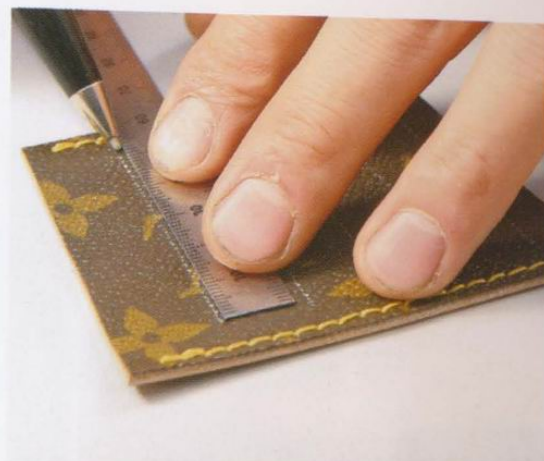
15 在距離縫合好的台座左邊20mm寬的地方和10mm的地方畫出四條線。
