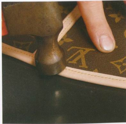
19 沿著縫線用機器縫合。從名牌包切下來的材料表面既凹凸不平又堅硬，所以要慎重緩慢地縫製。在縫製完成之後，再用槌子敲打線條。
