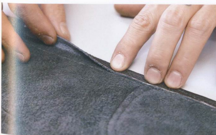
14 在距離工具插袋上方和右邊20mm寬的地方畫線，並折起來貼上雙面膠帶。
