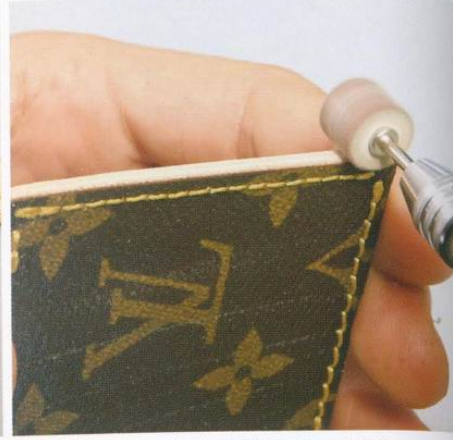
19 用鎚子敲打針腳讓針腳安定。如果邊皮和台座之間有高低差的話，用削邊器削掉讓邊緣平整。削掉邊緣之後記得要塗上磨邊蠟。
