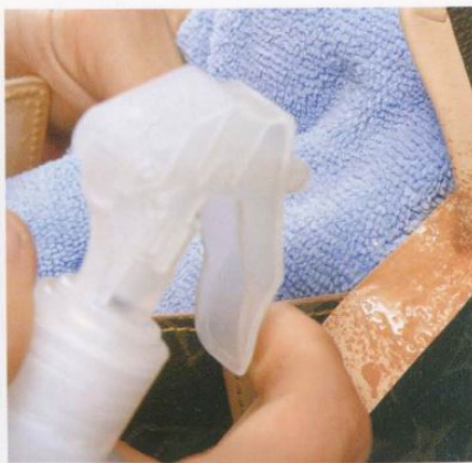
15 用手指貼合完成之後，用槌子敲打讓袋蓋可以貼得更緊。有角度的部分可以用噴霧器讓袋蓋濕潤之後，皮革就比較容易伸展。
