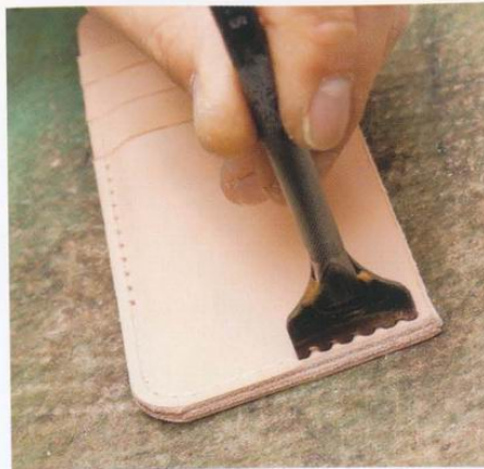
5 首先將菱斬的一根刀架在內袋D的邊緣上再做出幾個記號。從左邊照片的位置開始敲打菱斬。曲線的附近要一邊調節縫線孔的間隔，一邊鑽出均等的縫線孔。
