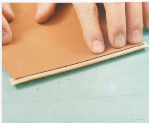
6 配合 3 所畫出來的線，再將之和名牌包的材料貼在一起。用槌子輕輕敲打讓本牛皮和名牌包的材料確實地粘著在一起。
