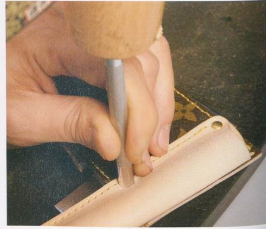
23 在板子上敲打固定釦並固定住。下面的孔也同樣要固定住。
