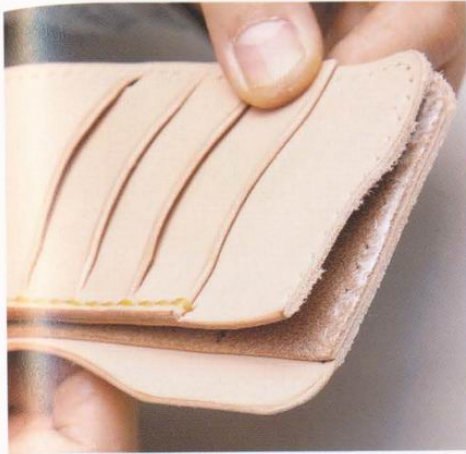
18 確實地拉緊縫線，讓卡片夾和背皮緊密貼在一起，最好用廢布料等物品壓住，讓卡片夾和背皮可以確實地粘著在一起。
