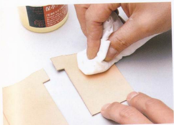
1 為了不讓手上的油脂附著在皮革上，在依照紙型裁下的配件上塗上皮革保養霜。
