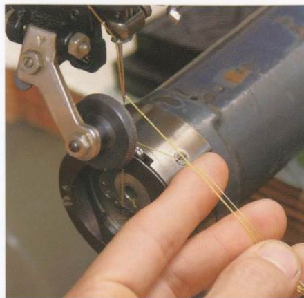
8 在 5 畫出來的線上將本牛皮和名牌包的材料縫合在一起。在這裡要使用上線比較粗、下線比較細的縫線機來縫合。
