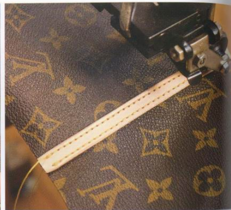
8 在 5 畫出來的線上將本牛皮和名牌包的材料縫合在一起。在這裡要使用上線比較粗、下線比較細的縫線機來縫合。
