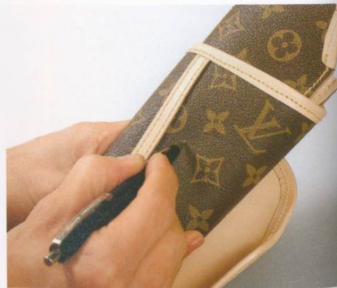
20 依照完成形狀成形，並在背部的中心點用銀筆做記號。
