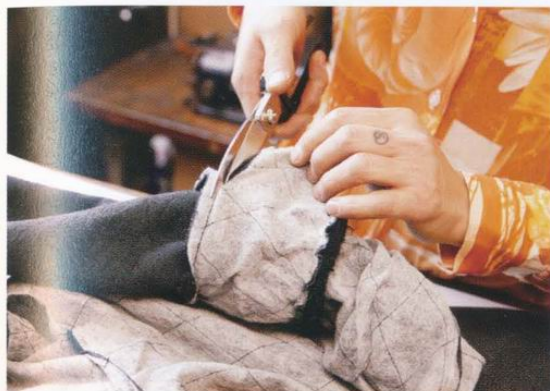
3 將手腕部分的襯布抽出來，剪掉縫製在手腕四周的部分。
