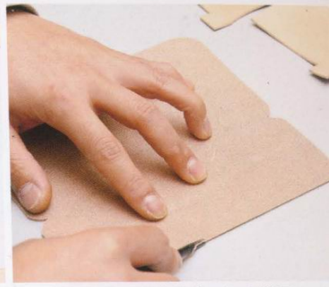
2 為了要打磨縫合後沒辦法打磨的毛邊部分，先用削邊器削掉邊緣。這次使用的紙型請看 4 的照片確認要打磨的地方。
