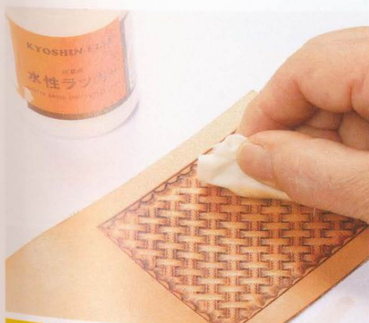
23 最後塗上用水稀釋過的水性亮光漆，讓油質染料固定下來。
