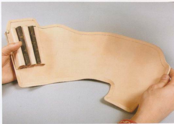
17 一周貼合完成之後，切割到靠近口袋台座極限的地方。全部貼合完成之後，接下來要進行縫合的工作。
