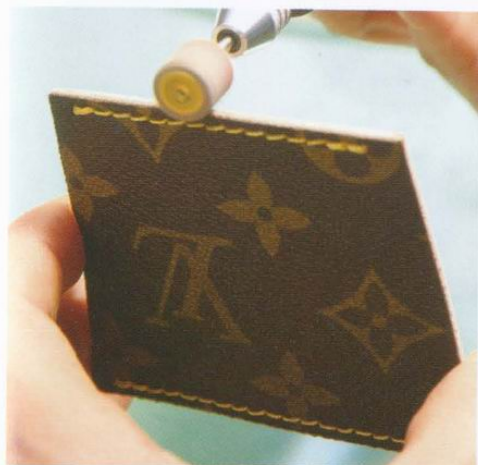
14 縫製完成之後，請確認有沒有高低差。如果有高低差的話，就用削邊器削掉高低差，並塗上磨邊蠟來潤飾。
