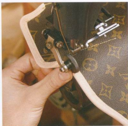
19 沿著縫線用機器縫合。從名牌包切下來的材料表面既凹凸不平又堅硬，所以要慎重緩慢地縫製。在縫製完成之後，再用槌子敲打線條。
