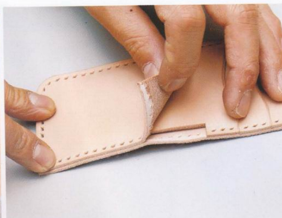
8 在剝掉背皮的狀態下，在鈔票夾口的附近畫出導引線，並用菱斬鑽出縫線孔。在這裡要將暫時固定的內袋D剝掉。
