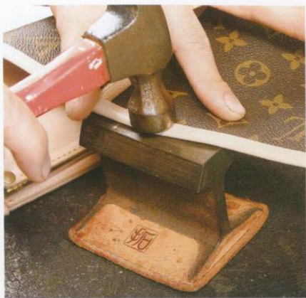
15 用手指貼合完成之後，用槌子敲打讓袋蓋可以貼得更緊。有角度的部分可以用噴霧器讓袋蓋濕潤之後，皮革就比較容易伸展。
