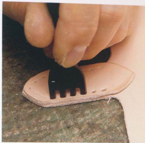
6 配合在 4、5 做的記號敲打菱斬，鑽出縫線孔。要調節到尖端也剛好有縫線孔是關鍵所在。
