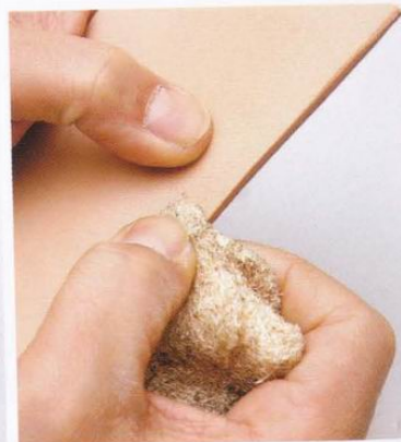
3 削掉邊緣部分的毛邊用含水的廢布料擦拭並塗上床面處理劑。在這裡使用的是背面處理劑。將多餘的背面處理劑擦掉之後，用乾燥的菜瓜布和帆布打磨。乾燥的菜瓜布多半在超市或生活用品賣場的浴室用品專櫃等地方販售。
