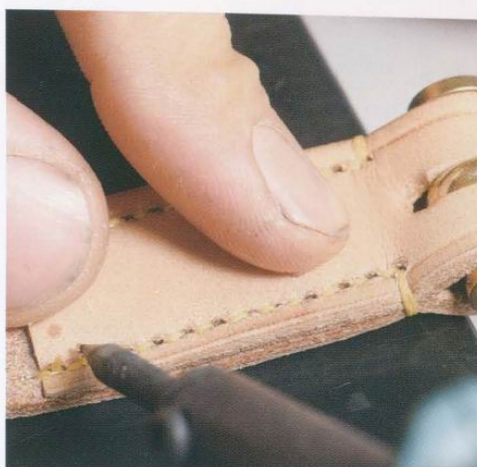
16 鉤子和鉤環穿過的部分要覆蓋邊緣並縫上雙重縫線。縫製的最後要用電燒器燒烙固定，再用槌子敲打讓針腳安定。
