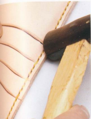
20 縫製工作的最後階段，在卡片夾和背皮之間打個不顯眼的結並將縫線燒烙固定。縫製完成之後，用槌子敲線條讓針腳安定。
