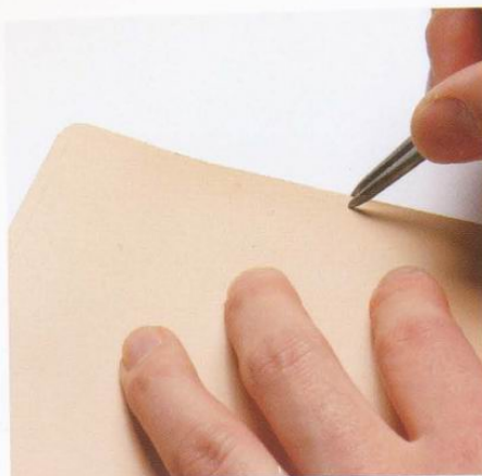
11 用間矩規在袋身的光滑面畫出コ字型的縫線。縫線的開頭和結尾要配合邊皮的高度用菱斬鑽出縫線孔。
