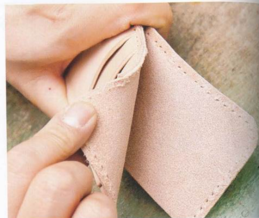
7 在這裡將暫時固定的背皮剝掉。請確認是不是有確實鑽好縫線孔。
