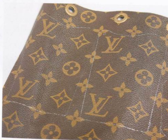
10 也將其他口袋配件或口袋台座的紙型描繪出來，用皮革裁刀將所有的配件切下來。五個口袋裡面只有兩個口袋是使用這個材料。
