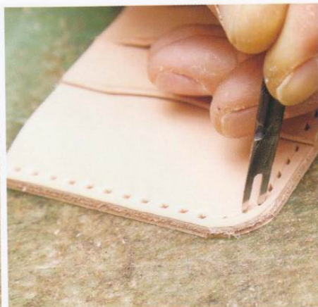
6 為了讓內袋的開闔部分有強度，在各自內袋邊緣的極限地方不要鑽縫線孔。卡片夾另一邊也請一邊調節間隔一邊鑽出縫線孔。
