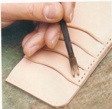
6 為了讓內袋的開闔部分有強度，在各自內袋邊緣的極限地方不要鑽縫線孔。卡片夾另一邊也請一邊調節間隔一邊鑽出縫線孔。
