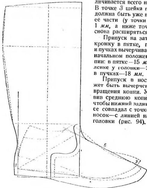
Рис. 94. Вращение копии колодки хромового сапога
