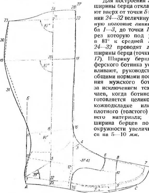
Рис. 92. Грунд-модель шоферского ботинка фасона „Дерби“
