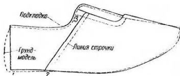
Рис. 76. Модель укороченной кожподкладки
