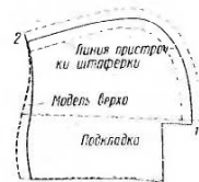
Рис. 70. Модель подкладки для ботинка с пряжкой (задняя часть берца с пристроченной кожаной штаферкой)
