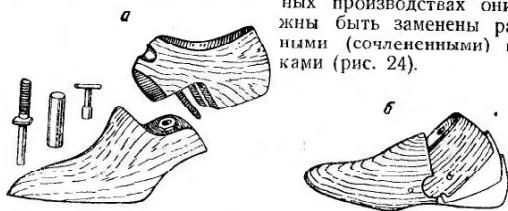
Рис. 24. а—разъемная колодка, б—сочлененная колодка
