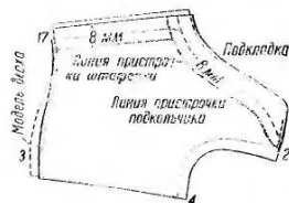
Рис. 84. Модель подкладки (берца) для мужского ботинка фасона „Дерби“
