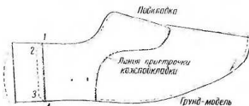
Рис. 77. Модель удлинненной кожподкладки с боковыми швами
