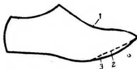
Рис. 43. Вид средней копии: 1—точка союзки, 2—внутренняя сторона, 3—внешняя сторона
