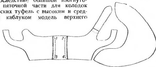
Рис. 113. Модель удлиненной подкладки с боковыми швами
