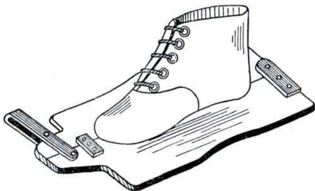
Рис. 71. Затяжка заготовки обуви парко пластинами
