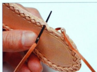
13 穿過圓圈的皮繩再插入正面的前一個交叉處之間。
