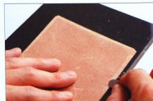
02 01所標示的記號為黏合部件的範圍，要用研磨片磨粗距離邊緣3mm寬的範圍。
