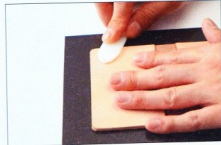
05 以三用磨緣器磨擦黏合部分壓黏。若為白膠，請放置乾燥後再進行動作。
