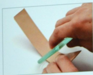
05 從背面用玻璃板壓點緊實。
