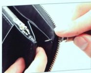
08 在包側交界處戳開基點線孔。
