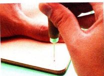
01 對齊紙型，用菱形錐標示零件的安裝位置。
