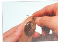
17 圓錐刺穿到底，擴大基點的線孔。
