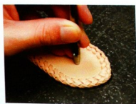
02 對齊紙型所記的位置， 用12號（直徑3.6mm） 圓斷鑿出安裝孔。
