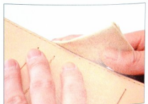
17 塗上灰面處理劑，用帆布磨整側邊。
