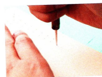
03 沿著記號，用菱形錐鑿開鉚釘孔。由於鉚釘孔位置一旦歪掉，圖案也會隨之歪斜，務必鑿在正確的位置上。
