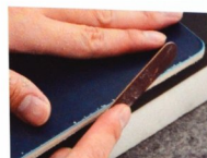
01 用研磨片磨齊部件黏合處的側邊。
