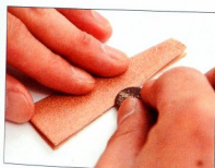
02 同樣磨粗包側的貼合部分。
