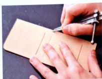
08 成為皮夾本體內側的那一邊依照紙型基點，用間距規劃出縫線記號。
