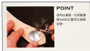
15 挖好縫線記號的狀態。注意基點之間縫線記號並沒有連起來。
