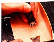
10 在基點間用簽斬估量間隔，調整線孔位置。
