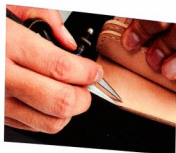
14 背面則用開距規，劃出當作參考線的3mm寬縫線記號。
