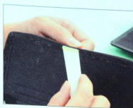
04 拉鏈布距離邊緣7mm寬的範圍也塗上DIABOND強力膠。
