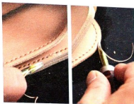
18 與零錢袋縫在一起的鈔票袋也用側邊器削掉邊角。
