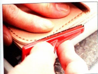
15 用研磨片或NT三角研磨器來磨齊側邊。
