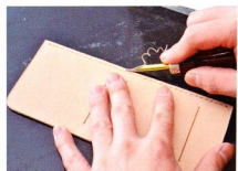
15 用削邊器削掉縫合的那一邊的側邊過角。
