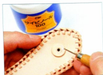
05 放上03所做的整圓 革，在鈕扣的螺絲孔 上少許白膠。
