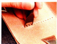
11 以輕壓的記號為準，用簽斬鑿出線孔。
