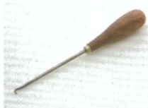
縫合鞋面皮革時用以拉緊縫繩的鉤錐。使用方法為以尖端部分鉤住縫繩後拉緊。
