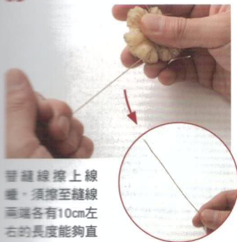
將擦過線蠟的縫線穿過針孔。若沒有經過方才削薄的步驟，這邊就會不容易穿過針孔。
