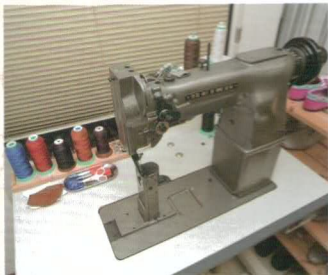
森田靴工房內是使用工業用車縫機縫合皮鞋，但其實也可以手工縫合。
