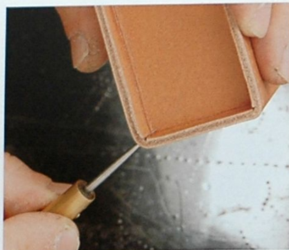
5 使用菱形錐將袋身上的縫線孔貫穿到邊皮上。
