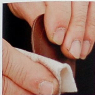
07 因為安裝部分的床面和毛邊在縫製完成之後無法進行打磨工作，所以要先進行潤飾工作。
