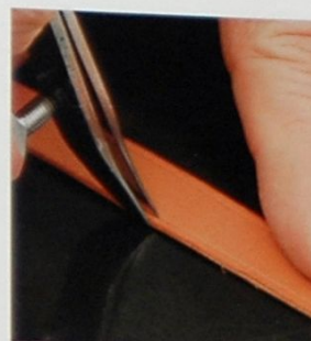
06 在05所完成的毛邊潤飾皮革的表面畫出2mm寬的縫線。
