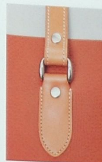
縫製結尾的部分要在外側縫上雙重縫線。固定住縫線之後，接著要進縫線的處理工作
