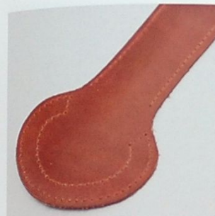
04 用菱斬鑽出縫線孔。帶子的部分只要在一邊鑽出縫線孔即可。
