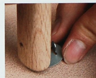
13 不要用敲打的方式來折鉤子，到最後一刻為止都要用壓的方式讓鉤子折起來。
