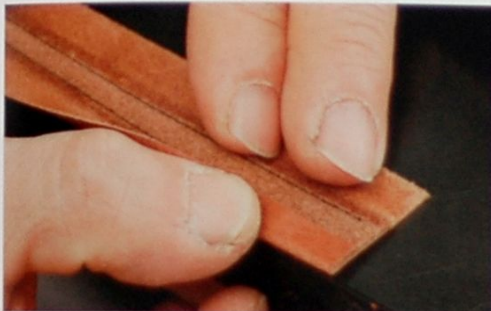
09 塗上接合劑之後，配合06所畫出來的基準線將邊緣反折起來。請對齊基準線來正確的進行反折工作。
