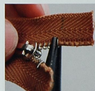
19 用鉗子壓壓拉鍊頭，讓拉鍊頭固定在拉鍊布上。請注意不要弄壞拉鍊頭。
