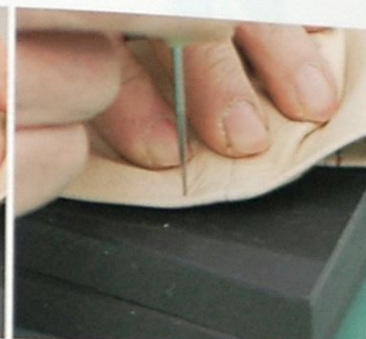
09 為了要鑽出可以穿過皮繩的孔，要用間矩規畫出均等的寬度，然後用錐子在每個位置上做記號。
