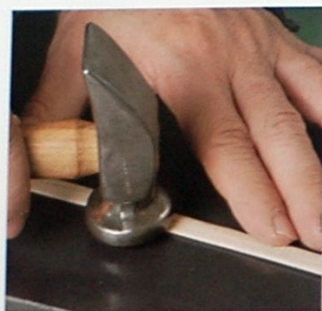
04 配合在中心所畫出來的線，將兩端折起來，然後用榔頭等工具壓著起來。
