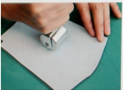
08 輪從背面（有切片的那一邊）讓切片和皮革緊密地貼合起
