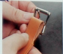
03 將帶釦對齊固定皮並反折起來，同時再確認一次安裝位置。
