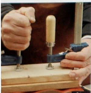
用和木型一樣大的板子夾住皮革，然後用夾鉗來固定住。
