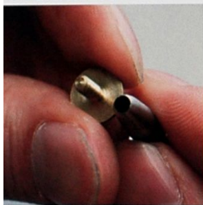
原子鉤的安裝孔要配合螺絲部分的直徑。在這裡使用的是6mm的原子鉤，和10號丸斬。
