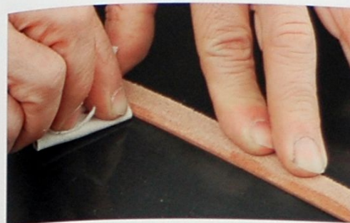
04 使用木製修邊器或帆布，以及利用背面處理劑來打磨並潤飾床面和毛邊。
