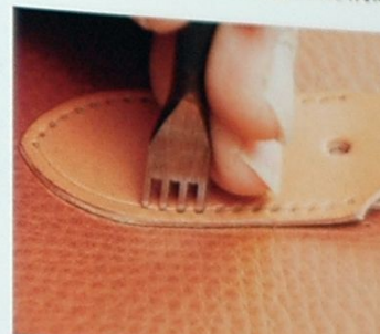
15 用叉斬鑽出縫線孔。轉彎部分請使用雙菱斬
