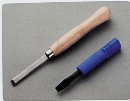
原子鉤的承受孔(※)要用平斬將用丸斬所鑽出來的兩個孔之間連結起來。固定原子鉤時要使用一字型螺絲起子。
