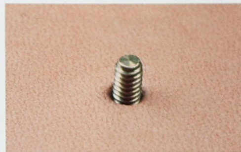
04 請確認螺絲部分有沒有完全從表面露出來。如果螺絲露出部分太少的話，就無法確實地固定住原子鉤。
