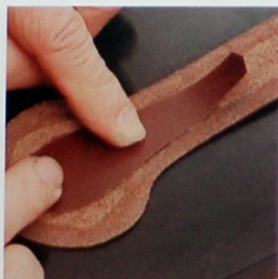
02 襯皮要貼在背面看得到卻不進行縫製工作的地方。它具有補強作用，此外也可以當作是芯材。
