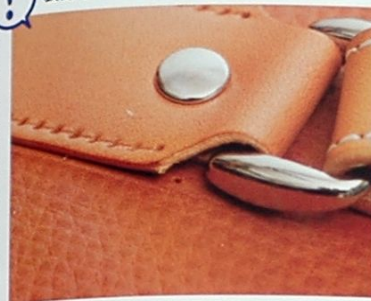
用圓錐鑽出上緣部分的最後一個縫線孔。另外，袋身也要像照片中一樣用圓錐鑽出縫線孔。
