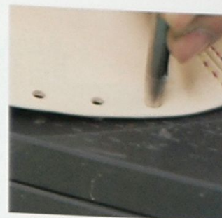
10 利用15號丸新來鑽出Φ4.5mm的孔。
