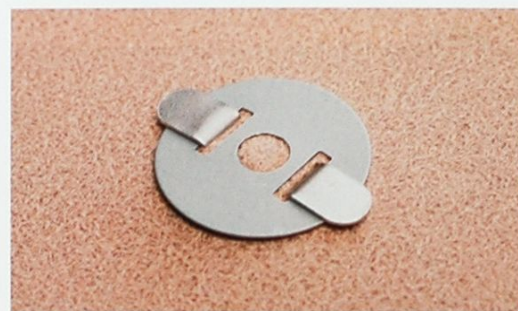
14 照片中的是兩邊的鉤子都有確實地折起來，並且固定好墊片的樣子。這裡的鉤子是往外側折，但是有時候可以配合情況往內折。
