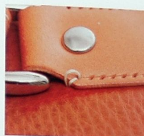
17 縫製起點的部分要在外側縫上雙重縫線之後再來進行縫製工作。
