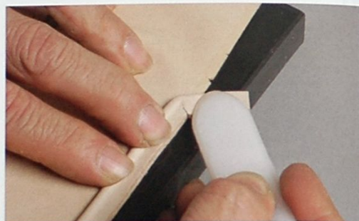
04 配合製作鑲邊時所裁切出來的切口，將兩端多出來的部分像往外折一樣地接著起來。
