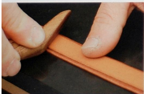
16 用木製修邊器等工具來磨擦，並將兩張皮革壓在一起。
