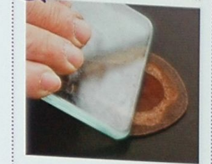
06 安裝部分的毛邊和床面要先進行潤飾工作。
