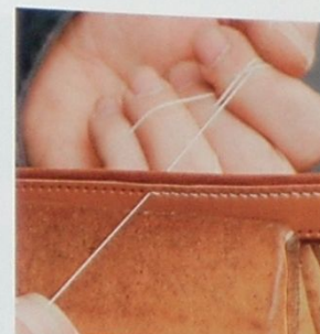
22 用平縫法來進行縫合工作。縫製距離如果太長，縫線就會受損，所以要分間幾次來進行。
