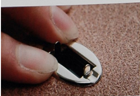
3 照片中的是從背面來看已經安裝好了的蓋頭部份，如果鉤子沒有確實露出來的話，就表示皮革太厚了。
