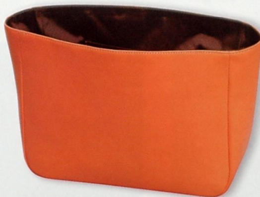
貼上接著芯之後，表面會出現張力，然後使用山東綢（※）當作襯布來製作作品。這個作品的襯布的縫合方法是利用最基本的縫法來進行縫製工作。另外，底部要使用bontex硬襯板的特厚類型來當做芯材。
