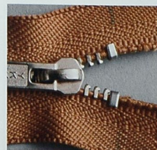
18 決定好拉鍊頭的安裝位置之後，請輕輕地把拉鍊頭壓上去來暫時固定住。
