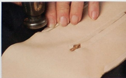
06 用榔頭等工具敲打接著起來的地方，讓皮革緊密地貼合在一起。請避開聚酯芯，只要敲打高邊即可。
