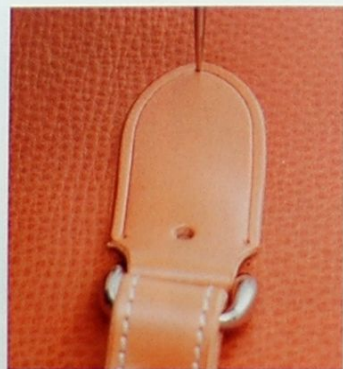
請鑽出縫線孔。首先用圓錐在頂點部分鑽出縫線孔。
