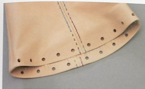
11 照片中的是在均等寬度的位置上完成鑽孔工作的樣子。接下來將08所製作的皮繩穿過這個孔，這樣提包就完成了。
