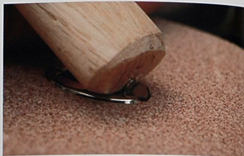
14 請用木槌的柄來壓折鉤子。如果零件從皮革上面浮起來的話，鉤子就無法確實地扣住底座，所以請確實進行壓折的工作。
