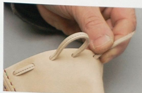
12 將皮繩的尖端裁切成斜的，然後像照片一樣穿過每個孔。
