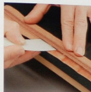
07 在邊緣到06所畫出來的基準線之間塗上接合劑（這裡使用的是THREEDYNE接著劑）。
