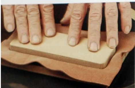
將皮革壓進木型輪框之後，在筆袋裡放入木型的凸型。
