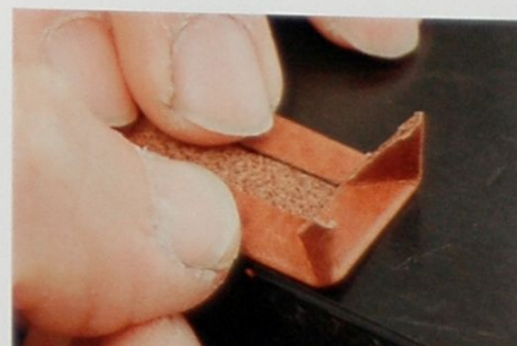
10 將尖端的部分反折起來。角落的部分要像照片中一樣折起來。
