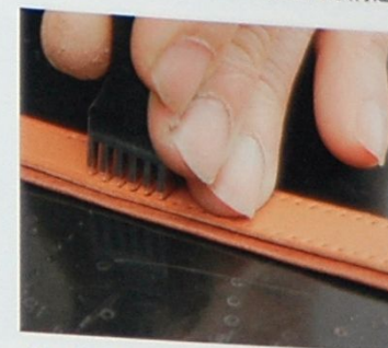
19 除了角落部分以外，要用菱斬在帶子四周鑽出縫線孔。
