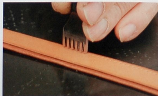
17 用菱斬配合縫線來鑽出縫線孔。請注意不要讓縫線孔變得太大，輕輕敲打菱斬，然後用菱形錐貫穿縫線孔。
