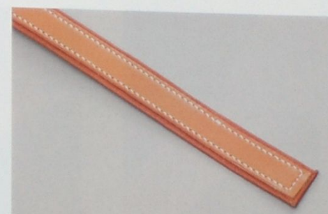
24 照片中的是縫製完成的樣子。像這種類型的平帶，最簡單的縫裝方法就是將邊緣反折起來穿過環，然後用固定釦來固定。
