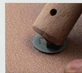
03 將墊片安裝在鉤子上之後，要和凹型一樣，用木槌的柄等工具來壓鉤子讓鉤子折起來。
