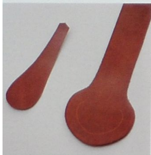
1 帶子的部分要裁切出30mm的寬度，安裝部分的圓形直徑要裁切出大約65mm的寬度。
