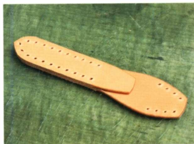
10 接著縫合插釦的配件。準備長度綽綽有餘的縫線。
