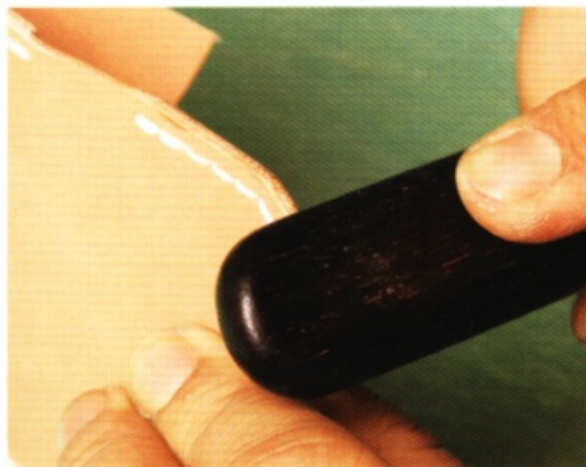
26 從尾端剪掉多餘的縫線。用打火機燒融，再將縫線壓扁。削掉兩面的皮革邊緣，打磨毛邊。接著削掉邊皮和袋蓋之間的皮革邊緣，打磨毛邊。下一步是安裝穿過皮帶的皮環。首先削去皮環的皮革邊緣，再打磨毛邊。
