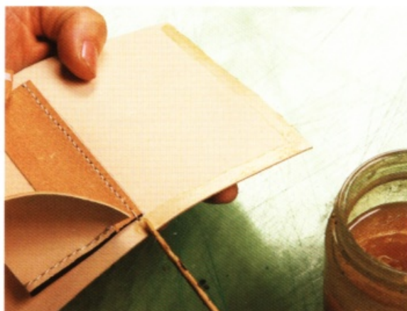
9 塗抹白膠，以便縫合。塗抹白膠的部分，剛好形成倒L型。
