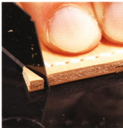
8 斜斜切掉邊角，讓蓋子部分的邊緣變得很工整。也可以把邊角的形狀削圓。
