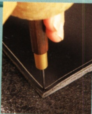
18 用菱斬鑿孔前，先以菱錐在邊角鑽孔。邊角共有 5 處，請全部用菱錐鑽出小孔。
