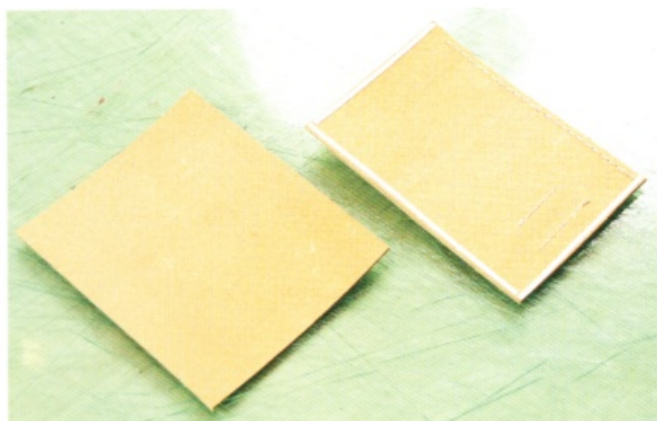
25 圖中的皮革是卡片夾層②的底部的床面。把兩張皮革黏在一起，就是卡片夾層的內面。
