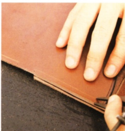
30 在零錢夾層的下端也拉出縫線溝槽，再用菱斬在上面壓出印記。
