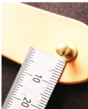
15 確認原子釦位於正中央後，用螺絲起子鎖緊。接著貼上袋蓋內裡，修整毛邊。
