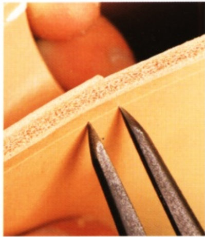
9 用手開間距規拉出縫線溝槽，以便縫合。再以手開間距規壓出印記。
