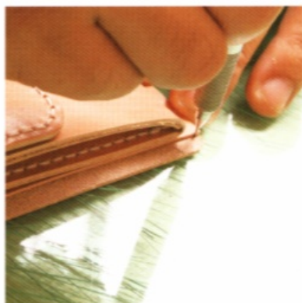
4 在主體內側的上端標記，將主體床面預備上膠的部分磨粗。
