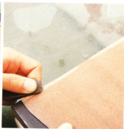
22 用圖錐鑿開本體銀面的記號，深度深及床面。再把記號下方的部分磨粗。
