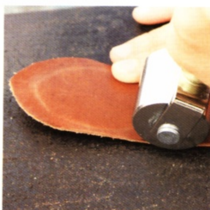
5 再以推輪滾壓。最後用裁皮刀修整毛邊。
