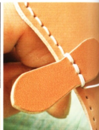
25 以2孔菱斬按照記號鑿出縫孔。接著縫合袋蓋周圍。前面兩片和皮帶的部分都重複縫製兩次，縫到最後一個縫線孔後往後縫1針半。
