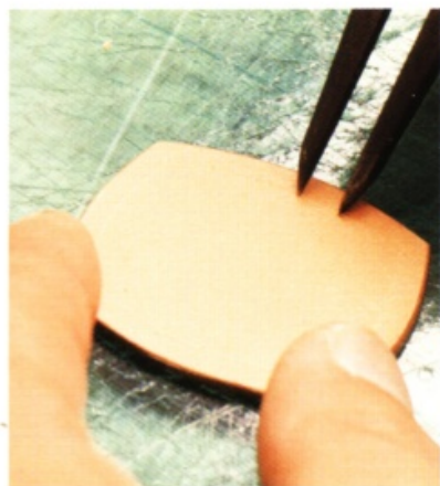
13 在皮環部分 B 的外框拉出 4mm 寬的縫線溝槽，再以調整為 5.5mm 寬的手開間距規壓出印記。疊上紙型，在邊角留下 4 處記號。
