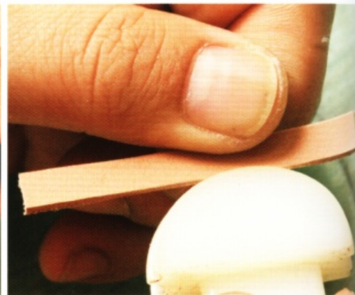
26 從尾端剪掉多餘的縫線。用打火機燒融，再將縫線壓扁。削掉兩面的皮革邊緣，打磨毛邊。接著削掉邊皮和袋蓋之間的皮革邊緣，打磨毛邊。下一步是安裝穿過皮帶的皮環。首先削去皮環的皮革邊緣，再打磨毛邊。
