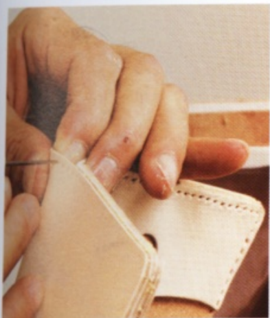
29 壓出印痕後，用菱錐鑿通縫孔。接著縫合外圍。準備長度約為縫合距離 4 倍的縫線。
