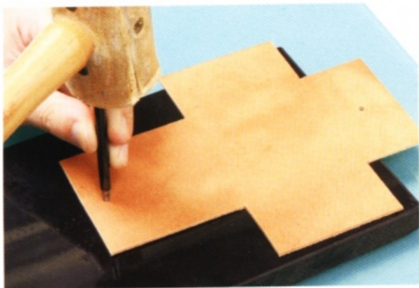
11 以同樣的手法在安裝四合釦凹釦的位置上鑿出孔洞。也是使用 8 號圓斬。
