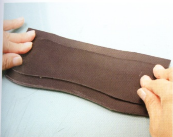
27 黏合卡片夾層⑥和⑦。將邊緣對齊，黏在距離頂端往下 10mm 之處。
