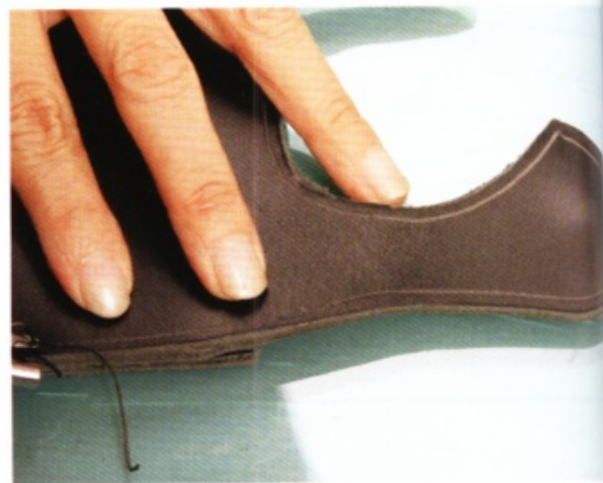
16 打磨完畢後，用拉溝器沿著皮革外圍拉出縫線槽。
