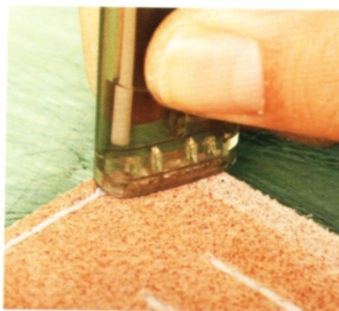
23 壓扁針腳。削掉皮革重疊處的兩面的邊緣，以便塗抹白膠。從距離下端 5mm 之處，削掉皮革邊緣。
