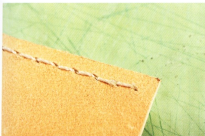
19 最後從背面露出 1mm 的縫線。用打火機燒融後再壓扁。
