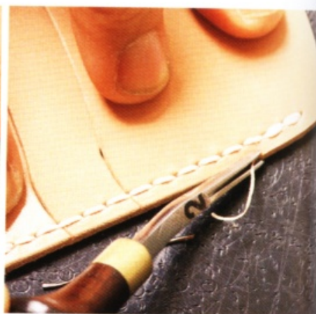
23 壓扁針腳。削掉皮革重疊處的兩面的邊緣，以便塗抹白膠。從距離下端 5mm 之處，削掉皮革邊緣。
