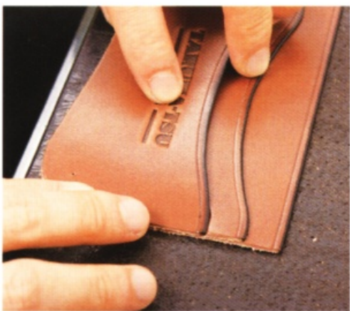
15 對齊邊緣後黏合。用槌子輕敲，將皮革確實壓緊。
