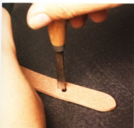
57 沿著剛才畫好的裁割線用平斬從兩面割開。穿入原子釦。一開始很難將釦子穿入堅硬的皮革，但使用一段時間以後，皮革會變得愈來愈軟。
