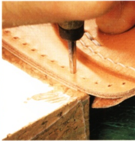
11 在外圍壓出印記後，用菱錐鑿出縫線孔。注意不要鑿到其他部位。
