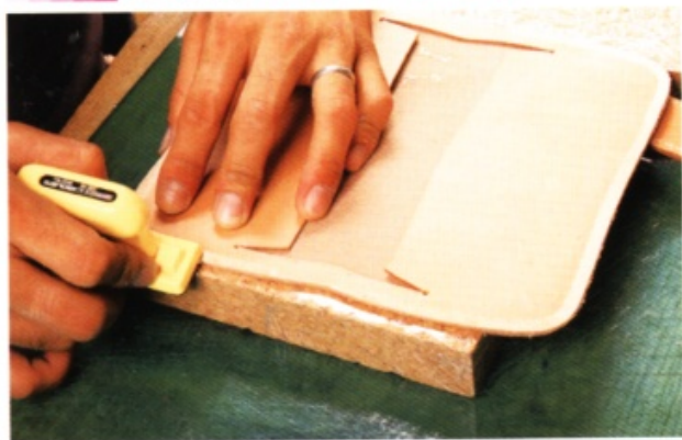
1 把預備上膠的部分磨粗，好貼合零錢夾層和卡片夾層。
