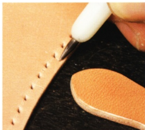
22 放上皮帶，拉出側邊的縫線溝槽，磨粗。接著抹上白膠，輕輕黏合。
