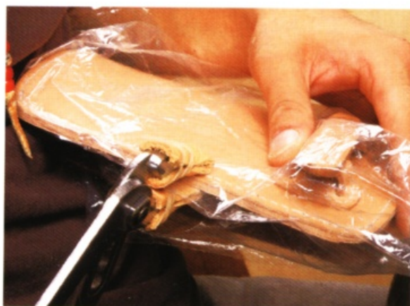
21 裝進塑膠袋以保護皮革，再用槌子敲平針腳。
