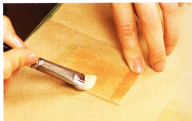
4 在零錢夾的舌釦部分也抹上橡皮黏膠。黏合彎曲的皮革時，橡皮黏膠是最好的接著劑。
