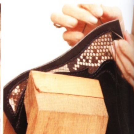
16 以同樣的手法縫合內側。把針穿入用圓錐鑽出的第二個縫線孔，以內外兩支針保持交叉的方式縫合。縫到最後一個孔後，往後交叉回縫一針，形成重複縫製2次。最後把針從銀面往床面回縫一針就結束了。
