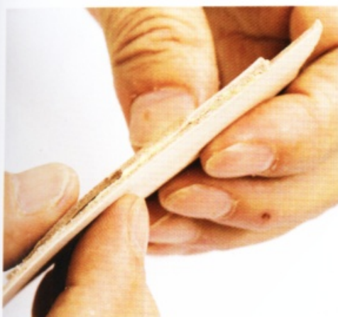
16 皮革重疊之處已經削掉一部分了，所以厚度不會太厚。貼合後，把邊緣器的寬度調為 3mm 寬，在下端拉出縫線溝槽。接著用菱斬壓出縫線孔的印子，再以菱斬鑿出縫線孔。
