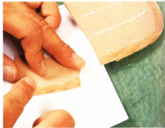
8 接著貼合卡片夾層的邊皮。抹上橡皮黏膠，貼得稍微不整齊。
