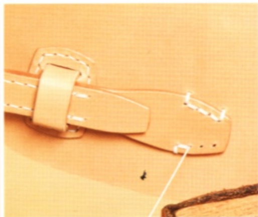
28 首先縫合皮環。用平針縫縫合外圍，只有最後兩針重複縫合兩次，再把針從床面穿出就結束了。再把插銷式皮帶插入皮環，繼續縫合。最後縫合馬鞍片。剪掉多餘的縫線後，燒融。
