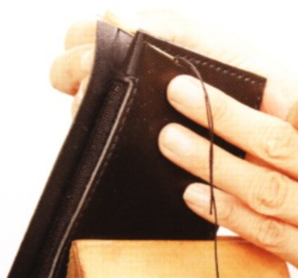
31 鑿出孔洞後，縫合。用兩支針交叉的方式從開始縫合到最後。
