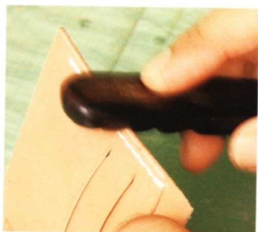
24 削邊以後，抹上 CMC，打磨毛邊。打磨完成以後，置放在主體內裡㊾上，在待會兒要塗上白膠的部位作記號。
