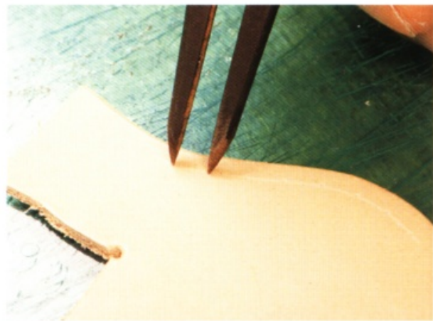
15 把手開間距規調整為 5.5mm 寬，在線上壓出印記。
