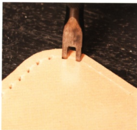
19 用菱斬在印記鑿出縫線孔。R部分用2孔菱斬。
