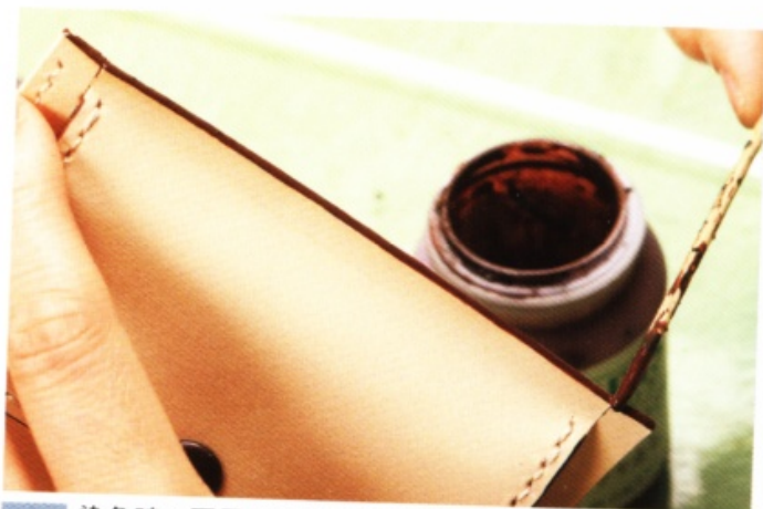
31 染色時，不需以筆刷大幅度地塗抹，只要把染料放在皮革上就可以了。上色時，注意不要沾染到銀面和床面。
