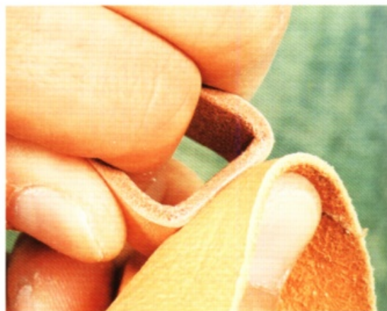
18 用水沾濕後，往逆向把皮革折出痕跡。再朝著正面折出摺痕。
