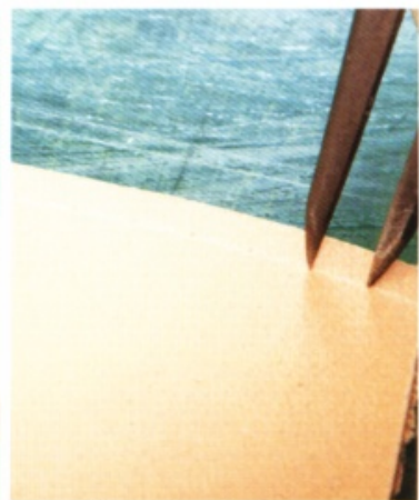
17 接著用調整為 4mm 寬的手開間距規在卡片夾層下端拉出縫線溝槽，再調整成 5.5mm 寬，壓出印記。
