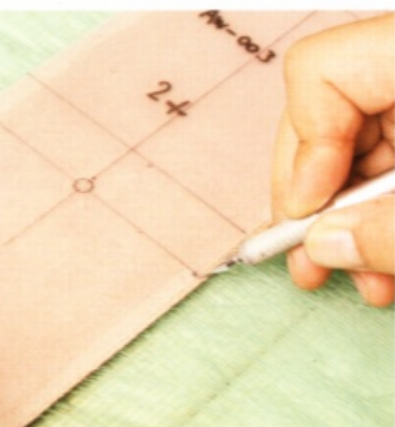
3 把紙型放在主體的床面，在貼合主體內側與固定紙鈔的舌釦部分做出記號。
