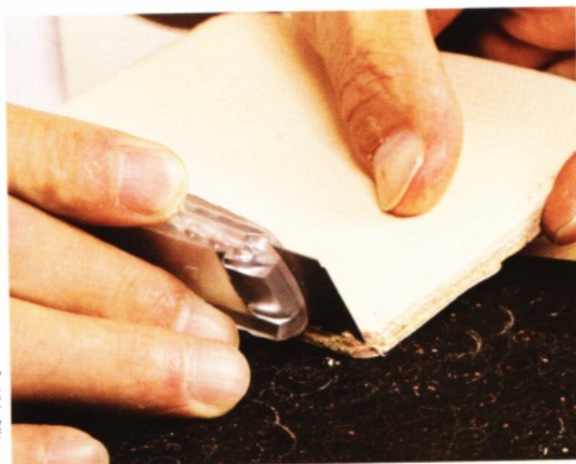
26 鑿出縫線孔後，削去部分的邊角。使用美工刀，逐次削去皮革。另一邊也比照辦理，先用菱斬壓出印痕，再鑿出孔洞。
