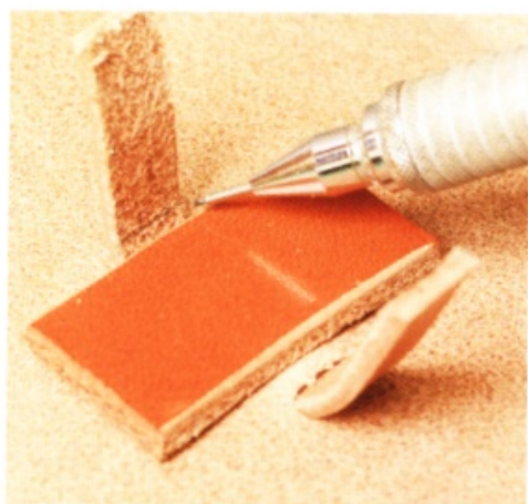
28 選塊厚度和皮帶相同的皮革替用，比對尺寸是否合適。在較厚的一面作記號。
