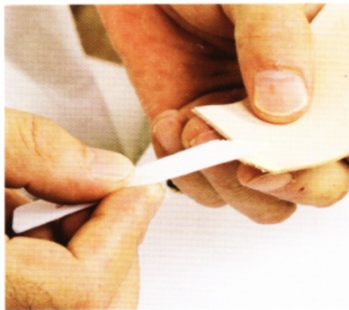
15 接著以同樣的手法縫合 5。首先打磨上端的毛邊；把要上膠的部分磨粗後，抹上白膠。以兩片三角板為輔助，貼合兩片皮革。
