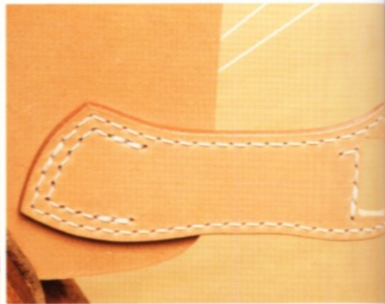
28 首先縫合皮環。用平針縫縫合外圍，只有最後兩針重複縫合兩次，再把針從床面穿出就結束了。再把插銷式皮帶插入皮環，繼續縫合。最後縫合馬鞍片。剪掉多餘的縫線後，燒融。
