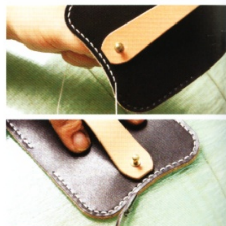
17 縫合。縫合完畢後，固定針腳，單獨削除銀面的皮革邊緣。
