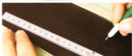
1 把皮帶安裝在主體。首先把紙型放在主體上，在皮帶的兩處做記號，再以描寫筆將記號相連。接著在主體標出足夠容納皮帶的區塊，再將此區塊和皮帶磨粗。
