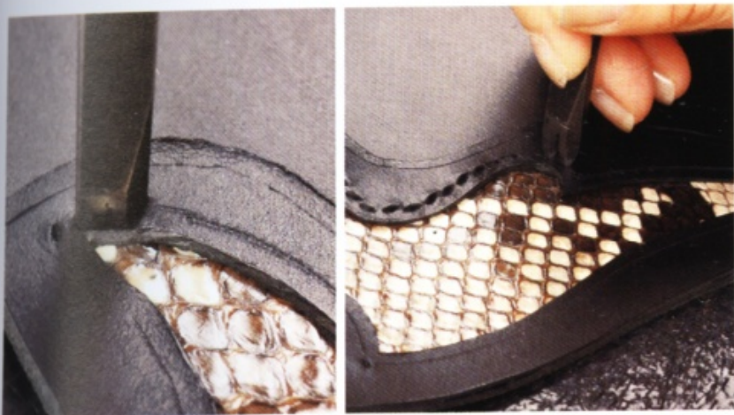
8 用菱斬鑿出縫線孔。這塊皮革的曲線較多，所以使用 2 孔菱斬的頻率很高。
