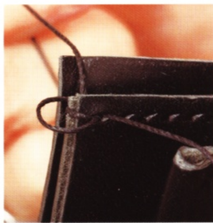
42 將針從邊緣穿出，再將左右縫線調整為等長。起針以雙線繞縫的方式組合，之後恢復普通的平線縫。
