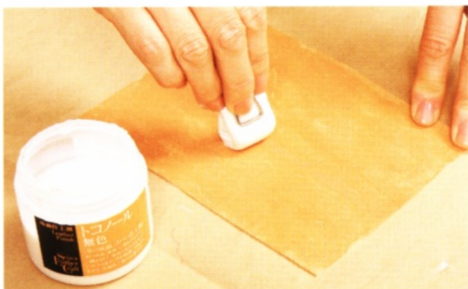
3 在主體①、貼在主體裡面的皮革⑬和⑩以外的床面抹上床面處理劑。小心不要塗抹到銀面。
