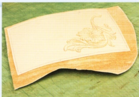
9 順應皮革彎曲的方向，把皮革黏合成微彎的狀態。
