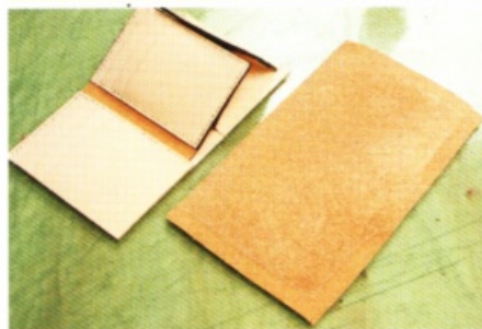
2 準備當作主體的皮材。按照紙型，描下正確的裁割線。
