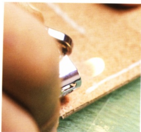
22 因為用的是尼龍線，所以從尾端剪掉縫線後，用打火機燒融。
