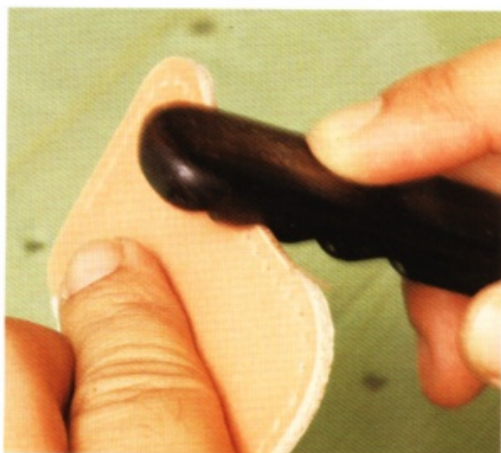
21 削去皮革邊緣後，打磨毛邊。為了能筆直地安裝好皮帶，先在正中央標出記號。
