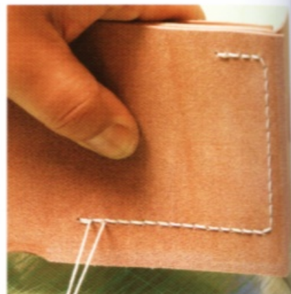
35 之後用麻線縫合。縫合完畢後，零錢夾就算完成了。
