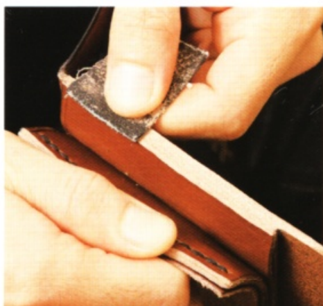
28 首先用砂紙把毛邊打磨得光滑平整。另外一邊也要打磨。
