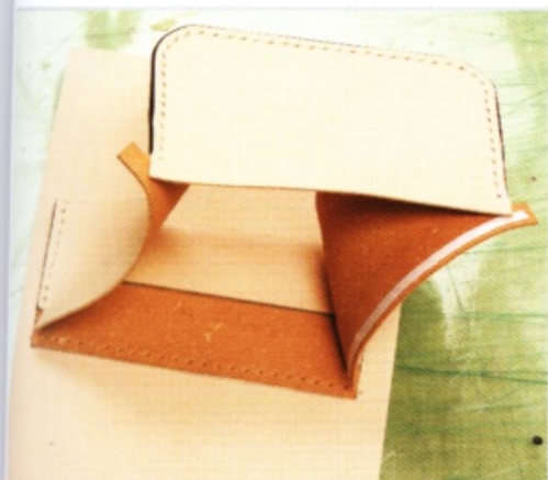
6 縫合零錢夾層之前，先以菱斬鑿出縫線孔的狀態。
