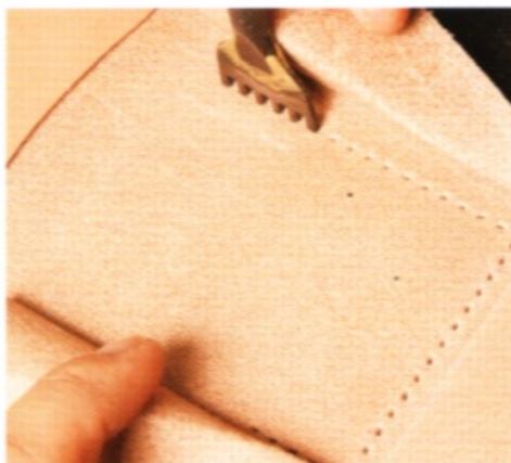
34 打開零錢夾層，在剛才拉出的縫線溝槽壓出印記，用菱斬鑿出縫線孔。
