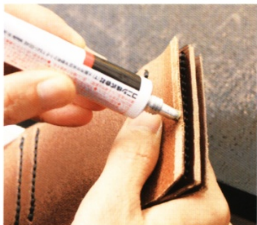
26 卡片夾層的兩側也抹上白膠，黏合。對齊邊緣貼合後，將皮革壓牢。
