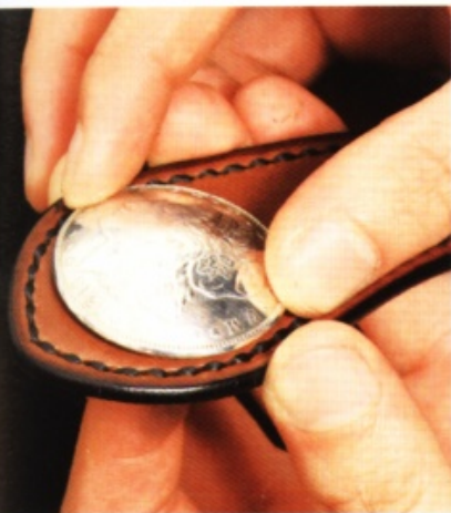
17 最後安裝銀釦。把銀釦放在正確的位置，用一字螺絲起子鎖緊。
