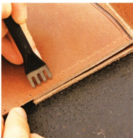
30 在零錢夾層的下端也拉出縫線溝槽，再用菱斬在上面壓出印記。
