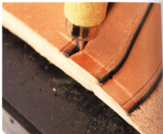
4 在以菱斬壓出印記前，用鐵筆在皮革重疊的部分做記號。
