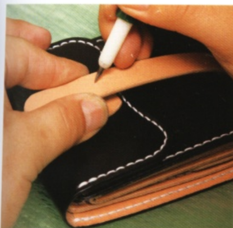
53 將皮帶放在原子釦上，用鐵筆標出位置。用尺測量位置是否在正中央。
