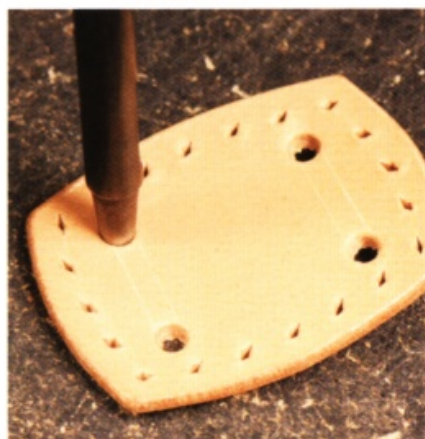
15 用圓斬在 4 處鑿孔。再以平斬將孔洞的內外相連。
