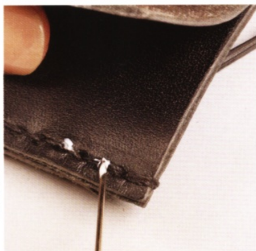
44 把白膠抹在剪掉的縫線上，固定線頭。進行至此，零錢夾層的部分就完成了。
