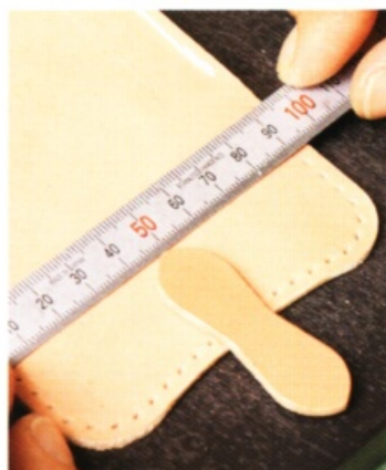
24 調整至完全筆直後，壓牢。用圓錐鑿出只要能在皮帶留下記號的深度的孔洞。
