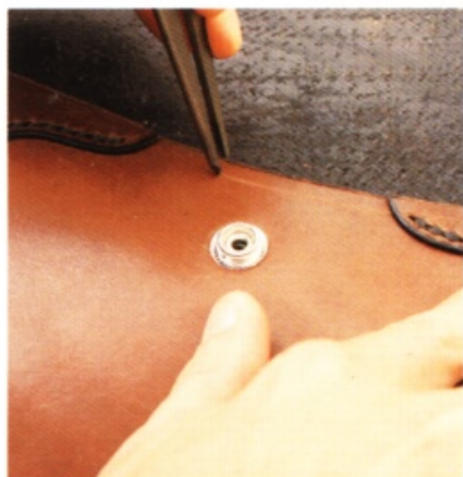
3 毛邊修整完畢後，使用手開間距規，拉出縫線溝槽。
