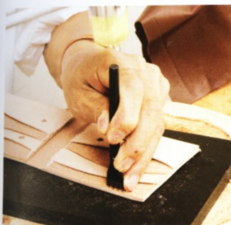
12 接著用菱斬鑿出縫線孔。接著，縫合上端。首先把針穿過右邊的第一個縫孔，以內側和外側的針交叉成十字的方式縫合。
