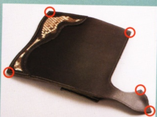
18 用菱斬鑿孔前，先以菱錐在邊角鑽孔。邊角共有 5 處，請全部用菱錐鑽出小孔。
