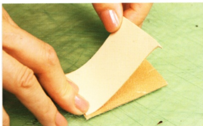
5 等到橡皮黏膠乾燥到不會黏手的程度，將兩片皮革黏合。
