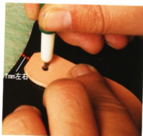
11 保持彎曲的狀態，用鐵筆在皮帶孔內做記號。
