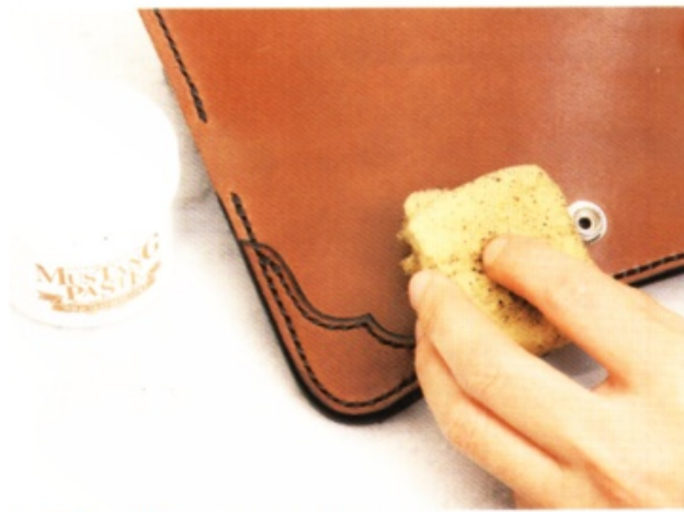
16 在銀面均勻地抹上野馬油 (Mustang Paste)。靜置約 1 小時使其乾燥，再擦掉多餘的油脂。
