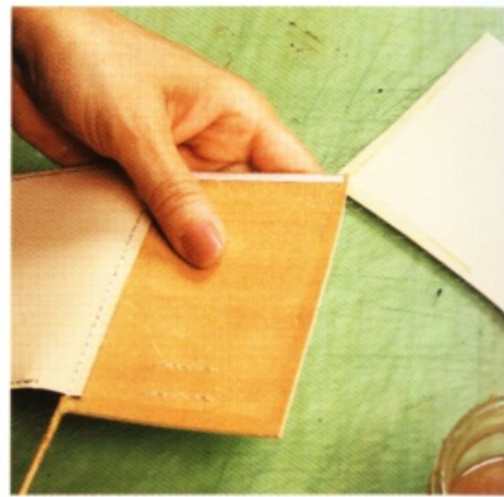
14 對齊主體的接著面，在卡片夾層的底層也抹上白膠。
