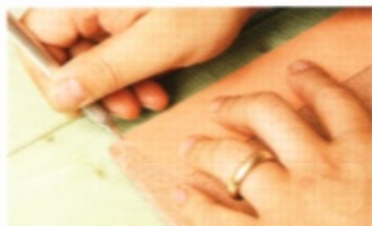
3 把紙型放在主體的床面，在貼合主體內側與固定紙鈔的舌釦部分做出記號。
