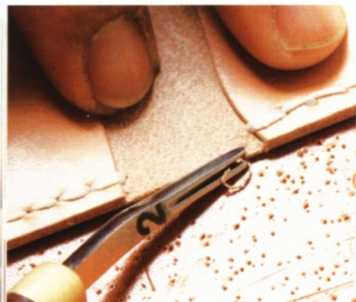
26 從尾端剪掉多餘的縫線。用打火機燒融，再將縫線壓扁。削掉兩面的皮革邊緣，打磨毛邊。接著削掉邊皮和袋蓋之間的皮革邊緣，打磨毛邊。下一步是安裝穿過皮帶的皮環。首先削去皮環的皮革邊緣，再打磨毛邊。
