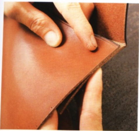
24 將零錢夾層貼合在主體。仔細對齊邊緣貼合後，將皮革壓牢。
