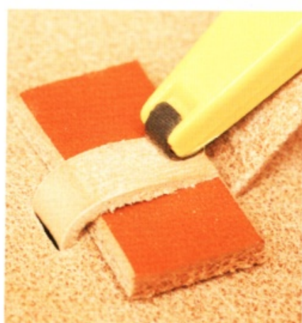
30 把做好記號的內側磨粗。抹上橡皮黏膠，黏合。在中央拉出縫線溝槽，再以菱斬鑿出縫線孔。
