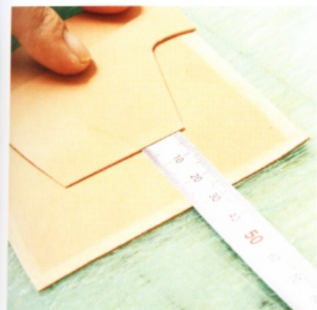
7 因為要用拉溝器拉出縫線溝槽，所以要量出距離溝槽的長度。
