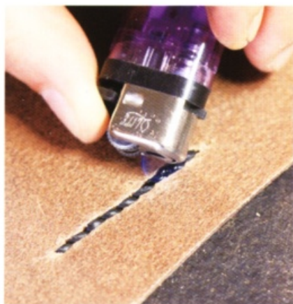
11 用打火機燒融縫線，再將線頭壓扁。這時也將針腳一併壓扁。
