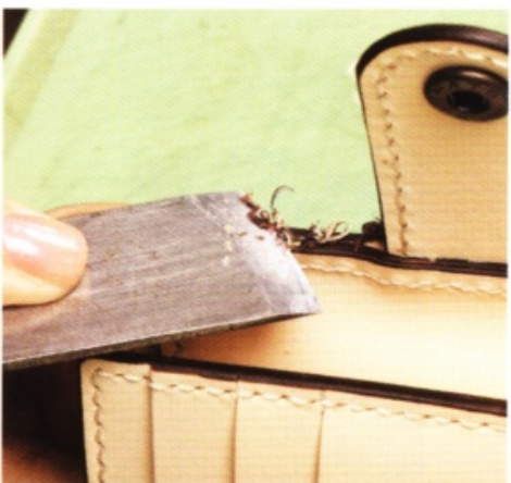
58 將短的一邊對齊，削平。即使毛邊已經修整過了，如有必要，還是得再次修整。
