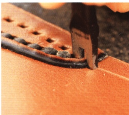
5 以皮革重疊處的記號為起點，在拉好的縫線溝槽上壓出印記。接著用菱斬鑿出縫線孔。
