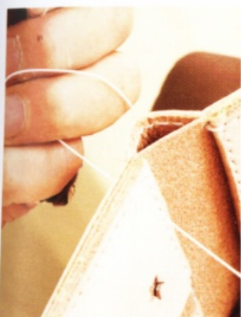
33 縫製到最後一個縫線孔後，往後回縫兩針，剪掉縫線。最後將側邊和下端的毛邊打磨得光滑平整。
