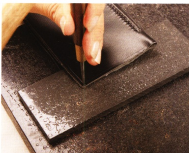
29 再度回到零錢夾層的製作。用手開間距規在零錢夾層拉出縫線溝槽，再用圓錐在 4 個角鑽孔。為了避免鑽到下面的皮革，記得中間要墊張橡膠板。
