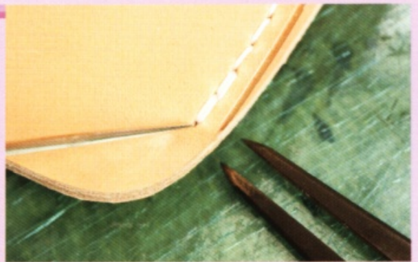
10 壓出印記時，要錯開邊皮的最後一個縫線孔。也就是菱錐所指的孔洞。
