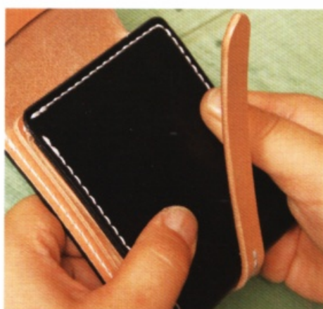
51 折起零錢夾層，和卡片夾層的邊緣對齊。
