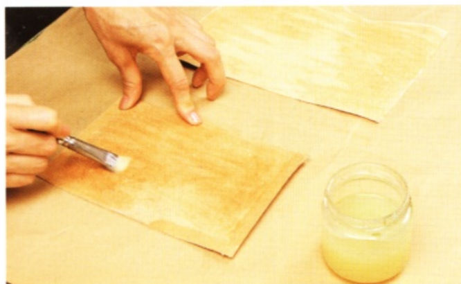
3 黏合主體部分時，使用延展性佳、無損皮革柔軟性的橡皮黏膠。
