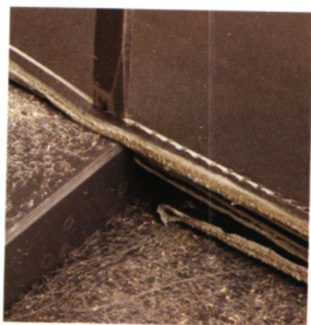
20 在整塊皮革依序鑿出縫線孔。皮革重疊的部分不少，要仔細確認是否已鑿出明顯的孔洞。另外，打孔時要跨越皮革的重疊之處。
