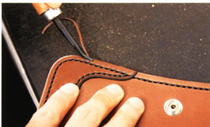
11 削除皮革邊緣。使用削邊器，削掉兩面的皮革邊緣。
