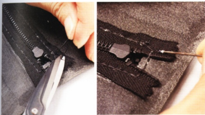
12 從尾端剪掉多餘的縫線。抹上白膠，固定線頭。
