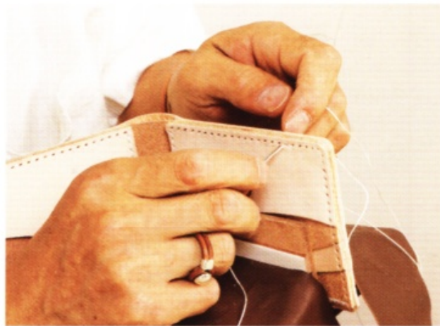
30 從主體下端開始縫合，以免線尾過於明顯。以內側和外側的針保持交叉的狀態縫合。
