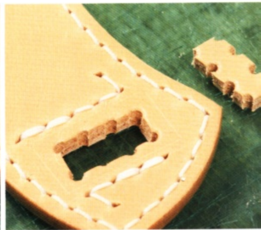
8 將雕刻刀的丸刀伸入圓孔，一路割開。如照片右所示，很輕易地便能將整塊皮革割下來。
