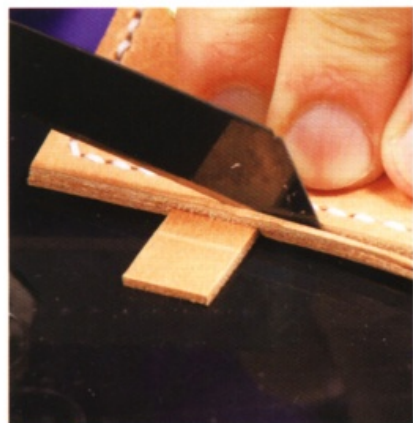
8 斜斜切掉邊角，讓蓋子部分的邊緣變得很工整。也可以把邊角的形狀削圓。
