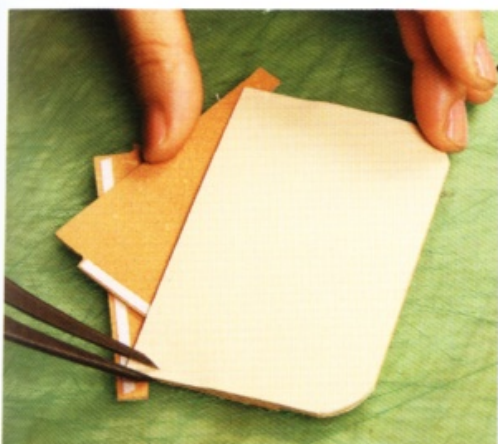
7 把手開間距調整為 3mm 寬，在袋蓋的邊緣拉出縫線溝槽。
