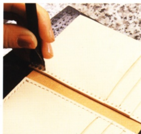
36 沿著重疊的基準線，用菱斬鑿出縫線孔。
