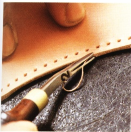
20 單獨削掉安裝皮帶的中央部分的皮革邊緣。
