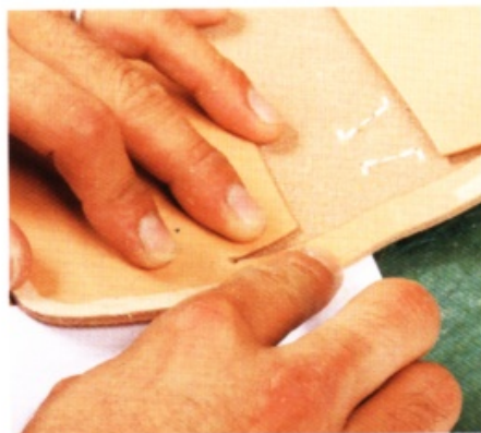
2 塗抹橡皮黏膠。從零錢夾層貼起。
