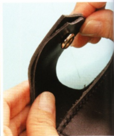
14 貼合帶狀部分。在兩面抹上橡皮黏膠，等到半乾再貼合。
