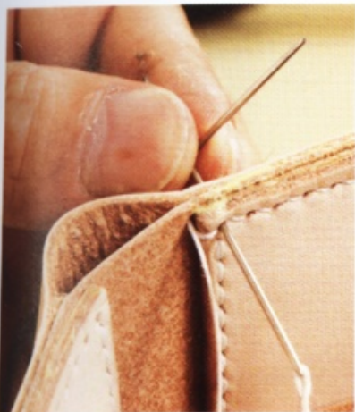
31 下端的中央部分只縫合主體①。注意不要連內側的部分也一併縫合。
