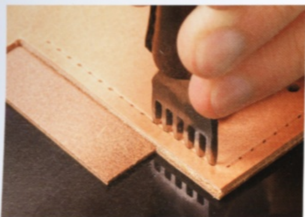
8 為了確保鑿出的縫線孔能形成一直線，下面要墊塊碎皮。長距離要使用 6 孔菱斬。
