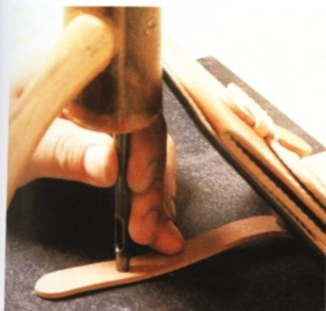
55 也用圖斬從床面鑽出孔洞。使用細棒，把孔內的毛邊打磨平整。
