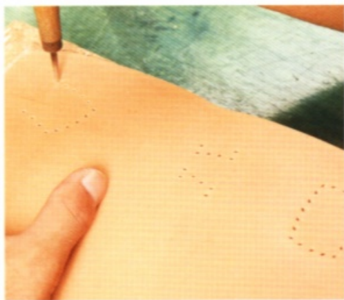
26 首先把紙型置於主體，用圓錐標示出插釦的縫線孔位置，再以菱斬鑿開孔洞。
