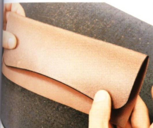
13 折出一定深度的摺痕後，將皮革往正面折。折出摺痕的同時，一樣用沾水的海綿擦拭。
