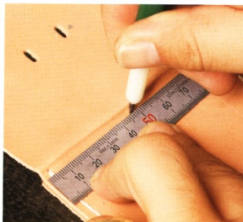
21 削去皮革邊緣後，打磨毛邊。為了能筆直地安裝好皮帶，先在正中央標出記號。
