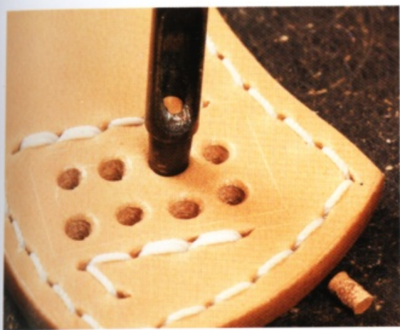
7 下一步是挖空四角形。首先用圖斬在四角形內鑿出幾個圓孔。
