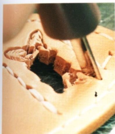
9 先粗略地挖出整塊皮革，再使用雕刻刀將剩餘部分清除乾淨。
