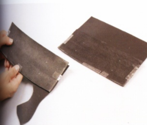
16 對齊每一塊皮革的邊緣，用膠帶固定以免位置跑掉。
