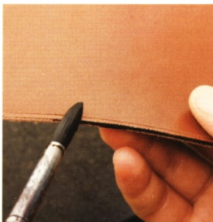
10 打磨削掉部分的毛邊。染色後，先用浸過水的海綿沾濕，再用毛巾和菜瓜布打磨。
