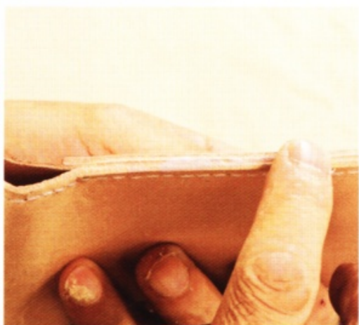
33 縫製到最後一個縫線孔後，往後回縫兩針，剪掉縫線。最後將側邊和下端的毛邊打磨得光滑平整。
