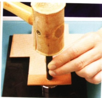
4 接著以凸出的圓棒組合四合釘的凹釘。重點是釘子要筆直固定。
