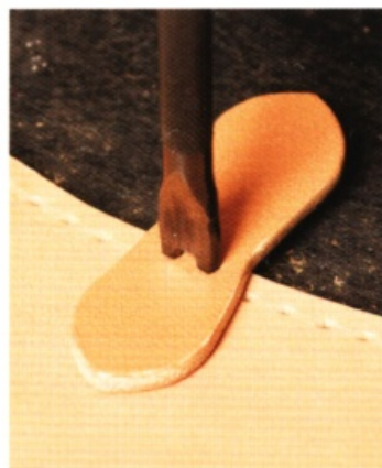
25 以2孔菱斬按照記號鑿出縫孔。接著縫合袋蓋周圍。前面兩片和皮帶的部分都重複縫製兩次，縫到最後一個縫線孔後往後縫1針半。
