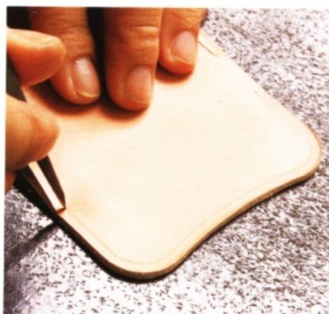
17 用手開間距規在深及銀面的標記之間拉出縫線溝槽。
