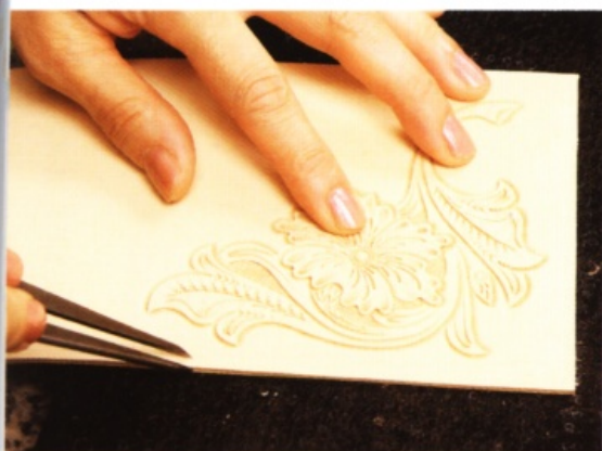
15 在主體的 4 個邊用手開間距規拉出縫線溝槽。
