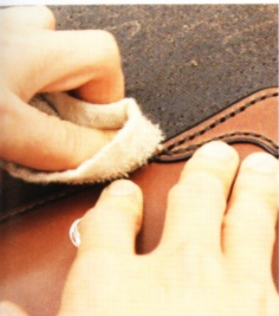
15 抹上背面處理劑後，先用毛巾打磨毛邊，再以菜瓜布輕輕打磨。
