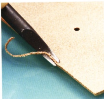
1 使用削邊器，削掉左右和四合釦邊緣的皮革邊緣。床面和銀面一起處理。
