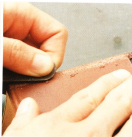
21 接著把零錢夾層和卡片夾層貼合在主體。首先，把零錢夾層的兩面磨粗。
