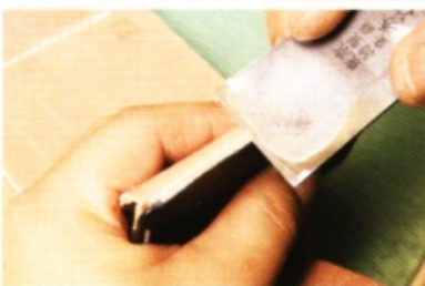
29 將主體與內裡貼合。把零錢夾層貼合在主體左側和下半部的L型部分。貼合後，修整毛邊。
