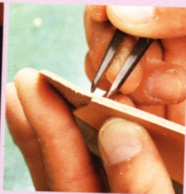
26 以 5.5mm 寬的孔距壓出印記。壓的時候要避開邊皮重疊之處。
