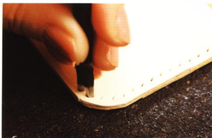
9 邊角的曲線部分，使用 2 孔菱斬鑿孔。
