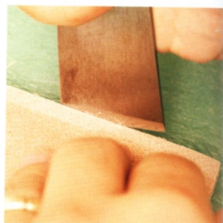
27 接著修整毛邊。用裁皮刀裁掉不整齊的部分。
