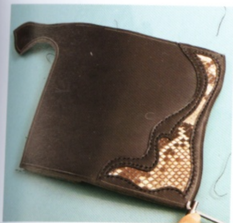
17 整塊皮革的邊緣已拉出縫線溝槽的狀態。
