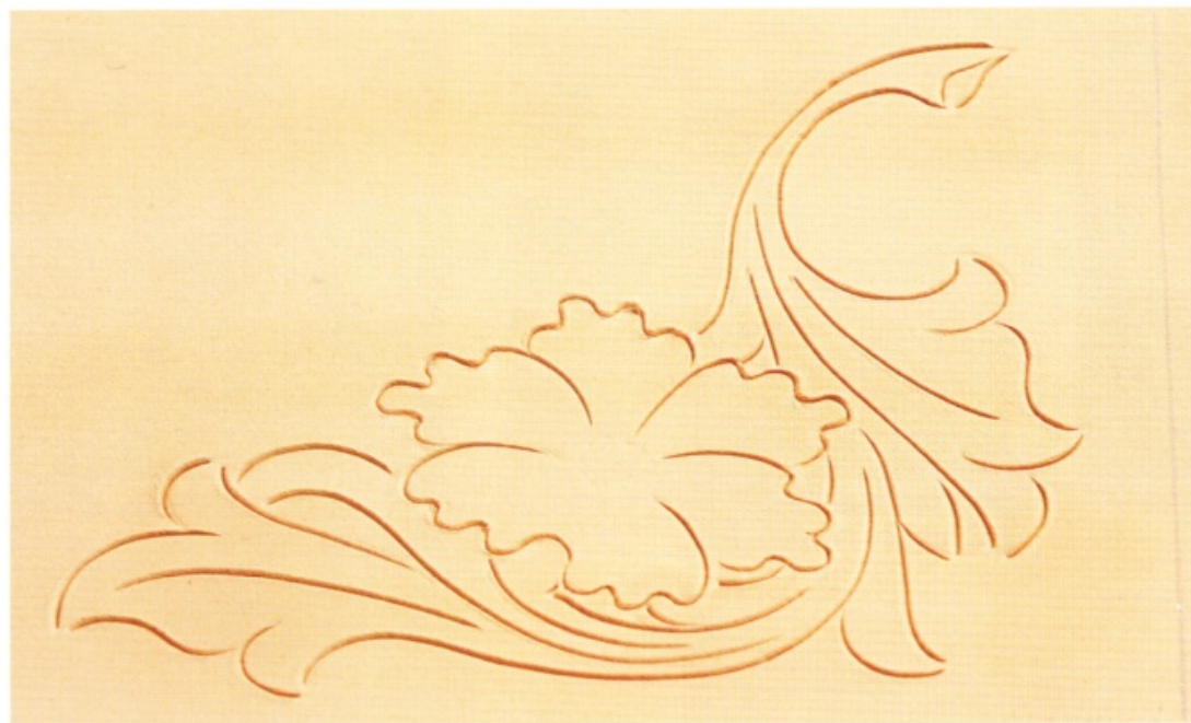
所有的線條已經裁割完畢。作業時，必須拿著旋轉刀在面前下刀，所以要隨時移動皮革。草的部分從前端下刀，雕刻時，隨時注意線條的動向和空間的平衡感。另外，下刀的深度，深及皮革厚度的 \frac{1}{3} \sim \frac{1}{2} 。
