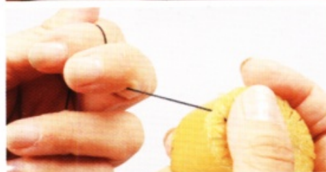
11 這次使用的縫線是麻線。首先準備長度約為縫合距離 3.5 倍的縫線，用線蠟打磨 5 次左右。
