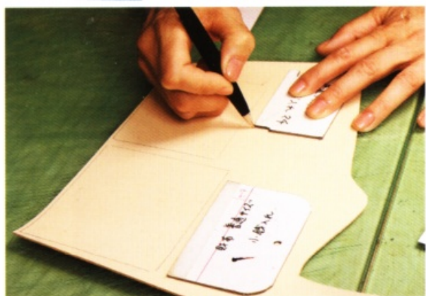
1 把紙型置放在皮革上，用銀筆拉出裁切線。
