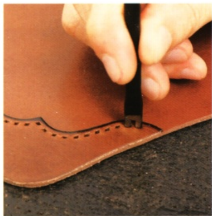
9 用菱斬沿著印記鑿出縫線孔。因為曲線部位很多，使用 2 孔菱斬較為順手。
