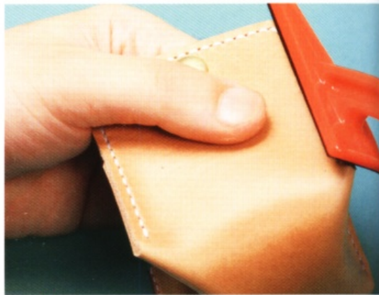
9 如果用美工刀不好切，改用三角研磨器分次削掉皮革。
