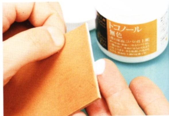
2 在毛邊抹上床面處理劑。記得要塗抹均勻，小心不要塗到銀面。
