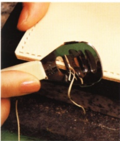
31 削掉皮革邊緣，打磨毛邊。
