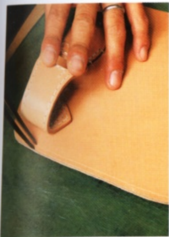
9 用手開間距規拉出縫線溝槽，以便縫合。再以手開間距規壓出印記。
