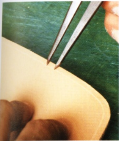
11 在外圍壓出印記後，用菱錐鑿出縫線孔。注意不要鑿到其他部位。
