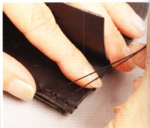
43 收尾和起針相同，以雙線繞縫後，往後回縫一針。再將表面的針穿過背面，輕輕拉緊縫線。最後剪掉多餘的縫線。
