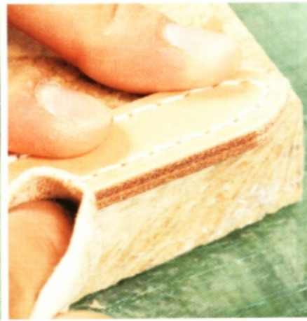
12 縫合完畢後，削除兩面的皮革邊緣，再將毛邊打磨得光滑平整。
