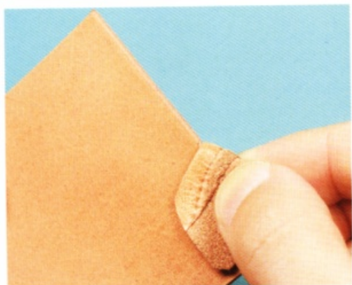
3 利用從同一塊皮革裁下來的小塊皮革打磨毛邊。如果用來打磨厚度不到 1mm 的皮革比較不順手；但皮革的厚度如果超過 1mm，不妨改用木製磨緣器。有些場合，還要再用布磨過，使皮革變得更有光澤。
