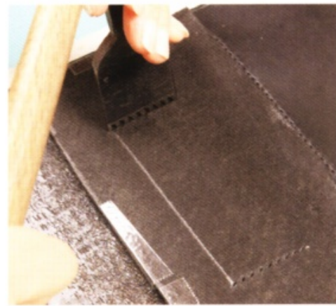
18 以拉成ㄣ字型的縫線溝槽為基準，用菱斬鑿出縫線孔。
