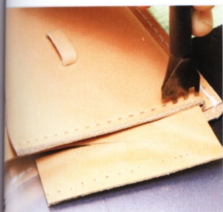
41 以剛才標示的記號為起點，用菱斬壓出記號，再鑿出縫線孔。
