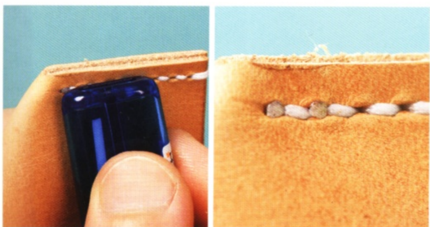
13 利用打火機的底部，將縫線壓扁。
