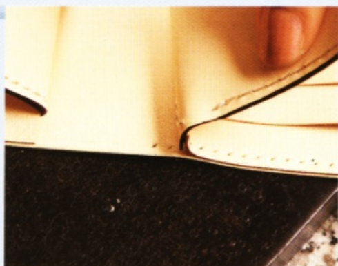
19 以菱斬從卡片夾層上方鑿下的孔洞，也要穿透主體的皮革。
