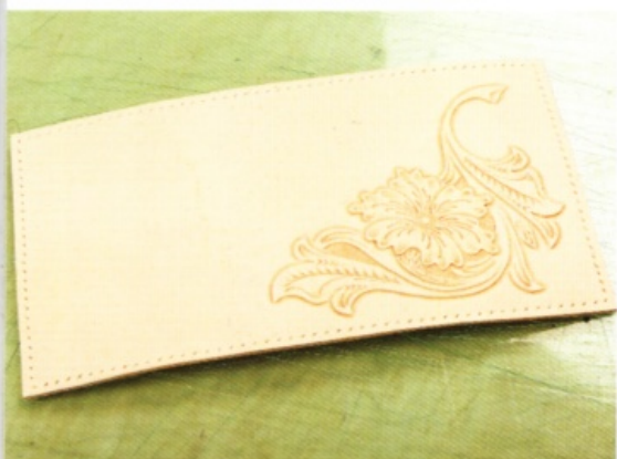
17 圖中是 4 個邊都已鑿出縫線孔的狀態。用單孔菱斬調整各端邊緣的間距。
