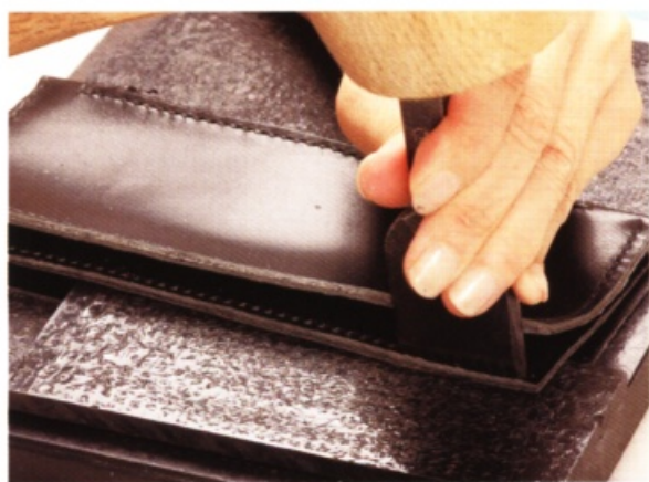
41 用菱斬鑿出コ字形。鑿好所有的縫線孔後，進入縫製作業。
