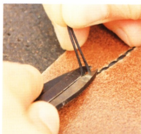
10 從尾端剪掉從床面穿出的縫線。
