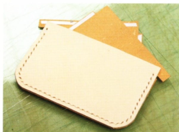
12 剪掉從邊皮穿出的多餘縫線，再處理線頭。圖中為縫合完畢的狀態。
