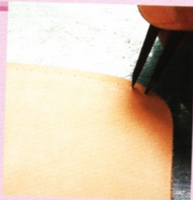
26 以 5.5mm 寬的孔距壓出印記。壓的時候要避開邊皮重疊之處。
