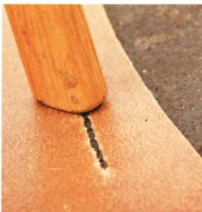
11 用打火機燒融縫線，再將線頭壓扁。這時也將針腳一併壓扁。
