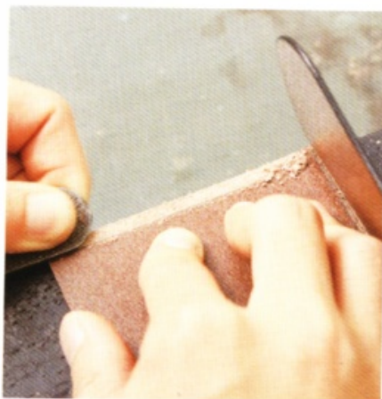
21 接著把零錢夾層和卡片夾層貼合在主體。首先，把零錢夾層的兩面磨粗。
