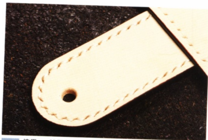
33 使用 15 號圓斬鑿出安裝四合釦的孔位。
