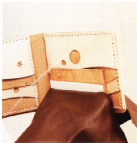
29 壓出印痕後，用菱錐鑿通縫孔。接著縫合外圍。準備長度約為縫合距離 4 倍的縫線。
