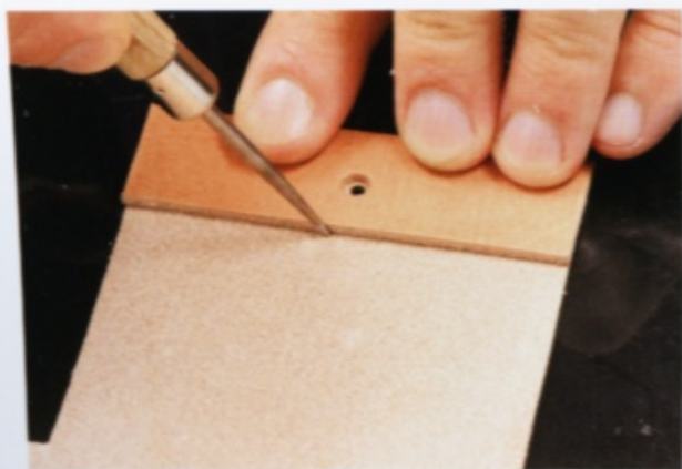
6 放上袋蓋的部分，用錐子沿著邊緣輕拉出框線，當作塗抹黏著劑的基準線。
