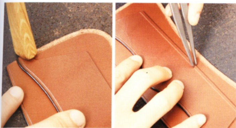
5 重疊兩張卡片夾層，用敲打的方式施壓。在距離卡片夾層F下端，2~3mm之處，拉出縫線之溝槽。
