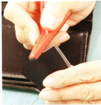
15 貼合後，修整毛邊。首先用裁皮刀削掉凹凸不平的地方，再以研磨器打磨。
