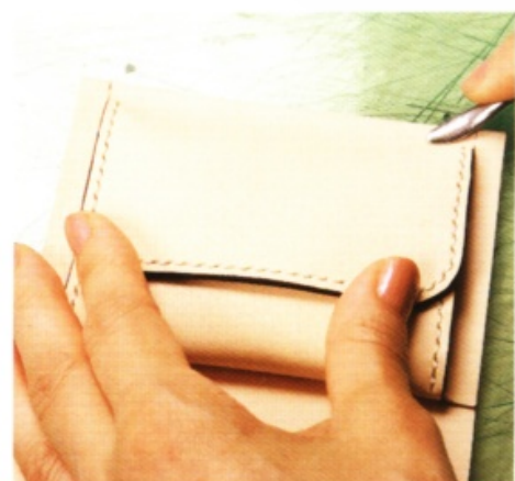
12 使用壓插器，按壓接著面。小心不要使皮革受損。
