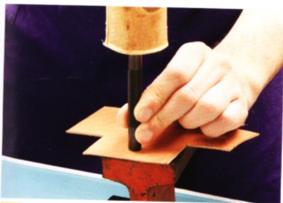
3 把凹的圓棒放在平穩的環狀台，壓住凸釘，用木槌敲打圓棒。
