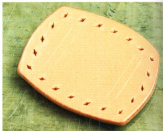
14 在邊角 4 處的中央處壓出印記，用線將印記的外側相連。在外框鑿出縫線孔。
