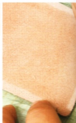
4 在主體內側的上端標記，將主體床面預備上膠的部分磨粗。
