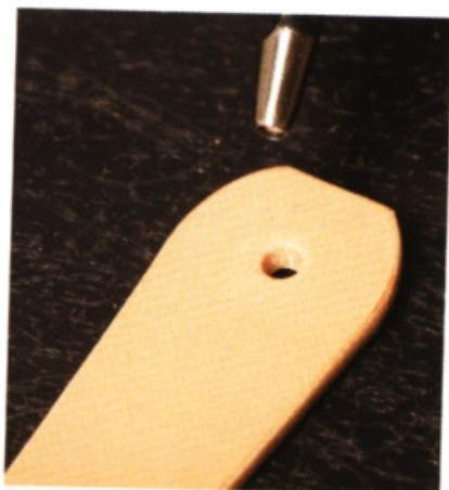
6 用圖斬鑽出安裝原子釦的孔位。在皮帶和主體塗上橡皮黏膠，再將皮帶輕輕置於主體。
