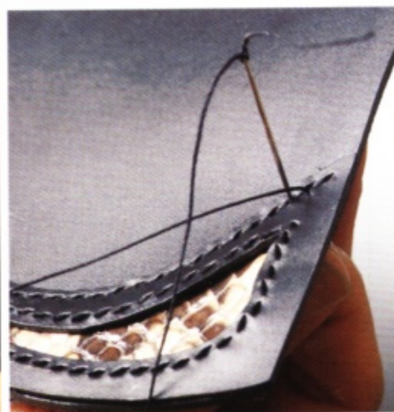
13 接著以內外兩支針保持交叉的方式縫合。縫到最後一個縫線孔後，往後回縫一針。再從銀面回縫 1 針。
