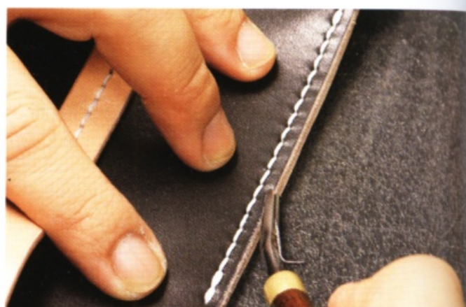
48 單獨削落染色那面的皮革邊緣。
