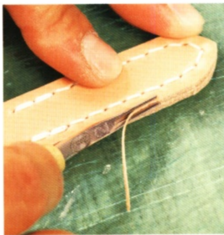
12 縫合完畢後，削除兩面的皮革邊緣，再將毛邊打磨得光滑平整。
