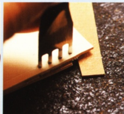
8 從距離邊緣 7mm 之處開始以菱斬鑿出縫孔。只有第一支刀刃不要刺到邊皮。下面墊張小塊皮革，有助作業進行。
