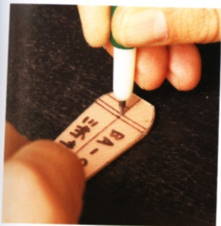
5 接著把紙型放在皮帶上，標示出打洞的位置。
