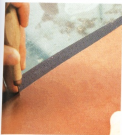
22 用圖錐鑿開本體銀面的記號，深度深及床面。再把記號下方的部分磨粗。
