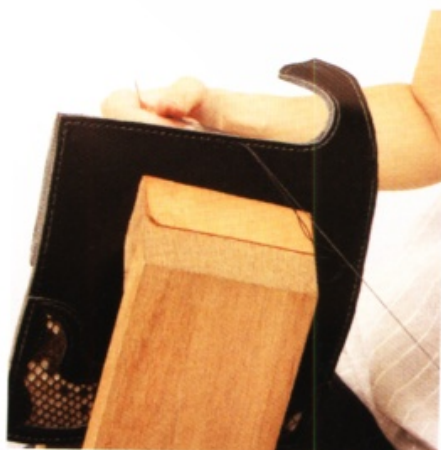
22 外圍以兩針交叉的方式縫合。因為縫合距離很長，記得先用線蠟打磨縫線。
