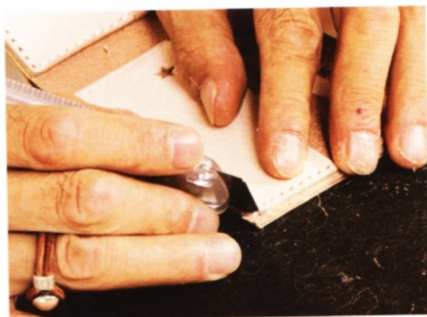
27 另一邊同樣在鑿出縫線孔後，削去邊角。
