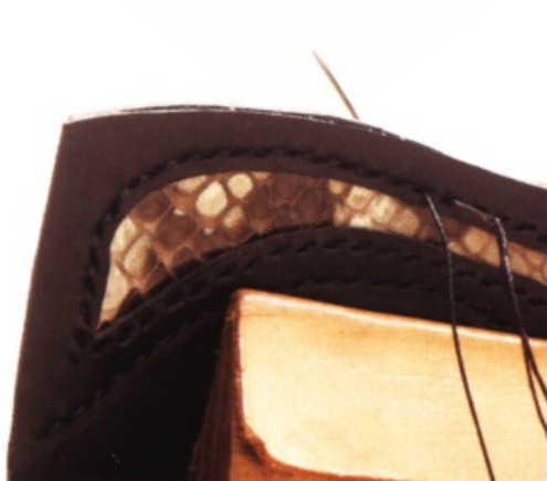
16 以同樣的手法縫合內側。把針穿入用圓錐鑽出的第二個縫線孔，以內外兩支針保持交叉的方式縫合。縫到最後一個孔後，往後交叉回縫一針，形成重複縫製2次。最後把針從銀面往床面回縫一針就結束了。
