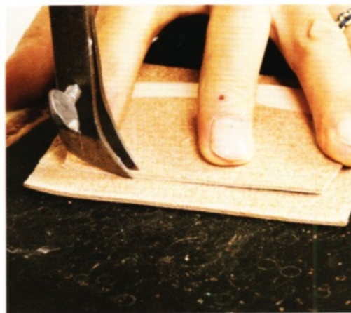
16 皮革重疊之處已經削掉一部分了，所以厚度不會太厚。貼合後，把邊緣器的寬度調為 3mm 寬，在下端拉出縫線溝槽。接著用菱斬壓出縫線孔的印子，再以菱斬鑿出縫線孔。
