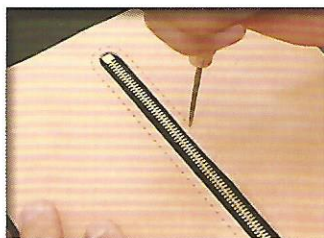
06 壓出線孔位置後，便可使用菱形錐（也可使用菱斬）鑿出線孔。
