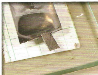
10 斜向削薄長方形拉頭零件（7 × 70mm）的兩端。
