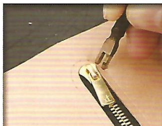
05 於前方拉出的縫線上鑿開線孔。首先須以雙菱斬壓出圓弧處的線孔位置，接著再以其為基準壓出直線部分的線孔位置。
