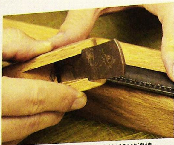
32 由於裁切過的邊緣會出現比較銳利的邊緣，使用小型刨刀將裡側與外側的邊緣削掉。
