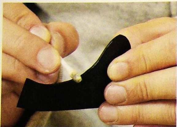
26 除了兩側比較短的部份之外，將其他毛邊都塗上海藻膠後打磨，並拉出裝飾性溝槽。
