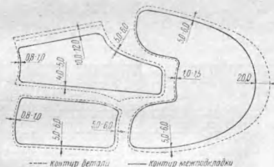
Рис. 78. Детали верха, подклеенные межподкладкой
