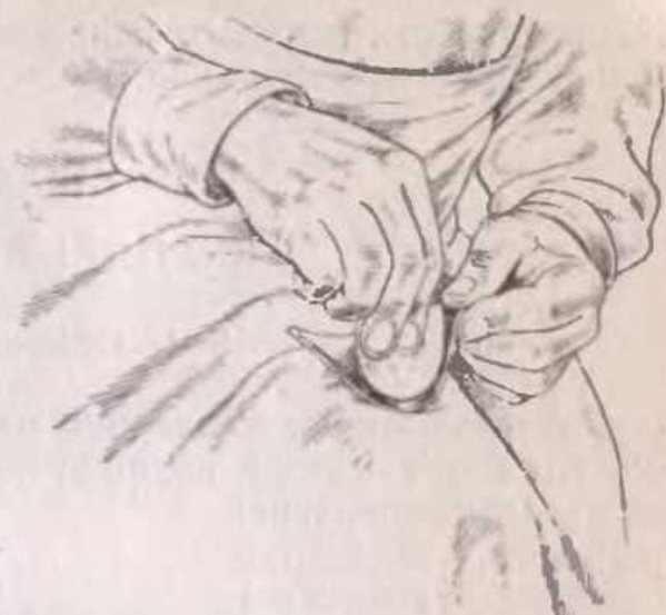
Рис. 142. Обтяжка деревянного каблука
