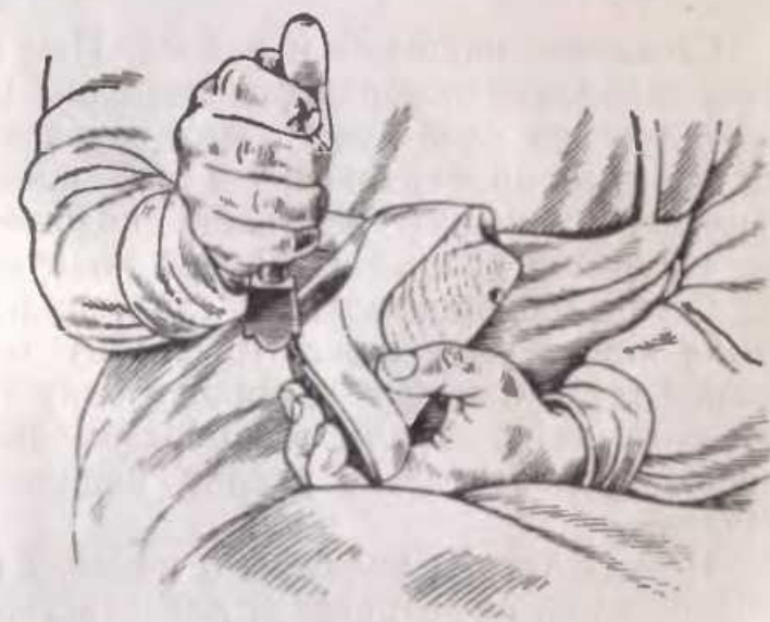
Рис. 172. Отставка уреза фумелем
