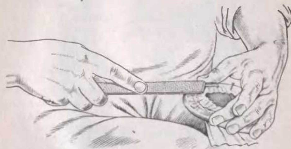
Рис. 135. Обработка носка рашпилем по затяжной кромке
