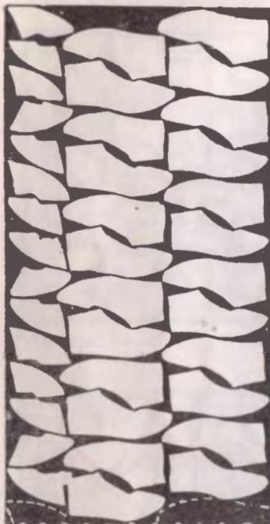
Рис. 32. Раскрой ткани на детали подкладки
