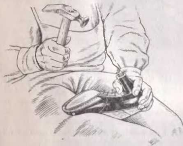
Рис. 143. Крепление каблука посадочным гвоздем
