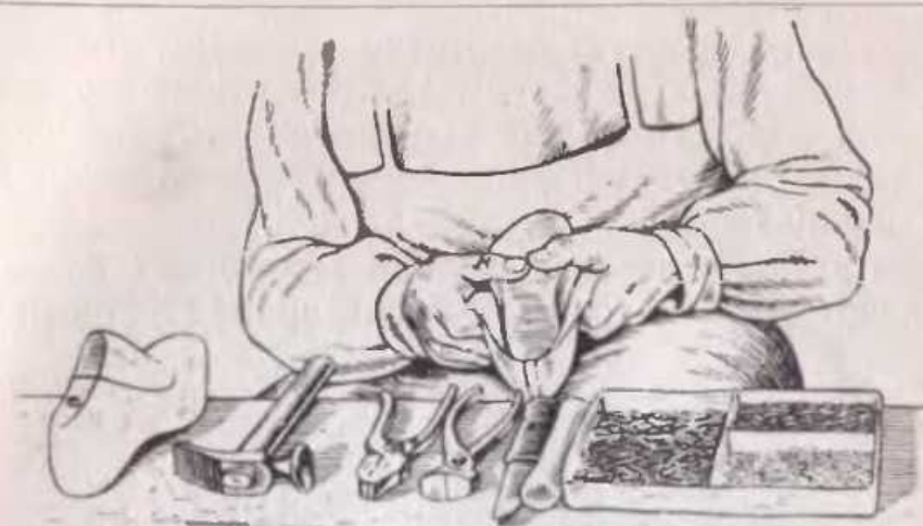
Рис. 118. Вытягивание заготовки вдоль следа колодки
