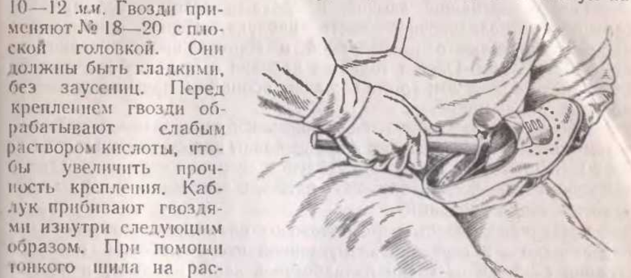
Рис. 163. Крепление каблука изнутри
