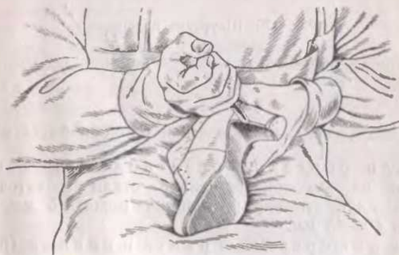
Рис. 174. Отставка крокульной части подошвы
