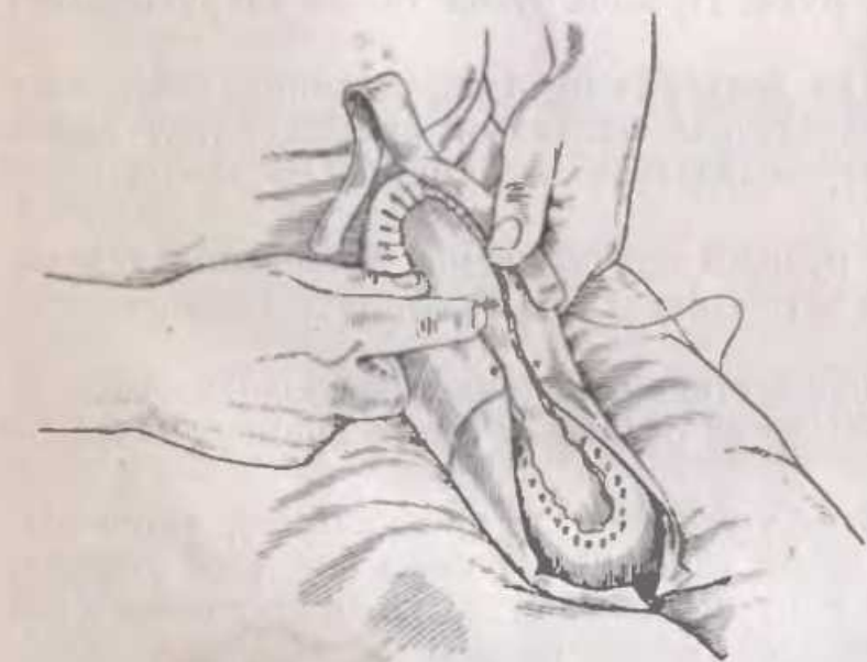
Рис. 148. Начало вшивания ранта
