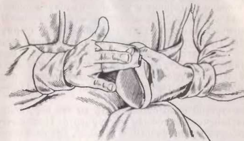
Рис. 171. Подшкуривание края подошвы
