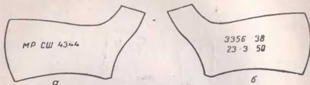
Рис. 36. Клеймение артикула, размера, номера партии и даты выпуска
