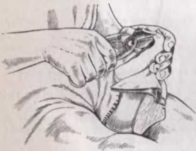
Рис. 126. Вытягивание подкладки по центру носка
