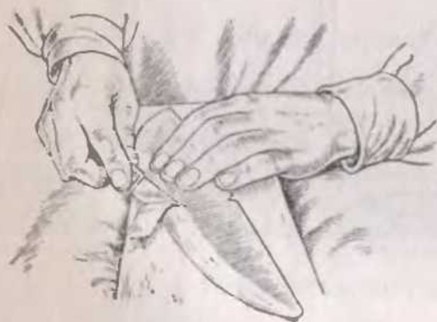
Рис. 100. Приемы работы по спуску деталей
