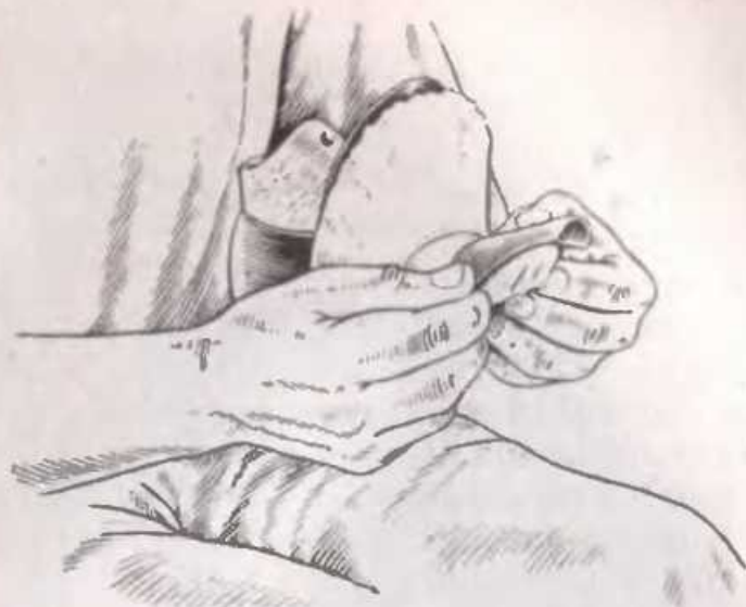
Рис. 128. Обтяжка жесткого носка
