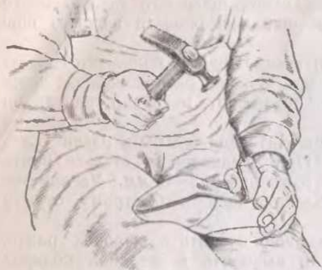
Рис. 162. Крепление каблука втулкой
