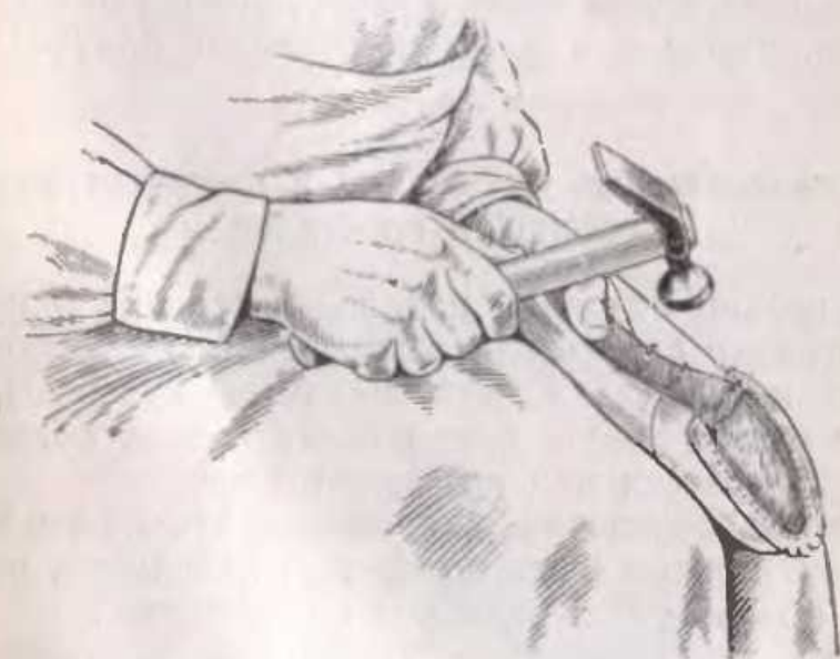
Рис. 152. Прикрепление кожаного геленка
