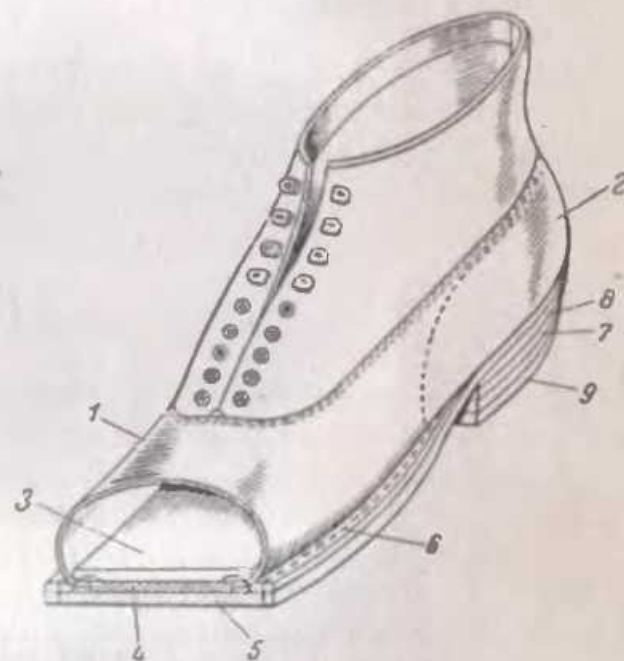
Рис. 74. Основные детали обуви: 1 — заготовка, 2 — задник, 3 — стелька, 4 — простыня, 5 — подошва, 6 — ризт, 7 — крапец, 8 — флик, 9 — набойка
