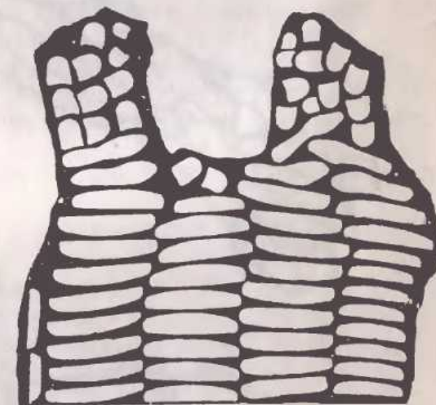
Рис. 95. Раскрой воротка на задники и стельки
