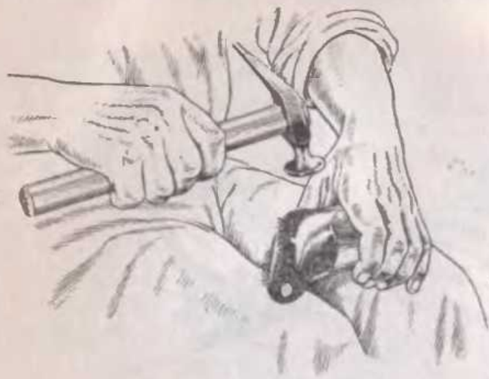
Рис. 139. Околачивание заготовки по грани
