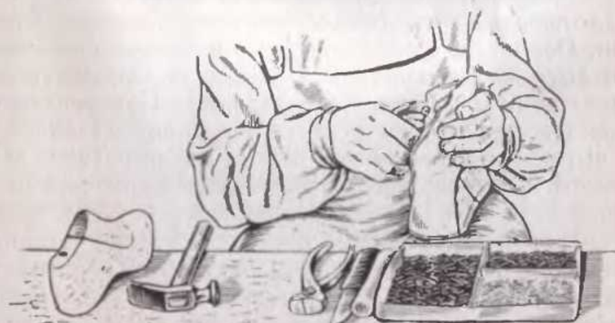
Рис. 119. Вытягивание носка руками
