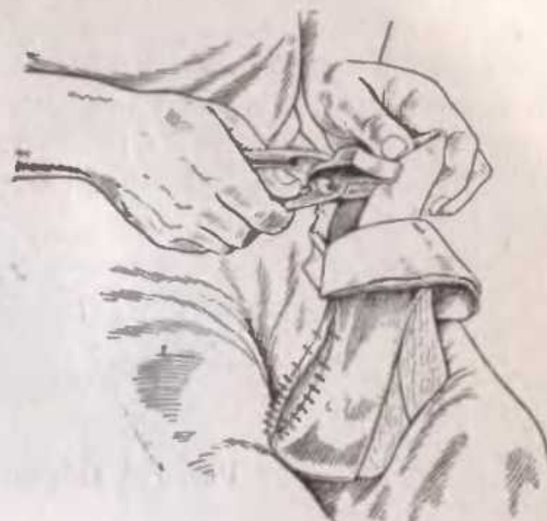
Рис. 127. Затяжка подкладки с боков
