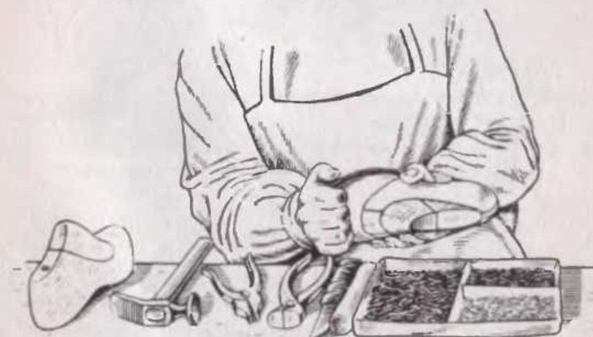
Рис. 118. Вытягивание заготовки вдоль следа колодки
