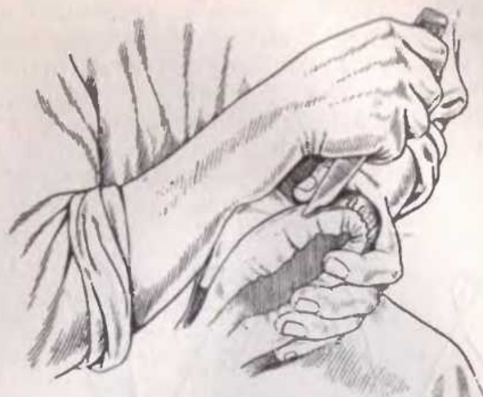
Рис. 132. Срезание носка по следу
