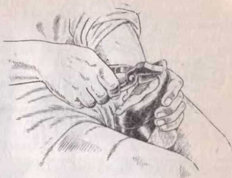
Рис. 137. Вытяжка переда в длину
