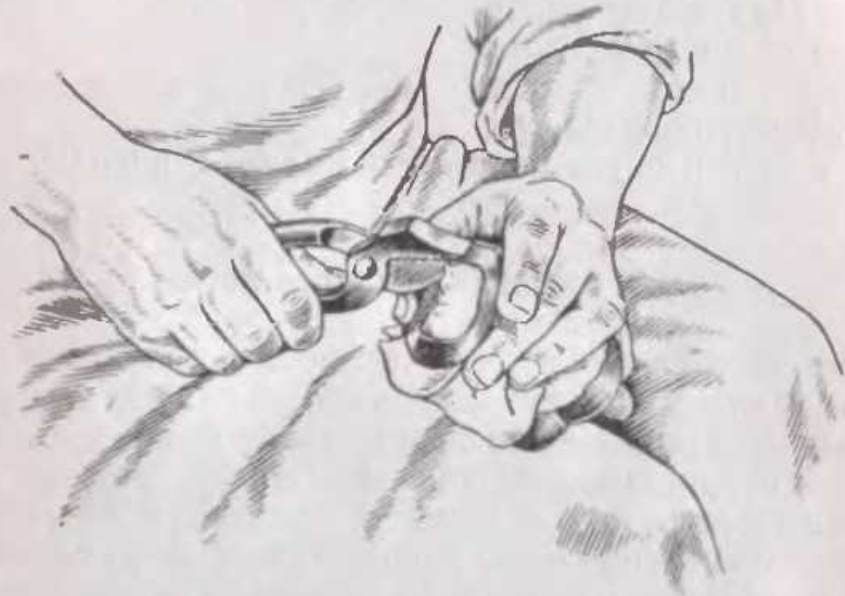
Рис. 129. Вытягивание жесткого носка с боковых сторон
