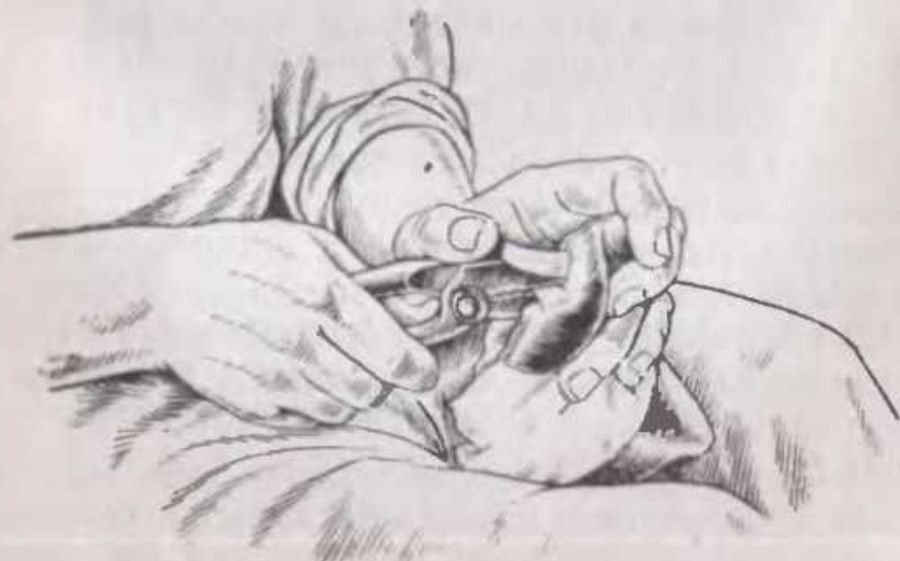
Рис. 130. Вытягивание жесткого носка вдоль колодки
