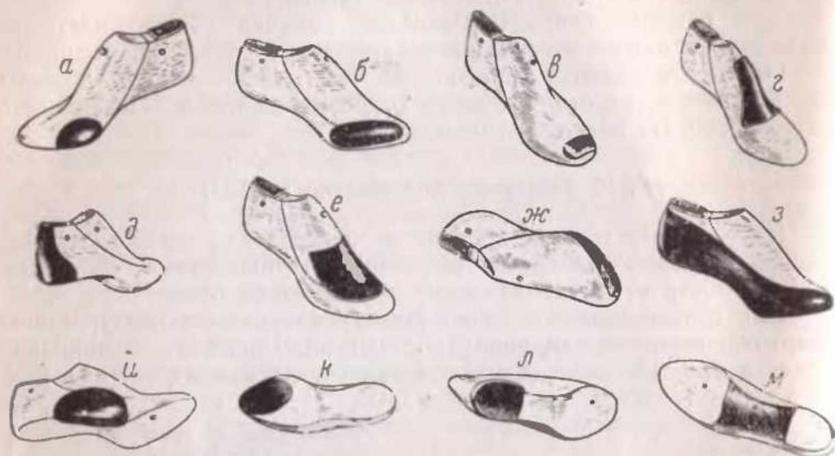
Рис. 107. Изменение формы колодки в зависимости от ненормальностей в форме стопы
