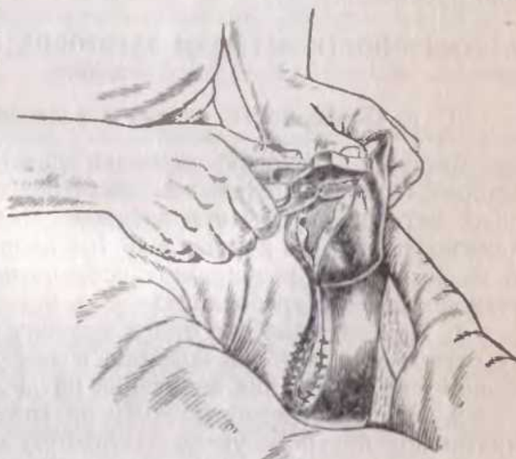
Рис. 138. Вытяжка переда в поперечном направлении
