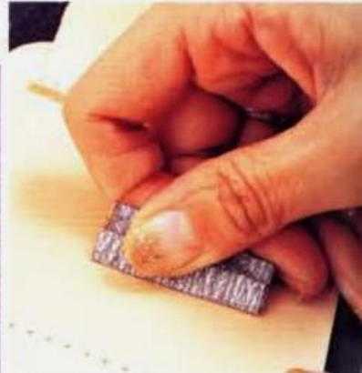
11 在基座安裝部位描上縫合位置，以該描線痕跡為準，基座部位也磨粗。
