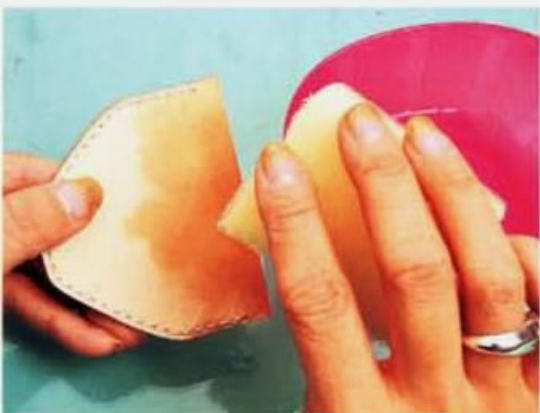
16 海綿沾水，從背面潤濕皮革，即可順利地促使袋蓋形成弧度。
