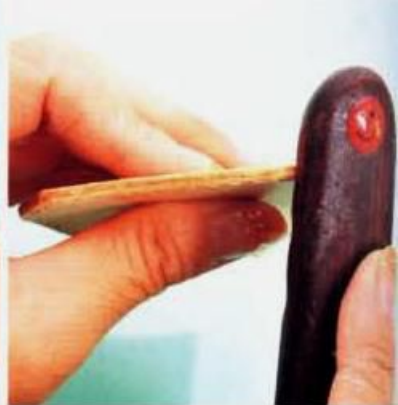
15 將透明肉面層處理劑塗抹在皮革裁切面上，以木製磨緣器打磨。利用水彩筆沾取處理劑，容易塗抹也不沾他處。
