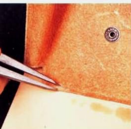
14 以距離設定為3mm的間距規，描好斬打縫孔的導引線。拿著菱斬，沿著該導引線打好縫孔。
