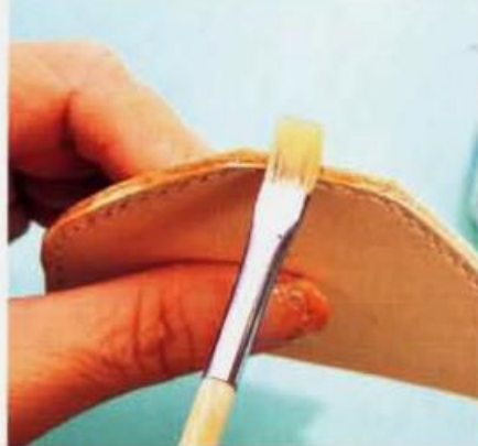
15 將透明肉面層處理劑塗抹在皮革裁切面上，以木製磨緣器打磨。利用水彩筆沾取處理劑，容易塗抹也不沾他處。
