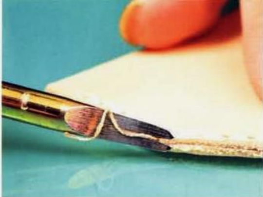
14 利用削邊器削掉零錢袋蓋部位的皮革稜邊後，打磨處理出平滑形狀。
