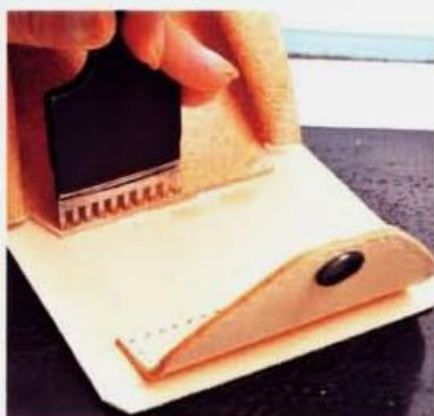
14 以距離設定為3mm的間距規，描好斬打縫孔的導引線。拿著菱斬，沿著該導引線打好縫孔。
