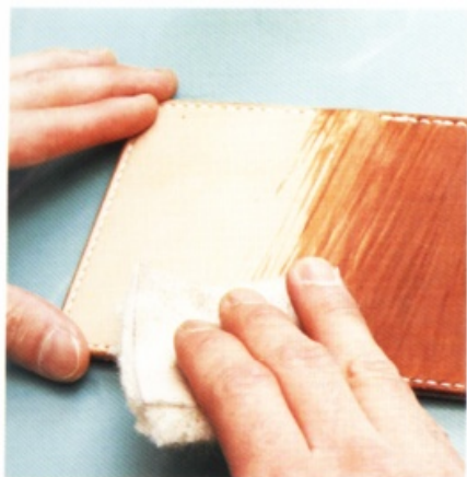
5 用含油的羊毛片像磨擦一樣地在皮革光滑面上塗上油料。
