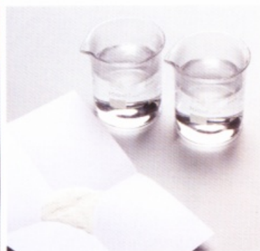
CMC基本上是將3g的CMC溶入200cc的水裡面來使用。在某種程度上，濃度可以配合個人的喜好。
