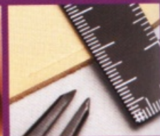
間矩規設定好了之後，先在不用的皮革上畫線看看，確認能不能確實地在3mm寬的地方畫線。畫出線條之後，再用曲尺測量寬度。
