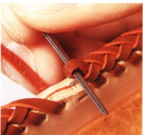
13 從下面將皮線針穿進剛才皮線被抽掉的環裡面。
