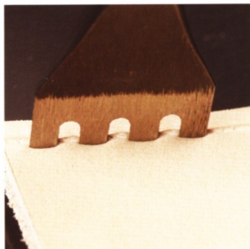
配合間隔來敲打菱斬。直線部分依照基本方法來鑽出一個一個的縫線孔。
