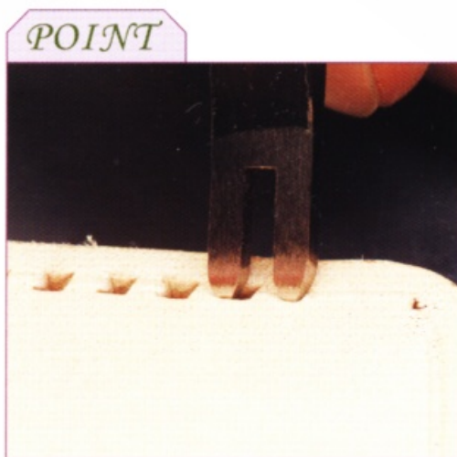
在這裡將跨在縫線孔的一根刀刃稍微錯開來，以配合間隔位置。如果錯開太多，縫線孔就會太大，所以請在0.5mm以下的幅度來進行調整。
