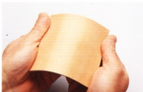
將皮革實際折折看。左邊是不會彎曲的方向，右邊是會彎曲的方向，折的時候觸感完全不一樣，所以馬上就可以了解。只要掌握這個方向，就能決定要取得的皮革部分。
