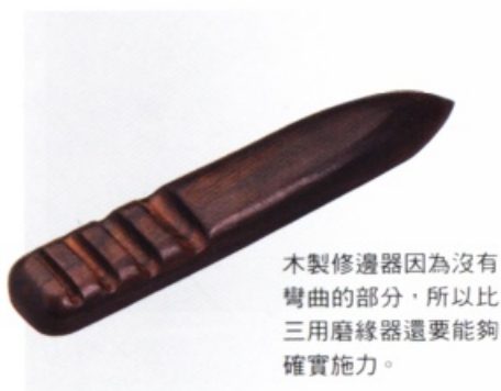
將木製修邊器放置在橡膠板表面。讓木製修邊器穩定之後，再使用尖端的部分來打磨粗糙面與光滑面。
