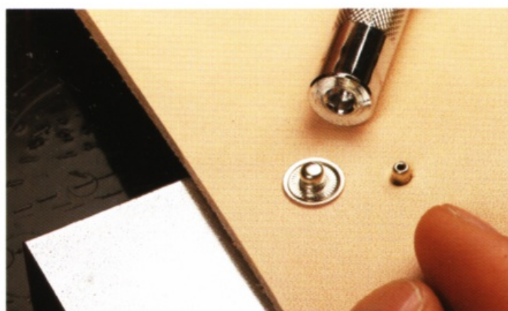
4 將之放置在萬用環狀台平坦的那一面上面。在主體上插入底釦，並準備四合釦工具(大)。
