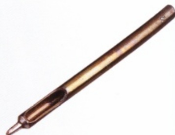
角落可以使用丸斬來代替平斬進行鑽孔的工作。
