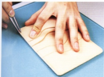
1 將間距規設定在3mm寬，然後在粗糙面上畫出基準線。
