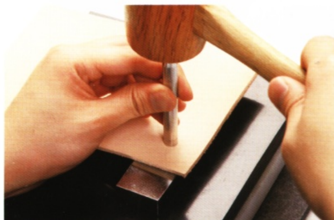
6 將四合釦工具在萬用環狀台上面保持垂直的狀態，使用木槌分成四~六次來敲打。
