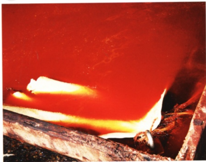
單寧鞣是將皮革浸在單寧槽內好幾個月的時間之後所製成的；鉻鞣則是在旋轉的桶子裡加入鞣劑所製成的，所以可以在短時間內就完成。
