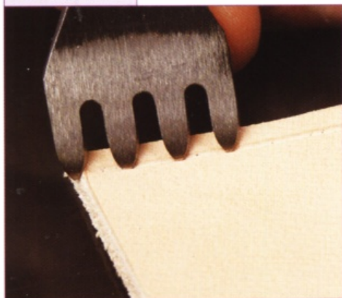
邊緣的部分要從外側來轉動縫線，所以菱斬的刀頭要像照片一樣，將一根刀刃錯開，來定出間隔。
