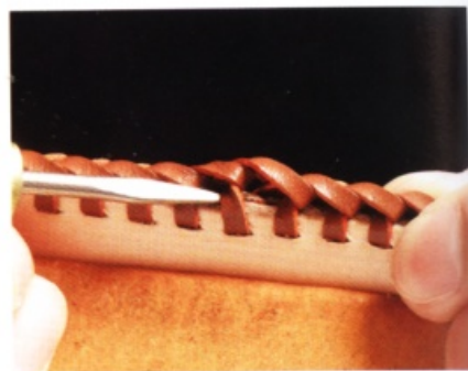
17 面向毛邊的編織針腳用薄平錐調整。
