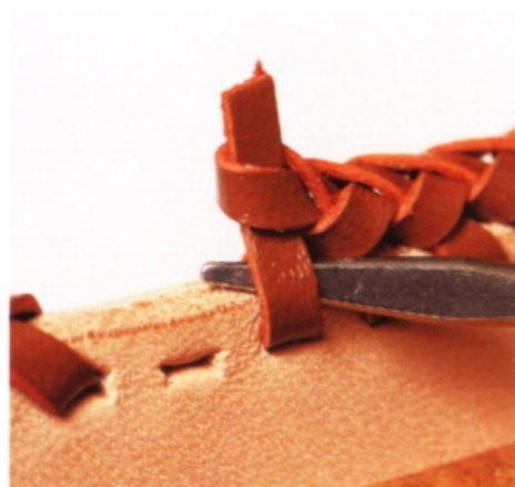
8 留下終點，先暫停編織工作，將第一個皮線從環的中間往自己的方向解開。
