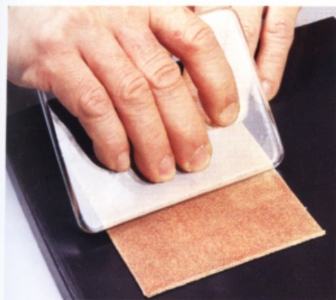
用玻璃板打磨粗糙面。如果太用力的話，皮革就會伸展開來，所以要一邊注意力道一邊打磨。
