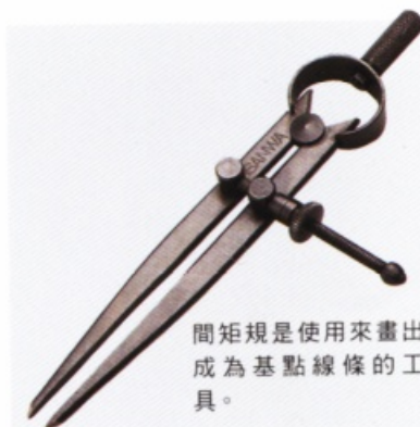
間矩規的尖端如果就這樣直接使用的話會太銳利，所以要用研磨片先削圓之後再使用。
