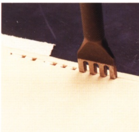
8 定出間隔，然後就這樣到下一個基點的第五個縫線孔為止，用四菱斬鑽出縫線孔。
