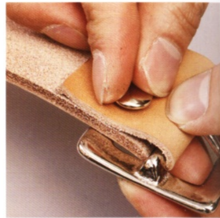
8 在皮帶皮革上安裝帶釦，將固定釦放置在有厚度的皮革的均衡點。
