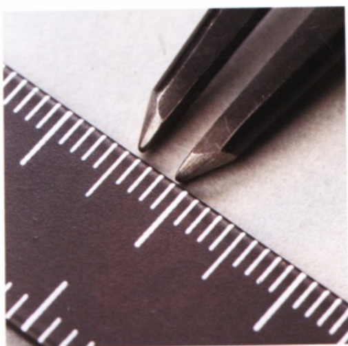
縫線基本上要畫在距離邊緣3mm的地方，所以將間矩規的寬度設定在3mm寬。
