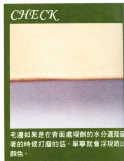
最後配合寬度再用溝槽來打磨，就能讓毛邊呈現弧形。如果纖維沒有束緊的話，毛邊就會翹開，所以請注意。
