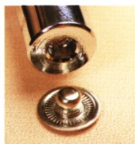
將公釦套在底釦上面，從正上方壓上四合釦工具。配合公釦的突起部分，四合釦工具也使用尖端中心凹進去的部分。
