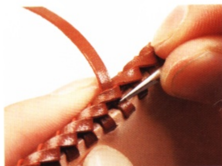
19 用薄平錐調整表面與裡面，並用剪刀剪掉皮線的根部。
