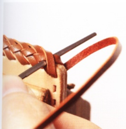
6 將皮線穿過皮線孔並拉緊，然後從自己的面前像要挖交叉部分一樣地插入皮線針。
