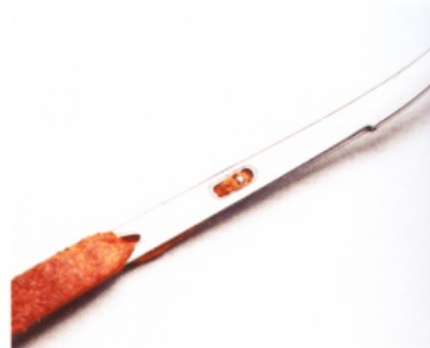
9 從背面確認的話，可以看得出來，皮線針裡面的倒鉤確實地深入皮線當中。
