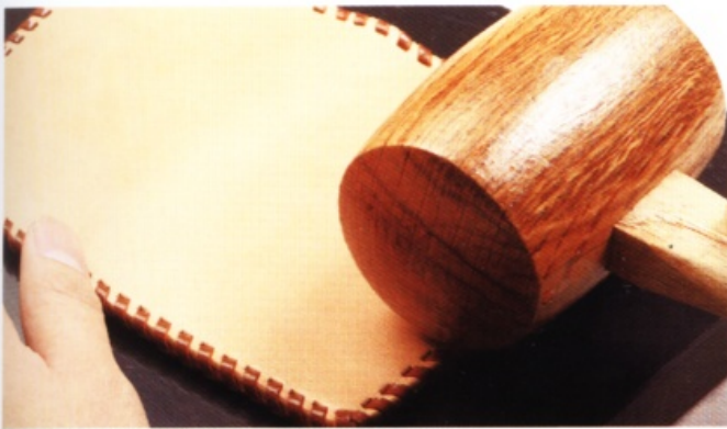
15 用木槌的腹部輕輕敲打，讓皮線融入皮革當中。
