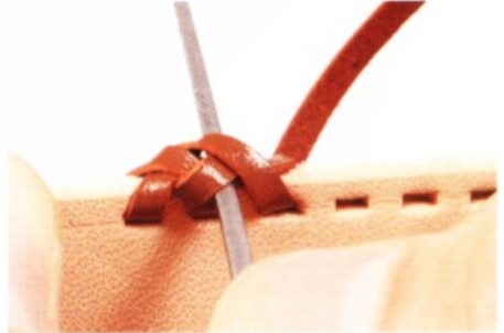
5 拉緊皮線之後，讓皮線在毛邊的中心交叉，然後從自己的面前像要挖交叉部分一樣地插入皮線針。
