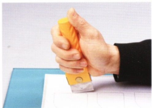
替刃式裁刀要像這樣確實地握住握柄，往自己的方向切割。工作的時候，需要在紙型下方墊上塑膠板。
