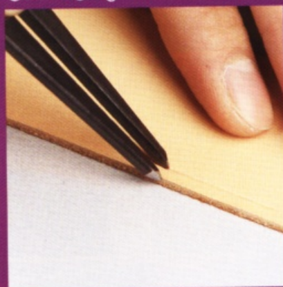
間矩規設定好了之後，先在不用的皮革上畫線看看，確認能不能確實地在3mm寬的地方畫線。畫出線條之後，再用曲尺測量寬度。
