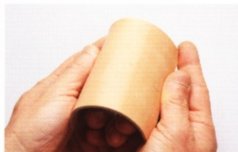
將皮革實際折折看。左邊是不會彎曲的方向，右邊是會彎曲的方向，折的時候觸感完全不一樣，所以馬上就可以了解。只要掌握這個方向，就能決定要取得的皮革部分。
