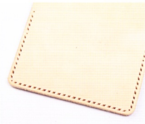
13 這是縫線孔全部鑽好的狀態。縫線孔能不能鑽得漂亮，和作品的完成度有很大的關聯。當然也可以照直鑽孔，但是希望的話，讓間隔也能呈現出漂亮的一致性。
