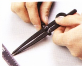
縫線基本上要畫在距離邊緣3mm的地方，所以將間矩規的寬度設定在3mm寬。
