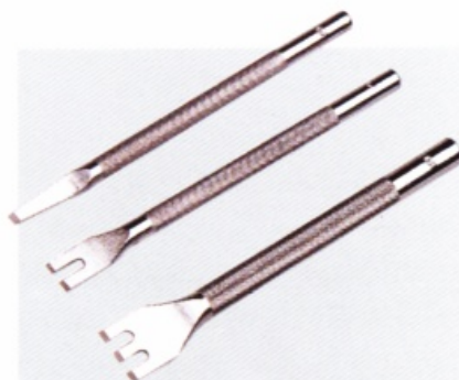
使用平斬來鑽出編織所需要的皮線孔。請注意平斬和菱斬之間的差異。
