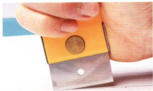
將替刃式裁刀的刀頭配合圖案的線條，刀頭的大面積儘可能地深入紙張來做切割。深入紙張的刀頭面積愈大，愈能切割出穩定又筆直的直線。
