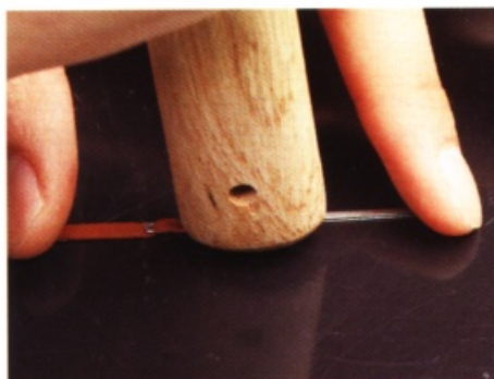
8 將夾住皮線的地方用木槌的握柄輕輕地敲打固定住。
