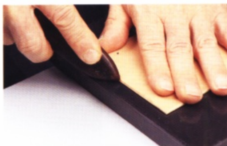
將木製修邊器放置在橡膠板表面。讓木製修邊器穩定之後，再使用尖端的部分來打磨粗糙面與光滑面。
