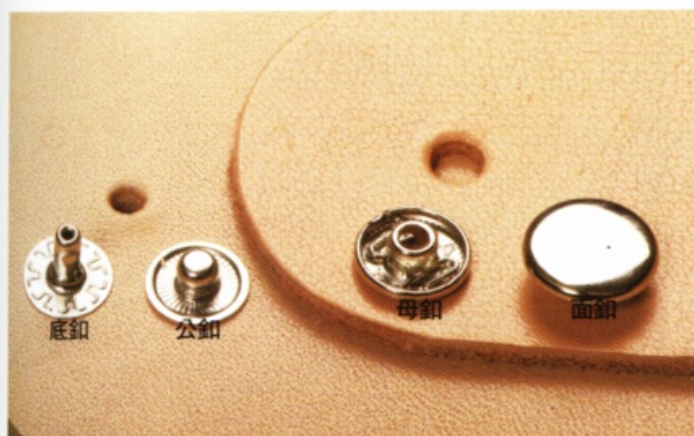
3 請確認照片上金屬零件的排列。左邊是安裝在主體的底釦與公釦，右邊則是安裝在蓋口的母釦與面釦，請以這樣的排列組合來使用。
