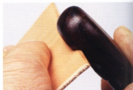
最後配合寬度再用溝槽來打磨，就能讓毛邊呈現弧形。如果纖維沒有束緊的話，毛邊就會翹開，所以請注意。
