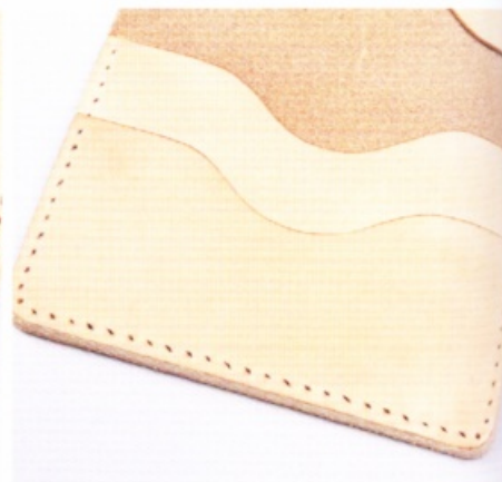
13 這是縫線孔全部鑽好的狀態。縫線孔能不能鑽得漂亮，和作品的完成度有很大的關聯。當然也可以照直鑽孔，但是希望的話，讓間隔也能呈現出漂亮的一致性。
