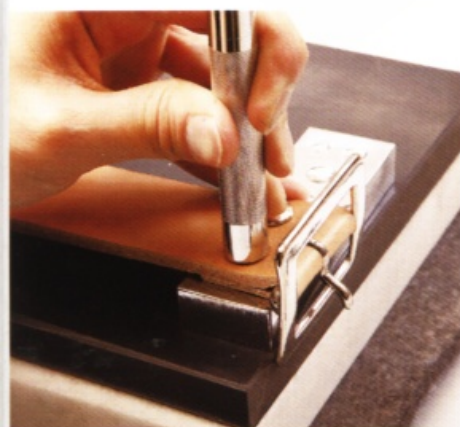
12 一邊保持固定釦工具垂直豎起的狀態，一邊敲打固定釦來固定住。
