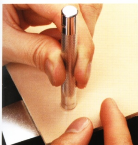
將公釦套在底釦上面，從正上方壓上四合釦工具。配合公釦的突起部分，四合釦工具也使用尖端中心凹進去的部分。
