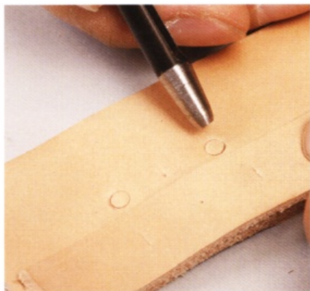
6 讓圓形的邊緣要在兩條線的內側，用丸斬在皮帶皮革上做記號並鑽孔。
