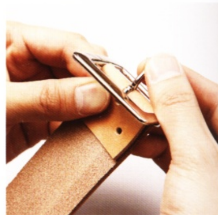
11 在固定固定釦之前，請確認帶釦針能不能在皮帶皮革的孔上移動。
