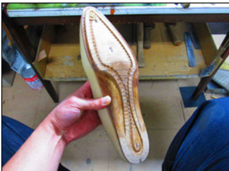
Подготовка основной стельки
