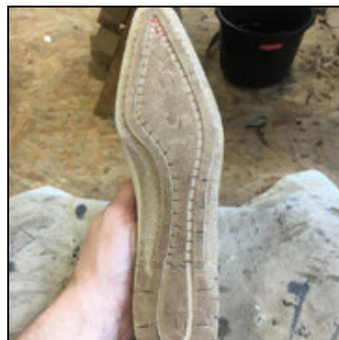
Процесс работы над подошвой. Подготовлена основная стелька
