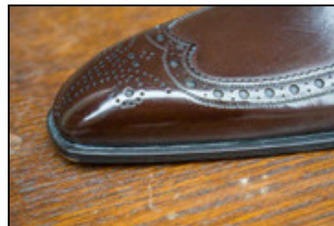
Подошва пришивалась с частотой 25 стежков на дюйм... то есть около 1 мм между отверстиями
