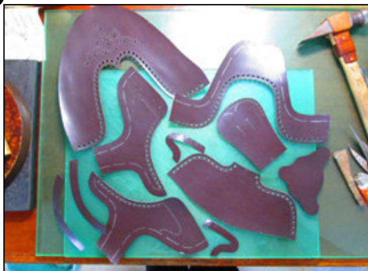
Все детали верха. Мурата сшивает верх на машинке, но броггирование и края делает вручную
