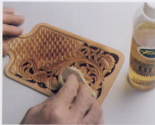
1 首先一開始先用牛腳油塗抹在整個施有皮雕的表面。
