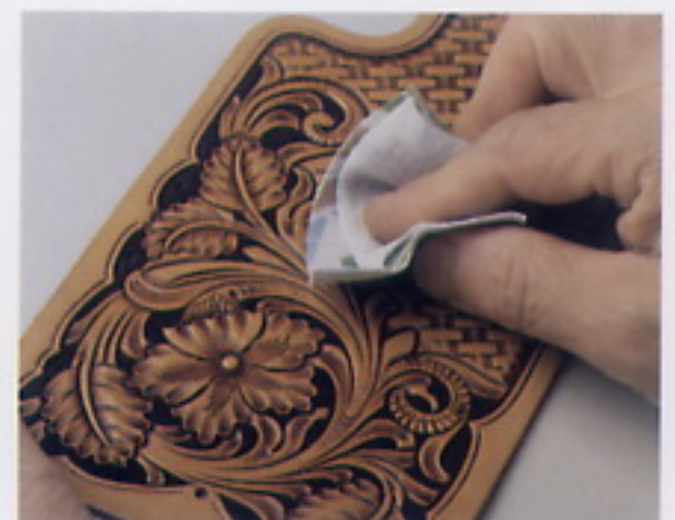
5 把古董染料擦掉之後，最後再塗上皮革覆膜作最後的修飾。
