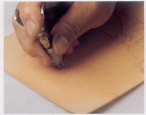
5 利用旋轉刻刀的角度來改變線條的粗細，以力道的強弱來為圖案賦予表情。
