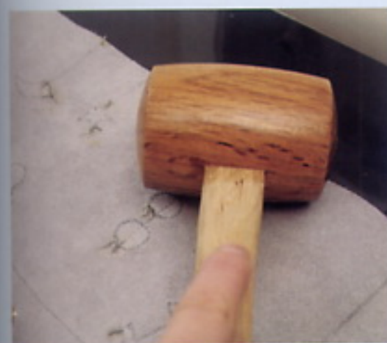
10 等到接著劑完全乾燥之後，用木槌輕輕地敲打接著的地方，將其壓緊。
