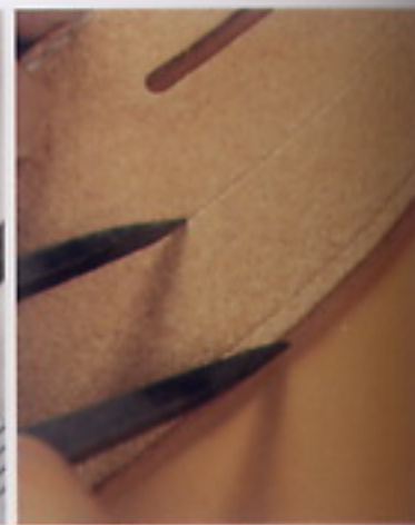
10 拉出第2條縫線。將分規器調整成20mm的寬度，把其中一邊靠在背帶口的直線部分把線拉出來。兩端要空10mm左右。
