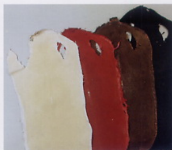
珍珠魚（光面皮）／把鯊魚的鱗片刮掉，打磨之後的皮革。屬於鯊魚皮中比較柔軟好處理的。會散發出宛如玻璃一般的光芒。
