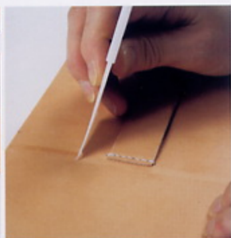
7 塗上接著劑。塗得太厚的話，空氣會跑進去，反而容易綻開，所以重點在於塗上薄薄的一層。使用上膠用刮板會比較順手。
