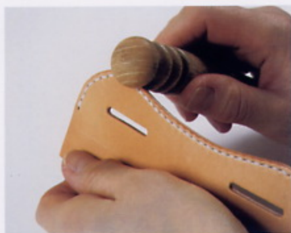
5 從塗上床面處理劑的地方用按壓式磨緣器推磨。
