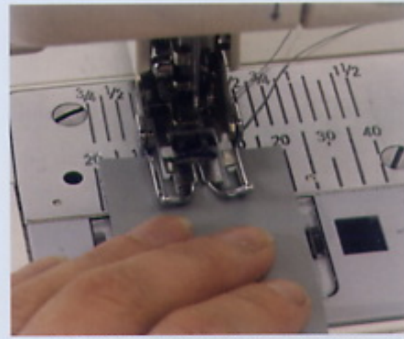
2 將繫帶皮革的兩端對齊針板上的導線20，把壓布腳和針放下來。
