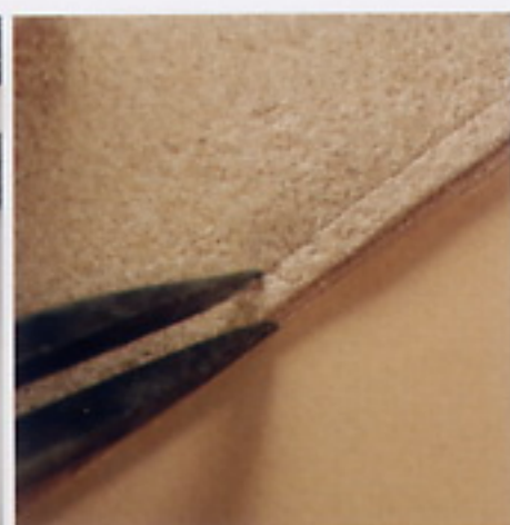
9 用分規器把縫線作出來。取3mm的寬度，把其中一邊靠在背帶口的直線部分把線拉出來。兩端要空10mm左右。
