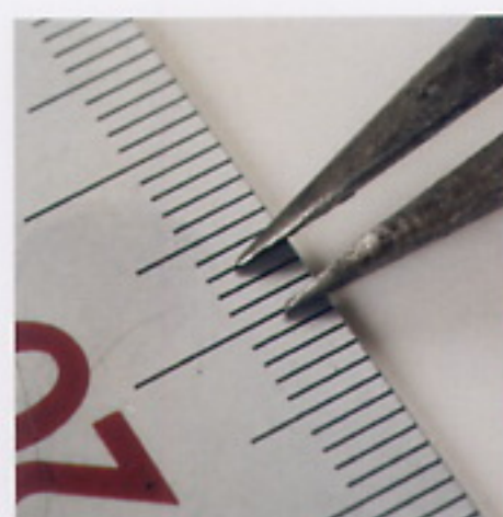
9 用分規器把縫線作出來。取3mm的寬度，把其中一邊靠在背帶口的直線部分把線拉出來。兩端要空10mm左右。
