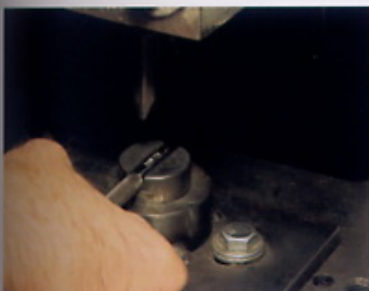
10 打上「Barry King」的標誌。然後再繼續研磨。用銼刀在各個角落反覆研磨，便可以製作出閃閃發光、具有高級感的印花工具。
