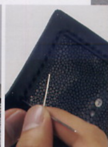
10 用菱形打洞器在外框的內側把洞打出來，用手將4片皮革縫合在一起。
