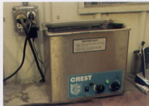
11 最後再放進超音波清潔機裡，把細微的鐵屑等去除乾淨之後就完成了。
