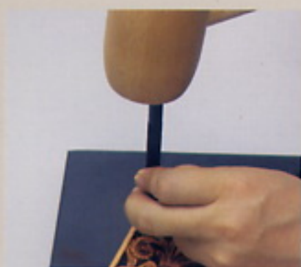
對準記號用菱形打洞器把洞打出來。基本作法在於要一直線地打洞。
