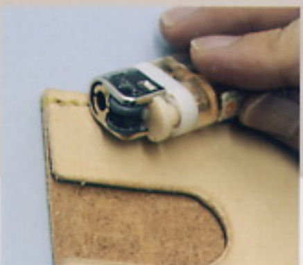
用打火機把剪斷的線頭加熱燒熔，以按壓的方式把線頭固定住。
