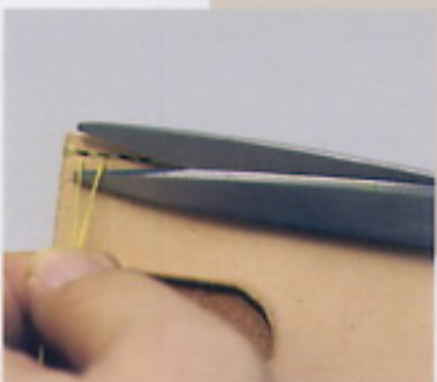
最後再把線倒回來縫個兩針之後，留下大約2mm的線條，把線剪斷。
