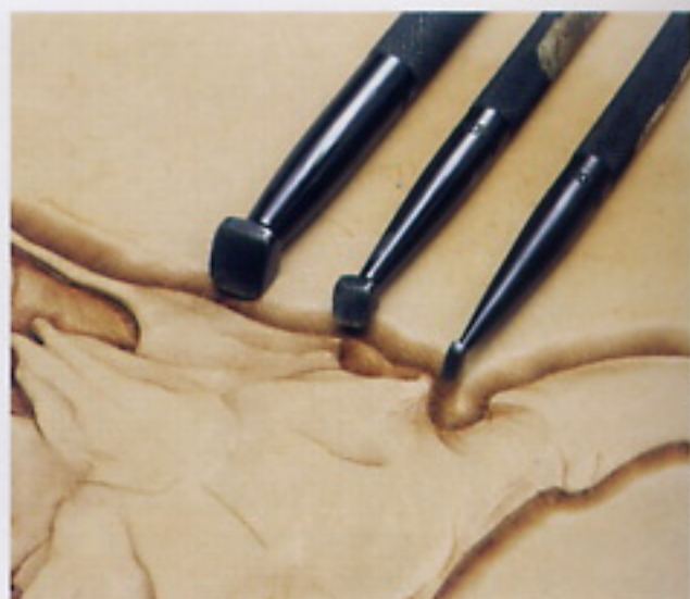
配合各個角落分別用大小不同的修邊工具，便可以敲打出更加正確的線條。
