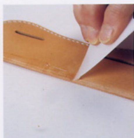
7 塗上接著劑。塗得太厚的話，空氣會跑進去，反而容易綻開，所以重點在於塗上薄薄的一層。使用上膠用刮板會比較順手。
