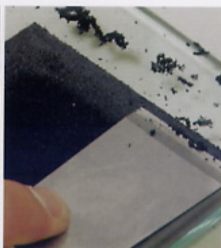
5 對各個零件進行斜切削薄的處理。①用鋒刀把魷魚皮周圍的鱗片斜斜地削掉。②把芯革削薄到適當的厚度之後，再對周圍進行斜切削薄。③把外框朝內側處理。
