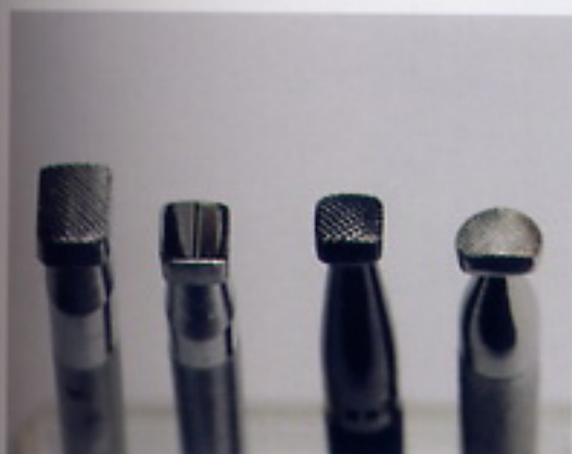
配合敲打的地方分別使用平坦度、網目數、大小及形狀各自不同的修邊工具。
