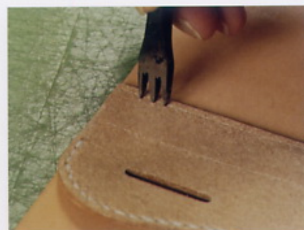
11 將菱形打洞器放在皮革上，把針腳的洞打出來。由於兩端各空了10mm，因此可以直接對準菱形打洞器的邊緣，讓洞的位置落在距離兩端各空10mm的地方。把位置抓出來之後，再把洞打出來。
