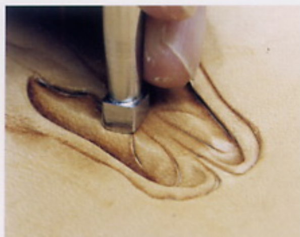
6 將修邊工具輕輕地敲打在表面上，讓表面變得均勻平整。
