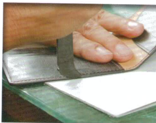
15 用裝飾邊緣器先內再外處理邊緣。壓到段差處時容易歪掉，要用手按著皮革仔細地動作。
