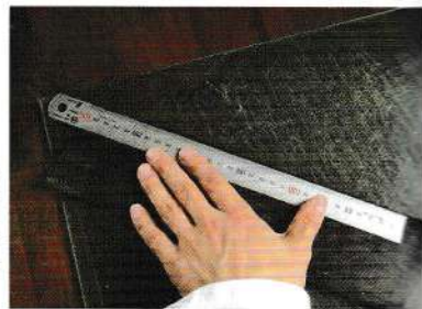
裁切很長的直線時，以壓住直尺的左手範圍為單位反覆重放直尺。若是一口氣裁切長直線，可能會使直尺歪掉。
