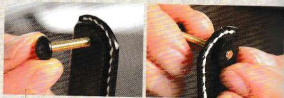
01 從外側鐵框表面插入鎖釘，背面穿通墊圈。
