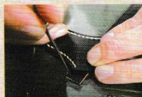
06 在細繩的鑰匙套本體側，刻上綁住本體用的切口記號。
