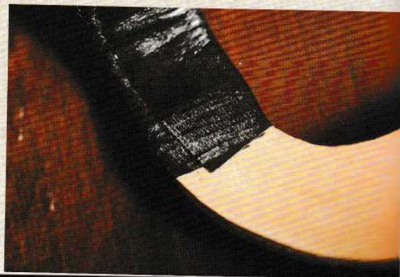
03 放上紙型，記上中心芯材黏合位置的記號後，磨粗記號範圍內的纏繞革皮面層。
