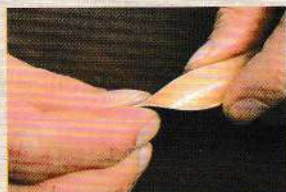
01 在床面塗上橡膠糊，縱向拗折。
