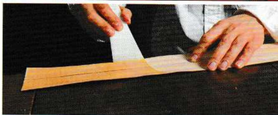
04 纏繞革肉面層畫上縱橫2條中心線，塗上橡膠糊。
