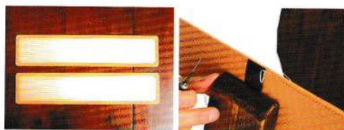
底板則是在芯材的一面貼上豬革，製作2塊底板後相互黏合。同時也須縫上拉片。
