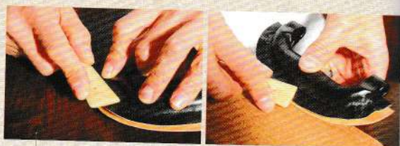
09 用壓黏片的角確實壓黏中心芯材與襯墊革的分界處，使皮革可以完全服貼芯材。
