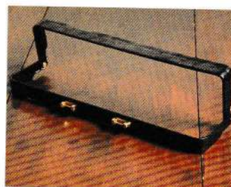
用軸孔連接兩個鐵框。
