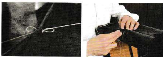
包側打角由上往下縫合，起針時用二重繞線提升強度。
