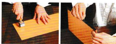
在芯材兩面貼上豬革，上緣纏繞皮革來完成隔板。
