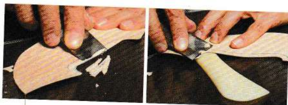
02 斜向削薄線的外側，將厚度削掉。
