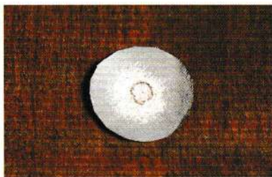
02 利用桌角，將圓外側削薄至零厚度。
