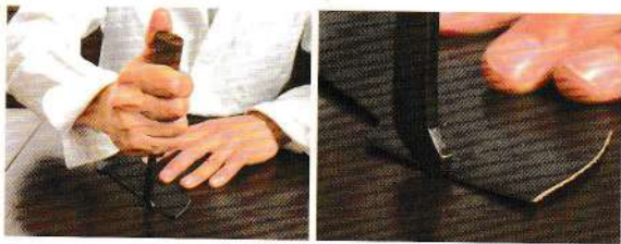
與裁皮刀同樣的握法，抵在邊緣上並滑動。
