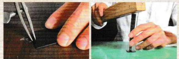
07 在直線部分畫上3mm寬的縫線記號，並打入線孔。
