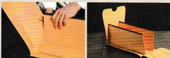
08 隔板的角確實貼合打角，並將一邊包側打角的側邊黏起來。
