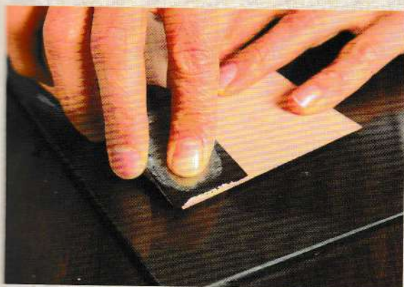
02 在包邊革的肉面層邊緣進行斜向削薄。
