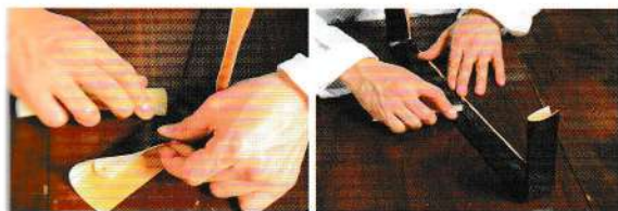
05 再折一次皮革，拉平皮革的同時也黏貼到內側。
