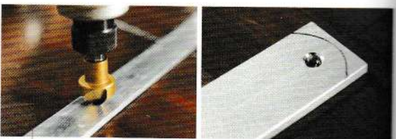
03 換成倒角刀，磨掉圓孔周圍的毛邊。
