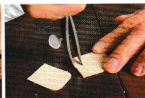
03 邊線器調整成記號寬度，並拉出線條。
