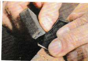
10 再以砂紙打磨平滑。
