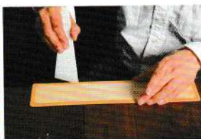
07 底板整個背面都塗上橡膠糊。
