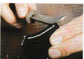
07 以加熱過的裝飾邊線器擦拭，使蜂蠟能確實染進皮革中。
