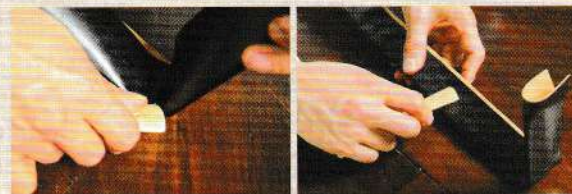
05 用壓黏片壓黏牢靠，使曲線內側不會產生皺摺。
