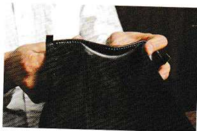
06 從包側打角調整縫合部的形狀。
