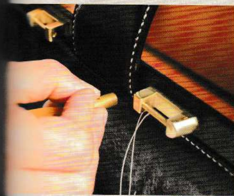
17 從包身的線孔貫穿 舌扣與鐵框，進行 縫合。
