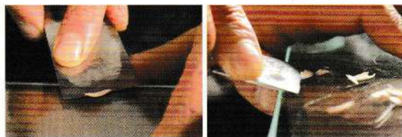
02 利用桌角，將圓外側削薄至零厚度。
