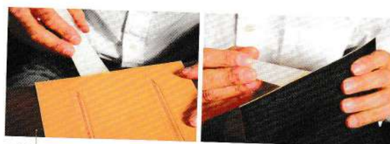
06 在各自的磨粗範圍內塗上橡膠糊。
