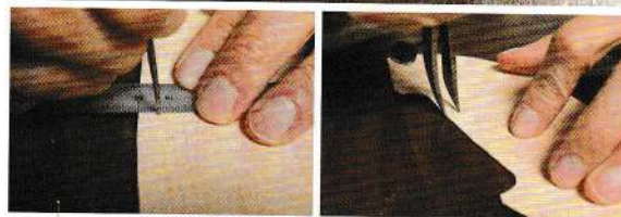
01 在全體纏繞革的內側曲線部分，拉出7mm寬的線。
