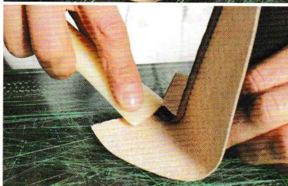
10 從縫線打開皮革，並用壓黏片摩擦，壓出折痕。
