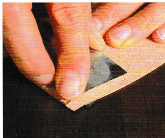
03 將線外側段差削薄。
