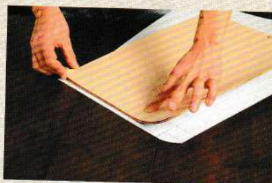
07 一邊彎曲一邊貼合，調整成Duffles手提包的包身形狀。
