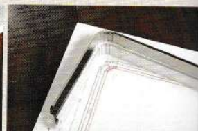
11 將兩配件都調整成與紙型的曲線相符合。
