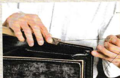
04 用裁皮刀裁落突出來的打角側邊。
