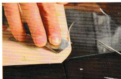
03 進一步斜向削薄2～3mm寬，將邊緣厚度削至零。
