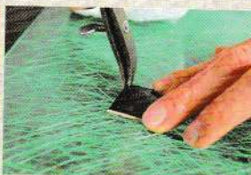
02 調整邊線器寬度並拉出縫線記號。
