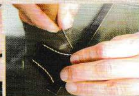
06 在細繩的鑰匙套本體側，刻上綁住本體用的切口記號。
