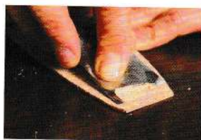
06 慢慢削薄記號前端，調整厚度。
