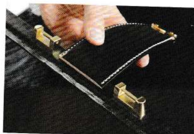
04 外側鐵框提把座之間的範圍不塗上橡膠糊。
