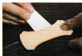
05 在線的外側仔細塗抹橡膠糊。
