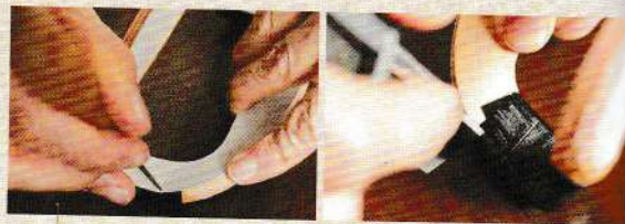
03 放上紙型，記上中心芯材黏合位置的記號後，磨粗記號範圍內的纏繞革皮面層。
