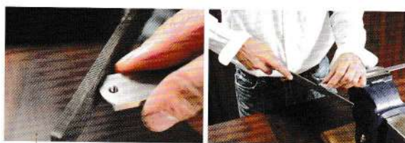
09 用銼刀磨削切口，把外側磨到與記號線相同。
