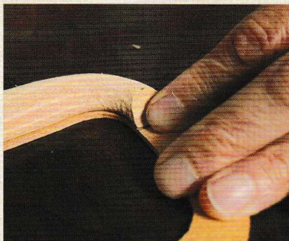
02 在襯墊革與本型革上塗抹橡膠糊。
