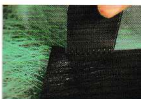
13 空出距離縫線記號端點1個線孔的距離，才開始打孔。
