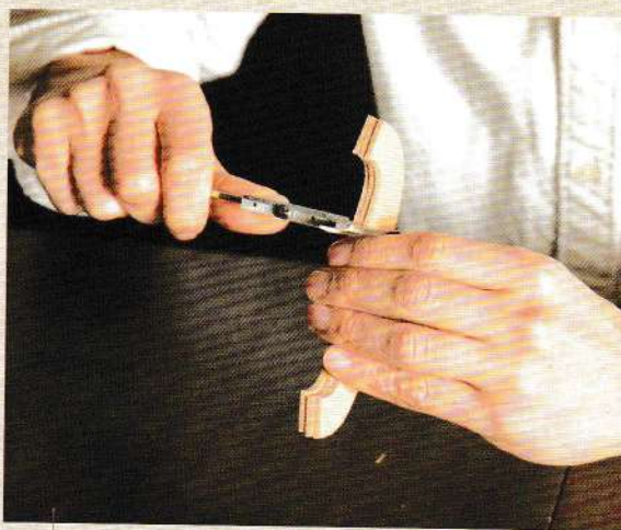
04 用卡尺測量襯墊革，準備厚約9mm的枚數。
