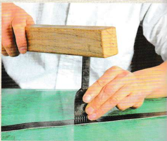
03 在兩端的記號之內打入線孔。
