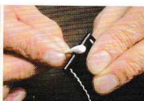
03 磨整孔洞內側的側邊。
