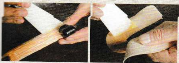
02 在提把及全體纏繞革上塗抹橡膠糊。
