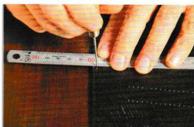
12 在包側打角的缺口間，拉出距離拗折處4mm的縫線記號。
