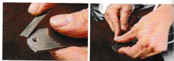
10 再用細目的銼刀削掉毛邊。
