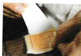
07 在纏繞革的肉面層塗上橡膠糊。
