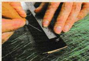
02 在距離軸孔內側25mm的位置做上記號。
