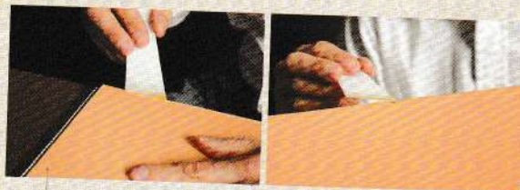
04 在隔板的磨粗部分及側邊塗上橡膠糊。
