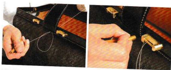
以平縫法縫合皮革時也同時以菱形錐鑿孔。如此一來針線容易穿過線孔，也能減少因摩擦所導致的縫線損傷。
