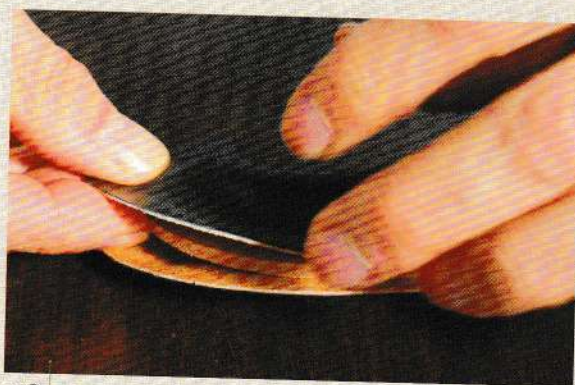
08 以夾入中心芯材的型態，閉合纏繞革的邊緣。
