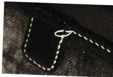
配件的端點等處，要越過段差的時候，用其中一邊的線進行二重繞線來補強。
