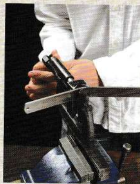
04 用手動彎板鉗彎折金屬片。
