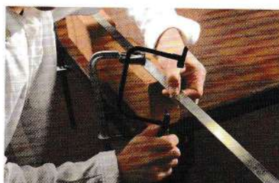
07 用線鋸裁斷兩端曲線。
