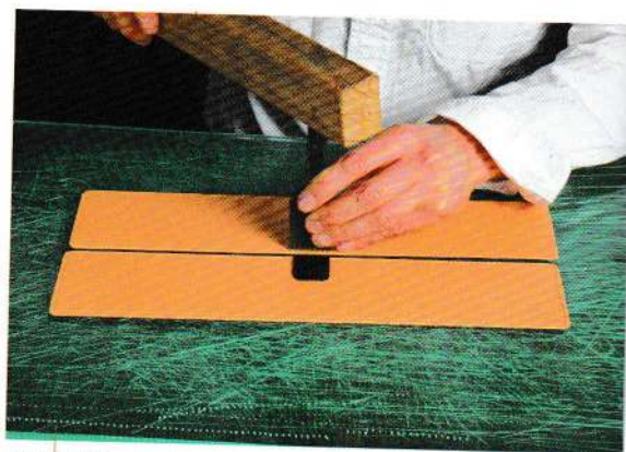
05 將另一個底板放在一起，摹寫線孔的位置後，直接打入線孔。
