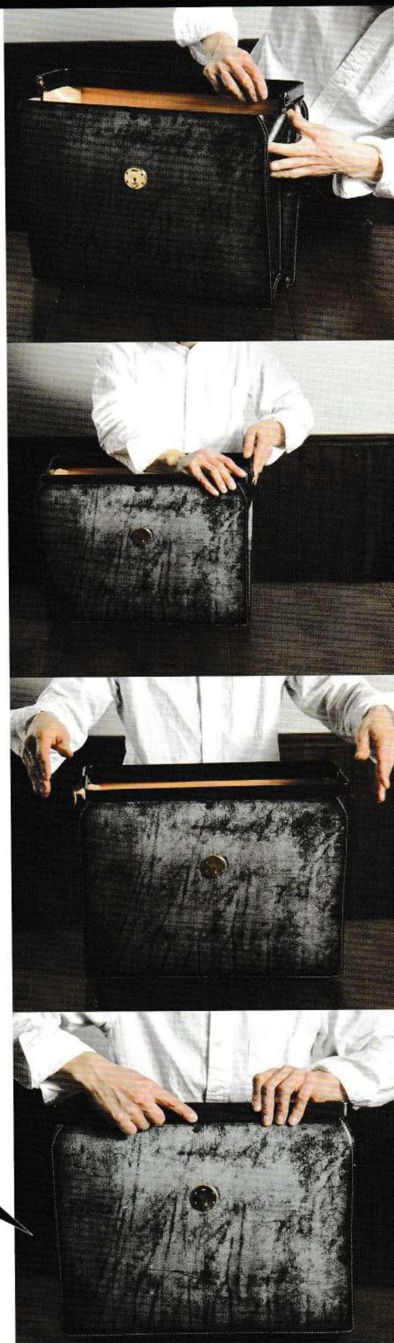
對齊包身與鐵框的中央，以及鐵框縫份的端點與包側打角的角。
