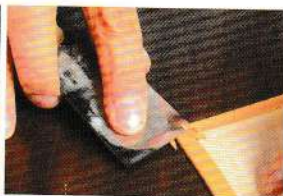
06 再用裁皮刀削掉多出來的部分。
