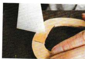
06 在線的內側塗上一圈橡膠糊。
