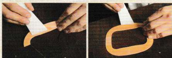
02 在襯墊革與本型革上塗抹橡膠糊。
