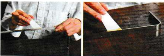
01 在外側鐵框表面、前方側面塗上橡膠糊。
