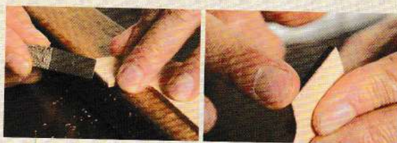
01 以砂紙打磨中心芯材的兩端側邊。
