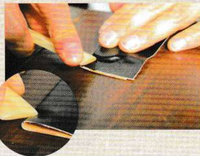
06 從表面沿著鐵框形狀拉伸皮革，壓黏在內側面。
