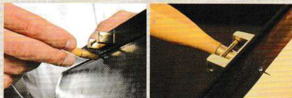
01 從包身線孔用菱形錐鑿穿鐵框縫份。
