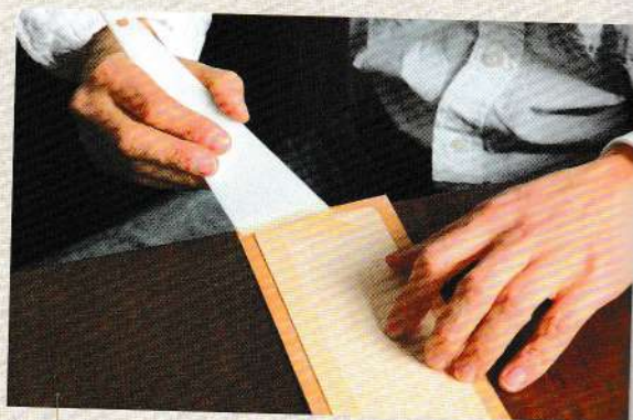
09 在芯材邊緣10mm寬的範圍塗上橡膠糊。
