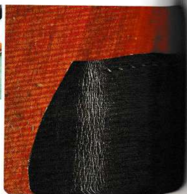
01 在上緣的記號間拉出3mm寬的縫線記號。
