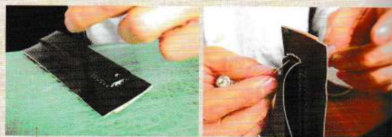
04 在縫合範圍打入線孔，從尖端向內側縫合。
