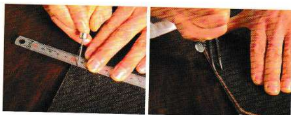
直尺置於皮革上，在想畫線的位置做記號。用圓錐稍微壓出凹陷即可。之後將邊線器調整到與記號同寬，即可畫出原先預想的線條。
