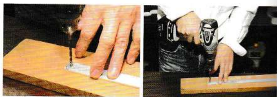
01 垂直拿著電鑽，抵在中心衝打出的凹槽上。
