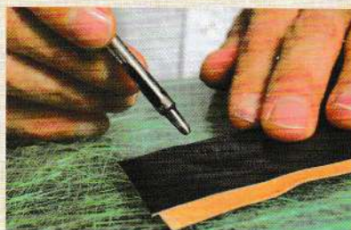
01 用 \phi 2\text{mm} 圓斬打穿軸孔。
