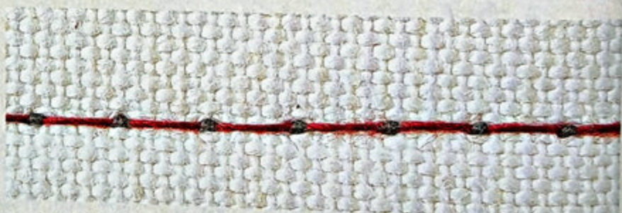
紅色上線的張力過強時從正面看的樣子。下線被拉上來，上線也變成完全的直線。
