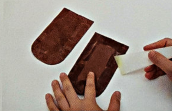
10 2片釦片的肉面層塗上橡膠糊。不過中央不黏貼，所以在距離邊緣2cm左右的範圍內塗橡膠糊即可。
