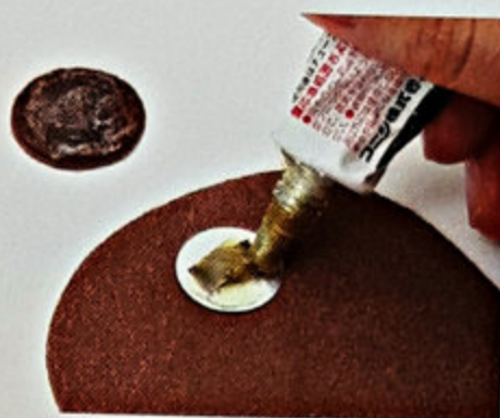
08 Point! 從碎皮料中，裁出能蓋住磁釦固定片的圓形補丁，並在其肉面層以及固定片塗上合成橡膠系的白膠。
