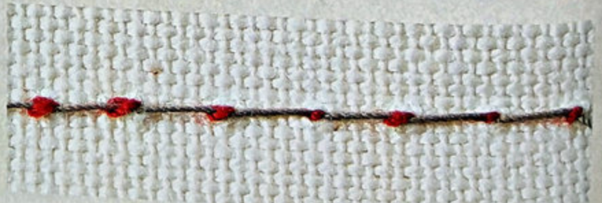
這邊則是相反，上線張力太弱時從背面看的情形。可以看見上線被拉出背面的情況。
