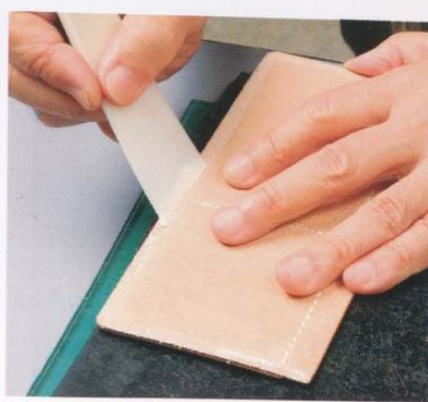
2 在袋身皮革、零錢袋與名片夾層等需要黏合的部位，薄薄地塗上一層寬約5mm的接著劑。
