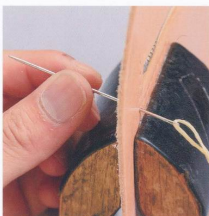
10 在本作品中使用的縫線是尼龍線。由角落開始縫起，會讓縫線收尾的位置比較不醒目，可以讓製作的手工感覺更有質感。
