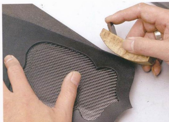
34 等到快乾膠乾燥後，開始打磨袋身四周的邊緣。裡層與表層的邊緣都要打磨。
