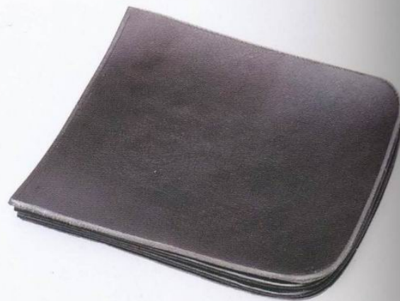
47 圖中為打磨完畢的表層袋身與邊皮。如果皮革上殘留著接著劑，會使得皮革無法染色，需多留意。
