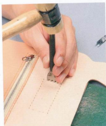
16 在之前拉出的長方形四周，以菱斬鑿孔。鑿孔的時候需注意，不要讓需要縫合的皮革滑開。
