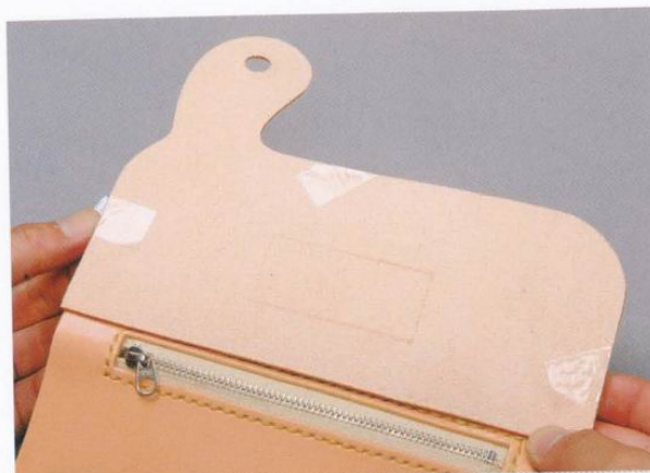
15 將口袋1與口袋2的邊角對齊之後，以透明膠帶固定。
