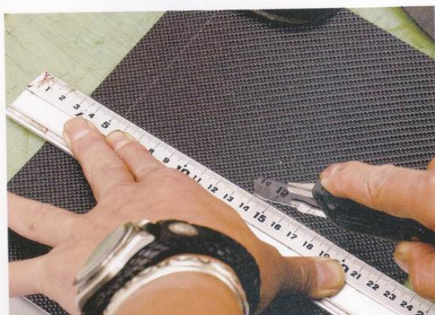
9 此處所選用的碳纖維片，可以用美工刀切割。將需要的大小切下。
