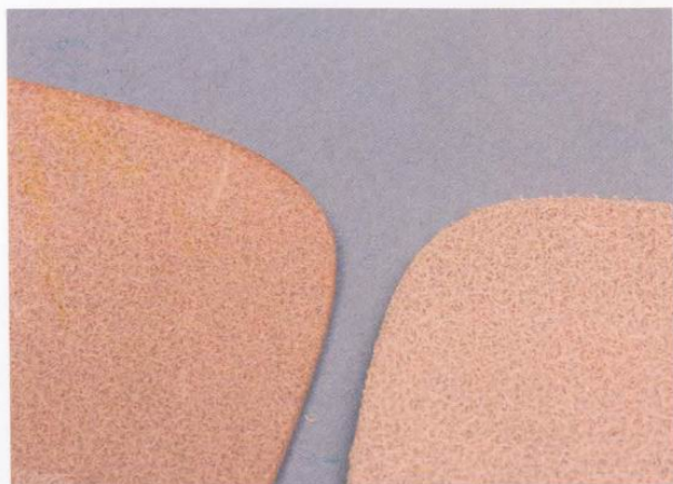
6 左邊是有使用海藻膠研磨過的皮革，右邊是沒有研磨過的。左邊的明顯較有光澤。
