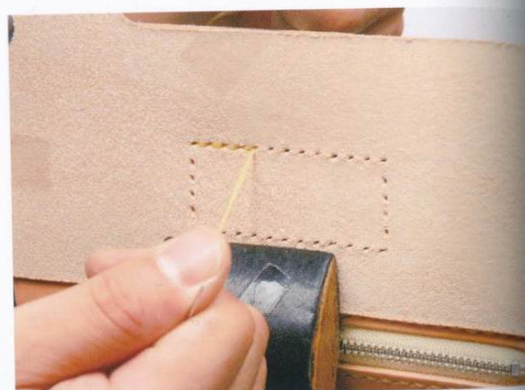
17 以菱斬鑿出縫線孔之後，從邊角開始縫製。
