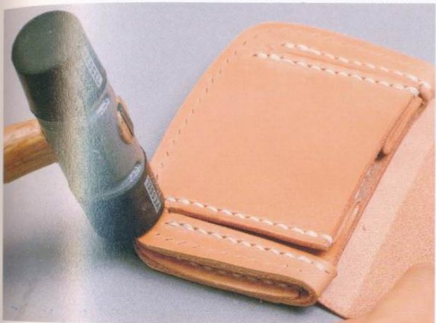
50 以槌子一邊輕敲一邊按壓，使皮革能緊密黏合。
