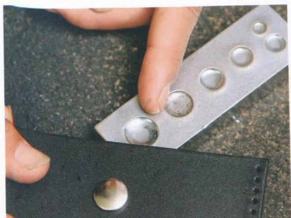
21 由於牛仔釦有很多尺寸，在裝上之前，可以先將牛仔釦的頭部與尺寸板對照一下。
