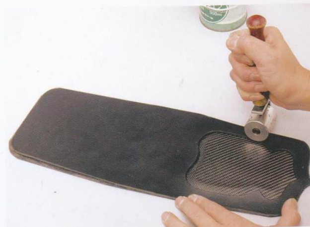
30 黏合完成後，以滾輪來回滾壓，使其緊密黏合。
