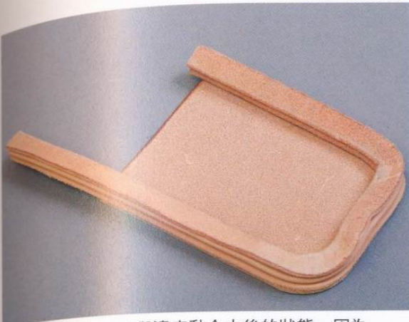
18 圖為將袋身2與邊皮黏合之後的狀態。因為使用的是快乾膠，所以很快又可以繼續進行下一個步驟。
