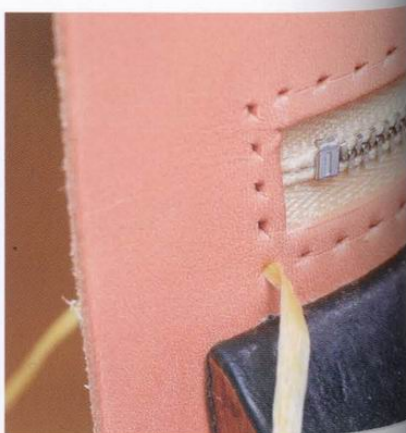
10 在本作品中使用的縫線是尼龍線。由角落開始縫起，會讓縫線收尾的位置比較不醒目，可以讓製作的手工感覺更有質感。
