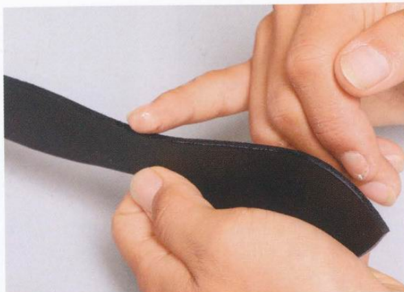
7 塗上染劑後，在上面再塗一層CMC。小心不要弄髒皮革表面。
