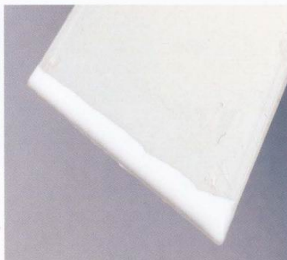
3 以上膠板挖取接著劑（白膠）。由於接著劑只要塗在需要黏合的那一面，所以上膠片也只要以單面沾取白膠即可。
