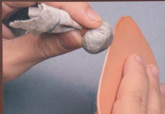
接著再上一次海藻膠。側邊經過2次的打磨之後，會大大提昇作品的質感。
