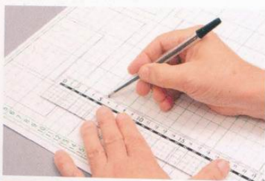
1 在方格紙上畫出各部位皮革的形狀與鑿孔的位置。
