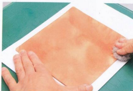
2 以畫圓的方式，將牛腳油均勻塗上。
