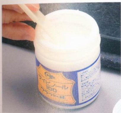
3 以上膠板挖取接著劑（白膠）。由於接著劑只要塗在需要黏合的那一面，所以上膠片也只要以單面沾取白膠即可。
