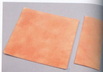
3 將所有裁切好的皮革都上好油之後，放置一天，可以讓牛腳油與皮革融合得更好。
