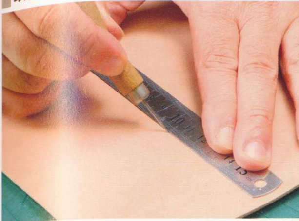
1 以圓錐與金屬製的曲尺，描出零錢袋開口的大小。
