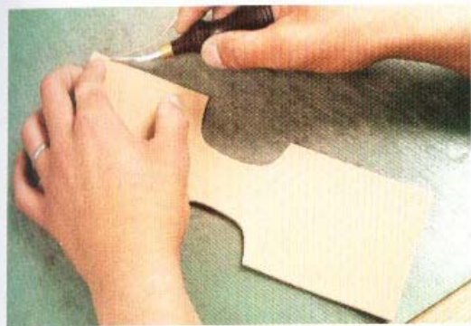
1 使用削邊器將四周的毛邊削下，皮革正面與背面的毛邊都必須削下。
