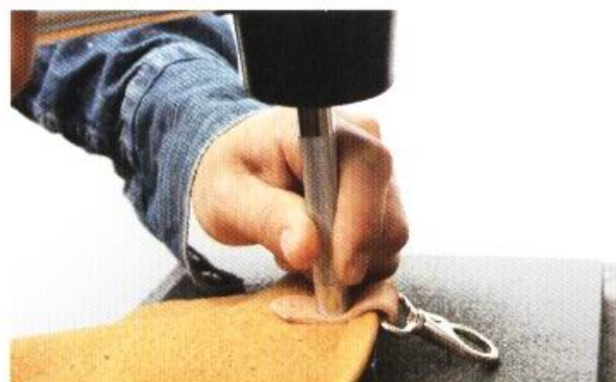
2 在袋身下墊著環狀萬用台，以固定鉗工具敲打固定鉗。
