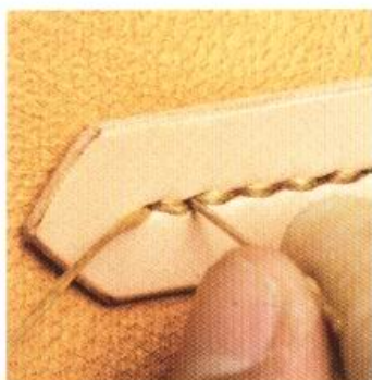
5 縫製到尾端時，向後重複縫製兩個孔，將兩條縫線都由皮革背面拉出。
