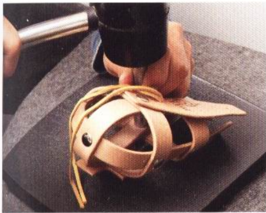
25 由於水壺套的袋身逐漸形成，使得固定釦工具越來越不容易使用，敲打時需多加留意。
