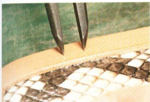
25 使用手開間距規，將菱斬應該鑿孔的位置做出記號。也可直接使用菱斬來做記號。
