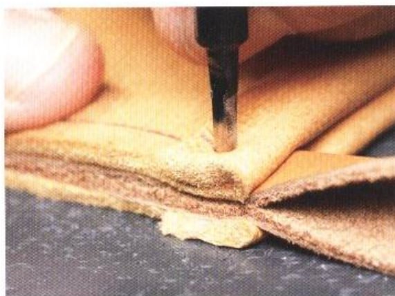
6 在袋身上方反折處，使用1孔的菱斬在正中間鑿孔。
