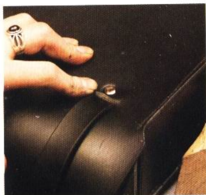
10 由於開圖帶與袋身只靠這一顆固定釦來固定，一定要確認固定釦是否有確實裝上。
