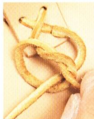
6 抓著穿至外側的鹿皮皮線其中一條，以另一條皮線繞行打結。為了讓袋身與皮帶環之間不會出現間隙，打結時需貼著皮帶環尾端。
