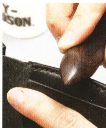
11 使用P118~119的方式，在邊緣塗上染劑或CMC等處理劑後，仔細打磨皮革邊緣。
