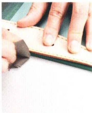
3 將CMC塗在側邊上，以棉布打磨。必須打磨至出現光澤感，且顏色變深為止。
