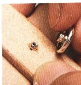
5 將橫向皮帶放在上方、縱向皮帶放在下方，再將固定釦由皮革背面插入。
