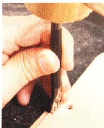
8 以手開間距規沿著邊緣拉線，再以菱斬鑿孔。轉彎處，需使用2孔的菱斬來鑿孔。
