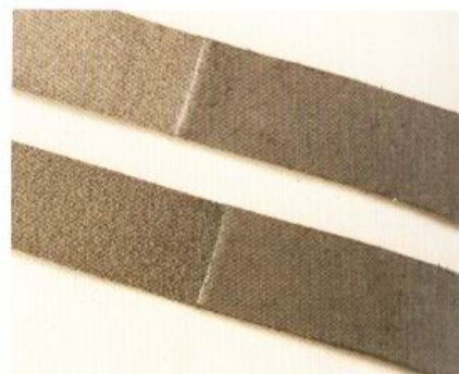
3 為了避免皮帶太過厚重，由皮帶的背面將皮帶削薄至原本二分之一的厚度。
