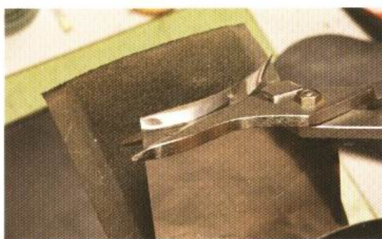
3 決定好邊皮的彎度之後，便可以接著調整長度。可使用斜口鉗來修剪鋁片的長度。
