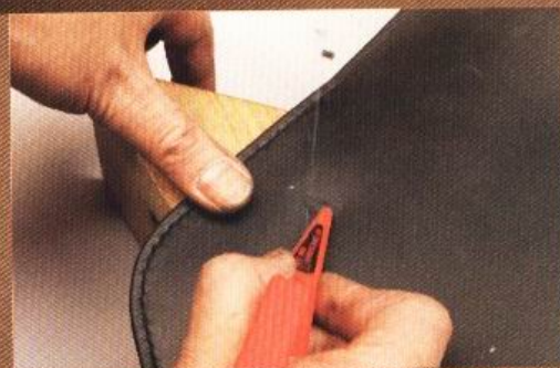
17 由於皮革上面太光滑無法上膠，可以使用研磨器將需要黏合的部位磨粗。
