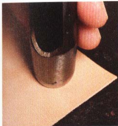
7 使用60號圖斬來切出銀釦的墊皮。 也可使用裁皮刀隨意切出一塊皮革來代替。
