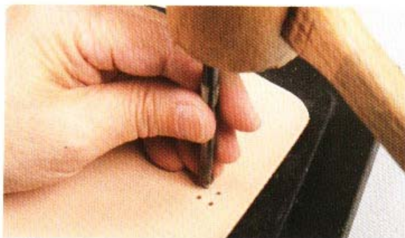
5 用來固定銀釦墊皮的孔，則應該以2號圓斬（0.6mm）來鑿孔。
