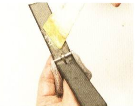
7 在皮帶的背面塗上接著劑，並將皮帶對折後黏合。當心接著劑不要塗到皮帶扣。
