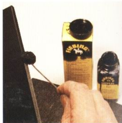
8 使用砂紙或磨砂棒打磨邊緣，再塗上染劑。
