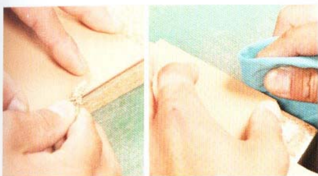
3 等背面處理劑乾後，使用絲瓜布與柔軟的棉布打磨。
