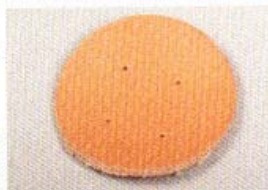
將紙型放在墊皮上， 將應該鑿孔的位置在 墊皮上做出記號。
