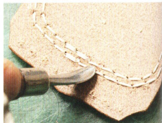
6 結束時與縫製內圈的處理過程一樣，由內側將縫線裁斷，再以打火機燒融後固定。
