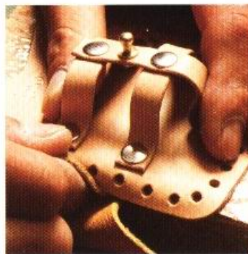
2 為了讓編織皮線的作業能更順利，可以先用手指將袋身A、B、C的邊緣折彎。
