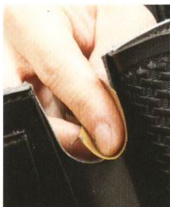
11 使用P118~119的方式，在邊緣塗上染劑或CMC等處理劑後，仔細打磨皮革邊緣。
