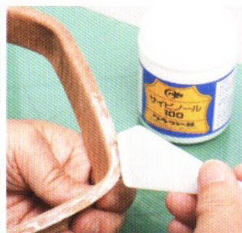
2 將白膠塗在袋身B磨粗的部位與邊皮彎曲的部位上。剛開始先塗半邊即可。
