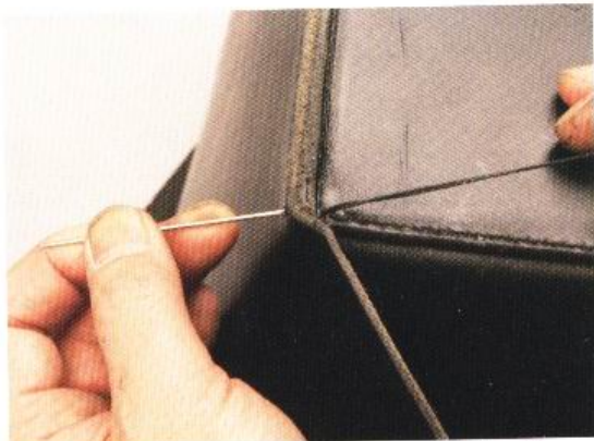
9 剛開始縫製的部份，必須先在袋蓋那一側進行2針繞縫。由於需要縫製的總距離相當長，不妨分成數次來縫製。
