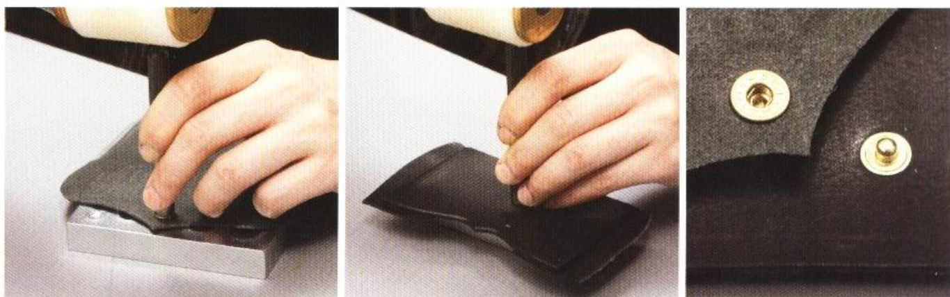
3 使用環狀萬用台與固定釦工具來裝置固定釦。如果一下子就大力敲打，固定釦會容易歪斜，應該輕一些、慢慢地敲打。裝置固定釦時，需注意公釦與母釦的正反位置。
