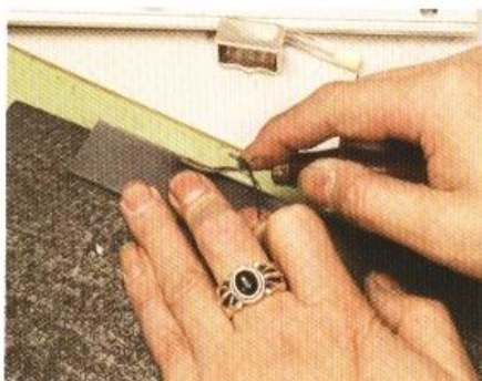
2 決定好皮帶的長度之後，將多餘的皮帶裁下，並在表面的邊緣上進行削邊。
