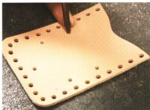
7 固定打火機套的孔，需使用8號圖斬（直徑2.4mm）來鑿孔。袋身B上用來穿過原子鉤的孔，則是以8號圖斬與5號圖斬（直徑1.5mm）鑿孔後，再將兩個孔中間以平鉗裁開。由5號圖斬所鑿出的孔，是為了避免穿過原子鉤的孔裂開才開鑿的。
