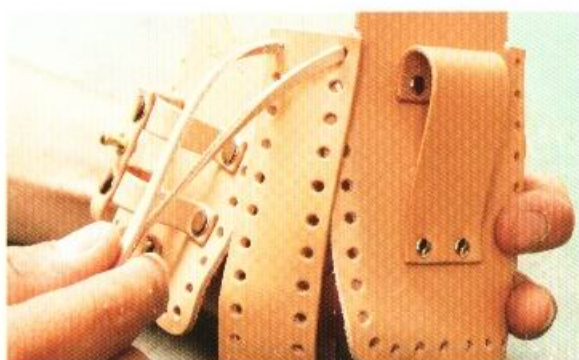
3 將袋身C放在袋身A、B的上方，再由內側將皮線穿出。接著將皮線調整至左、右等長。
