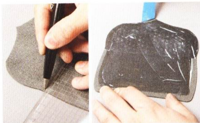
16 在零錢夾層B與零錢夾層A上縫合的位置做出記號，除了縫合的部位之外，其餘部位都塗上背面處理劑。
