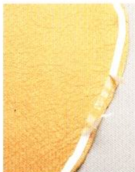
2 先將雙面膠中間的紙撕開，將袋身邊皮的中心與袋身A的中心黏合。黏合的時候，需沿著邊皮的線條曲線。
