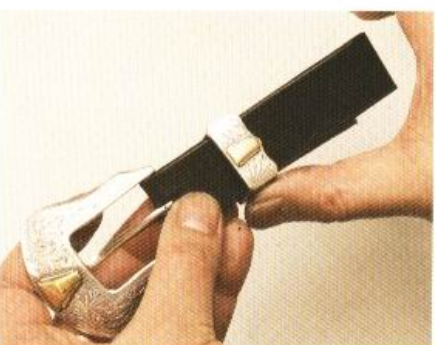
8 將固定環穿入兩片皮帶之間，確定位置正確之後將兩片皮帶黏合。
