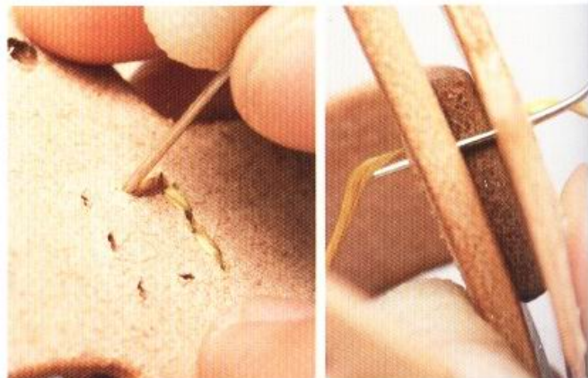
18 經由菱斬在中央所鑿出來的孔，可以一次縫合十字固定皮與縱向的兩片皮革。
