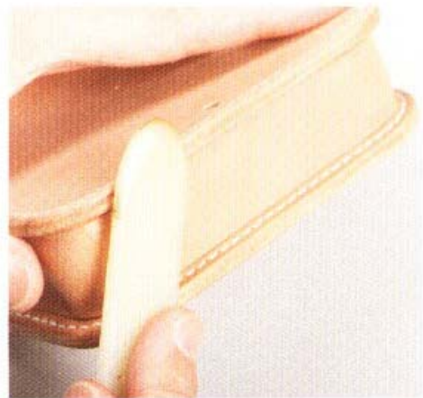
13 使用上膠片打磨毛邊。也可以使用木製磨緣器或三用磨緣器來打磨。
