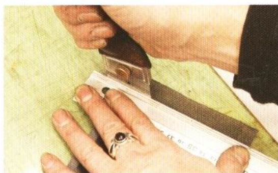
5 將邊皮的正面皮革與內裡皮革裁切整齊。當心別裁下過多的皮革。
