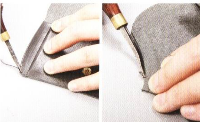
6 袋蓋的部份與步驟5做出的記號左下方，以及皮革的正面，使用2號削邊器將邊緣削下。至於皮革背面，則使用1號削邊器來削下皮革邊緣。
