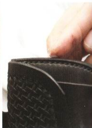
12 使用寬度不同的裝飾線拉溝器，沿著縫合的針腳拉線。接著再以砂紙、染劑、背面處理劑等來打磨邊緣。
