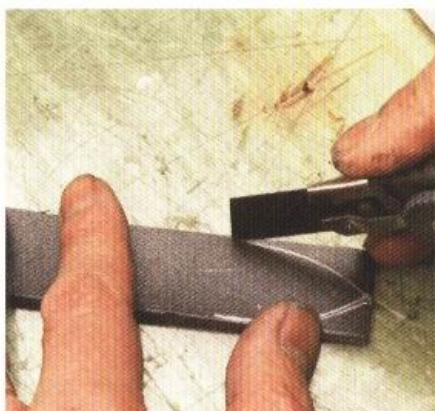
14 以美工刀沿著描線裁切皮革。最尾端的部份必須要能藏在薄片之中。
