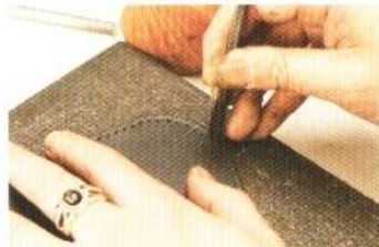
接著在皮革上鑿出縫線孔。在轉角的部位，使用2孔的菱斬將縫線孔鑿穿。鑿孔時必須讓縫線孔之間的距離維持等距。
