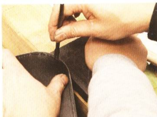
14 為了讓檯面不歪斜，可以請人幫忙將檯面壓著後再鑿孔。
