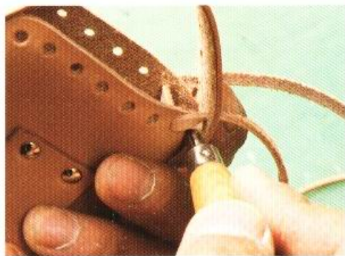
5 皮革重疊的部份如果沒有確實拉緊，便會出現空隙。可以一邊將皮革彎曲，一邊使用印花工具來幫忙慢慢地將皮線穿洞、拉緊。為了避免傷到皮革，最好避免使用圓錐等工具來幫忙穿皮線。
