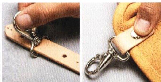
1 將彈簧鉤穿過固定皮，並裝上固定鉗。固定皮比較短的那一頭，必須固定在袋身內側。
