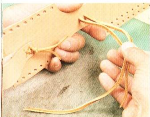
9 將用來環繞銀釦的鹿皮皮線（粗），穿過袋身下方的兩個孔。將皮線長長地由後方穿出後打結。
