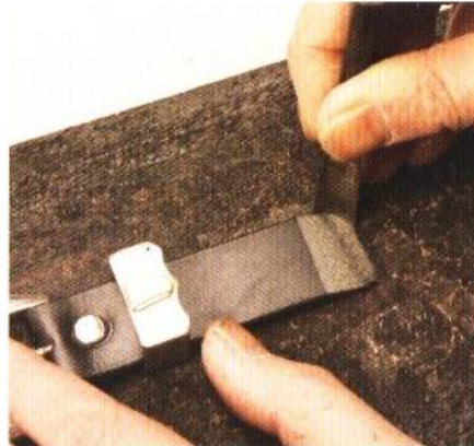
9 將皮帶的下端進行斜削，並把邊角修圓。
