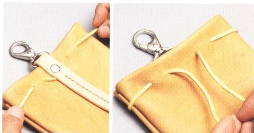
8 如圖中一般，將鹿皮皮線繞著袋身穿一圈，由袋身的正面（袋身B）拉出之後，再將左、右兩邊的皮線調整為等長。
