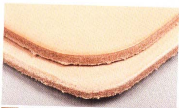
5 圖上為尚未削邊的皮革，下方則為已經完成削邊的皮革。其中的差異，一目了然。
