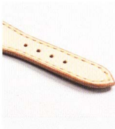
6 如圖一般，必須打磨到表面平滑、且出現光澤感為止。細心、仔細，是把這個步驟做好的不二法門喔。
