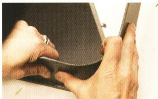
2 彎曲鋁片，將邊皮彎折出袋身的曲線。調整好形狀之後，便讓邊皮維持這個彎度。
