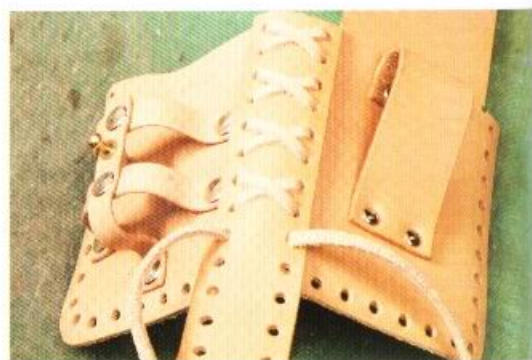
4 將皮線交叉編織。皮線從上到下交叉的方向最好能一致。
