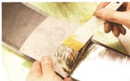
6 將袋舌與邊皮縫合的部位塗上接著劑，並與邊皮黏合。黏合完成後便可以開始縫製。
