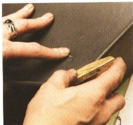
11 將邊皮與袋身確實黏合之後，將邊緣削下並打磨。
