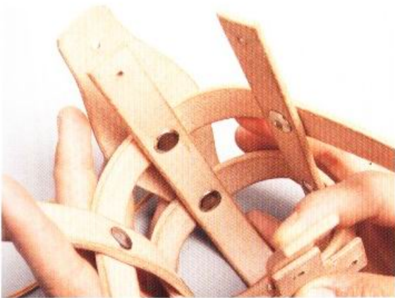
23 接著固定橫向皮帶（中）與縱向皮帶B。與處理其他固定釦的方式相同，將固定釦裝上後必須將釦面敲平。
