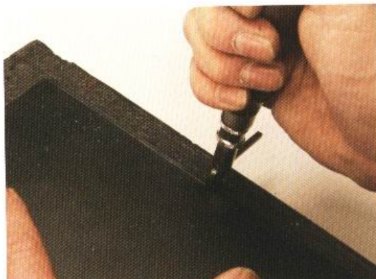
12 使用拉溝器，在離邊緣3mm處拉出縫線溝槽。不需將皮革削下，只要留下痕跡即可。
