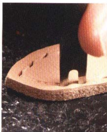
11 由於尾端的一側已經鑿過孔，因此，必須以尾端的孔為基準，確認出適當的鑿孔位置。
