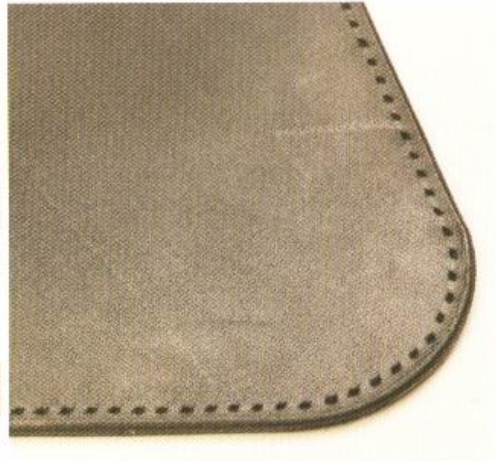
接著在皮革上鑿出縫線孔。在轉角的部位，使用2孔的菱斬將縫線孔鑿穿。鑿孔時必須讓縫線孔之間的距離維持等距。
