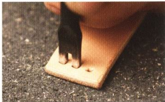
8 在上、下兩條橫向皮帶的兩端，以2孔的零斬鑿出3個孔。
