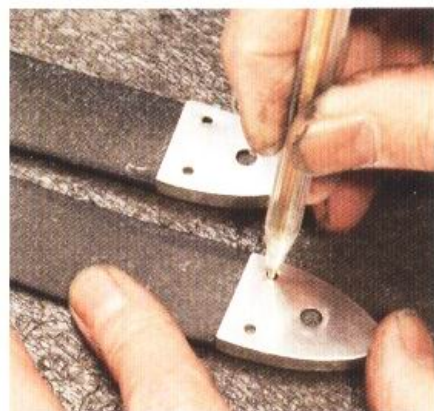
15 將裁切好的開闔帶尾端塞進薄片之中，並以銀筆將裝置螺絲的位置標出來。
