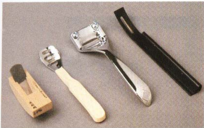
小型刨刀 德式削薄刀 美式削薄刀 美式安全削薄器 工具名稱依序由左到右，可用於削薄皮革。
