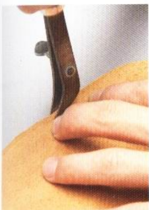
5 以邊緣器在離邊緣3mm處拉出縫線溝槽。由於在鹿皮上不容易看清楚拉出的溝槽，可以使用原子筆將溝槽描得清楚一點。
