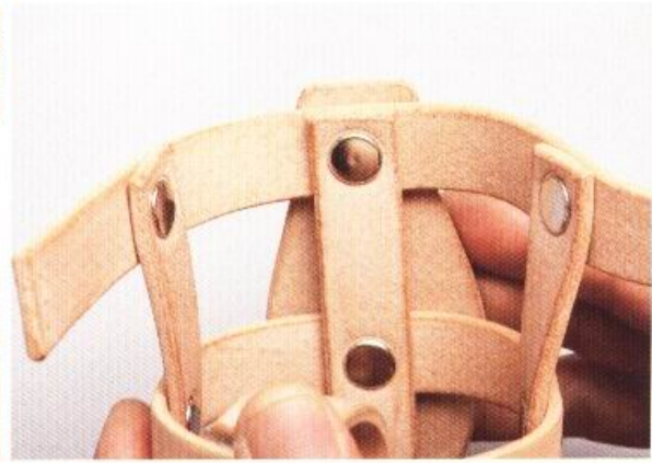
26 固定上方的皮革。固定圖樣皮革時須使用長根部的固定釦，並留意皮帶需以正確的方式重疊。
