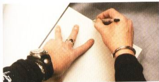
1 使用銀筆將紙型描在皮革上。確定皮革纖維的走向之後，再將需要的皮革裁下。
