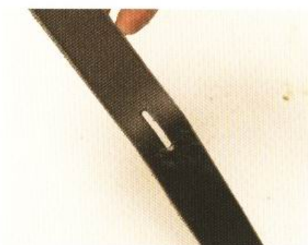
5 以皮帶斬鑿孔之後，便會出現如圖中一般的孔洞。鑿孔時須確定位置是否正確。
