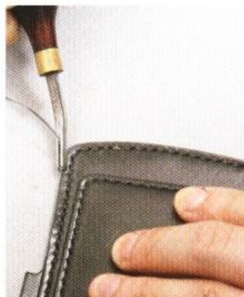
10 在P124中未處理的皮革正面，以3號削邊器來削下皮革邊緣。至於其餘部位的皮革正面或背面，則用2號削邊器處理。但是在曲線明顯的部位，無論是皮革的正、反面，則必須使用1號削邊器來進行削邊的工作。
