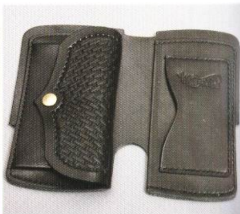
8 使用撕開縫線中的2條縫線，將零錢夾層與卡片夾層縫在袋身B上。縫製的方式與P123相同。
