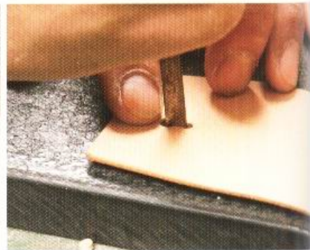
7 固定打火機套的孔，需使用8號圖斬（直徑2.4mm）來鑿孔。袋身B上用來穿過原子鉤的孔，則是以8號圖斬與5號圖斬（直徑1.5mm）鑿孔後，再將兩個孔中間以平鉗裁開。由5號圖斬所鑿出的孔，是為了避免穿過原子鉤的孔裂開才開鑿的。
