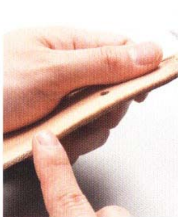
3 將CMC塗在側邊上，以棉布打磨。必須打磨至出現光澤感，且顏色變深為止。
