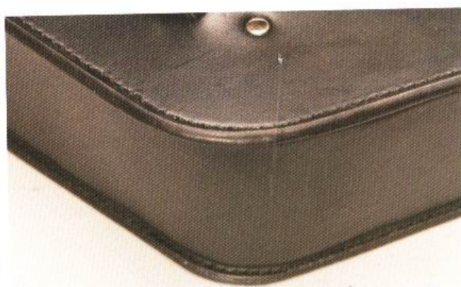
14 圖中為邊緣修飾完成後的狀態。如此一來，袋身的製作便大致完成。接下來，便剩下裝置皮帶等作業了。
