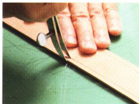
2 將邊線器一側的刀刃貼著邊皮的側邊，以另一側的刀刃拉溝。
