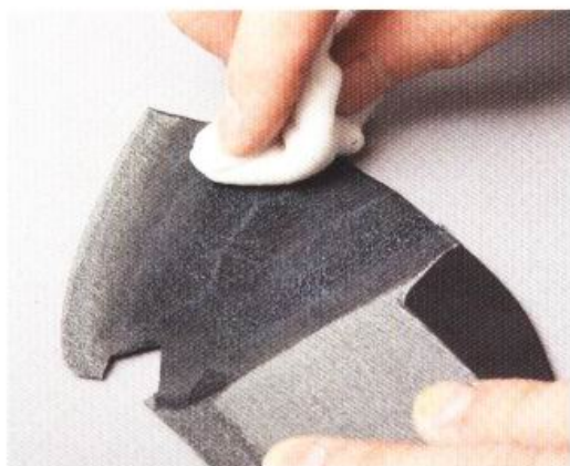
19 把零錢夾層A的兩側以水沾濕。使用棉布等工具讓皮革充分吸收水份，直到皮革的顏色改變為止。
