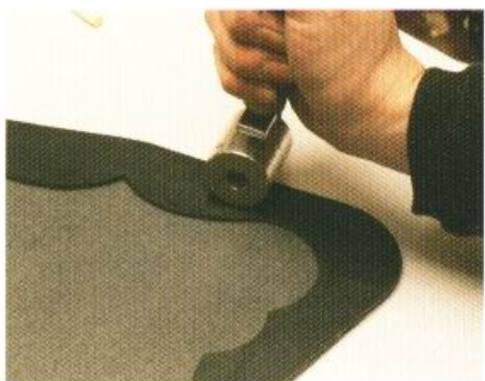
4 在袋緣皮上也塗上接著劑，然後將袋緣皮與袋蓋對齊後黏合，並以滾輪來回按壓。
