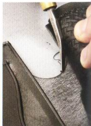
10 在P124中未處理的皮革正面，以3號削邊器來削下皮革邊緣。至於其餘部位的皮革正面或背面，則用2號削邊器處理。但是在曲線明顯的部位，無論是皮革的正、反面，則必須使用1號削邊器來進行削邊的工作。
