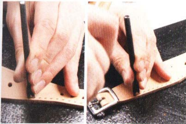
6 沿著縫線溝槽，以菱斬鑿出縫線孔。為了能沿著皮革的曲線準確鑿出縫線孔，需使用兩孔的菱斬。
