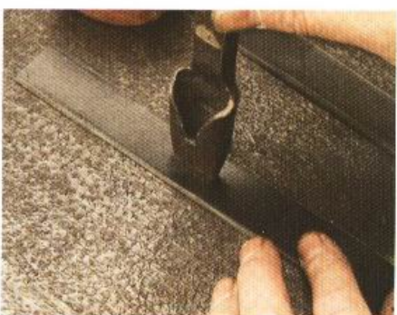
4 使用皮帶斬在皮帶的中央鑿孔。
