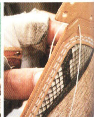
8 接著縫合袋蓋與袋身。將針線準備好之後，由最側邊的縫線孔將縫線穿過。縫製時若使用手縫固定夾，固定皮革時需避開縫線孔。
