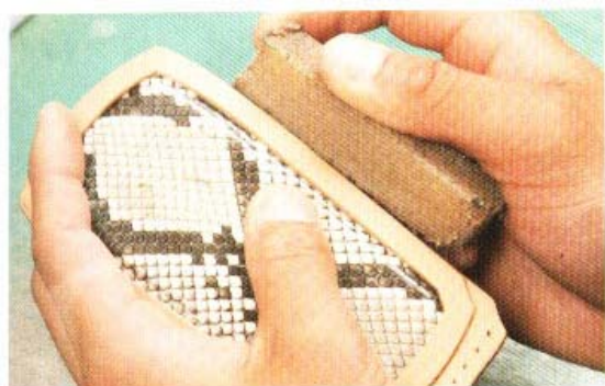
23 使用去膠片（也可使用凝固的橡皮黏膠塊）來摩擦皮革邊緣，將滲出的接著劑刮除掉。
