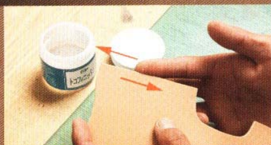
2 在邊緣塗上背面處理劑。以與皮革相反的方向，使用手指將背面處理劑塗上，便可以讓處理劑順利的附著在皮革上。
