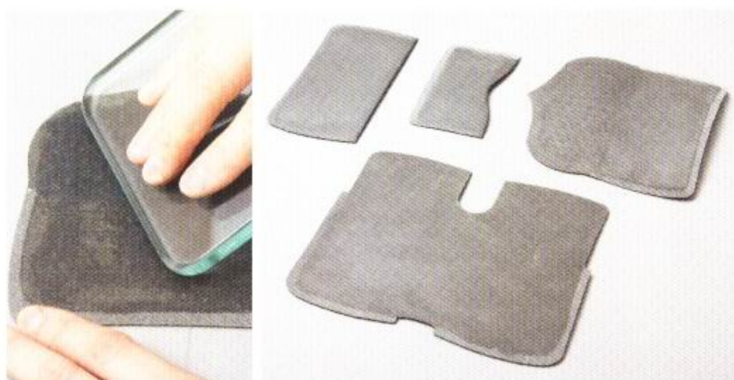
17 塗上背面處理劑之後，以玻璃板沿著皮革的纖維走向打磨。右邊的圖片中，除了縫合的位置之外，其餘的皮革背面都已經打磨完畢。
