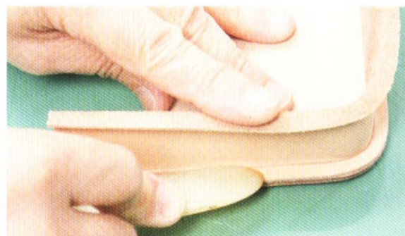
6 如果手邊沒有壓插器，也可以使用三用磨緣器的上膠板來壓緊黏合部位。黏合處的每個位置，都必須確實壓緊。
