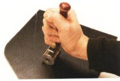
3 將兩片皮革黏合之後，以滾輪來回滾動、壓緊皮革。
