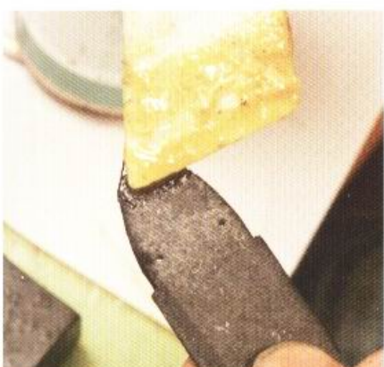
16 鑿出裝置螺絲的孔之後，先打磨修飾開闔帶尾端的背面。接著在必須塞進薄片的部位上塗上接著劑。
