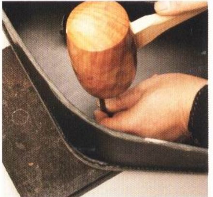
13 決定好裝置皮帶的位置之後，在皮帶與袋身上鑿出裝置固定釦的孔洞。
