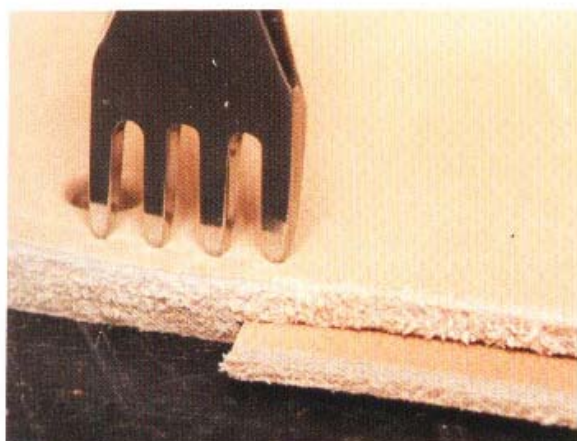
7 如同P42之示範，將菱斬對齊邊緣，空出一個洞的距離之後鑿孔。可在下方墊上另一片皮革以減少高低差，進而加強鑿孔時的穩定度。
