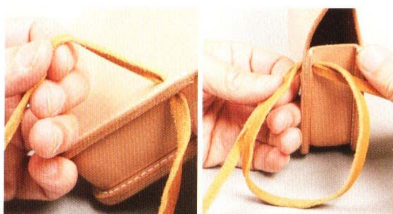
10 將當做背繩的鹿皮皮繩，來回兩次穿過袋身A與邊皮上的孔，以形成一個圈。這個圈圈之後便是背繩的固定圈。
