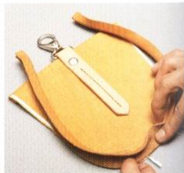
2 先將雙面膠中間的紙撕開，將袋身邊皮的中心與袋身A的中心黏合。黏合的時候，需沿著邊皮的線條曲線。
