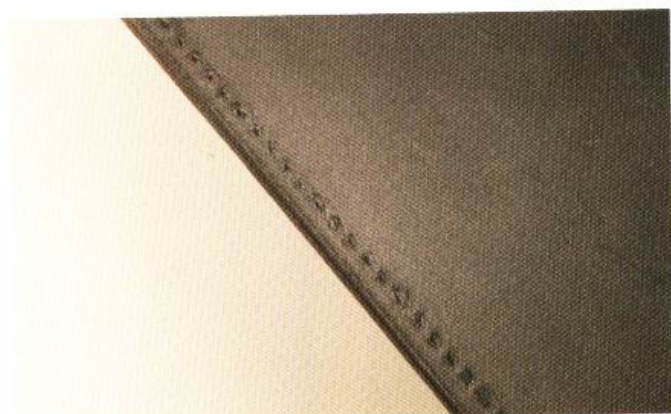
15 沿著縫線溝槽鑿好縫線孔之後，便會呈現如圖中一般的狀態。
