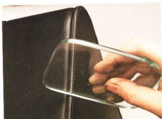
13 在絲瓜布上塗上背面處理劑後打磨邊緣，最後再以玻璃板來打磨。
