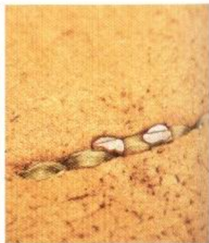
6 將縫線留下2~3mm的長度後裁斷，再以打火機將線尾燒融。接著使用打火機或手指將燒融的縫線壓平。
