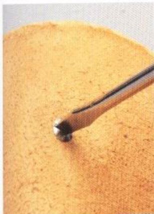
14 使用一字螺絲起，將螺絲確實轉緊。再把袋子重新翻回到表面，調整一下銀釦的方向。
