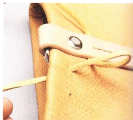
7 將皮線穿過以圓斬鑿出的孔。由於鹿皮柔軟，即使鑿的孔比較小，皮線也可以穿得過去。
