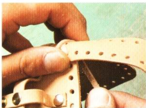
5 皮革重疊的部份如果沒有確實拉緊，便會出現空隙。可以一邊將皮革彎曲，一邊使用印花工具來幫忙慢慢地將皮線穿洞、拉緊。為了避免傷到皮革，最好避免使用圓錐等工具來幫忙穿皮線。
