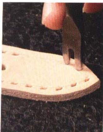
11 由於尾端的一側已經鑿過孔，因此，必須以尾端的孔為基準，確認出適當的鑿孔位置。
