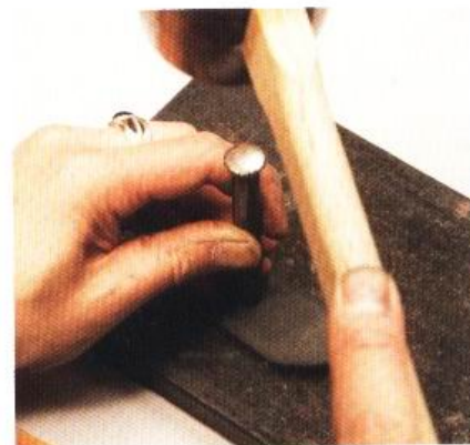
15 將固定皮背面朝上放在橡膠板上，敲打固定釦工具以固定銀釦。
