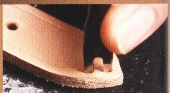
5 如果尖端的縫線孔鑿得不整齊，便會嚴重影響到作品的外觀。所以，使用菱斬鑿孔時，先從手環的尖端開始。
