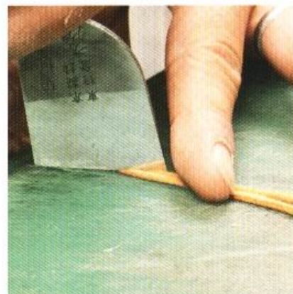
8 打結完成後，將皮線留下適當的長度後裁斷。裁切尾端時，斜著切斷會讓皮線看起來比較有型。
