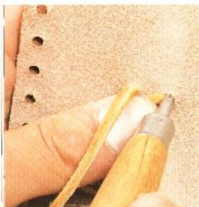
5 以壓插器等工具穿入最下方的孔，將孔洞擴大一些，再將鹿皮皮線（細）由皮革背面穿至外側。
