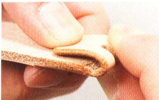
6 為了方便裝上帶扣，以孔洞的中心為準將皮革對折，使皮革產生微微的彎度。
