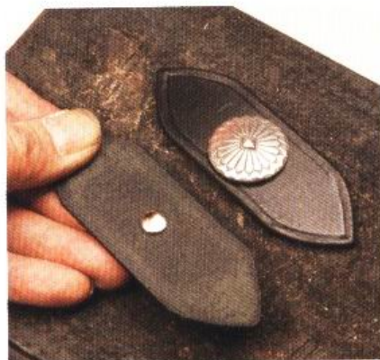
14 此使用的銀釦是以固定釦來固定的，所以必須在皮革背面裝上固定釦。
