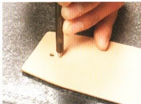
7 固定打火機套的孔，需使用8號圖斬（直徑2.4mm）來鑿孔。袋身B上用來穿過原子鉤的孔，則是以8號圖斬與5號圖斬（直徑1.5mm）鑿孔後，再將兩個孔中間以平鉗裁開。由5號圖斬所鑿出的孔，是為了避免穿過原子鉤的孔裂開才開鑿的。
