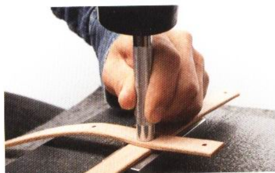
6 接著將皮革放在萬用環狀台上，以固定釦工具(大)敲打固定釦(母釦)。
