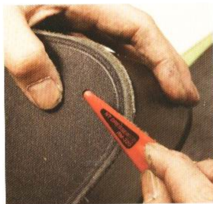
12 此處是以研磨器來打磨邊緣。無論是染色或打磨的工序，都應該在皮革縫合之後再進行。
