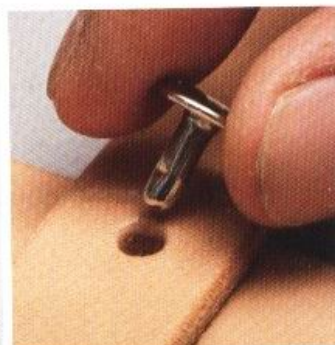
4 首先將縱向皮帶A放在橫向皮帶(中)的下方。將縱向皮帶A的第二個孔對齊橫向皮帶(中)正中央的孔之後，插入固定釦。
