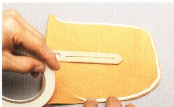
1 在袋身A的周圍貼上寬3mm的雙面膠。小心不要讓雙面膠的寬度超過皮革邊緣。
