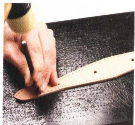
10 接著繼續沿著側邊的縫線溝槽鑿孔。鑿到尾端時，需再一次調整鑿孔的距離。
