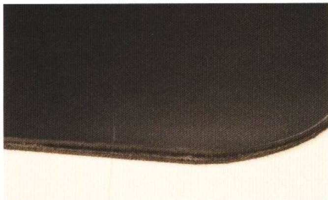
4 將皮革黏合之後，多少會像圖中一般，出現有些誤差的情形。
