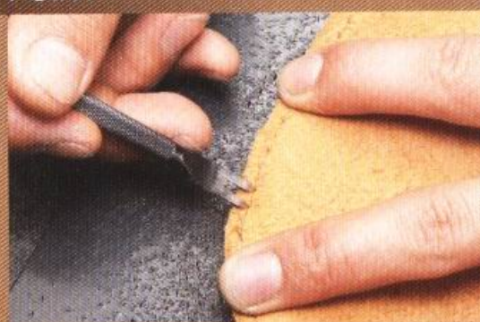
8 在尾端調整菱斬鑿孔的距離時，可以使用2孔的菱斬，慢慢地調整需要鑿孔的位置。
