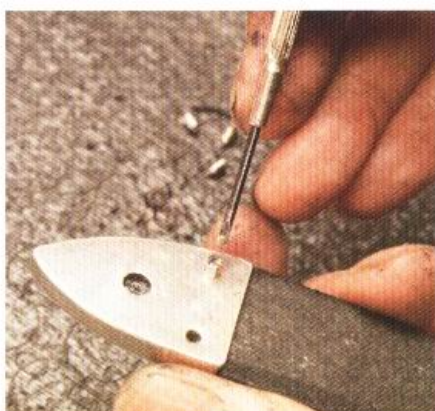
17 將開闔帶尾端塞進金屬薄片之中，並將螺絲拴上。
