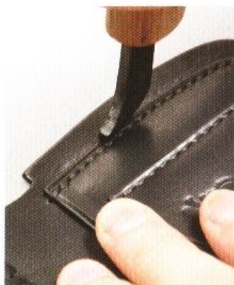
12 使用寬度不同的裝飾線拉溝器，沿著縫合的針腳拉線。接著再以砂紙、染劑、背面處理劑等來打磨邊緣。
