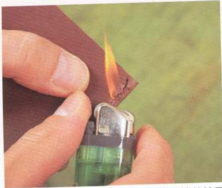
15 把線從肉面層拉出來，用打火機燒熔固定。
