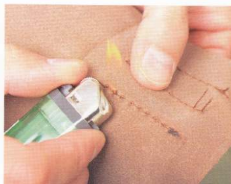
12 再用打火機燒熔固定。火太靠近的話會把皮革燒焦，所以請格外小心。
