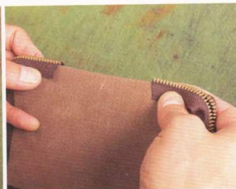
28 為了和主體的外側縫合，請先把拉鍊的邊緣固定住。把雙面膠貼在左圖的位置上，要配合弧度彎曲，將其貼合。
