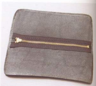
02 塗上接著劑的狀態。由於使用的是橡膠系的接著劑，所以塗好之後就會乾掉。
