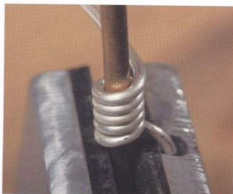
09 把經過退火處理之後的圓線夾在工作檯上，將其捲在直徑4mm的軸棒上。
