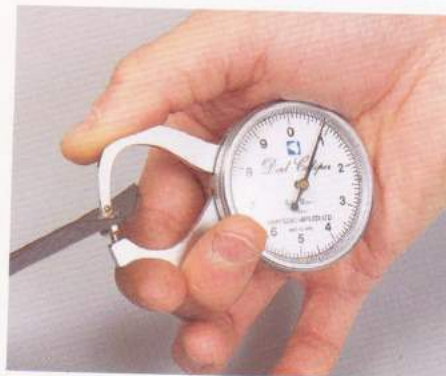
10 皮革的厚度可以用如上圖所示的厚度測量計來測量。
