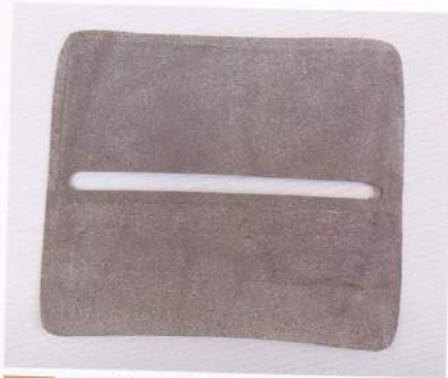
03 零錢袋使用的是1.6mm厚的皮革，請把四個邊全都削薄到1.4mm。
