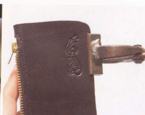
03 等到接著劑乾了之後，再仔細地對準邊緣貼合。由於橡膠系的接著劑沒有辦法重貼，所以請準確地對齊好位置再貼。貼好之後要壓緊密合。
