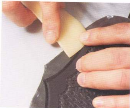
09 邊緣的部分用牛角刮刀壓緊。邊緣的部分如果沒有壓緊，切口就會變得不好看。
