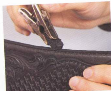
03 把邊緣修掉之後，用染料為切口染色。在染的時候要把染料確實地塗抹均勻。
