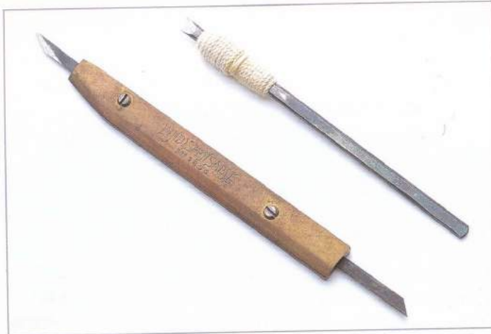
由於是以握筆的方式來使用，因此具有獨特的刀柄。下方的裁皮刀還可以替換刀刃。
