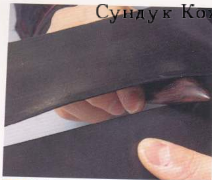
05 塗上CMC之後，再用木頭磨緣器推磨。請注意不要對切口垂直重壓，以免往旁邊綻開。
