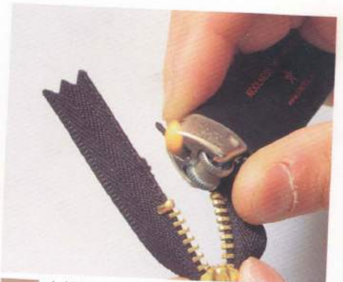
24 由於鍊齒被拔下來的部分布條會開始綻線，所以請用打火機燒熔，把線固定住。
