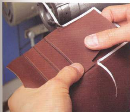
09 以同樣的方式把第3片貼合上去，將卡片口袋的下面縫合。
