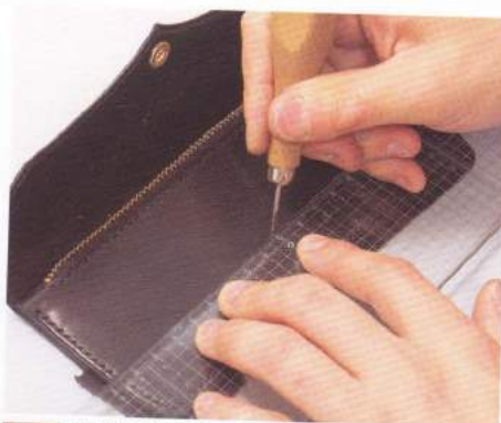
28 以用壓的印上痕跡的地方為基準，取其為中心點，決定出要裝上四合釦的正確位置。
