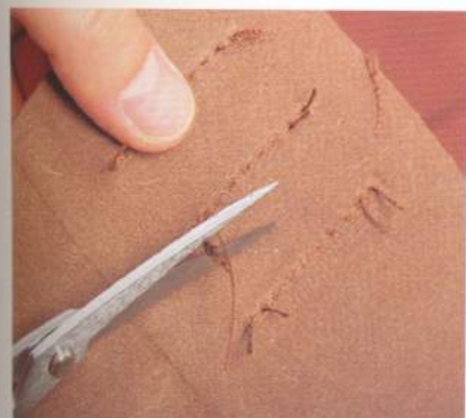
11 一次把所有的線頭處理掉。在肉面層的那一側把上線拉緊，用剪刀剪斷。
