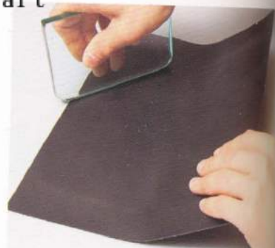
14 以玻璃板從背面撫平，壓緊密合。請要把皮雕和鍛壓加工的花紋壓扁了。
