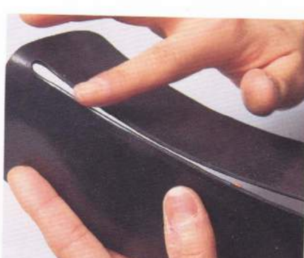
09 用手指頭把床面處理劑均勻地推開，塗抹在切口上。
