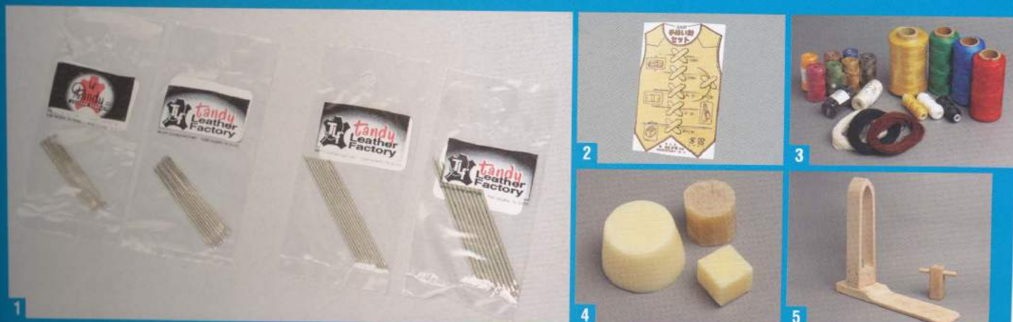
1 各種長度、粗細不一的手縫針。2 圓針和三角針、皮針等等的縫針組。3 縫線有亞麻線、上蠟麻線、手縫亞麻線等等，種類繁多。4 為了讓線使用起來更順手的線蠟。5 用來固定皮革的皮革夾板。
