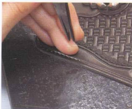
05 為了在作上記號的地方能夠很順利地打出針腳的洞，調整洞的位置也是一個方法。
