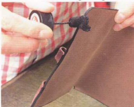
08 在與主體的外側縫合之前，請先處理四周的切口。事先塗上皮革塗料，再把多餘的皮革塗料用軟布擦掉。
