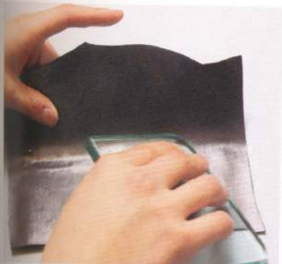
08 貼合之後再從背面用玻璃板按壓。請小心不要把鍛壓加工的花紋壓平了。
