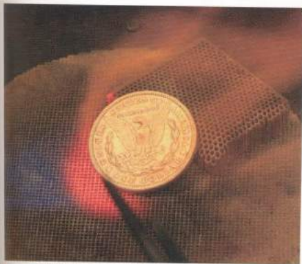
01 用本生燈把硬幣加熱。利用高溫來進行加工稱之為「退火處理」。
