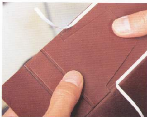
08 把第1片縫好之後，再稍微把背膠撕開一點點，把第2片也貼合上去，縫合。由於線頭可以留到最後再來統一處理，所以這個階段不需要理會它。
