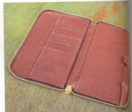
29 再把拉鍊的兩端固定，看起來就快要大功告成了。接著再進行最後的縫製。
