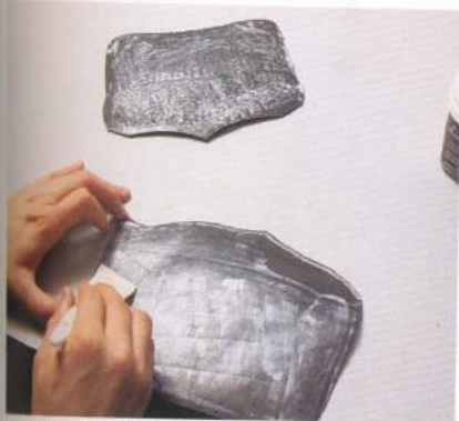
07 先把要塗上皮革專用白膠的地方打濕之後，再把皮革專用白膠塗在兩者的背面。
