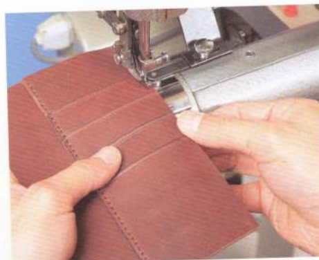
19 將卡片口袋的右邊和底座縫合。縫到快完的時候請把線拉出來到肉面層，再用打火機燒熔固定。
