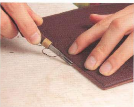
17 用修邊器把邊緣修掉。修邊器要同時落在主體的正反兩面上。
