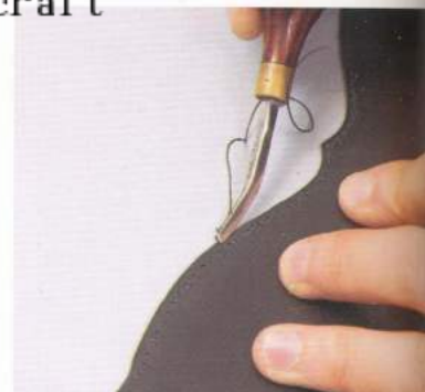
02 用銼刀把切口面磨平之後，再利用修邊器把邊緣修掉。
