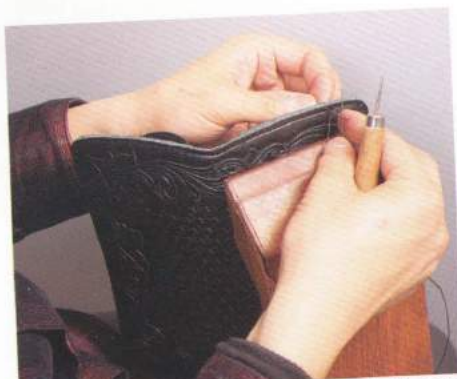
12 把針腳的洞全都打好之後，便進行縫合。使用2/5的上蠟麻線，請一面調整針腳，一面縫合。
