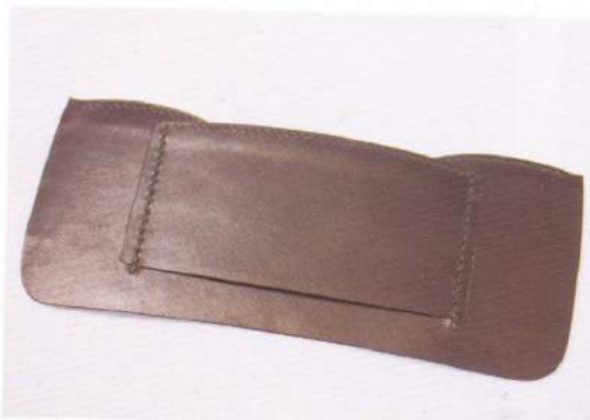
10 上圖是將卡片夾層A與B縫合的狀態。在這個階段所要縫合的只有這裡而已。
