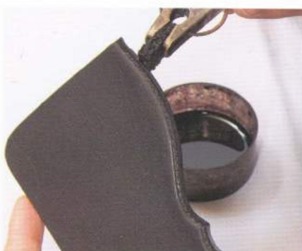
04 等到切口的形狀成形之後，用染料為切口染色。在染的時候要把染料塗抹均勻。
