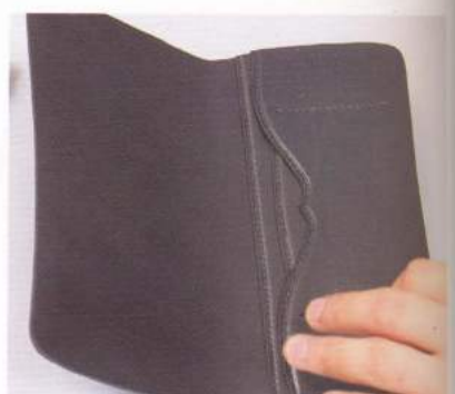
07 把針腳的洞打好之後，再把各個部分重疊起來，檢查要組合的位置。
