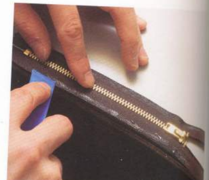
32 在布條的邊緣塗上暫時固定用的接著劑。這裡使用的是橡膠系的接著劑。
