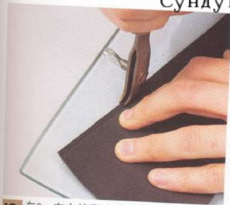
12 在2mm左右的寬度（視個人喜好）上，利用平行線器畫線。
