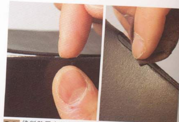
04 染料乾了之後再塗上CMC。溢出來的CMC要馬上用軟布擦掉。
