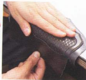
在把裡革貼在對折的地方時，請使用桌邊等工具，一面彎折，一面貼合。在壓出折痕的時候也可以利用這種作法，但要注意不要折過頭了。
