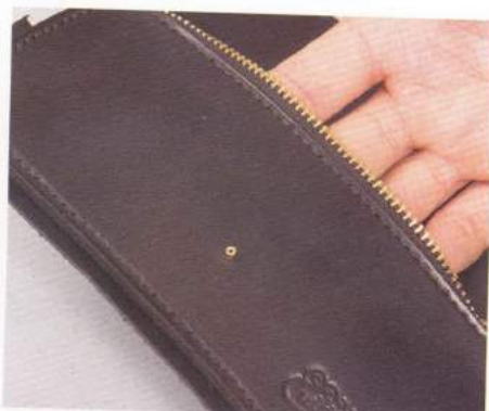
30 把四合釦的內側零件從零錢袋背面插進用專業圓斬打出來的洞裡。
