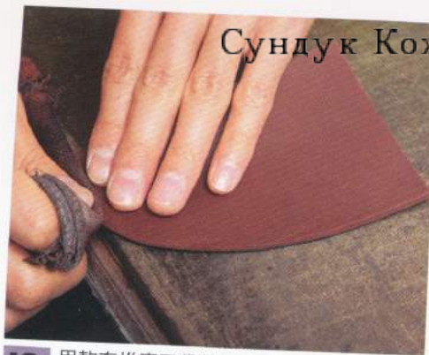
16 用軟布推磨口袋的曲線部分和拉鍊的把手。把皮革放在桌子邊緣會比較好磨。
