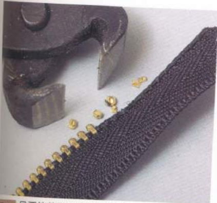
20 只要能夠順利地把鍊齒剪斷，就能夠如上圖所示地把被剪碎的鍊齒從布條上拔下來。
