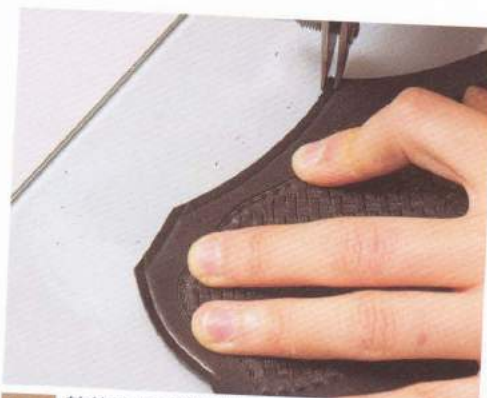
16 其他所有看得到表面的邊緣部分也全都進行同樣的加工。主體、卡片夾層、零錢袋的蓋子部分等等也都是要經過這道加工手續的部分。
