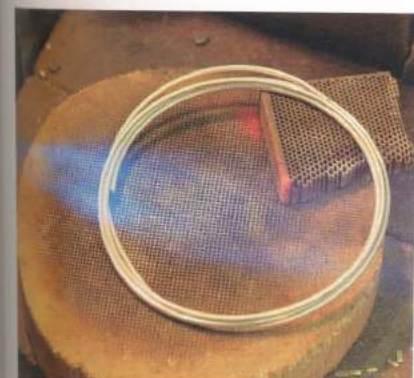
08 接著再對要裝在銀釦上的圓形扣環用的圓線進行退火處理。選用直徑2mm的銀製圓線。
