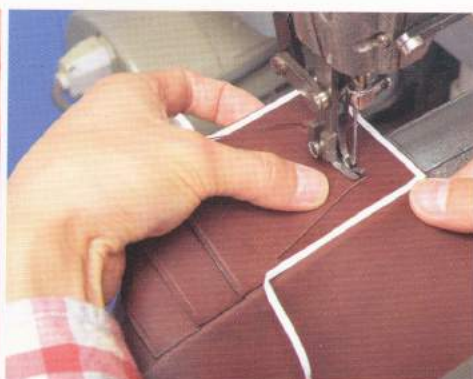
09 以同樣的方式把第3片貼合上去，將卡片口袋的下面縫合。
