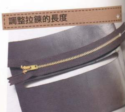
13 將拉鍊和零錢袋的開口對齊，藉此確認其長度。
