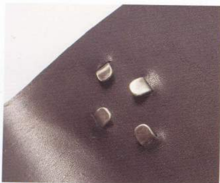
06 把穿到背面的爪子折彎。由於一口氣折彎可能會斷掉，所以請慢慢地折。
