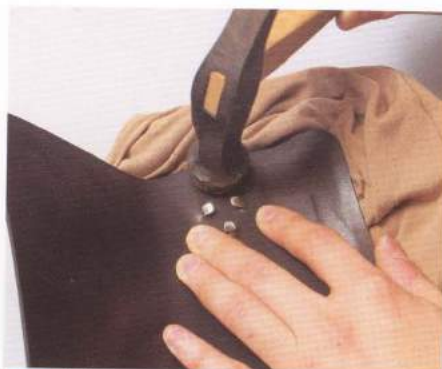
07 等到爪子被折到某個程度之後，再用榔頭敲打，使其完全折彎。請把軟布墊在底下保護。
