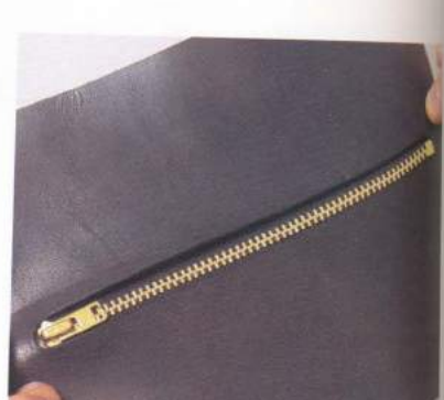
16 把拉鍊實際從內側放在零錢袋的開口上，決定出長度。
