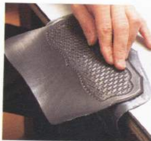
在把裡革貼在對折的地方時，請使用桌邊等工具，一面彎折，一面貼合。在壓出折痕的時候也可以利用這種作法，但要注意不要折過頭了。
