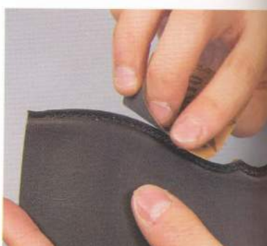
08 接著繼續重覆以上的步驟。再次用銼刀打磨已經塗上CMC的切口。
