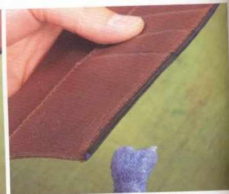
21 把皮革塗料擦拭一下，再塗上CMC，用軟布推磨。之後再塗上木工用的邊漆作最後的修飾。藉由上漆的這個動作可以帶出略顯濕潤的光澤，並增加耐用度。
