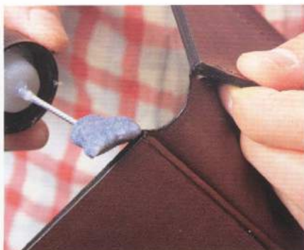
10 最後再塗上木工用的邊漆作最後的修飾。
