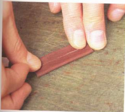
02 確實地壓緊。如果有需要的話，可以用榔頭等工具敲打，使其密合。
