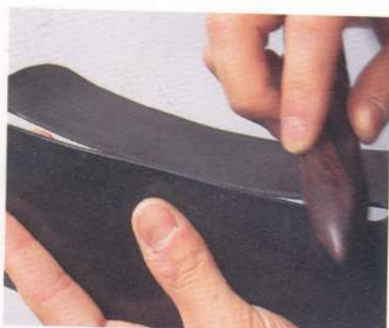
11 用木頭磨緣器推磨。不妨先把左右磨平之後，再來磨中間。
