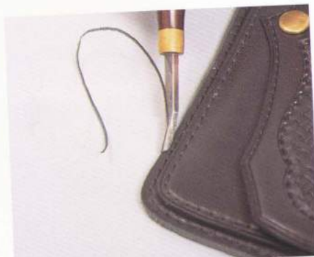
02 把切口的面作出來之後，再用修邊器把邊緣修掉。
