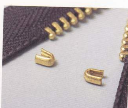
15 拆下來的金屬零件。這個金屬零件之後還會再用到，所以請好好地保管起來。
