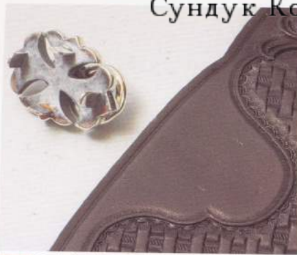
03 確定好位置之後，再把扣環的爪子按在沾濕的皮面層上，印上爪子的痕跡。
