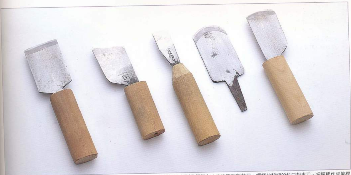
由左至右分別是握柄在中央的兩面削薄刀、握柄比較短的斜口裁皮刀、把握柄作成筆桿的形狀、刀刃前端為圓形的鞋用削薄刀、形狀跟平口裁皮刀很像的削薄刀。
