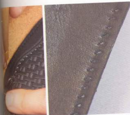
11 把各個部位貼合之後，再用菱形錐子把針腳的洞一路鑿穿到零件的部分。
