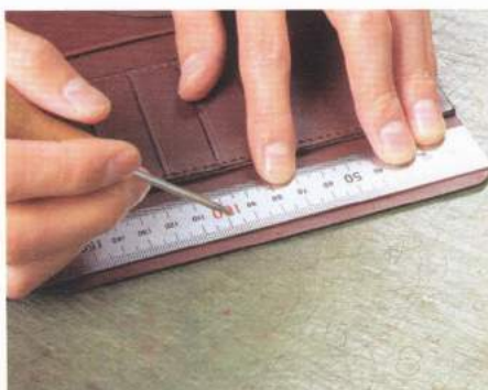
12 測量出內側和外側兩邊垂直線的中心點，用錐子打洞，作上記號。只要盡可能地把記號作在外側，縫合之後就看不見了。
