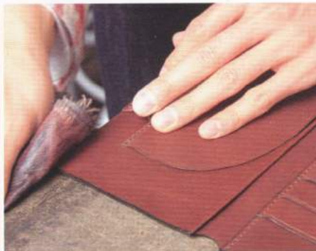
08 在與主體的外側縫合之前，請先處理四周的切口。事先塗上皮革塗料，再把多餘的皮革塗料用軟布擦掉。
