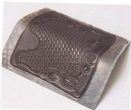
16 貼上裡革的主體。等到皮革專用白膠徹底乾了之後，再繼續進行下一個步驟。
