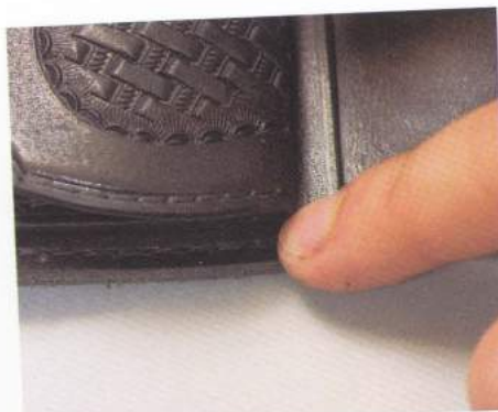
15 把紙型放在最外面的主體A上，往外推個幾mm之後先大致上裁開。
