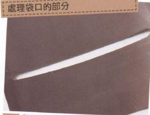
01 利用修邊器把要裝上拉鍊的零錢袋開口部分的邊緣削掉。表面的邊緣請削掉多一點。
