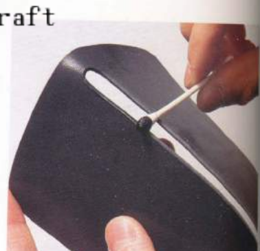
07 把切口削平之後，再塗上染料。請仔細地塗抹均勻，小心不要產生暈染或斑駁。
