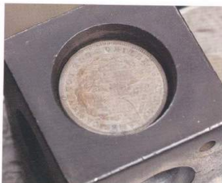
03 冷卻到可以用手去碰之後，垂直地放入大小跟硬幣相同的骰子型模具裡。
