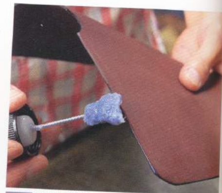
19 最後再進行染色，在處理好的切口塗上木工用的邊漆作最後修飾。
