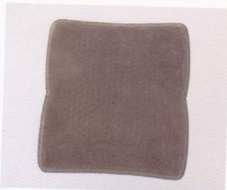
09 主體使用2mm厚的皮革，將5mm寬的邊緣削薄成1.3mm厚。
