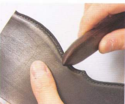
07 用木頭磨緣器推磨切口。從左右兩側以按壓的方式推磨，好讓皮革的纖維繃緊。
