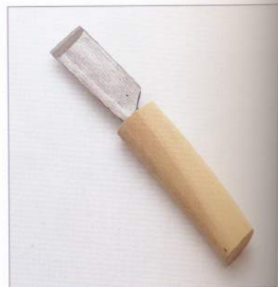
24mm寬的裁皮刀在把皮革從紙型上切割出來的時候，由於在小轉彎的地方很聽話，所以很實用。
