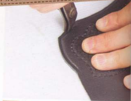
03 把零錢袋的蓋子邊緣和卡片夾層的上緣縫合。首先把縫線拉出來。
