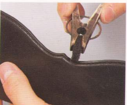
09 用銼刀磨好之後，再塗上染料。這裡一樣要小心翼翼地染色，以免形成斑點。
