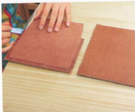
10 在主體A的皮面層3mm寬的位置上拉出縫線，把DIABOND橡皮膠塗在主體A和主體C上。
