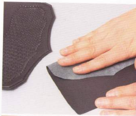
05 要貼在零錢袋上的裡革，請先以蓋上蓋子的方式在彎曲的部分事先壓出折痕。
