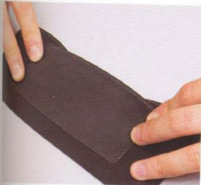
06 把邊緣的厚度被削薄的卡片夾層B和卡片夾層A重疊，重新比對位置。
