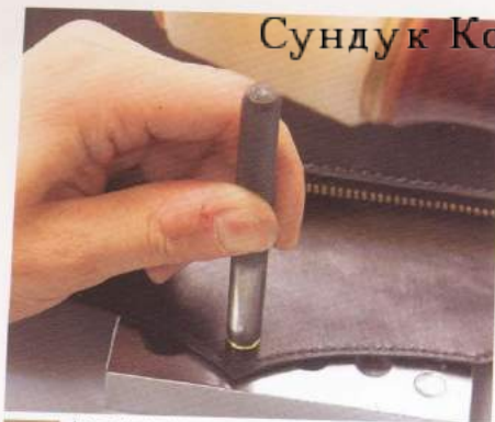
24 把四合釦裝在打好洞的位置上，把正面放在撞釘台上，用撞釘棒敲打固定。
