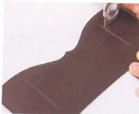
04 用美工刀將左右畫好的線條內側約5mm的皮面層削薄，處理好要上膠的地方。
