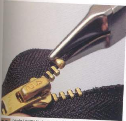
22 決定好要裝上金屬零件的位置之後，再用尖嘴鉗等將其固定在布條上。
