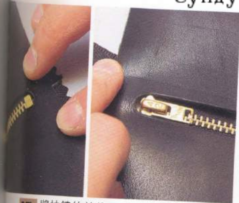
17 將拉鍊的前後調整成如上圖所示的狀態。
