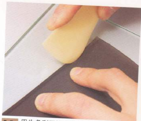
14 用牛角刮刀按壓從用平行線器畫好的線到前端的邊緣部分。
