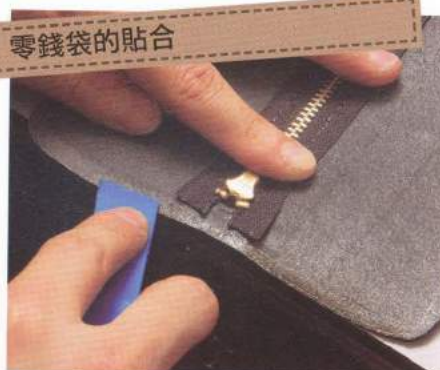
01 在零錢袋的主體邊緣寬約5mm的範圍內塗上接著劑。請小心不要塗得太多。
