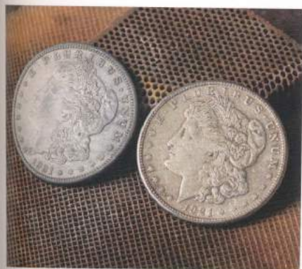
02 左邊變成白色的硬幣是經過退火處理之後的狀態。退火處理之後會在常溫下慢慢地冷卻。
