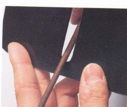
12 木頭磨緣器照顧不到的地方可使用木製的筆桿來推磨。
