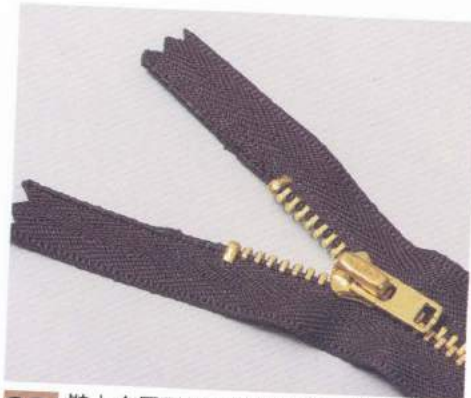
23 裝上金屬零件之後的狀態。檢查拉鍊是不是能夠確實地拉上。
