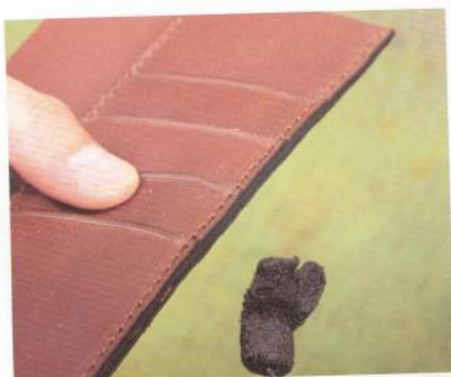
20 在縫合的部分塗上皮革塗料，進行切口的處理。
