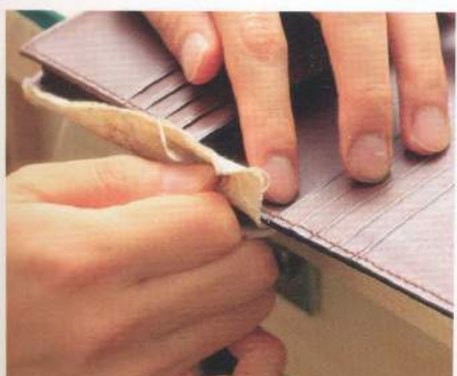
20 塗上CMC，用帆布推磨。重覆 18 ~ 20 的步驟2~3次，切口就會變得很工整。
