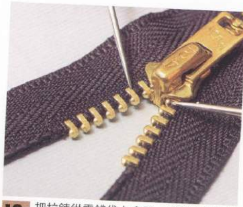
18 把拉鍊從零錢袋上拿開，檢查鍊齒最後會落在哪個位置上。
