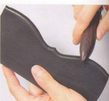
11 用木頭磨緣器推磨，重覆以上步驟直到滿意切口的狀態為止。
