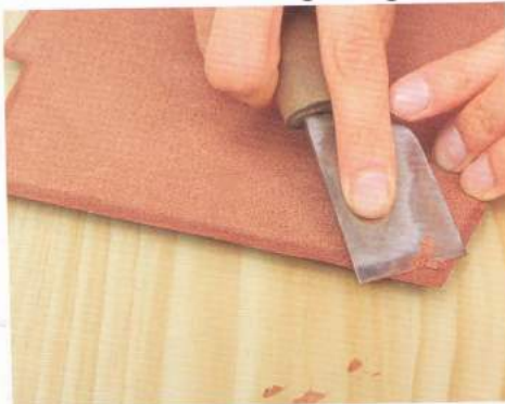
08 在把卡片夾層貼合的時候，為了不讓皮革的厚度影響到整體的美觀，請事先將主體C的前端削薄。
