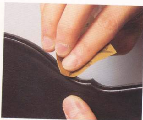
02 只要在弧形的部分使用紙銼刀，就可以削得很工整。
