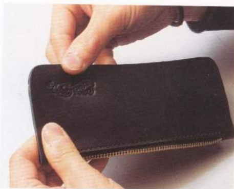
03 等到接著劑乾了之後，再仔細地對準邊緣貼合。由於橡膠系的接著劑沒有辦法重貼，所以請準確地對齊好位置再貼。貼好之後要壓緊密合。
