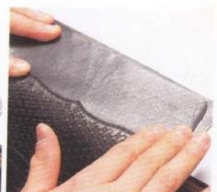
在把裡革貼在對折的地方時，請使用桌邊等工具，一面彎折，一面貼合。在壓出折痕的時候也可以利用這種作法，但要注意不要折過頭了。
