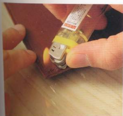
15 把線剪斷，用打火機燒熔固定住。這麼一來縫合就大功告成了。
