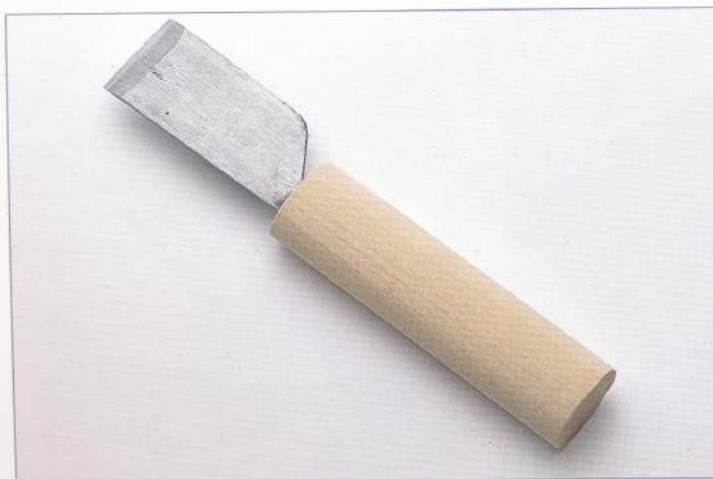
左圖為寬度比較窄的30mm裁皮刀。如果想要製作的東西以小東西為主，也可以選用這把裁皮刀。
