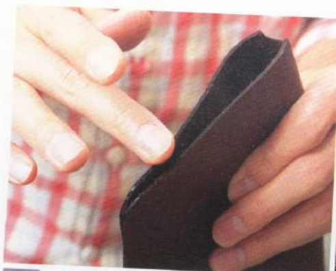
18 一定要把多餘的皮革染料擦掉之後，再塗上CMC，用軟布推磨。
