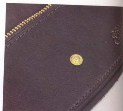
31 把四合釦的外側零件裝在穿出正面的四合釦內側零件的突起上。
