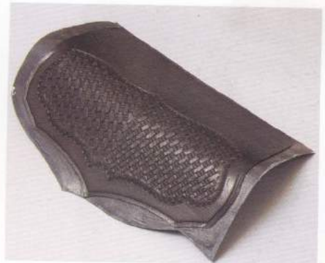
10 和裡革貼合之後的零錢袋的蓋子。彎曲成這個狀態是最理想的。
