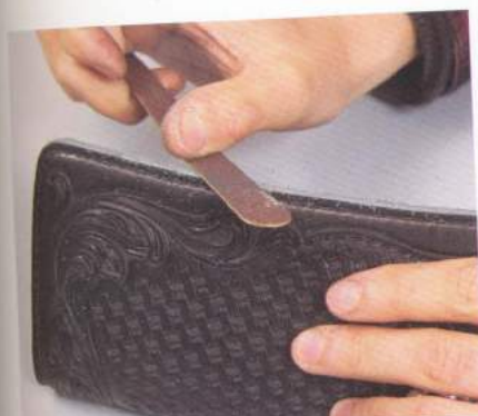
01 用紙銼刀把切口磨光，製造出光滑平整的面。
