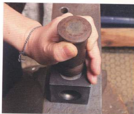
04 找出一樣符合硬幣尺寸的圓頭槌，從上面圓頭朝下放在硬幣上。
