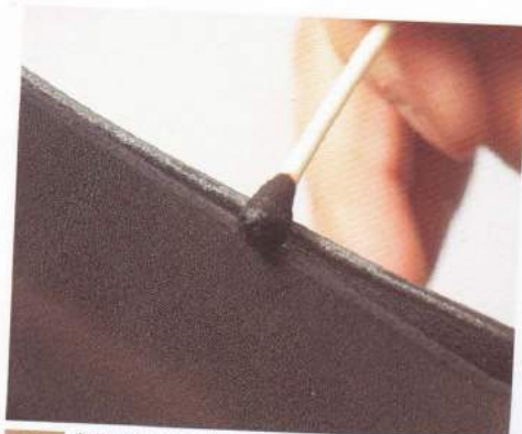
03 把邊緣削掉之後，再用染料染色。以棉花棒沾取染料，一面轉動一面把染料染上去。
