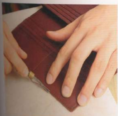
17 用修邊器把邊緣修掉。修邊器要同時落在主體的正反兩面上。
