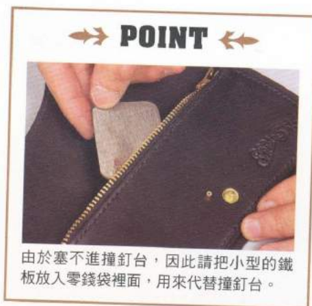
31 把四合釦的外側零件裝在穿出正面的四合釦內側零件的突起上。
