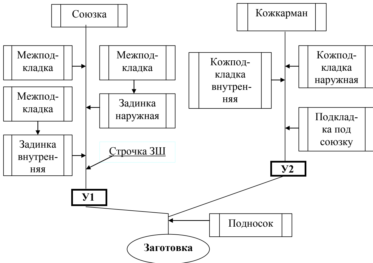
Рис. 1.1. Схема сборки заготовки
