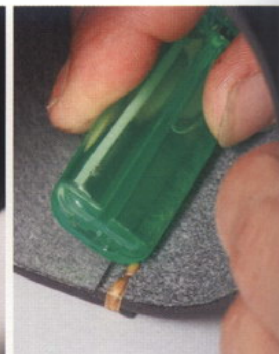
29 ライターで飛び出ている糸をあぶり、溶けたらライターの側面で押しつける
