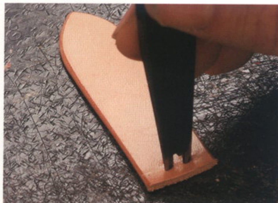
51 ベルトの中心にヒシ目打ちを打つ。2本ヒシ目打ちで、本体の縫い線と同じ幅で穴をあける
