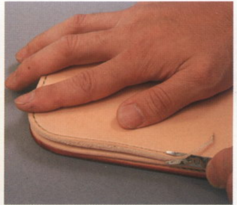
49 カバーとなる部分と縫い合わせた部分の角を落とす。裏表両側とも落とす
