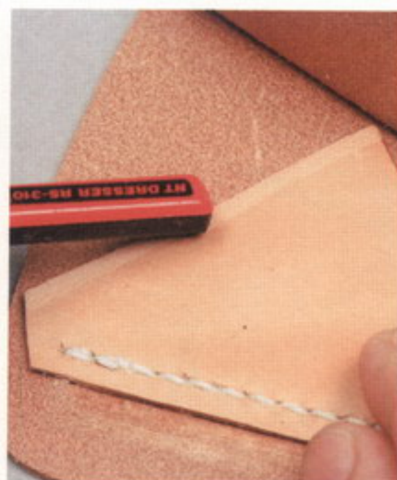
27 続いてマチ1,2ののりしろ部分をドレッサーで擦る。面を荒らしたら、そこにゴムのりを薄く付ける
