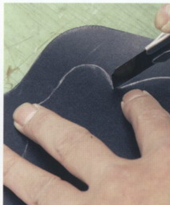
2 本体の革を切り出す。窓の部分は刃を動かすのではなく、革の方を動かして切っていくと上手くいく
