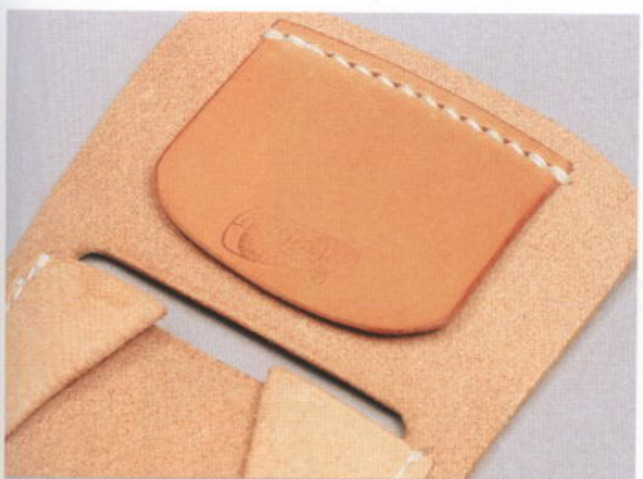
30 マチ1,2を本体1に縫い合わせたら、仕切を縫い合わせる。縫い方はマチ部分と同じ
