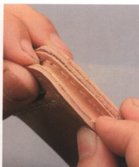
49 マチ3を折り曲げてくせをつけ、ゴムのりを塗って本体と貼り合わせる。ヒシ目の位置を合わせる
