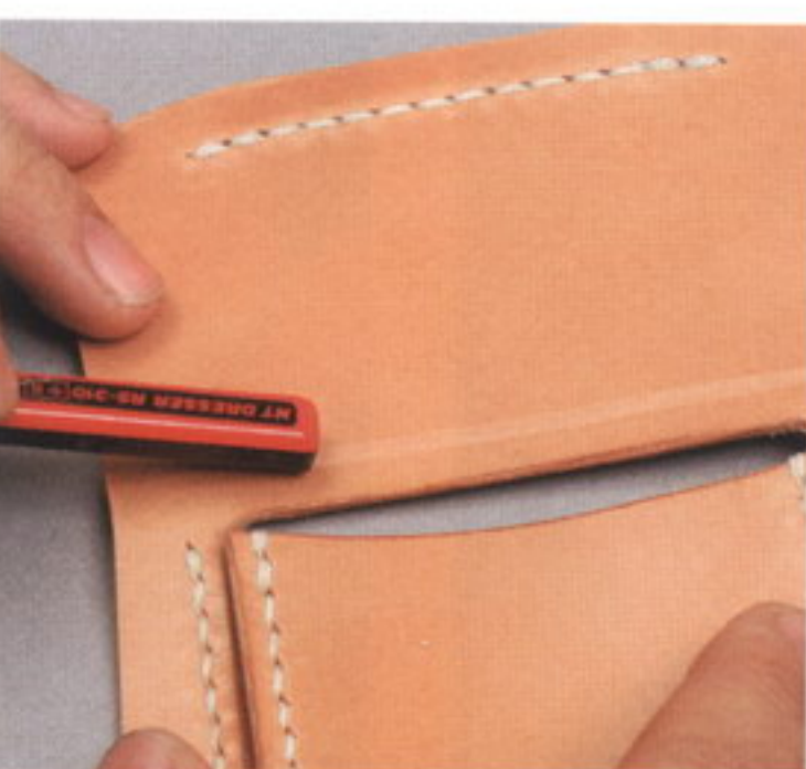
31 コインケース口の上をドレッサーで擦って荒らし、本体2に縫い線を引いてヒシ目打ちを打つ。これはコインケースのカバー部分となる
