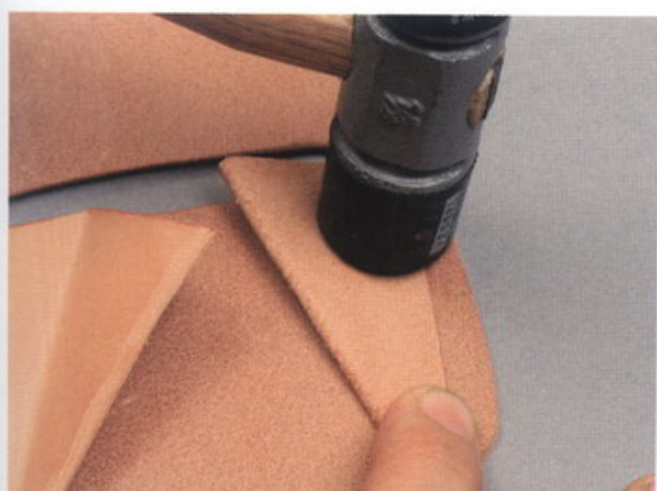
28 マチを折り曲げて本体1に貼り付ける。貼り付ける位置が決まったら、ハンマーで圧着する
