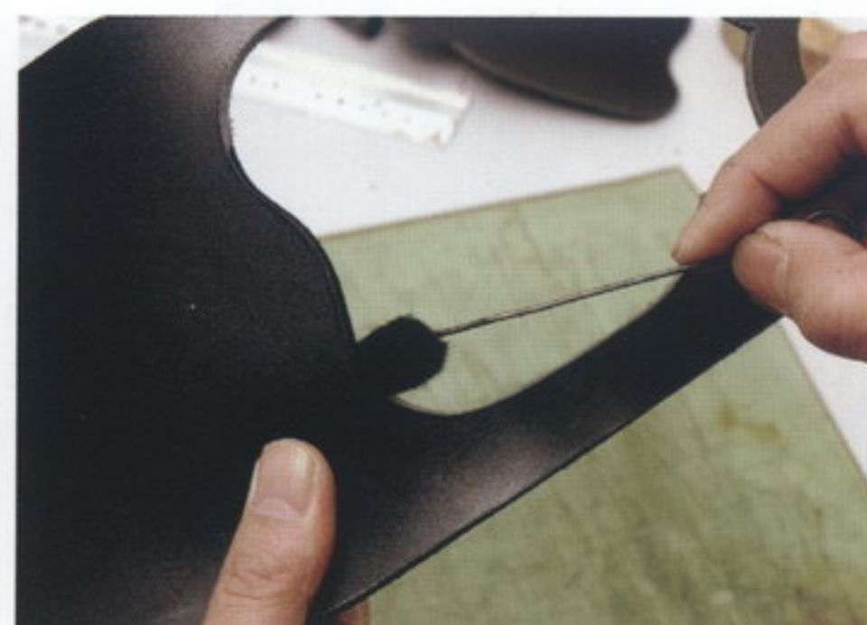
4 窓の内側の部分は組み立ててしまうと作業できないので、先に染色しておく
