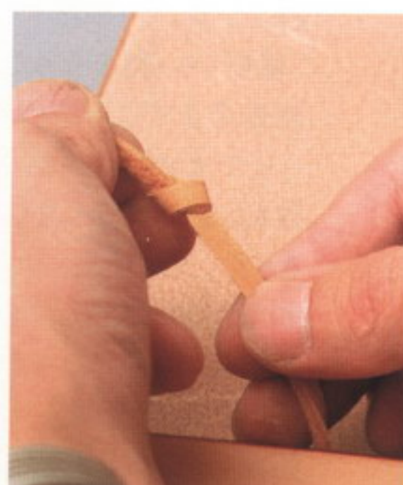
75 バッグの内側からレースを引っ張り出して固結びをする。結んだら再びレースを外側へ引っ張り出す
