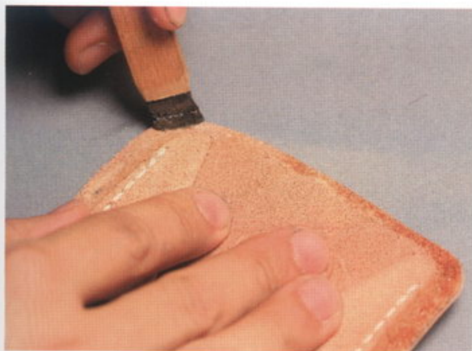
48 続いて本体1のコインケース側にゴムのりを塗る。ゴムのりは極力薄く塗る
