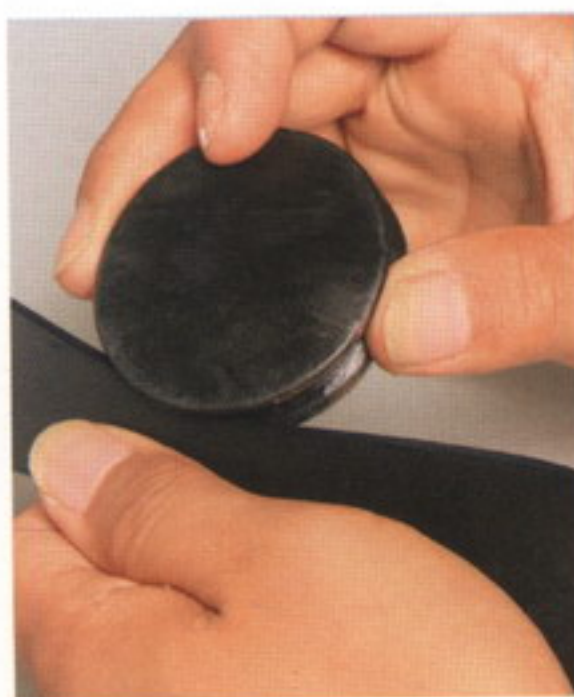
8 ヘリみがきを使ってパーツの側面を磨く。力を入れずに、まずは毛羽立ちを抑える程度にし、乾いたら平面で光沢を出す
