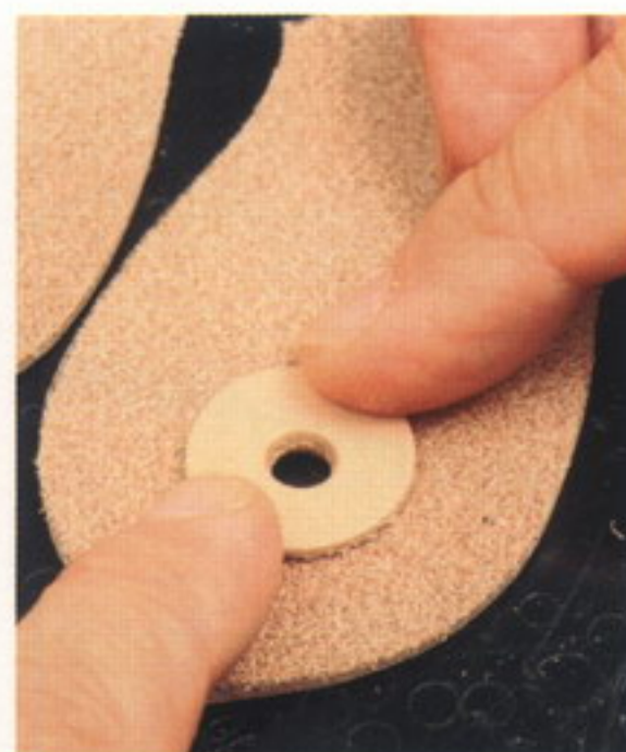
8 穴の部分にあて革を挟み、3mm幅の縫い線を付けて本体を縫い合わせる。ハトメ抜き20号で、あて革にも穴をあけること
