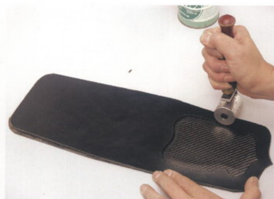
30 位置を合わせて貼り合わせたら、ローラーを使ってパーツを圧着させる
