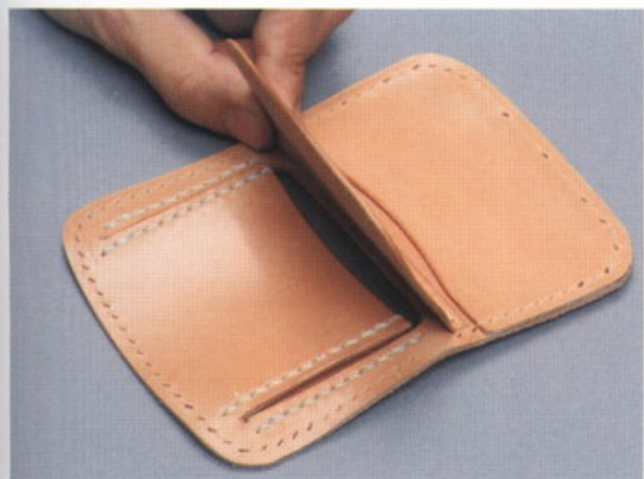
38 このように本体1の周りにヒシ目打ちを打つ。ただし、折り目となる部分には打たない
