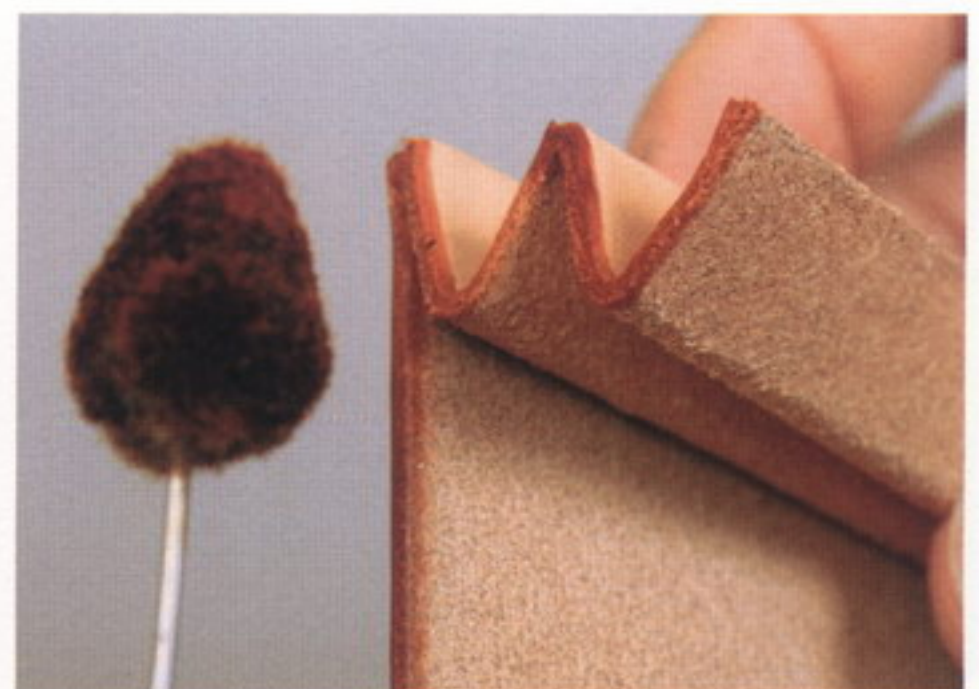
22 ヘリおとして角を落としたら茶色の染料を塗る
