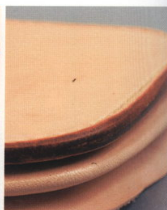
37 ウッドブロックなどでヘリを磨く。内側と側面、外側を丁寧に磨き、光沢を出す。厚みがあるので、ヘリみがきを使う場合は平面で磨く
