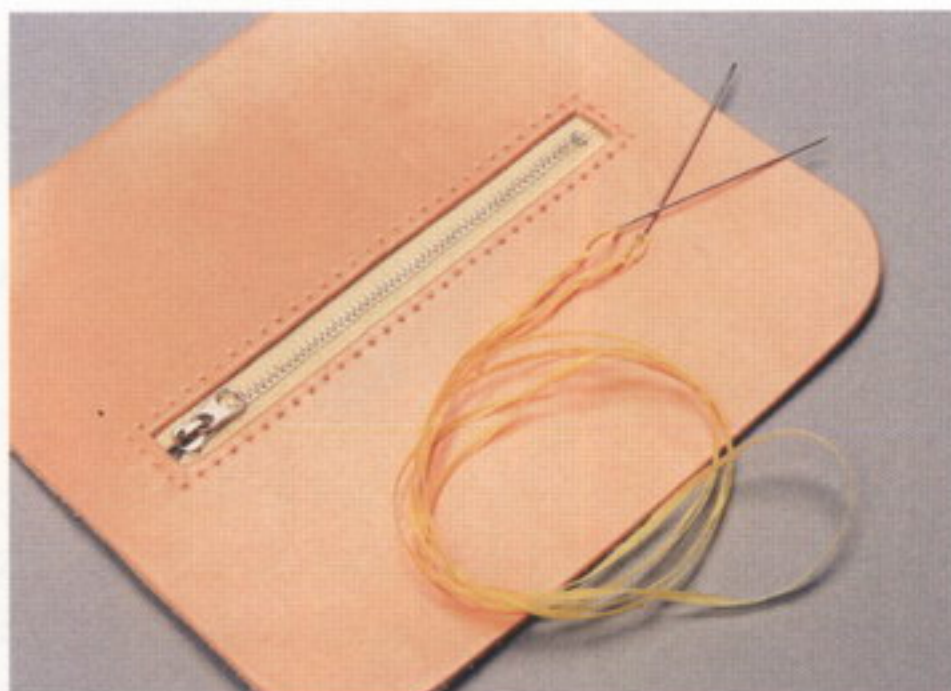
9 ファスナーの周りに穴をあけたら、針と糸を準備する。糸の長さは縫う長さの3.5~4倍程度
