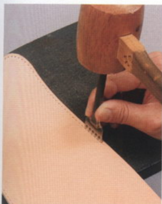
40 本体2と同じように、貫通しない程度にヒシ目打ちを打っていく。最後で目の位置が合わない場合は、菱ギリであける
