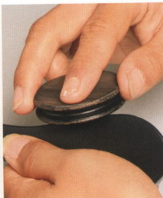
8 ヘリみがきを使ってパーツの側面を磨く。力を入れずに、まずは毛羽立ちを抑える程度にし、乾いたら平面で光沢を出す
