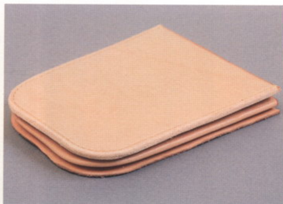
34 角の処理をした状態。R部分がなめらかな曲線を描くように仕上げる。ペーパーをかけすぎると、縫い目にかかってしまうので気を付けること
