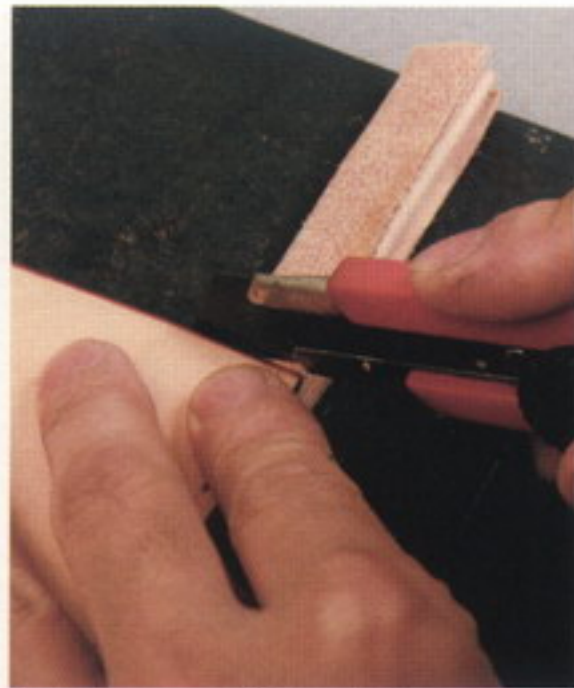
19 マチの余分な部分をカッターで切り取る。本体2の上部に合わせてまっすぐに切り落とす
