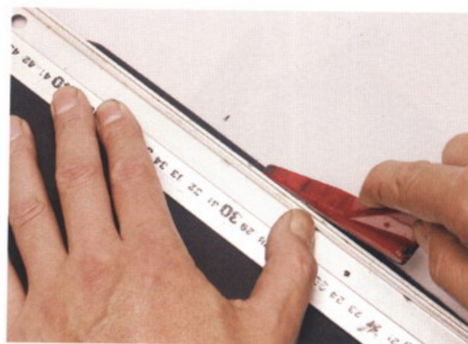
52 のりしろ以外の部分を削らないように、金尺等をあてながらヤスリで表面を削る
