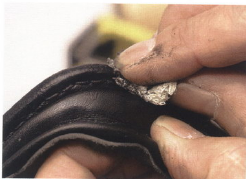
50 染色し、磨く。先にも書いたが、ボンドが残っていると染まらないので、削り落とすこと
