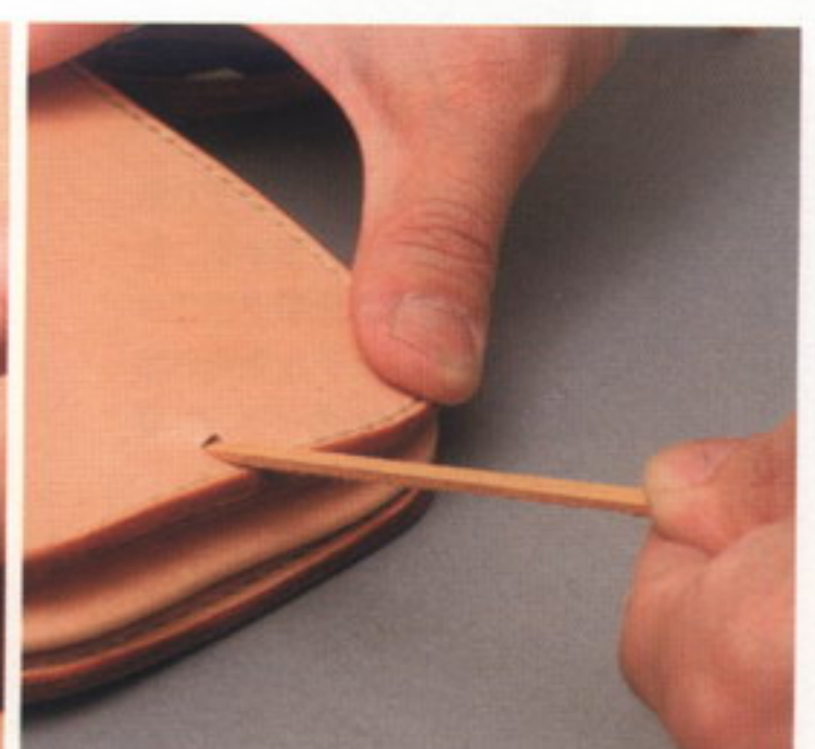
75 バッグの内側からレースを引っ張り出して固結びをする。結んだら再びレースを外側へ引っ張り出す
