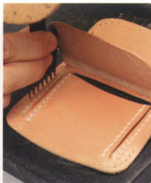
37 菱ギリで付けたアタリを目安に、コインケース側の本体1にもヒシ目打ちを打っていく。R部分は2本ヒシ目打ちを使用する
