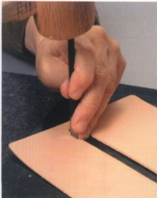
2 コインケースの口にヒシ目を打つ。直線は4本ヒシ目を使用し、曲線は2本ヒシ目を使用する
