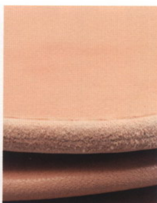
34 角の処理をした状態。R部分がなめらかな曲線を描くように仕上げる。ペーパーをかけすぎると、縫い目にかかってしまうので気を付けること
