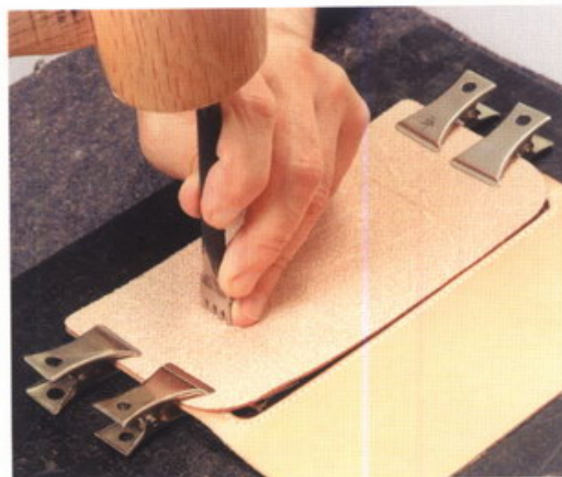
3 クリップで固定したままヒシ目を打つ。パーツ同士がずれないように注意する
