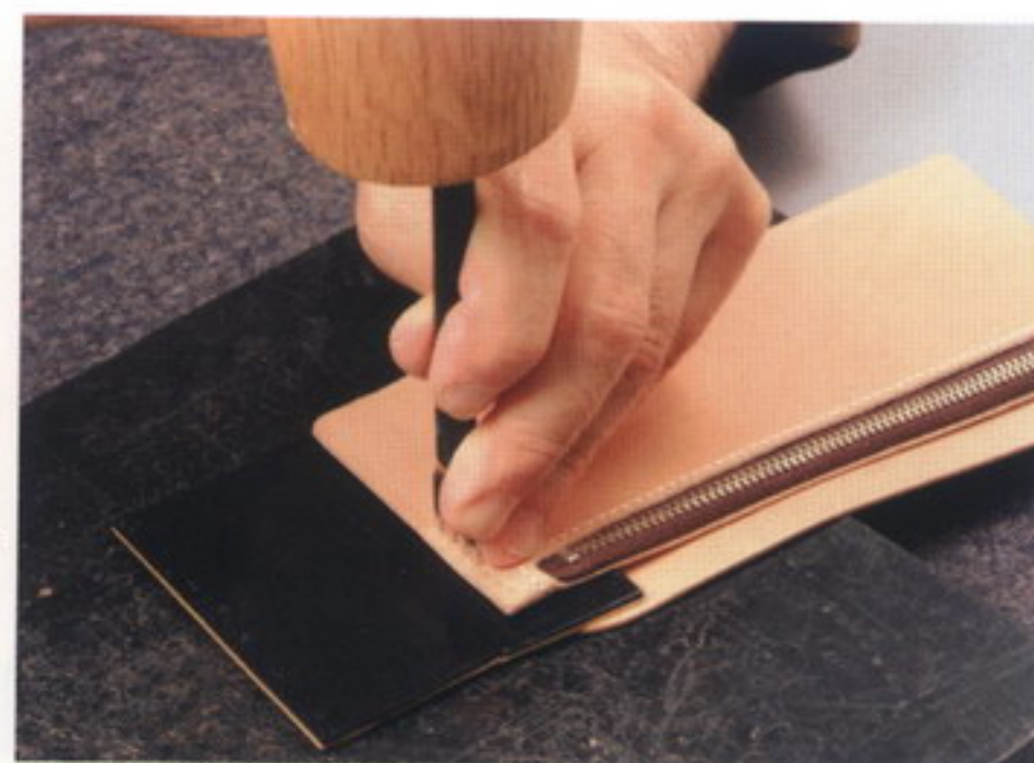
8 コインケースとパーツFの間に薄いゴム板を挟み、ヒシ目打ちを打って縫い合わせる
