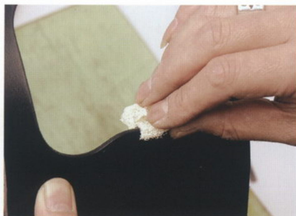
5 染色したら、CMC(革用の糊)を付けたヘチマで、毛羽立ちが収まるまでしっかり磨く
