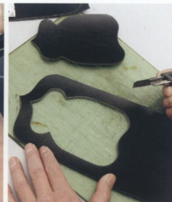
2 本体の革を切り出す。窓の部分は刃を動かすのではなく、革の方を動かして切っていくと上手くいく
