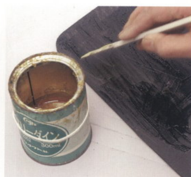
28 本体と裏のパーツの貼り合わせる面に、ボンドを塗る
