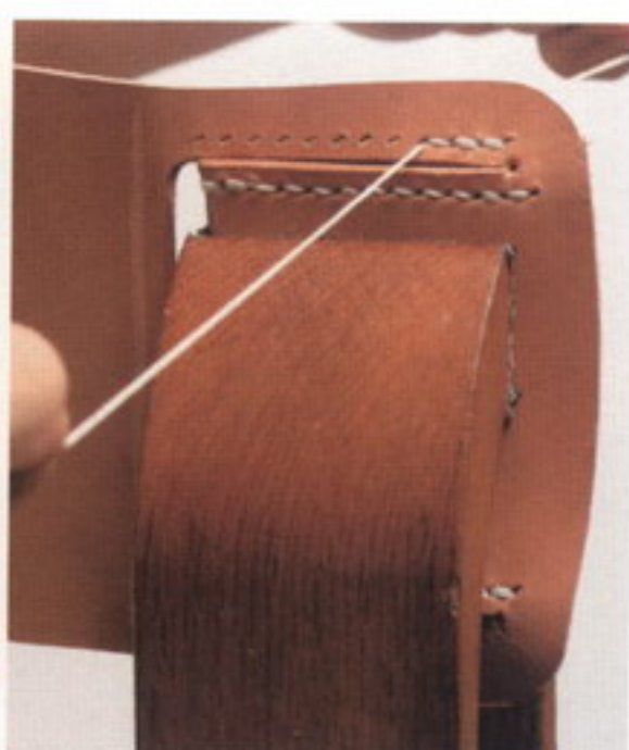
29 本体1を裏返し、13で付けた縫い線に沿ってヒシ目打ちを打つ。ヒシ目打ちを打ったら、21と同じように縫い合わせていく
