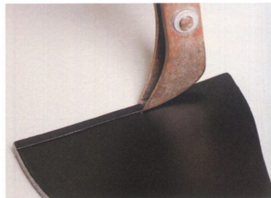
9 ネジ捻を使用して、ホルダー1と2、本体に3mm幅の縫い線を付ける
