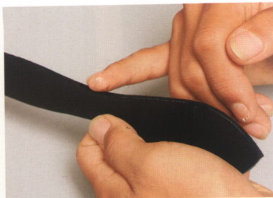
7 染料を塗ったら、上からCMCを塗る。銀面にはみ出ないように気を付けること
