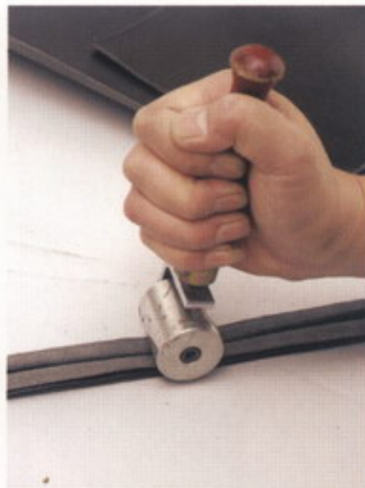
18 革が折れたら、ローラーでしっかりと形を付ける
