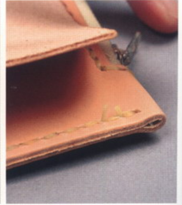
24 縫い終わりは2重に返してから1目分戻り、内側へ糸を出す。2mm程残して糸をカットしたら、ライターであぶって固着させる
