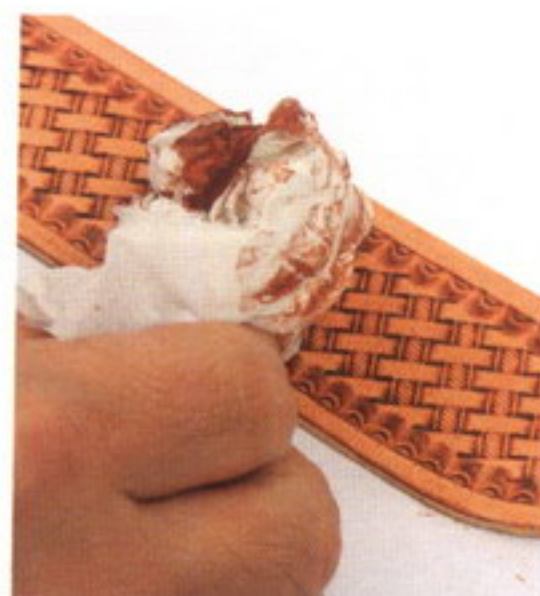
10 アンティックを塗ったら、すぐに布で拭き取る
