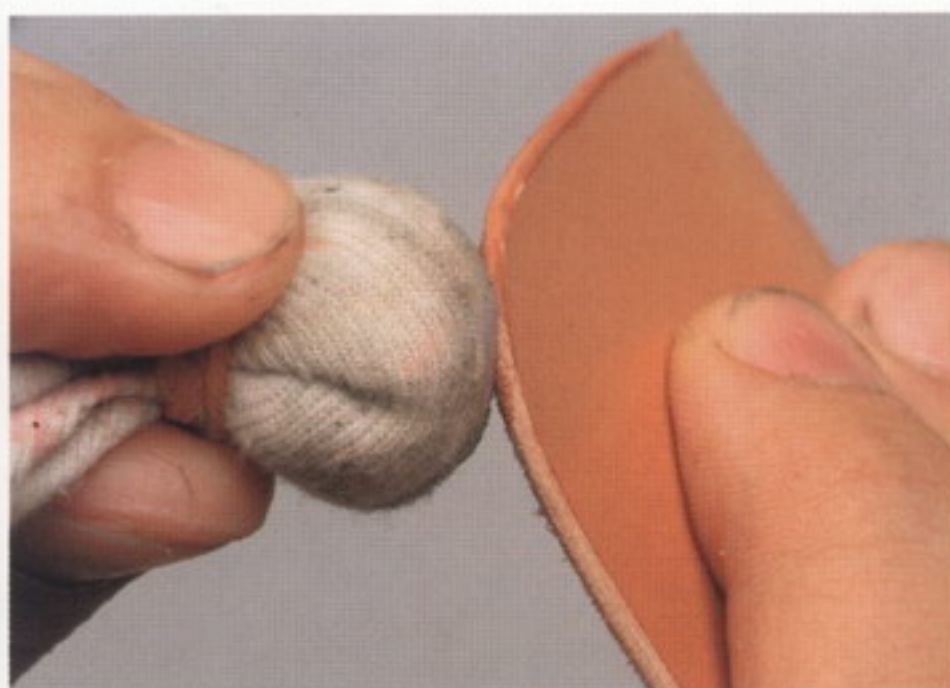
8 面取りをしたら、ふのりをウエスに取って塗る
