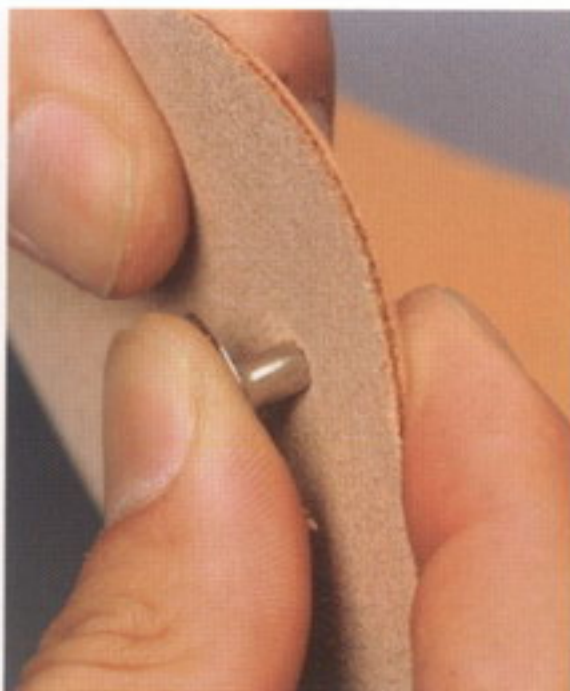
32 ジャンパードットの脚を本体の裏側から差し込み、表側からジャンパードット(凸)をはめ込む
