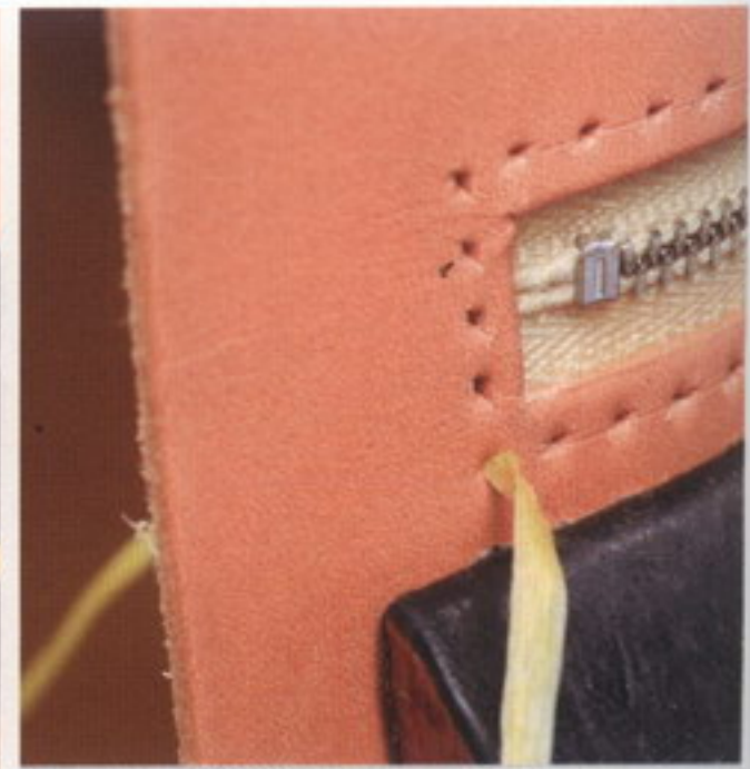
10 今回はシニュー糸を使用する。角から縫い始めていくと縫い終わりが目立たず、きれいに仕上げることができる
