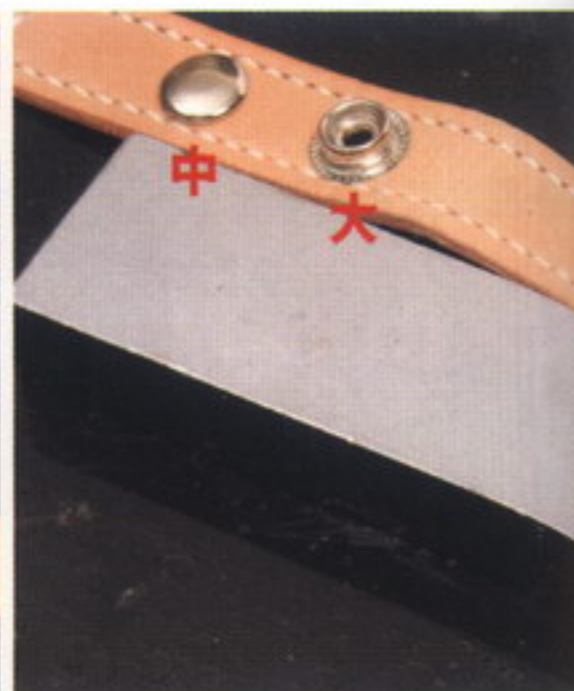
10 端から6cmの所にジャンパードット大凸、12cmの所に中の凸をそれぞれ付ける。大はハトメ抜き10号を使用する
