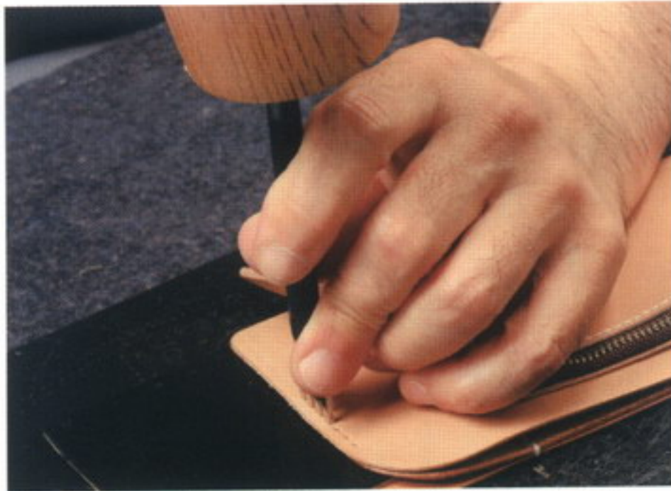
13 パーツCとGの間に薄いゴム板を挟み、コインケースをめくりながらヒシ目打ちを打っていく
