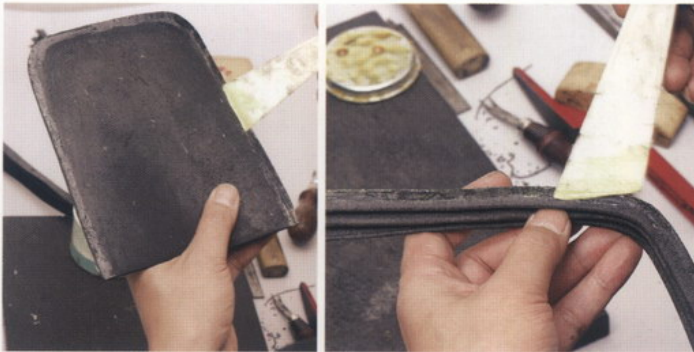
42 磨き残したのりしろと、マチの合わせ面にボンドを塗る。合わせた時にはみ出さないように、薄く塗り広げるようにすること
