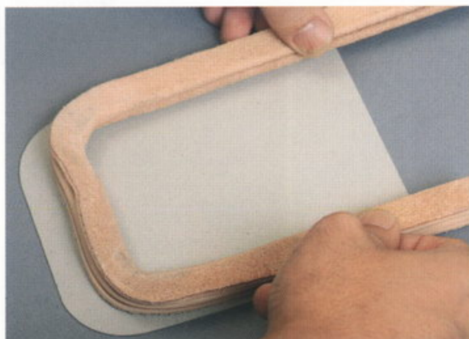
8 型紙に合わせて左右ともRを作る。形を作ったら、約1日置いて革の中までしっかりと乾かす
