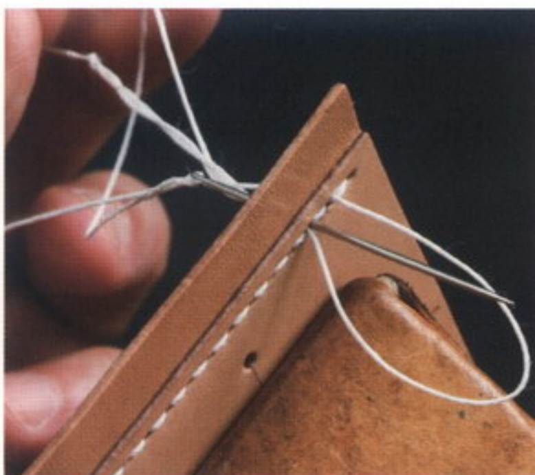
8 常に同じ順番で糸を通し、縫い進めて行く。糸は均等な力で締めていくこと。最後の目まで縫ったら、折り返して2目分縫い戻る
