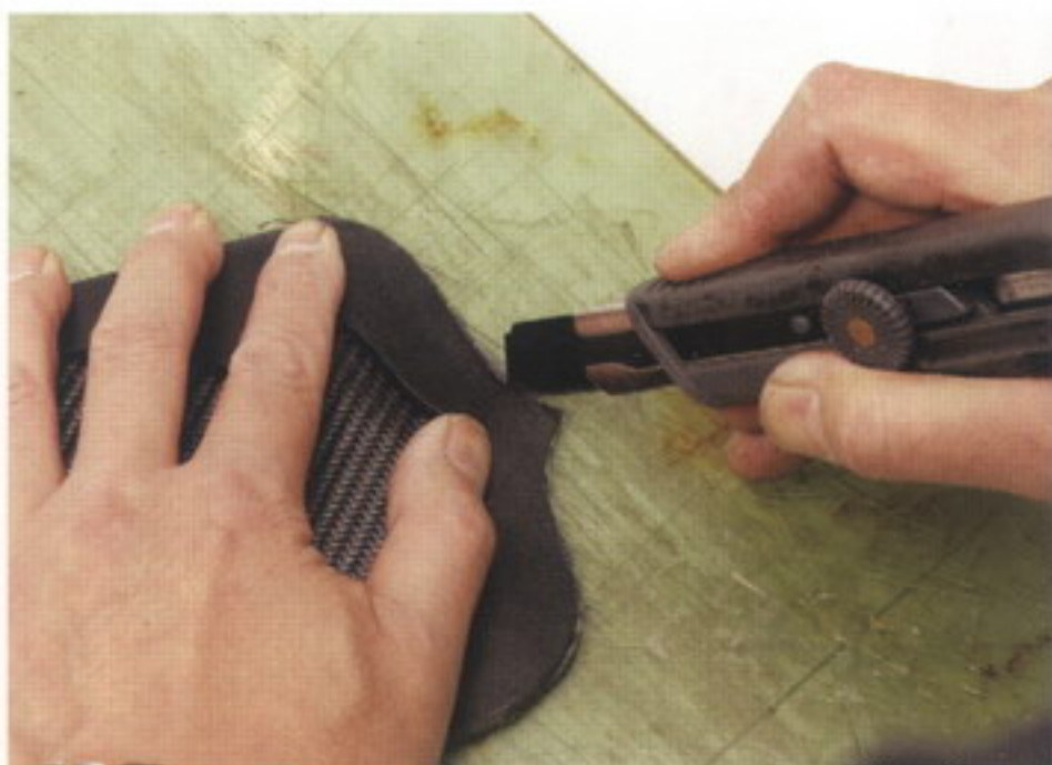
31 少し大きめにカットしていた裏側のパーツの、はみ出した部分をカットしていく
