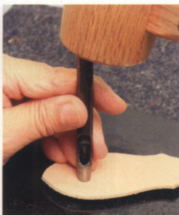
7 続いてキーホルダーに金具を付ける。コンチョとジャンパードットを付ける穴を、20号のハトメ抜きであける
