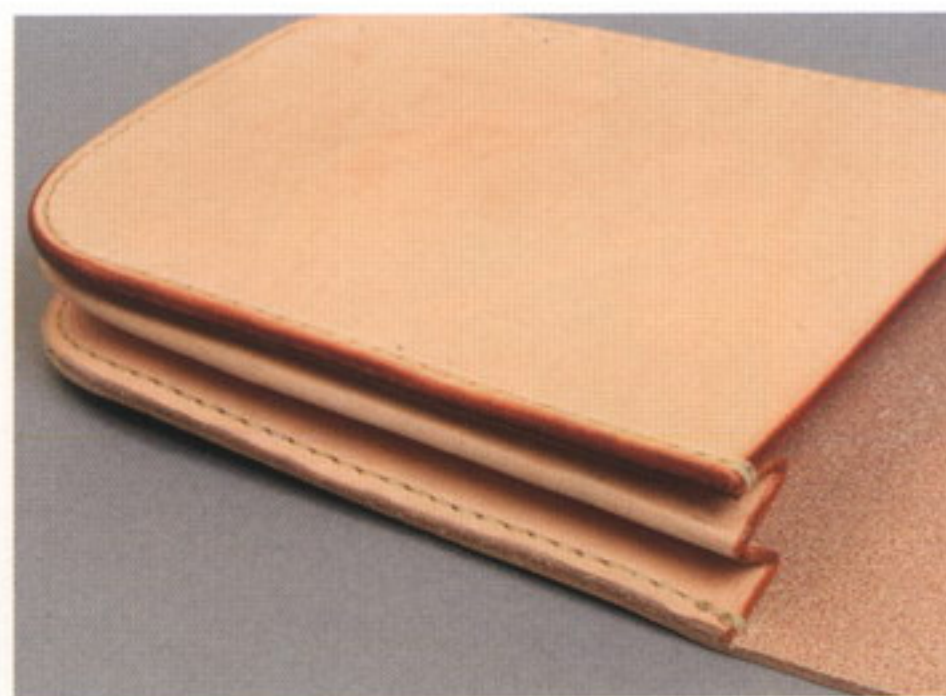
47 2mm程残して糸をカットし、ライターであぶって糸の先を潰す
