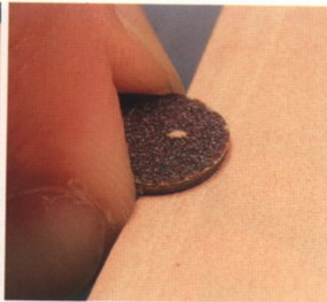
2 接着剤を付ける面をサンドスティックで荒らす。スティックの頭を5mm出して持ち、指を革の側面に沿わせれば、均等な幅でヤスリ掛けできる
