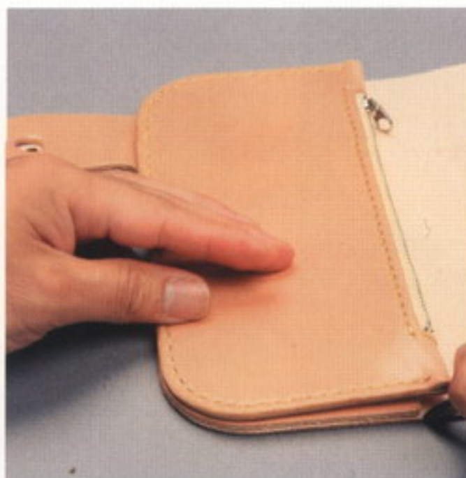
35 ポケットとカード入れを本体の取り付け部分に合わせ、のりしろの位置に印を付ける
