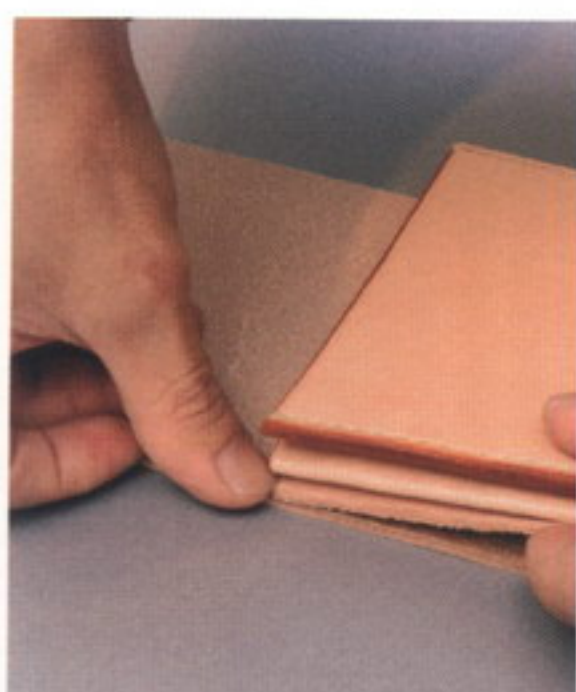
42 ボンドが半乾きになったら、マチと本体1を貼り合わせて圧着する。始めにマチの上部を本体1に付けた印に合わせて貼る
