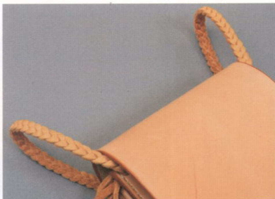
63 左右の編み込みが同じ長さか確認する。長さが異なるとベルトに付けたときに傾いてしまう
