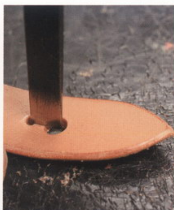
66 ギボシをはめる穴と裂け防止穴の間を、つきのみで裂く。ベルトをギボシにはめ込み、スムーズにはまるか確認する
