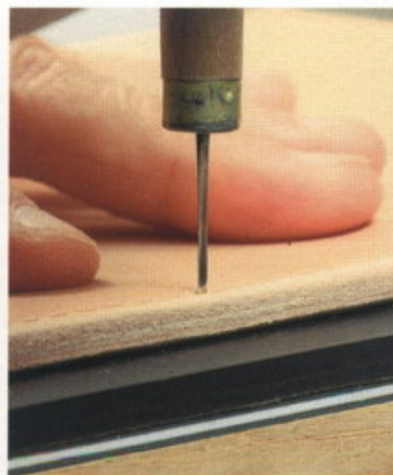
11 途中まで打った穴は、全て菱ギリで貫通させていく。手間はかかるが、縫い目をきれいに仕上げるためのポイントだ
