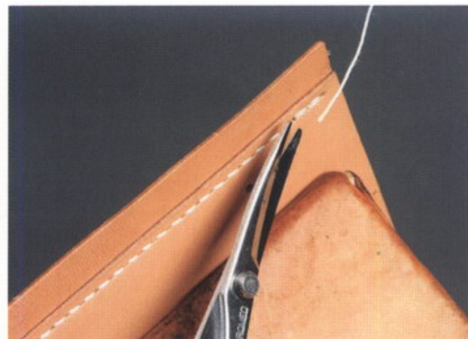
9 縫い目のきわで糸をカットする。糸が出ていると格好悪いので、ギリギリでカットすると良い
