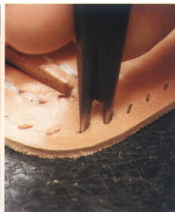
37 菱ギリで付けたアタリを目安に、コインケース側の本体1にもヒシ目打ちを打っていく。R部分は2本ヒシ目打ちを使用する
