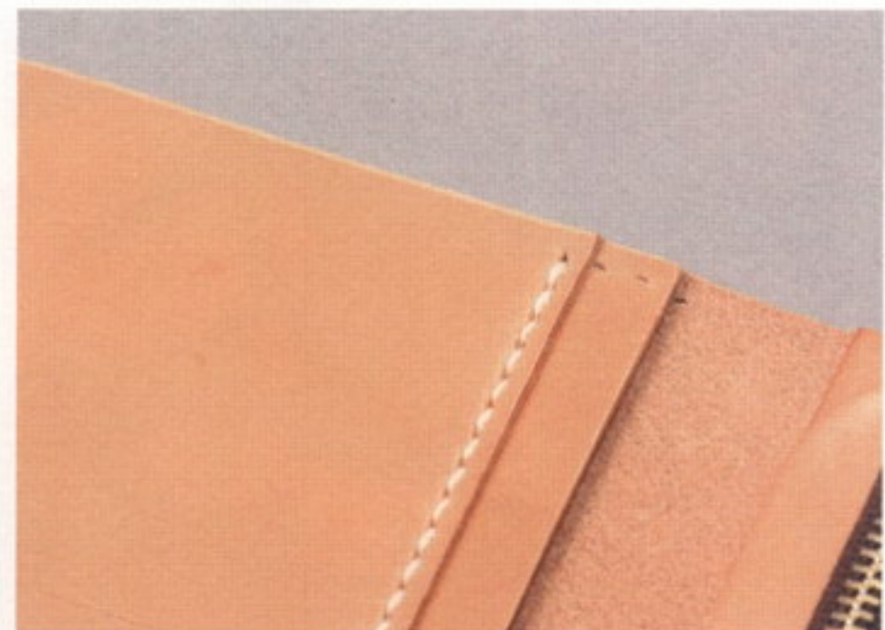
9 裏から見た状態。このように菱ギリであけた穴の真ん中に、ヒシ目打ちを打つようにする
