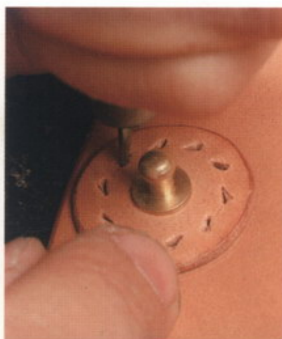
63 ギボシ受けにあけた穴に菱ガリを打ち、穴を貫通させる。穴をあけたらギボシ受けを縫う
