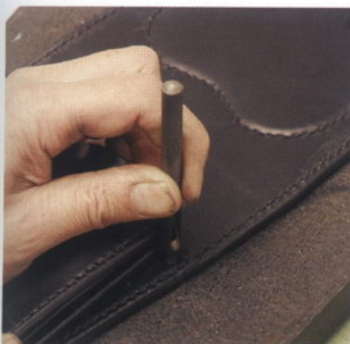
64 6mmのハトメ抜きで、釣り紐を通すための穴を本体にあける
