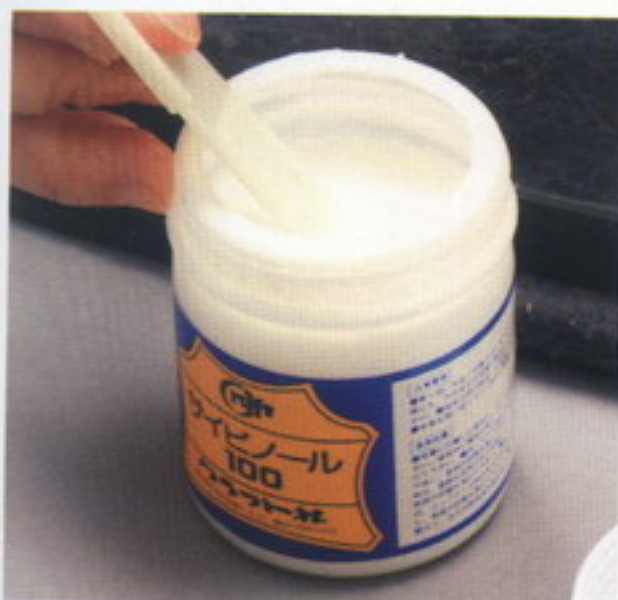
3 接着剤(サイピノール)をジラコヘラに取る。接着剤が接着面以外に付かないようにするため、ヘラの片面だけに付ける
