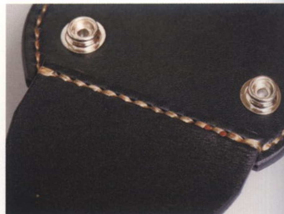
33 本体の下部はホルダー1を重ねて縫っていく。始めと終わりは2重に縫って強度を上げている
