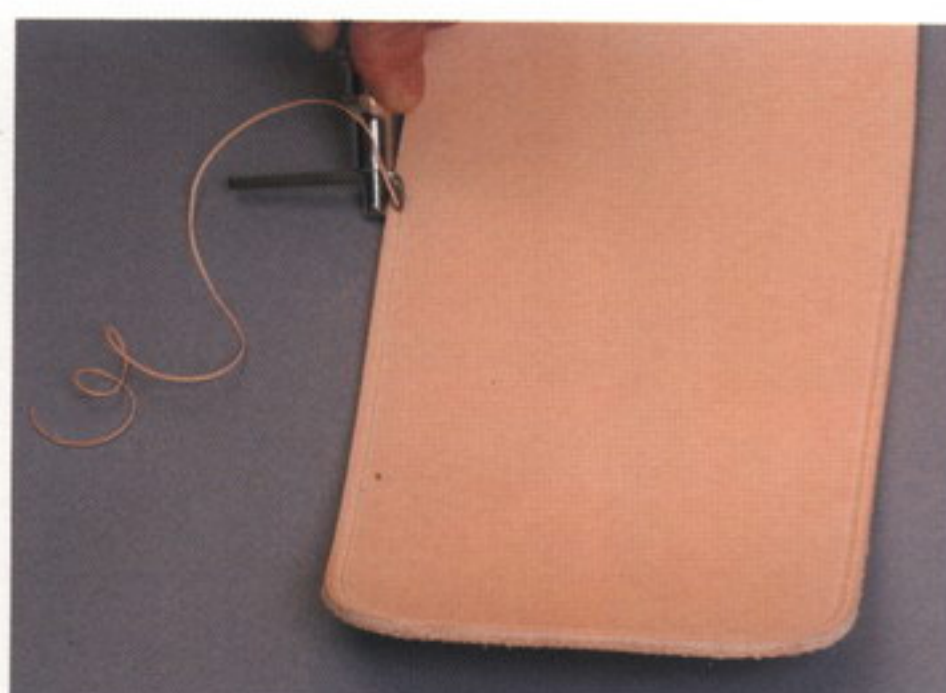
39 裏側の印を元にして縫い始めの位置を決め、ステッチンググルーバーで縫い線を付ける
