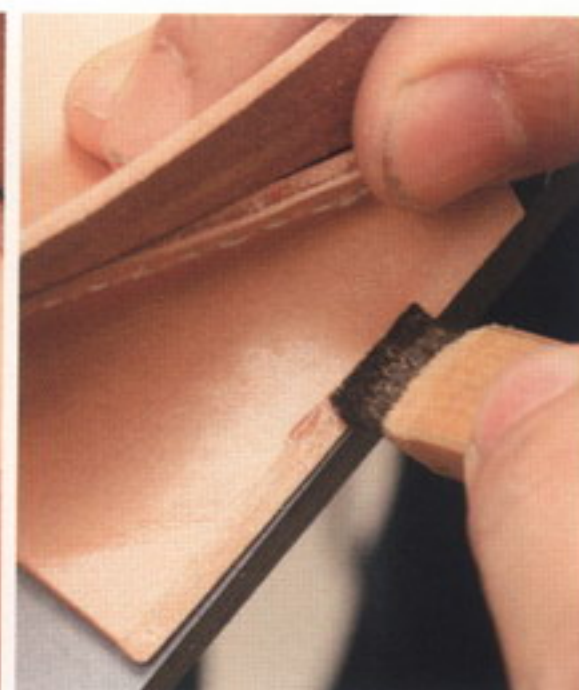
27 続いてマチ1,2ののりしろ部分をドレッサーで擦る。面を荒らしたら、そこにゴムのりを薄く付ける
