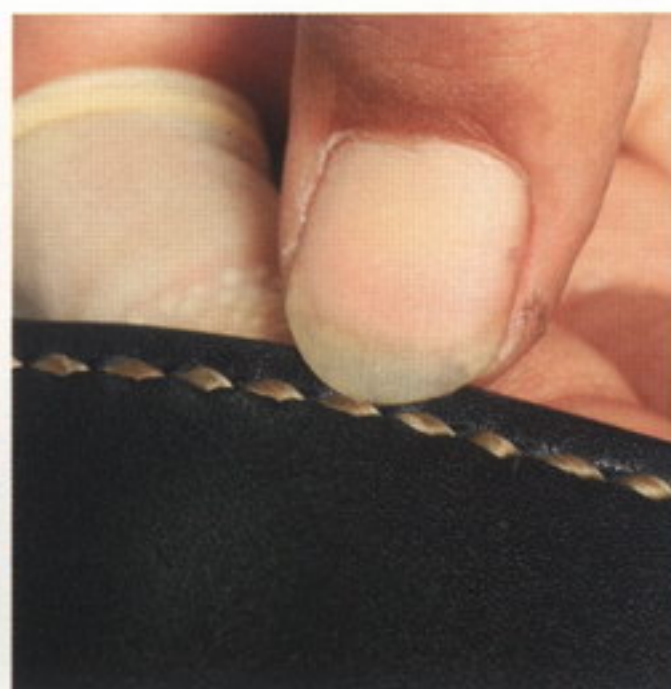
32 シニュー糸は細い繊維が束ねられているので、爪で中心に寄せながら縫い進めていく。これにより縫い線がきれいに仕上がる
