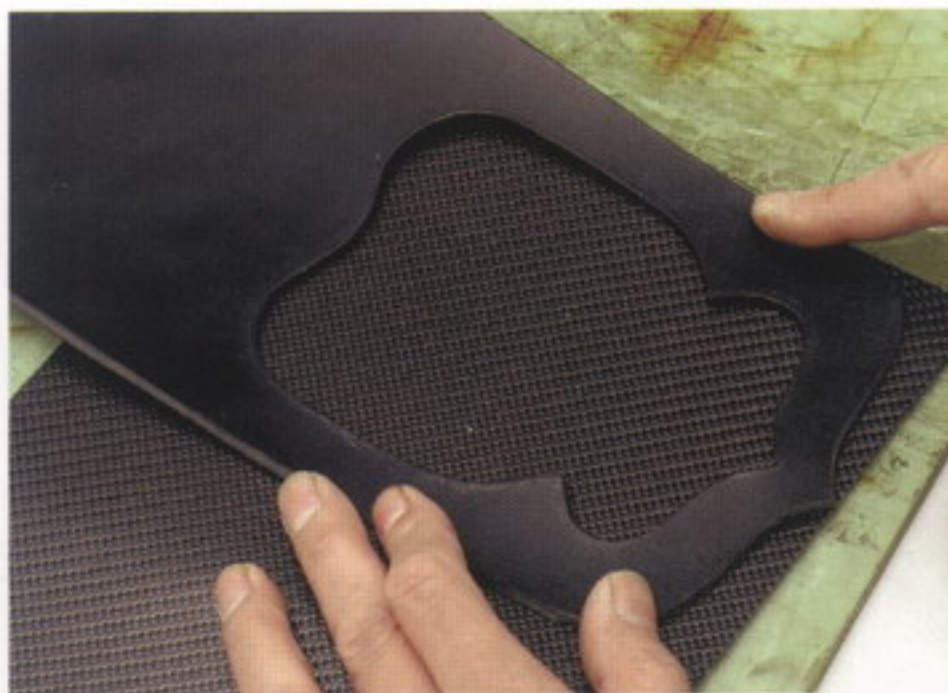
7 窓の部分に合わせて、カーボンシートを切り出す大きさを決める
