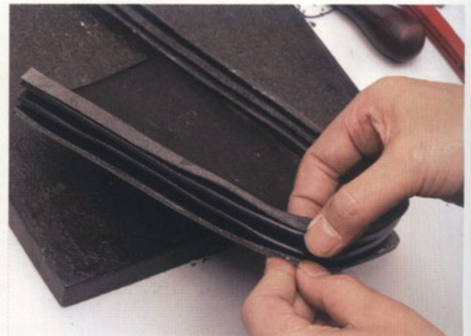
43 半乾きの状態でパーツを張り合わせていく。きちんと位置を合わせて貼ること
