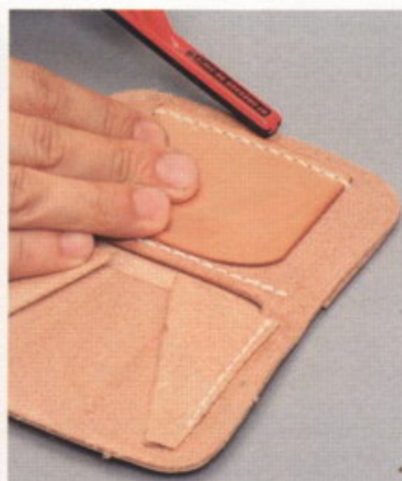
42 マチ3の両側と本体1の周りをドレッサーで擦り、ゴムのりが付 きやすいように面を荒らす
