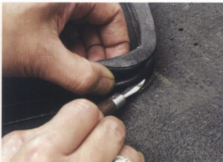
44 角の部分は剥がれやすいので、しっかりと上から押して接着する
