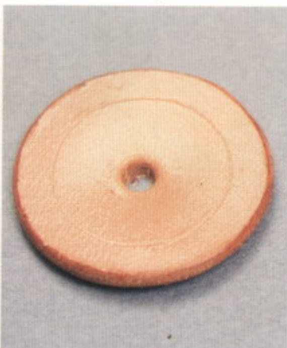
58 円の中心に印を付け、ハトメ抜きで穴をあける。ハトメ抜きの大きさは、ギボシの大きさに合わせる
