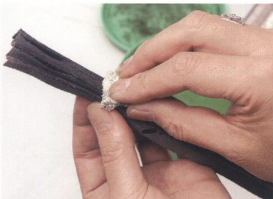
20 折り目の部分の強度を出すために、CMCで磨く。左右の接着面は磨かないこと
