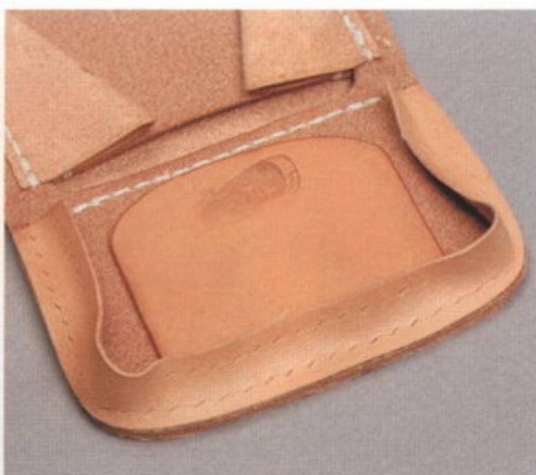
46 マチを引っ張って伸ばしながら角に合わせて貼り付けていく。本体からは み出さないように、しっかり貼ること
