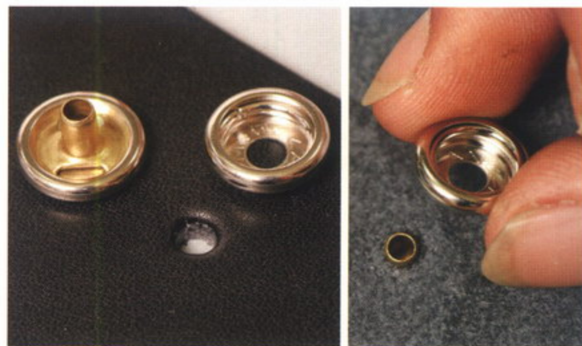
20 ホルダー2の穴には凹を取り付ける。このジャンパードットは本体とホルダー部分を固定するために使用する
