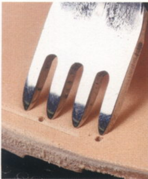
8 菱ギリの穴と4本ヒシ目打ちの間隔が合わなければ、2本ヒシ目打ちを使用して間に穴をあける。これは終わり部分も同じ
