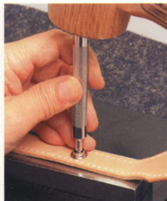
10 端から6cmの所にジャンパードット大凸、12cmの所に中の凸をそれぞれ付ける。大はハトメ抜き10号を使用する
