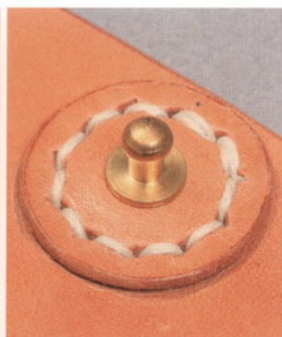
63 ギボシ受けにあけた穴に菱ガリを打ち、穴を貫通させる。穴をあけたらギボシ受けを縫う
