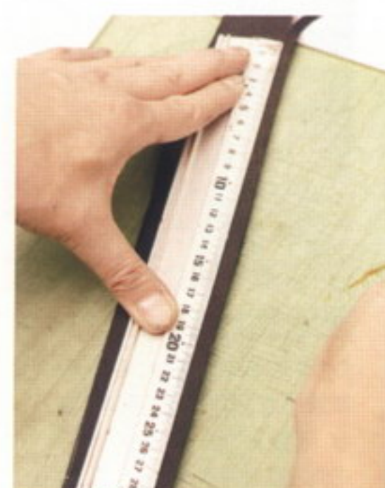
63 釣り紐は鹿革を6mm幅でカットして製作する
