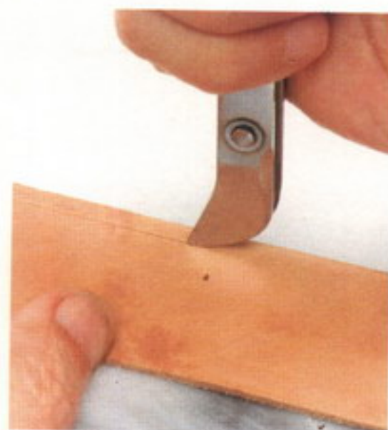
2 ネジ捻で3mm幅程度の外枠線を付ける
