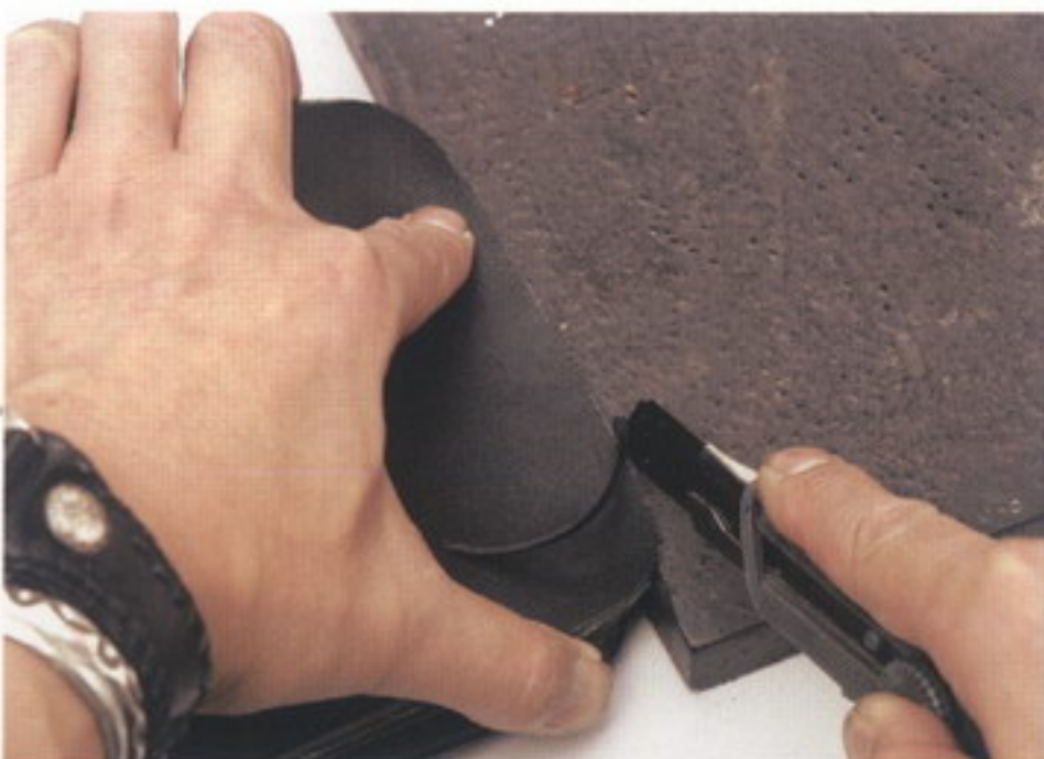
46 ボンドが乾いた後で、はみ出ている場所があるようならカットし、面取りする
