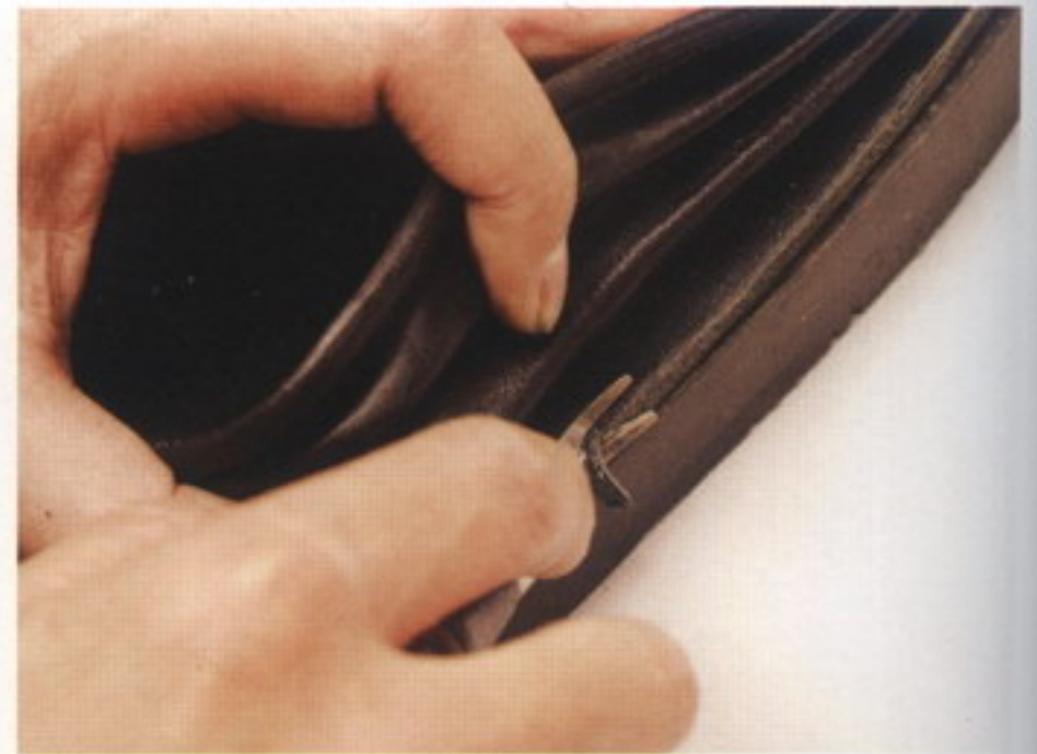
54 接着剤が乾いたら、合わせた部分の面取りをする。はみ出したボンドにも注意する
