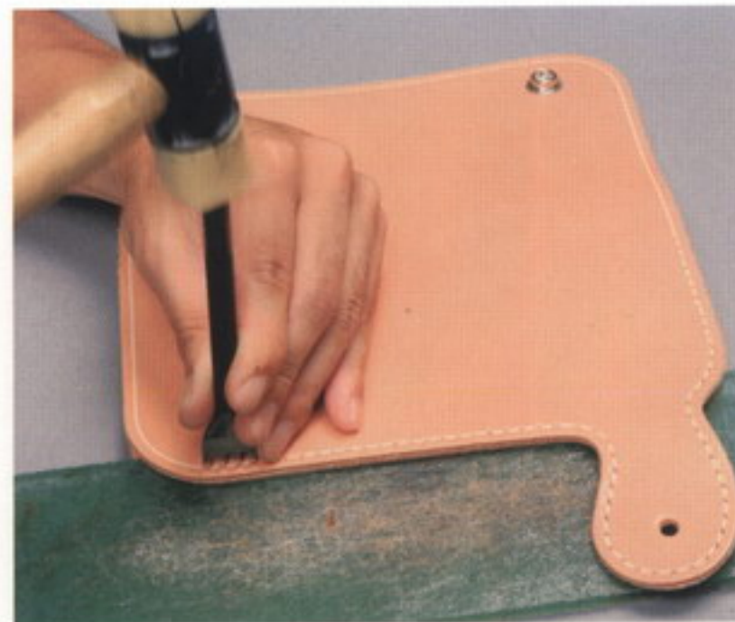
38 カード入れやポケットに穴があかないよう、間に板を挟んでヒシ目打ちを打っていく。段差部分はヒシ目打ちの間隔をうまく調節すること
