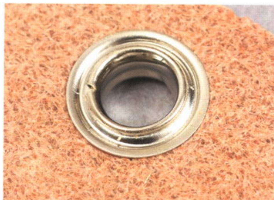
6 頭が潰れ、座金に被さって固定される。打ち込みすぎるとリングが変形するので注意すること
