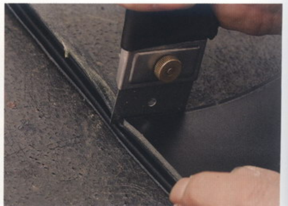
45 マチの余分を切り落とす。きちんと寸法で切ってしまうよりも、この方が失敗がない
