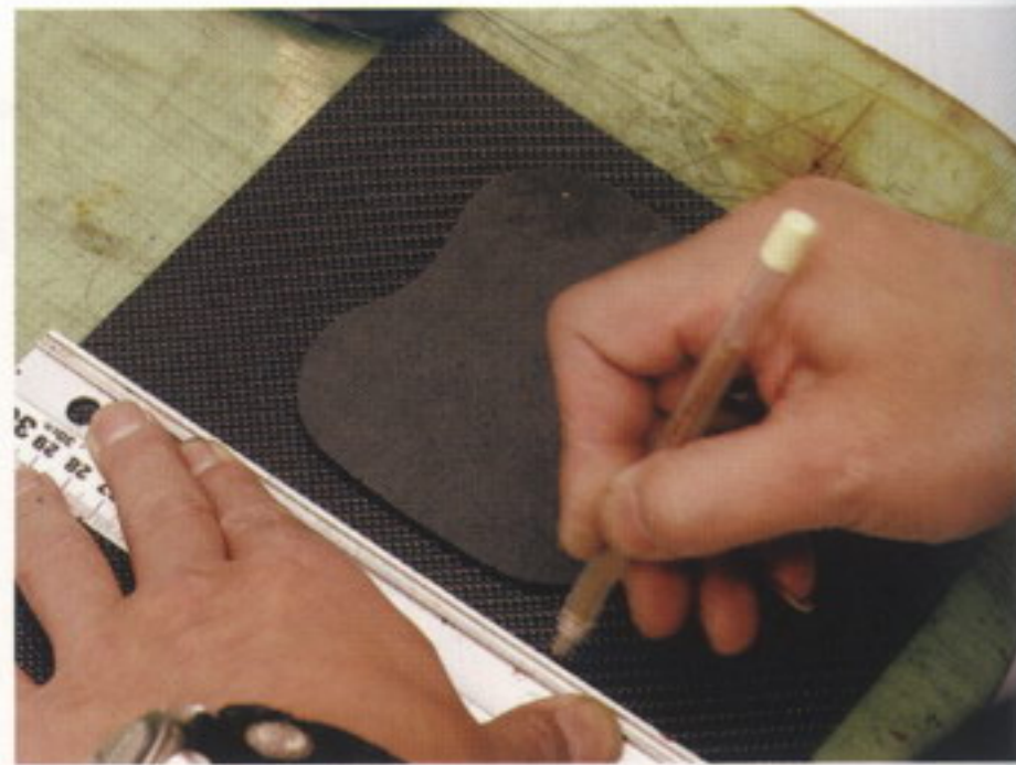
8 カーボンシートは自由度が高く、使いやすいハセプロ製。カットラインをマーキングする
