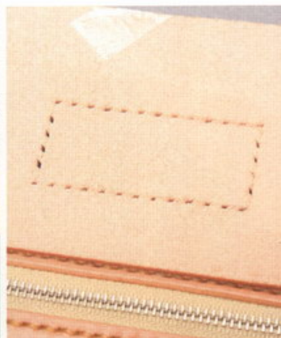
16 けがいた長方形にヒシ目打ちを打っていく。打つ時にパーツ同士がずれないように気を付けること
