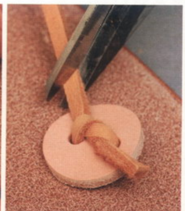
73 鹿革レースを穴に通し、固結びをしてコンチョを固定する。鹿革レースが長い場合はカットする
