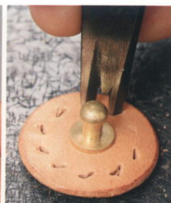
59 ギボシを付けてヒシ目打ちを打つ。Rがきついで2本ヒシ目打ちを使用すると良い
