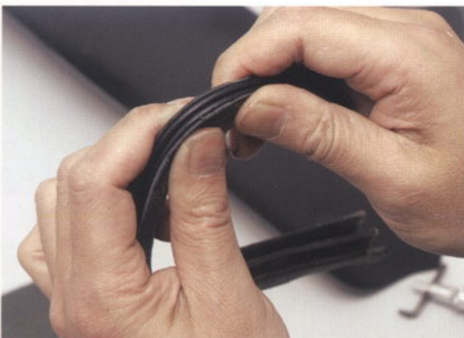
21 濡れている間に本体部分に合わせて角の部分も成型し、ゆっくりと力をかけて曲げる
