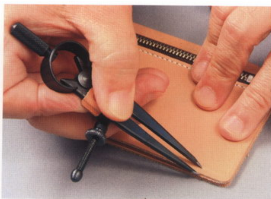
7 コインケースの表側に、ディバイダーで3mm幅の縫い線を付ける
