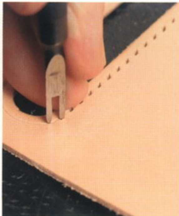
2 コインケースの口にヒシ目を打つ。直線は4本ヒシ目を使用し、曲線は2本ヒシ目を使用する
