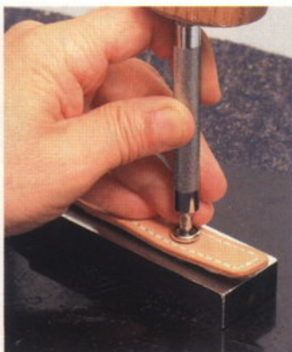
9 端から3.5cmの所に8号のハトメ抜きで穴をあけ、ジャンパードット中の凹を付ける。頭とプレートの窪みのサイズを合わせる
