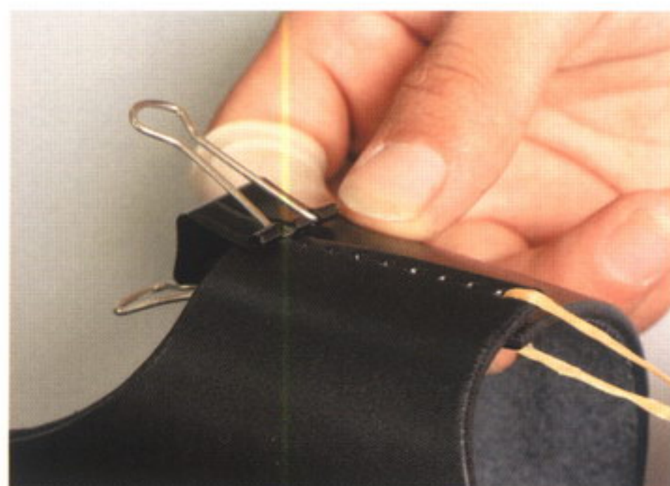
22 ホルダー1とホルダー2を縫い合わせていく。クリップで片側を固定しておくと縫いやすい
