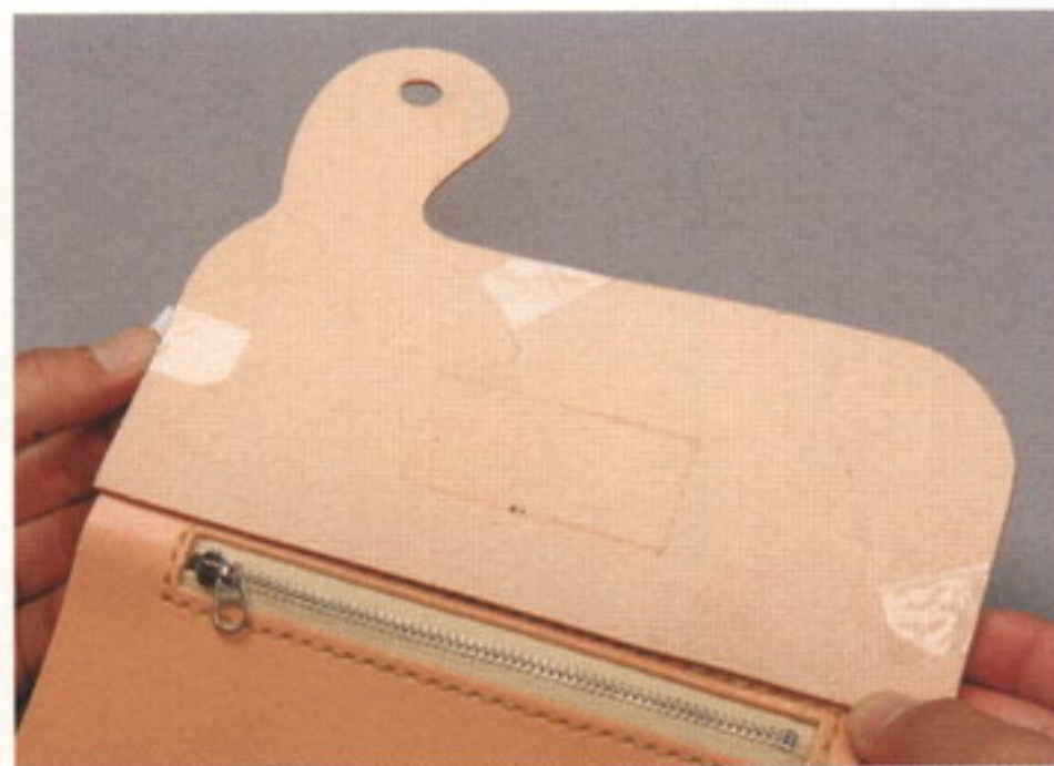
15 ポケット1とポケット2の角を合わせ、セロファンテープを貼って固定する
