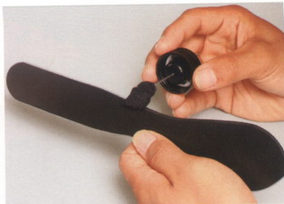
6 ヘリを落としたベルトとホルダー1、2の側面に、黒い染料を塗る
