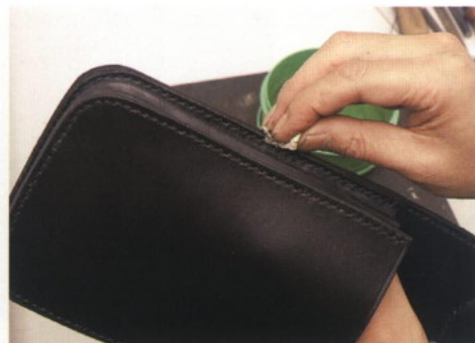
57 染色が終わったら、糊で磨いて本体を仕上げる。糊が乾いたら、最後はガラスで磨く
