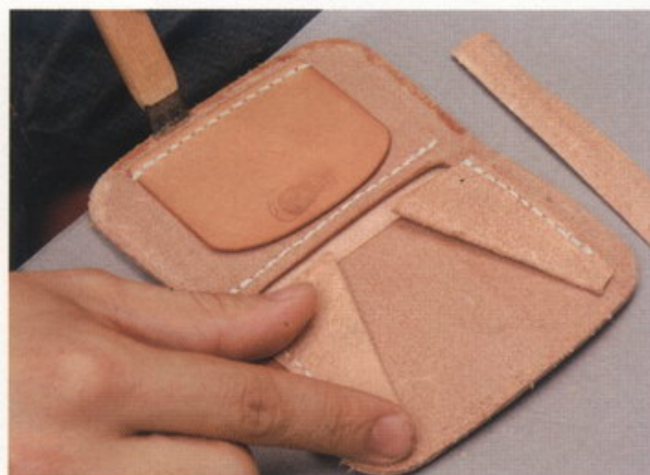
43 本体1のカードケース側と、マチ3の片側にゴム のりを塗る
