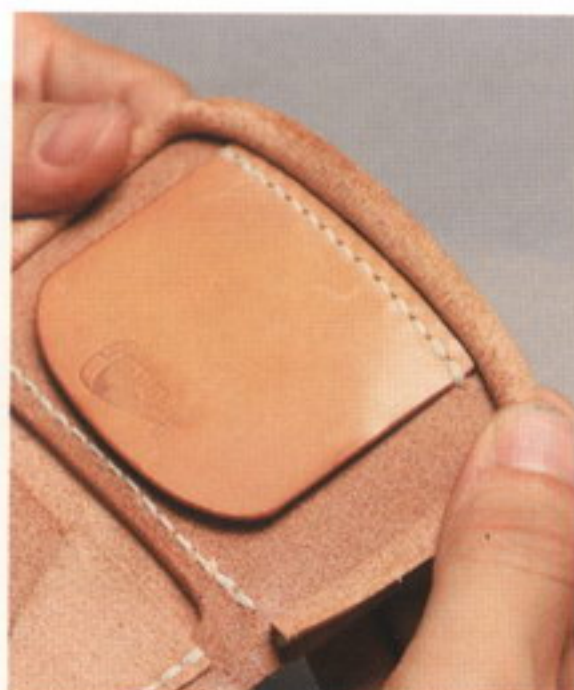
49 マチ3を折り曲げてくせをつけ、ゴムのりを塗って本体と貼り合わせる。ヒシ目の位置を合わせる
