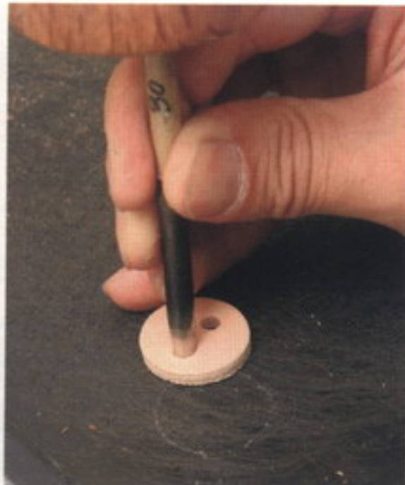
72 20mm程度のハトメ抜きで円形の革を抜き、中心に穴を2つあける。大径のハトメ抜きがない場合は切り出しても良い
