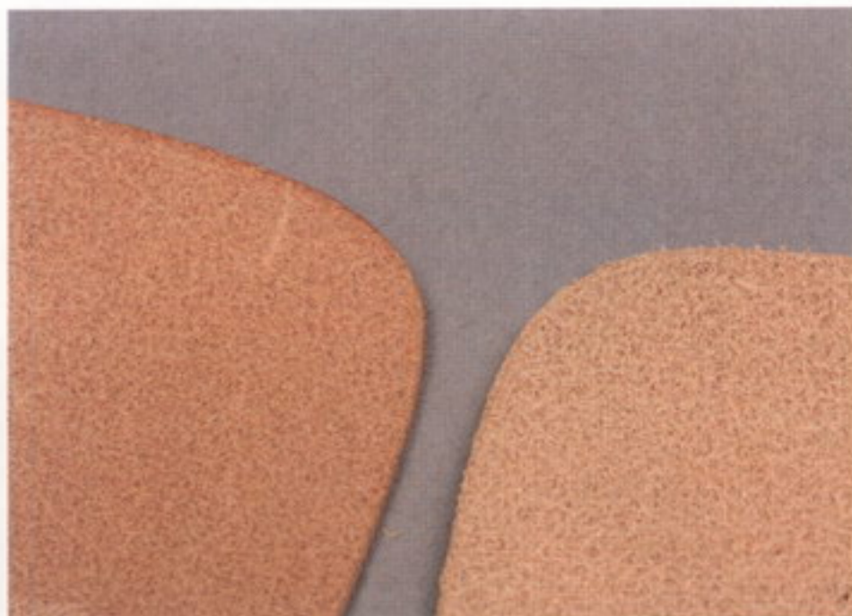
6 ふのりを付けて磨いたもの(左)と磨いていないもの(右)。磨くと光沢も出る
