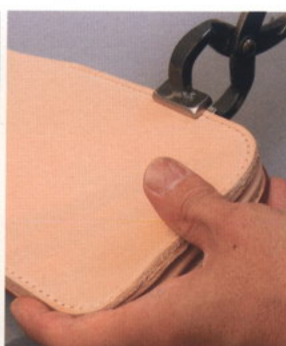
42 ボンドが半乾きになったら、マチと本体1を貼り合わせて圧着する。始めにマチの上部を本体1に付けた印に合わせて貼る
