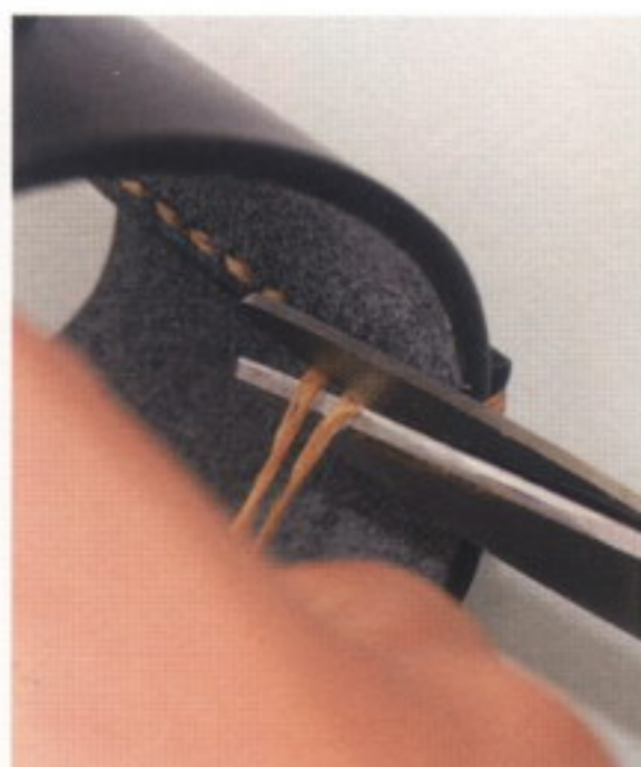
28 2mm程残して糸をカットする
