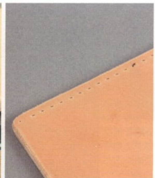
11 途中まで打った穴は、全て菱ギリで貫通させていく。手間はかかるが、縫い目をきれいに仕上げるためのポイントだ
