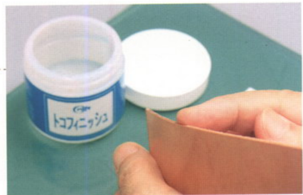
1 トコフィニッシュを側面に薄く塗る。革が薄い場合は、はみ出ないように気をつけること
