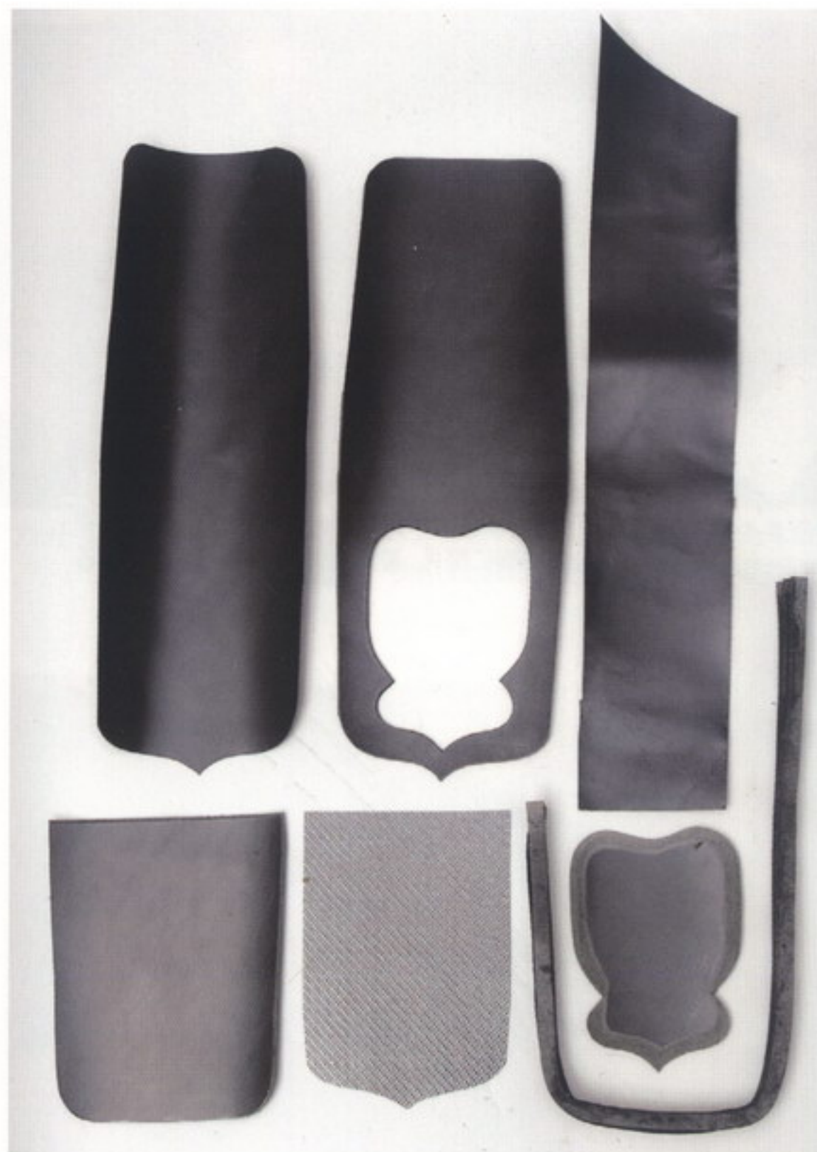
22 完成したパーツ。右上の革は紐を作るための物。濡れているパーツは完全に乾いてから使用すること
