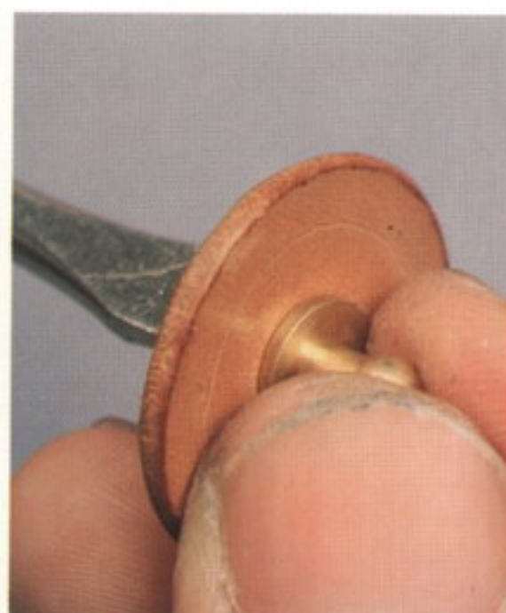
59 ギボシを付けてヒシ目打ちを打つ。Rがきついで2本ヒシ目打ちを使用すると良い
