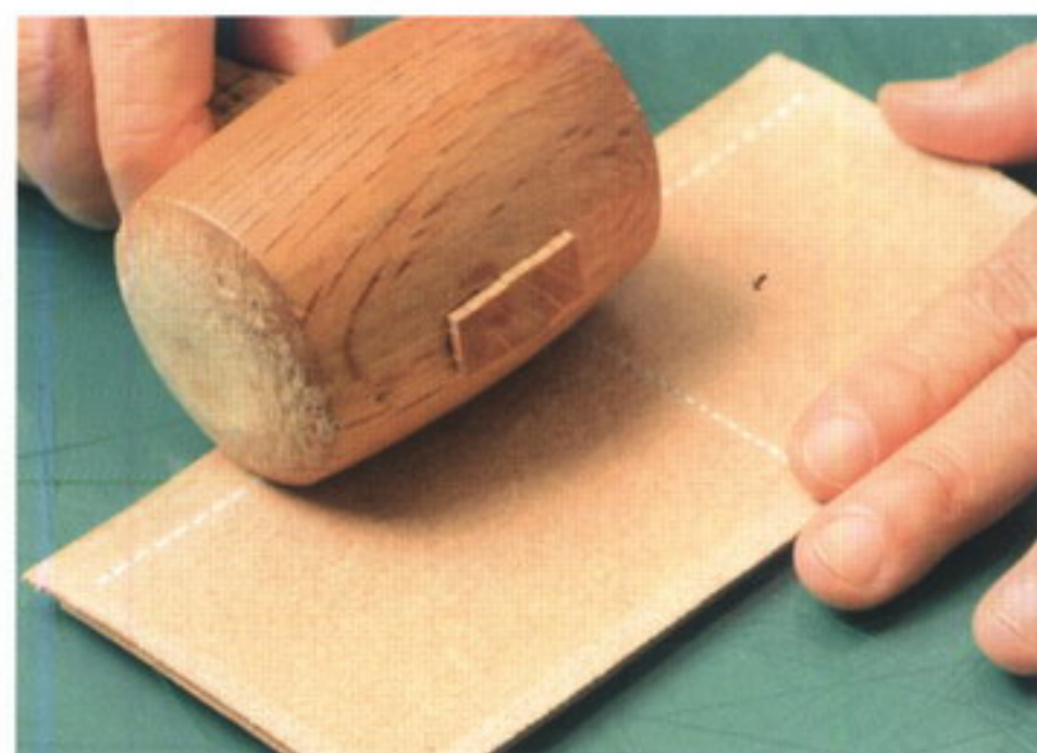
11 木槌の腹を使って軽く縫い目を叩く。こうすることで糸が馴染み、手触りも良くなる
