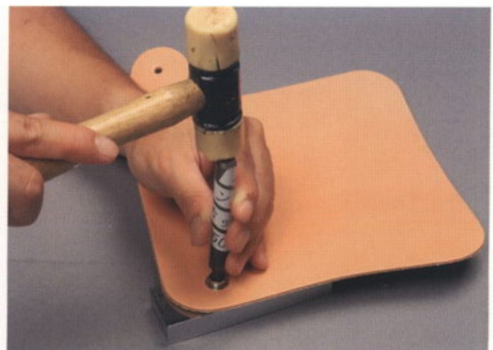
33 オールマイティプレートの上に乗せ、ジャンパードット打ちでジャンパードットを固定する
