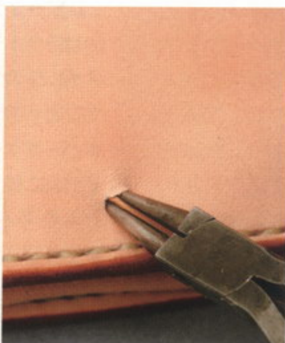
74 本体1の下部に丸ギリで穴をあけ、丸ペンチでレースを入れる。丸ギリでマチを傷つけないように気を付けること
