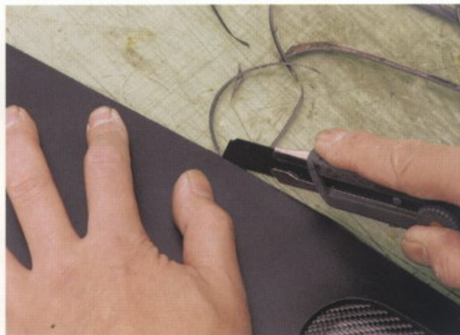
32 全周を確認して切り揃え、本体と裏のパーツの大きさをしっかり合わせる
