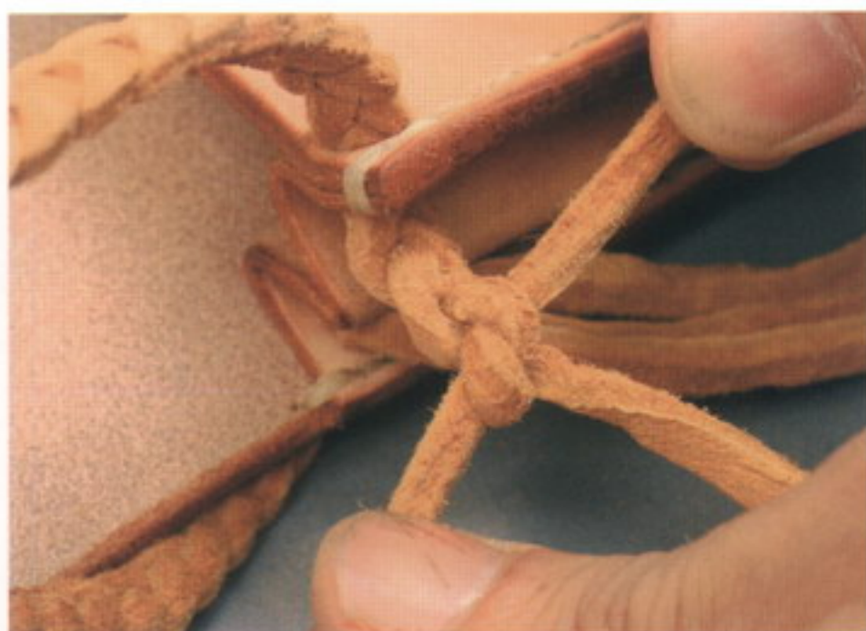
64 3本の皮革レースのうち、2本を固結びしてループの位置を固定する
