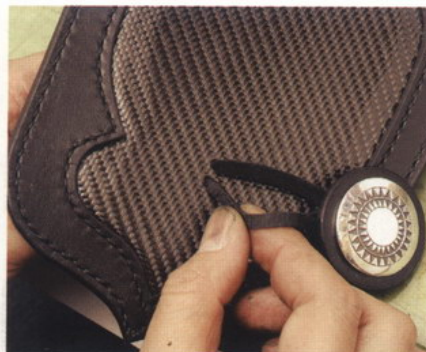
59 ベースを取り付けたコンチョを、革紐で蓋の部分に取り付けていく
