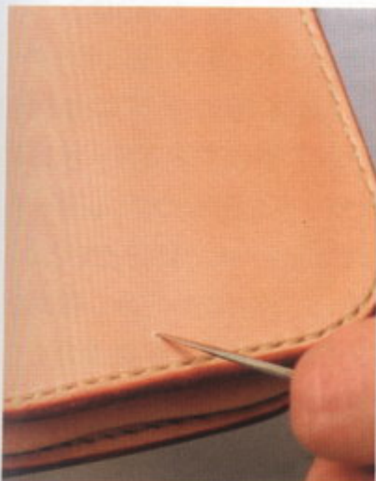
74 本体1の下部に丸ギリで穴をあけ、丸ペンチでレースを入れる。丸ギリでマチを傷つけないように気を付けること
