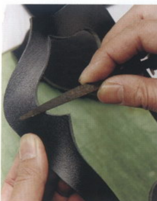
3 革の切断面の角が丸くなるように、ヤスリやカンナを使用して面取りしていく。落としすぎないように、少しずつ進める
