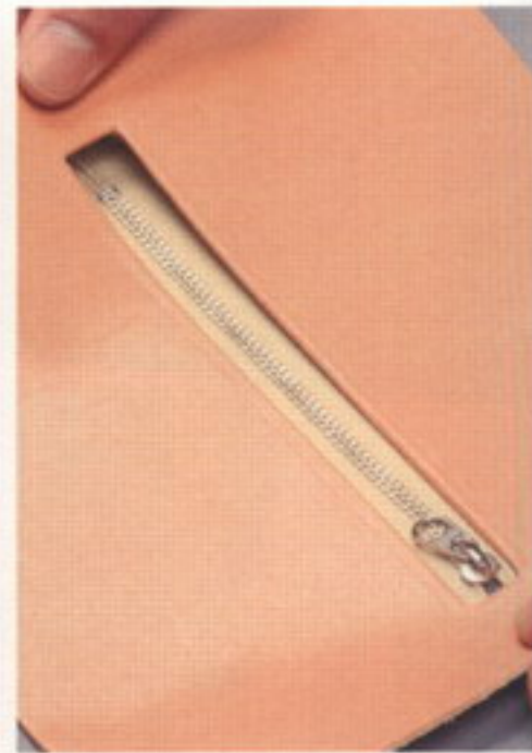
7 ファスナーに3mm幅の両面テープを貼る。ポケット1の裏側からファスナーを貼って固定する。ファスナーが曲がらないように気を付けること
