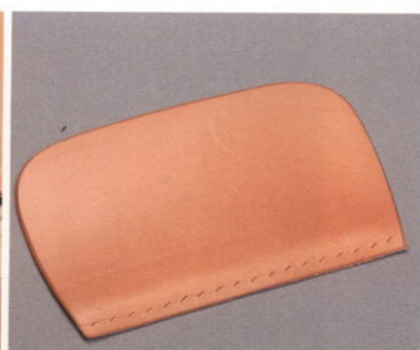
31 コインケース口の上をドレッサーで擦って荒らし、本体2に縫い線を引いてヒシ目打ちを打つ。これはコインケースのカバー部分となる
