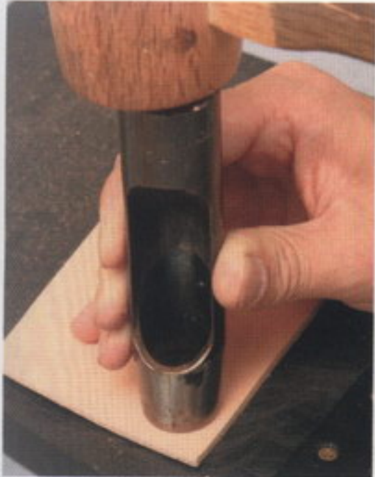
72 20mm程度のハトメ抜きで円形の革を抜き、中心に穴を2つあける。大径のハトメ抜きがない場合は切り出しても良い
