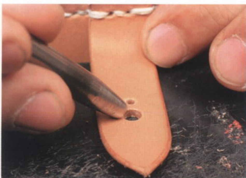
65 印を付けた位置に、ハトメ抜きで穴をあける。穴の大きさはギボシの大きさに合わせる
