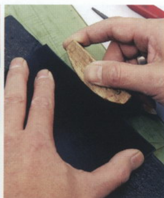
3 革の切断面の角が丸くなるように、ヤスリやカンナを使用して面取りしていく。落としすぎないように、少しずつ進める
