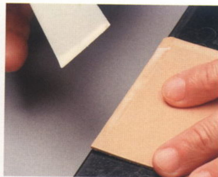
4 荒らした面に接着剤を塗る。どんな接着剤でも薄く塗ること
