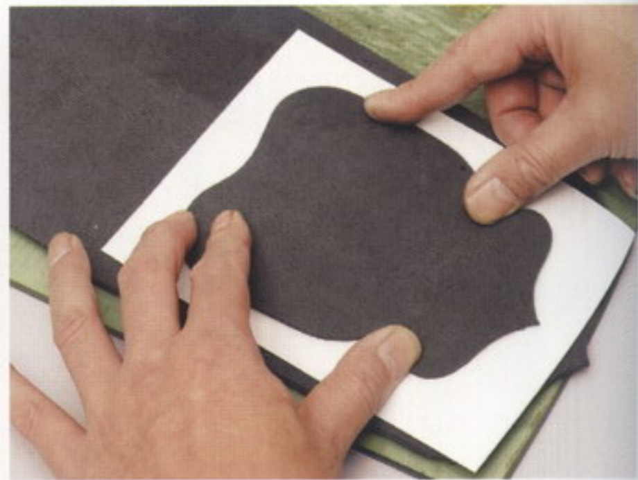
10 本体の窓の部分にカーボンシートを合わせ、切り出した窓の部分の革を当てて型押しする
