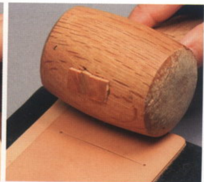
6 革を貼り合わせたら、指で押してしっかりと圧着する。木槌の腹で軽く叩いたり、ローラーを使って圧着しても良い
