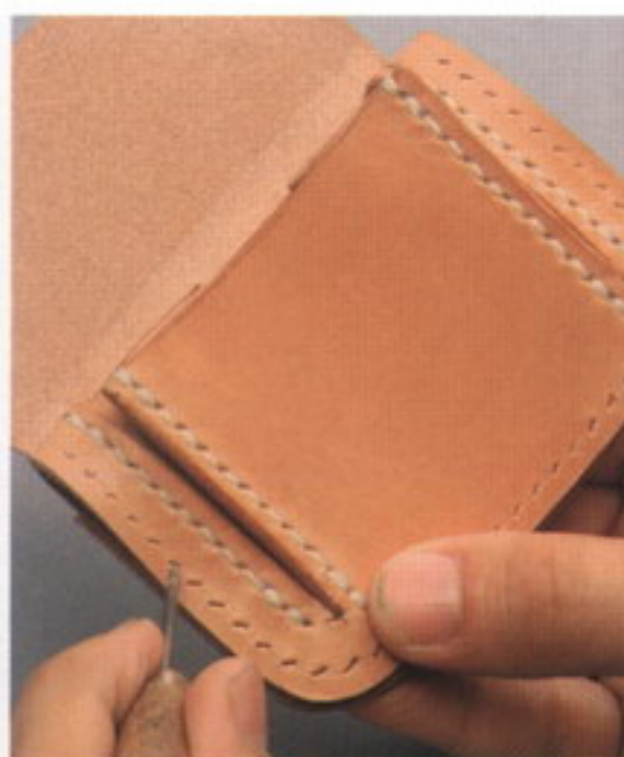
40 本体1にあけたヒシ目の数を数える。その数とマチ3の穴数を合わせ、余分な部分をカットする
