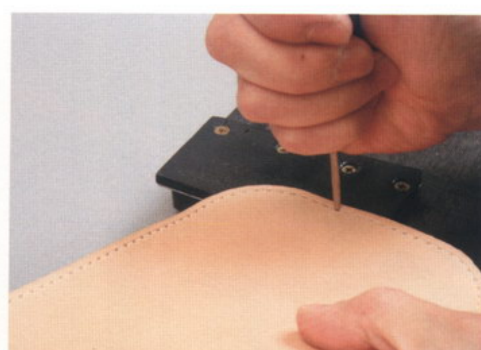
43 マチの間に薄いゴム板を挟んで、菱ギリでひとつひとつ穴を貫通させていく
