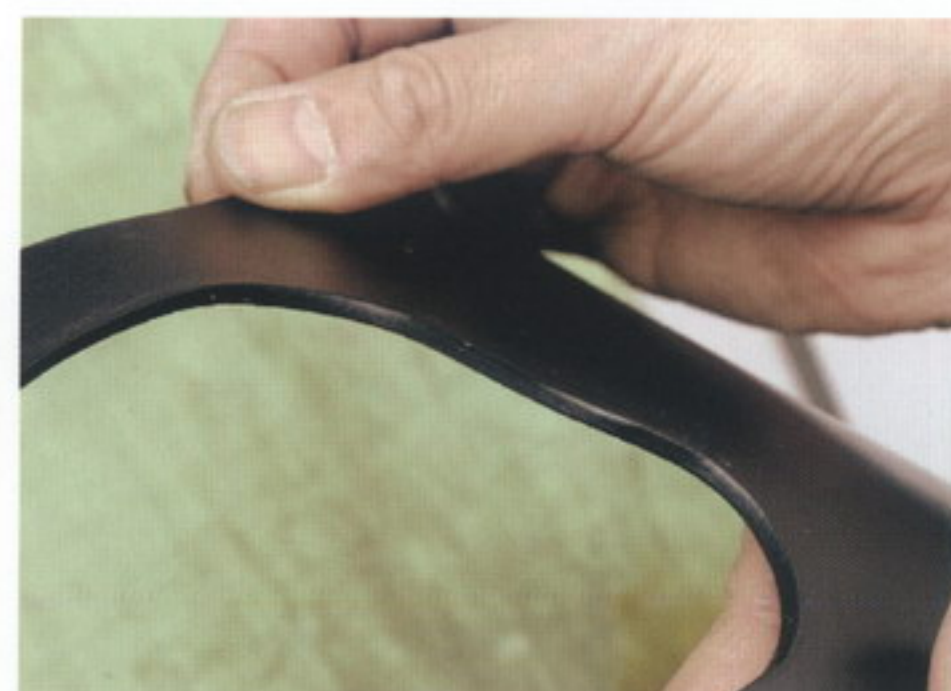
6 切断面が仕上がった状態。生成の革の場合は、ロウを使用する場合もある
