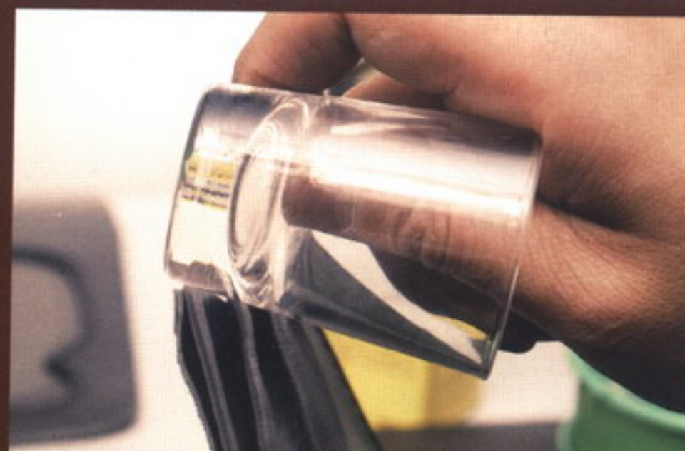
最後はガラスで磨くのだが、萩原氏はこのように指を入れて磨けるショットグラスを使っている
