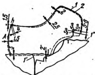
Рис. 48. Построение кожаной подкладки под берцы.
