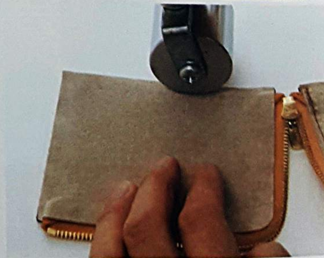
圓角旁的縫線則用雙面膠帶黏合，最後用滾輪壓黏。
