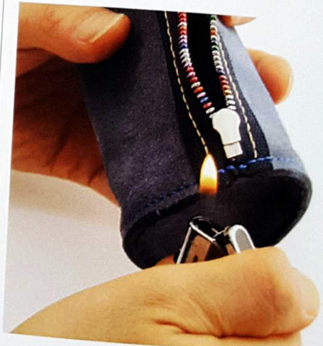
33 若切掉了拉鏈布的邊緣，要用打火機處理免拉鏈布綻線。
