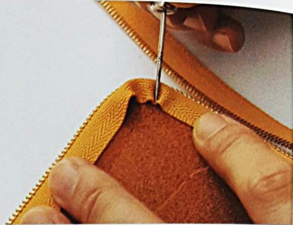
拉鏈布正面兩側貼上2mm寬的雙面膠帶。
