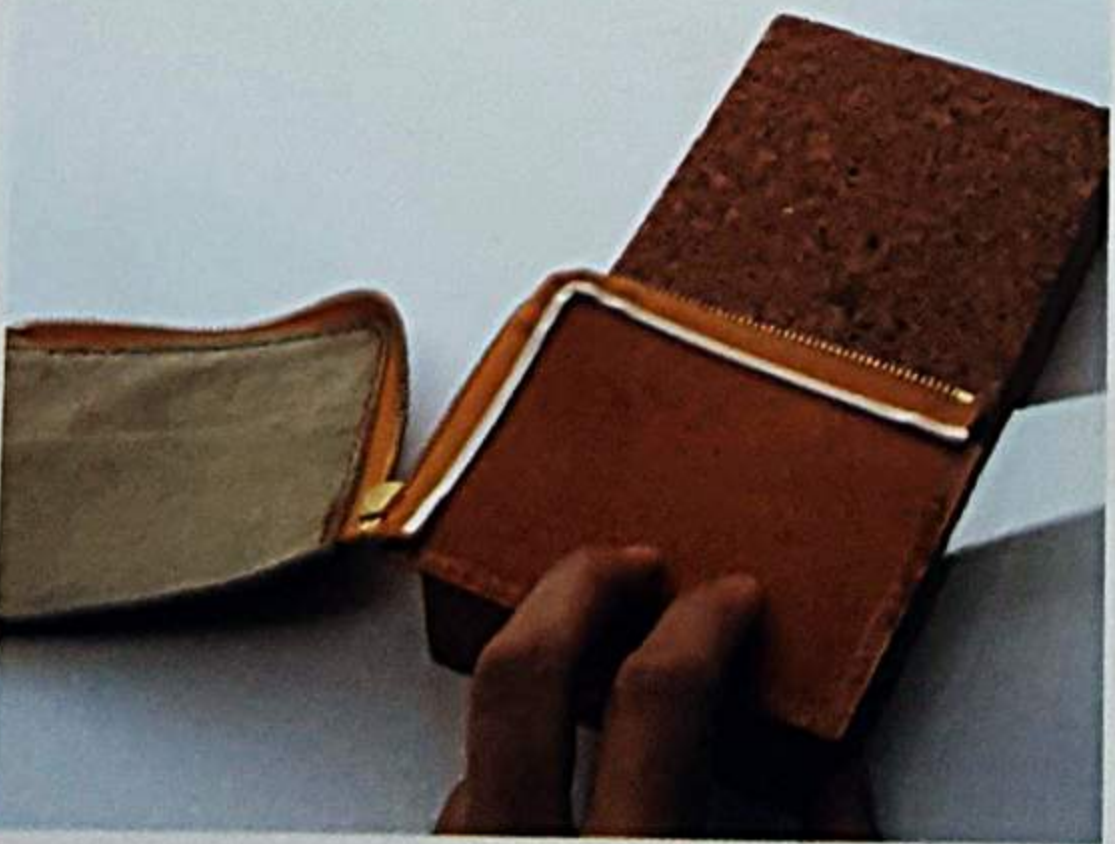
拉鏈布邊緣貼上 2mm 寬的雙面膠帶，連接包側的邊與底邊則塗上橡膠糊。
