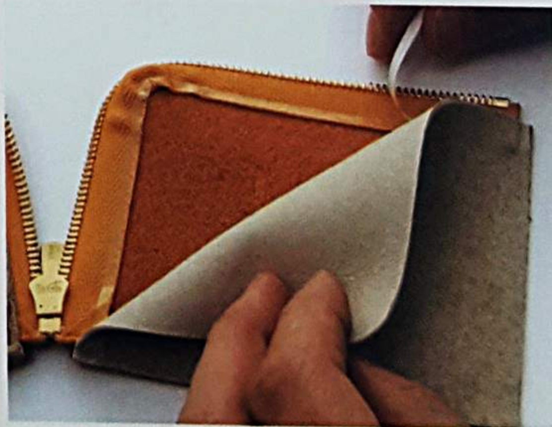
拉鏈布邊緣貼上 2mm 寬的雙面膠帶，連接包側的邊與底邊則塗上橡膠糊。
