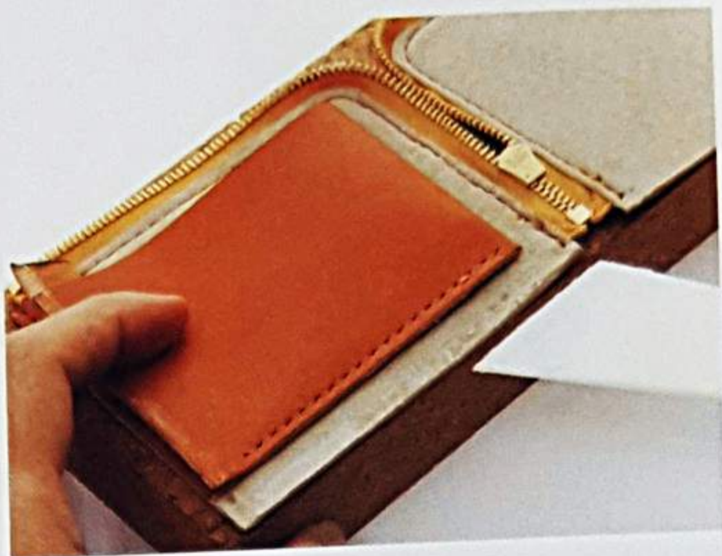
從上角開始縫，縫線先跨過上邊3次進行補強。
