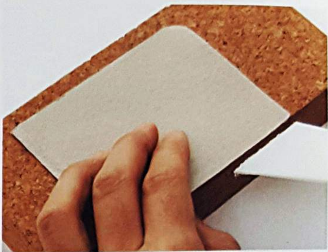
內襯背面的包側連接邊與底邊塗上橡膠糊。
