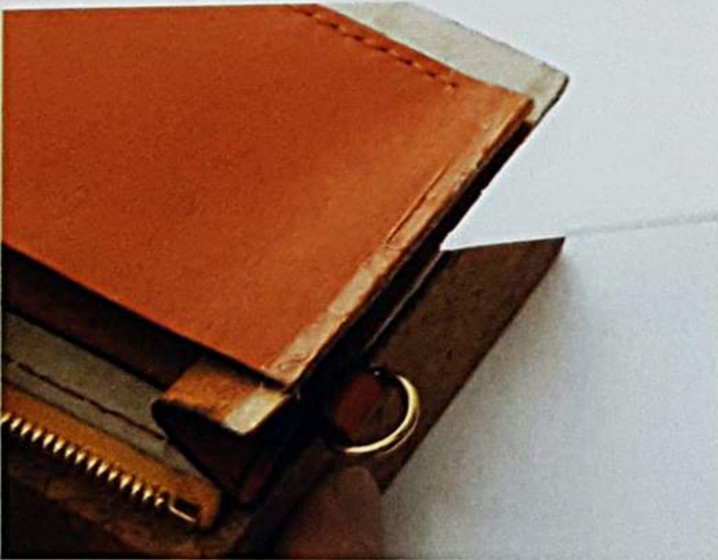
包側另一側的邊緣塗上橡膠糊。
