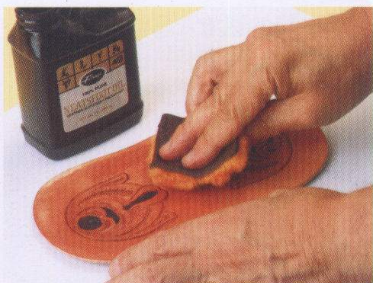
①以羊毛片沾取牛腳油，均勻地塗在皮革上，靜至數小時讓油滲入皮革內。
