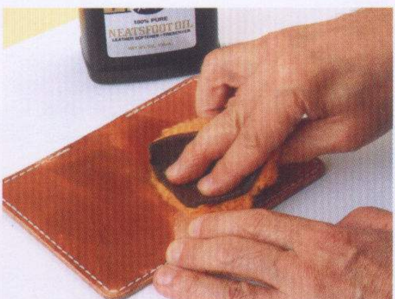
②將皮革全都塗上牛腳油之後，靜置數小時讓油滲入皮革內。
