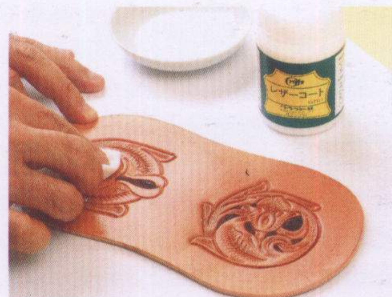
②以棉布沾取皮革亮光乳液，塗在整片皮革上，陰乾即可。
