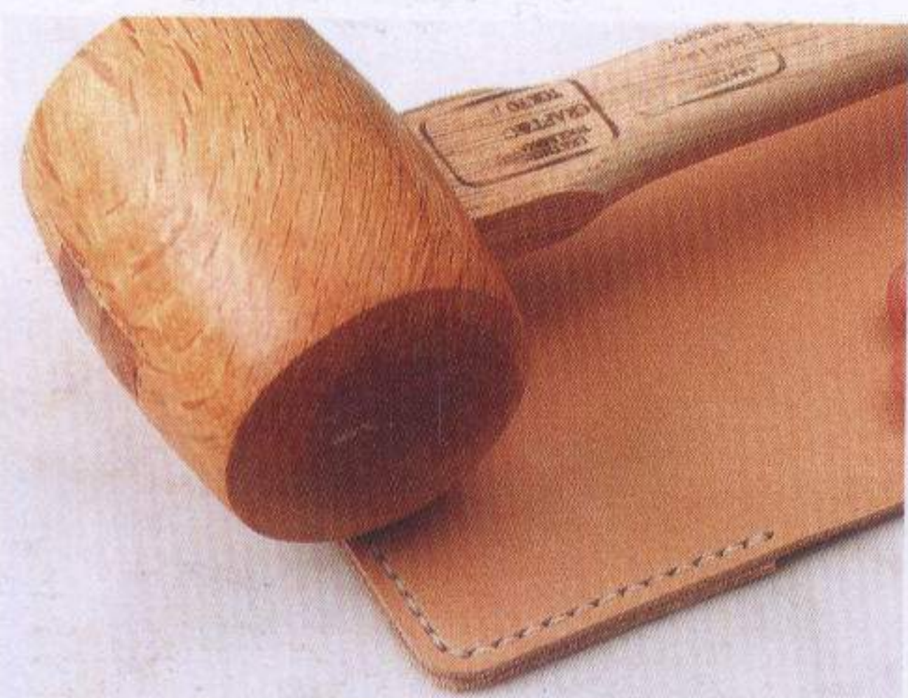
⑫為了不傷到皮革，以木槌的側面輕敲針腳，讓縫線與皮革合而為一。
