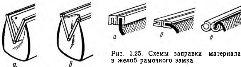
Рис. 1.24. Рамочный замок с заправкой (а) и без заправки (б) боковых частей сумки
