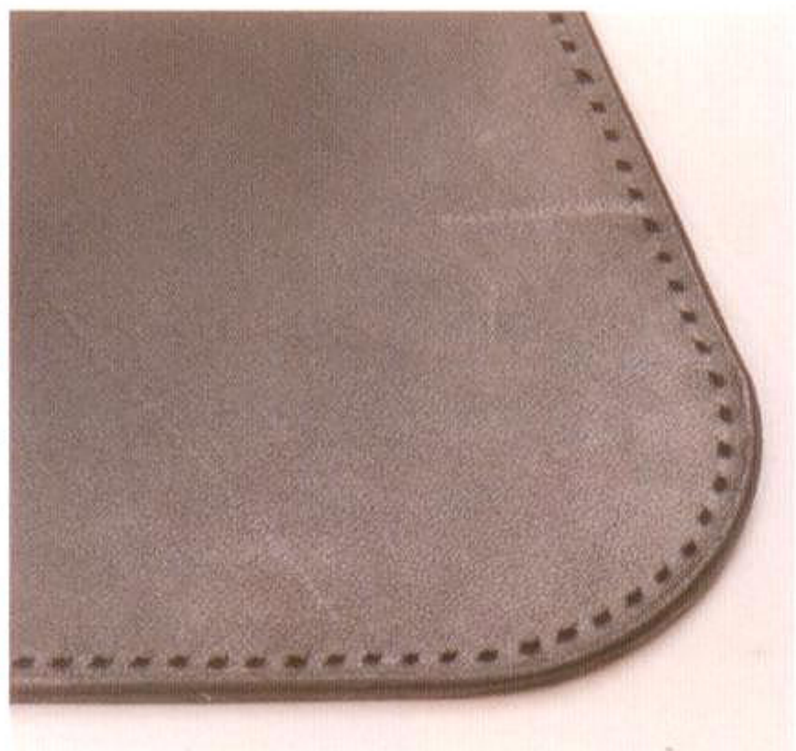
縫い穴を空けていく。カーブしている部分は2本ヒシ目打ちを使い、カーブに沿って穴を空けていく。間隔がずれないように注意すること
