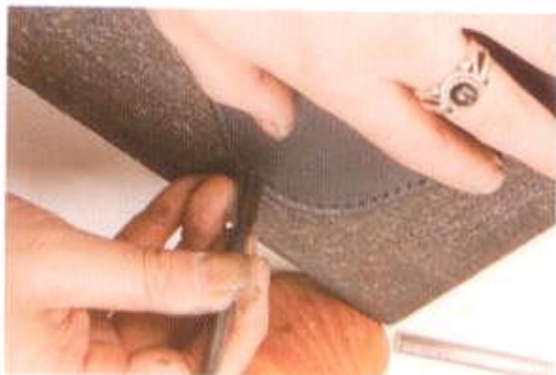
11 縫い穴を空けていく。カーブしている部分は2本ヒシ目打ちを使い、カーブに沿って穴を空けていく。間隔がずれないように注意すること
