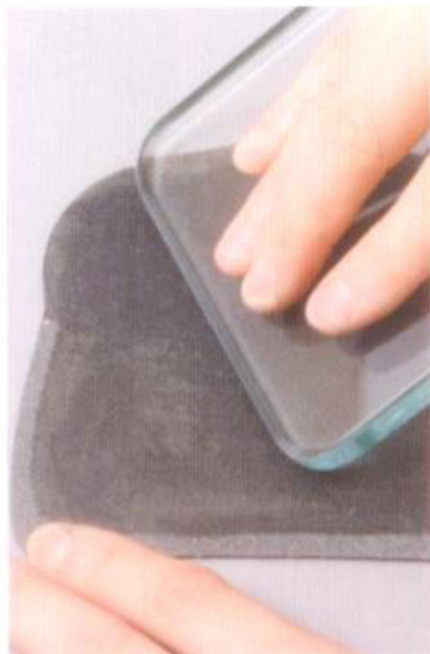
17 トコノールを塗ったら、革の目に沿ってガラス板で磨く。 右の写真のように、縫いしろ以外の床面を全て磨く
