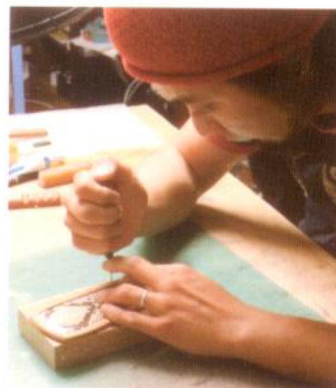
26 ディバイダーで跡を付けたら、菱ギリで穴を空けていく。穴を空け終わったら、針と糸を外周と内周の2セット分用意する
