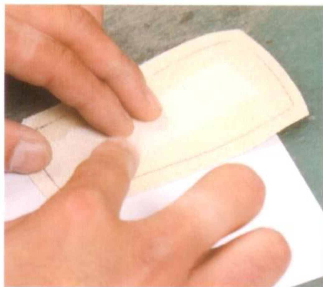
12 ボールペンで書いたラインの内側とアンコの表面に、接着剤を塗る
