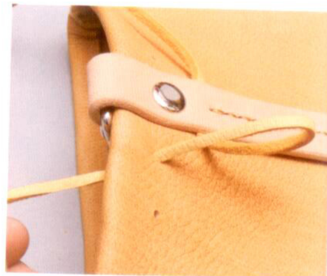
7 ハトメ抜きで空けた穴に鹿ヒモを通す。鹿革は柔らかいので、穴が小さくても大丈夫だ
