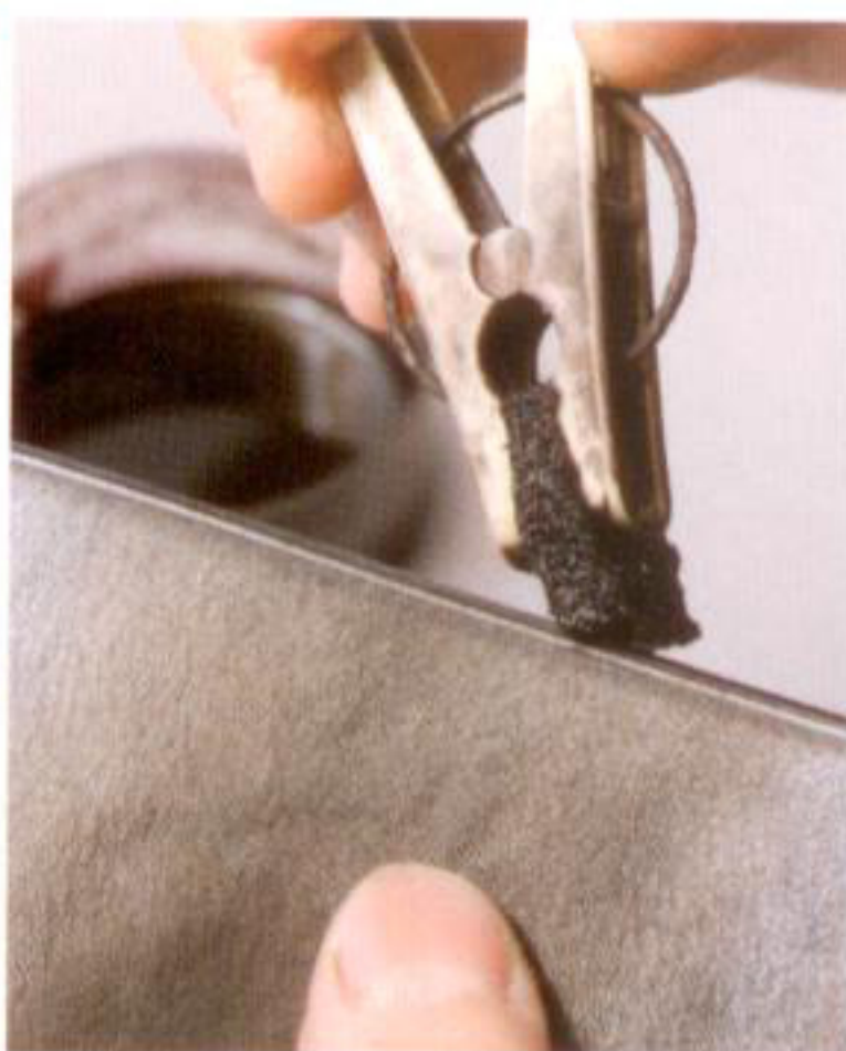
13 再びサンドスティックでヘリとコバを整え、染料を塗る。 染料はフェルトを使って塗っている
