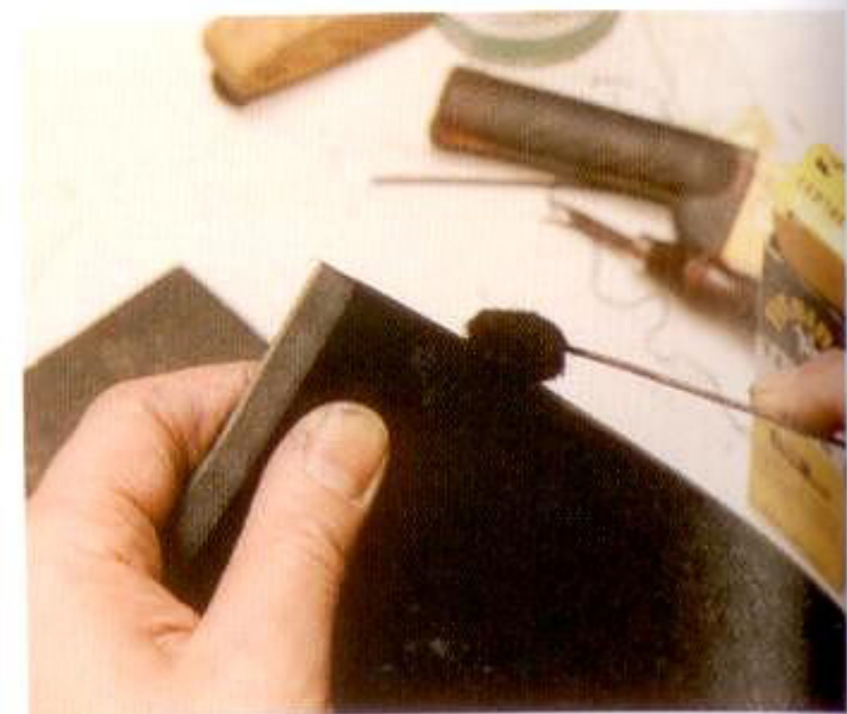
19 縫い合わせた部分のコバを仕上げる。ヘリを落として染色し、磨いて仕上げる
