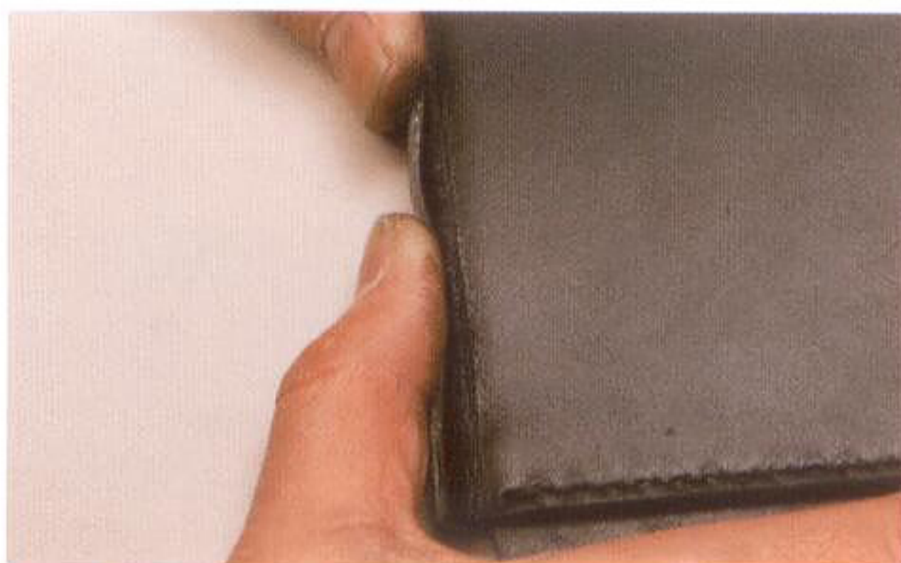
15 折れ線に沿ってマチの縁を折り曲げていく。この折り曲げた部分が本体との縫いしろになる
