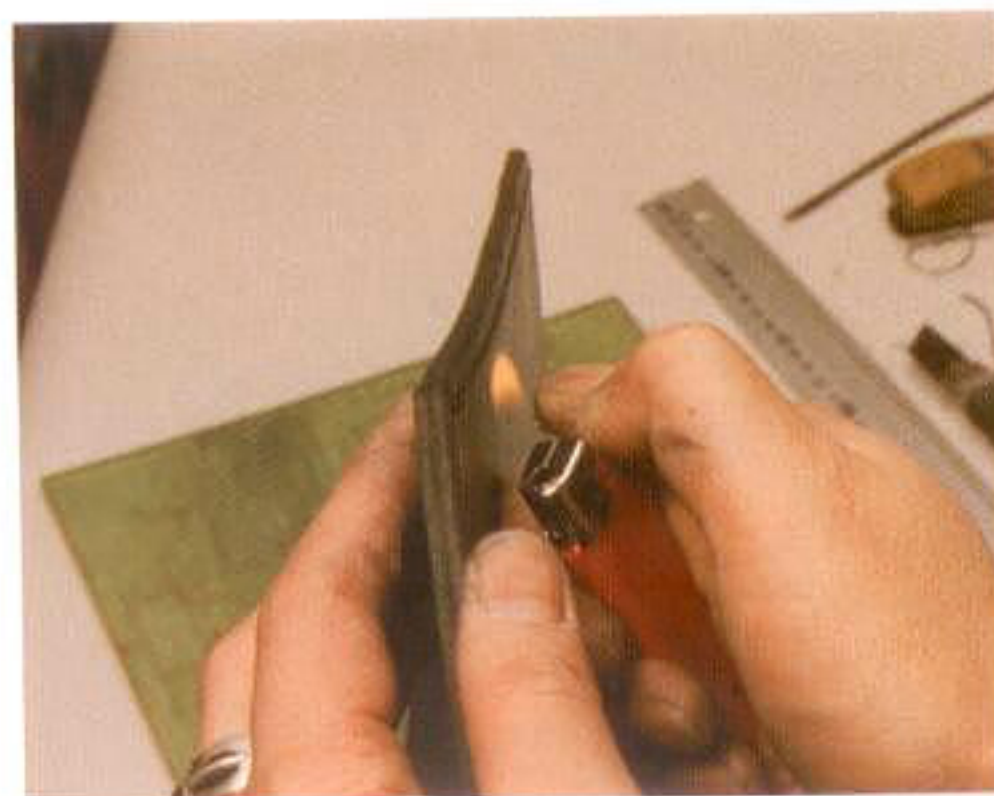
18 切った糸の端をライター等の火であぶって溶かし、縫い目に押しつけて留める
