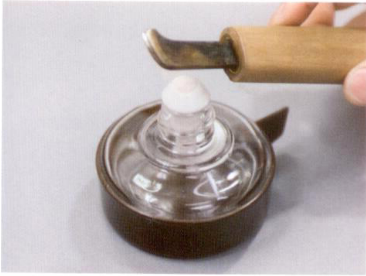
11 アルコールランプに火を付け、飾り捻を熱する。 熱しすぎると革が焦げてしまうので注意
