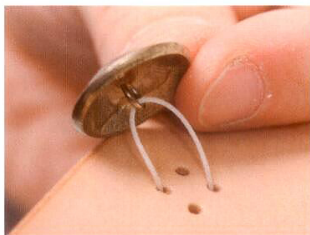
2 表側に出た糸をコンチョの丸カンに通し、対角線上の穴に再び通す
