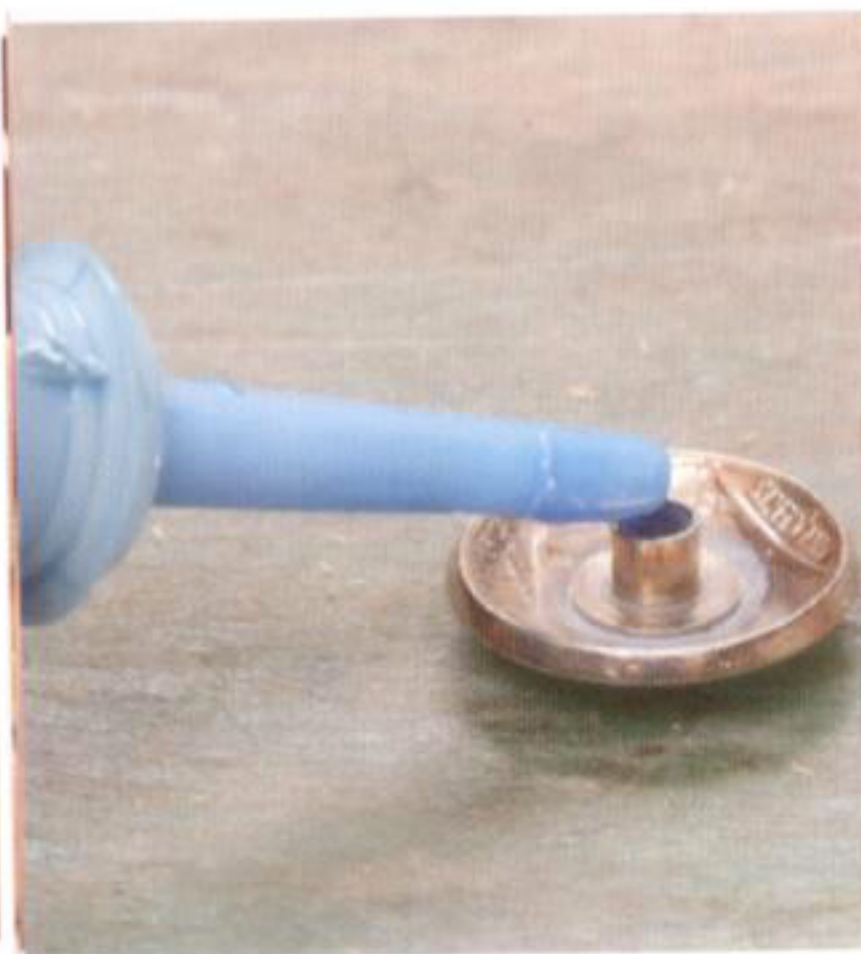
16 蓋のコンチョ穴を元に、アンコとヘビ革にも8号の穴を空け、コンチョにネジロック剤を付けてネジを締める
