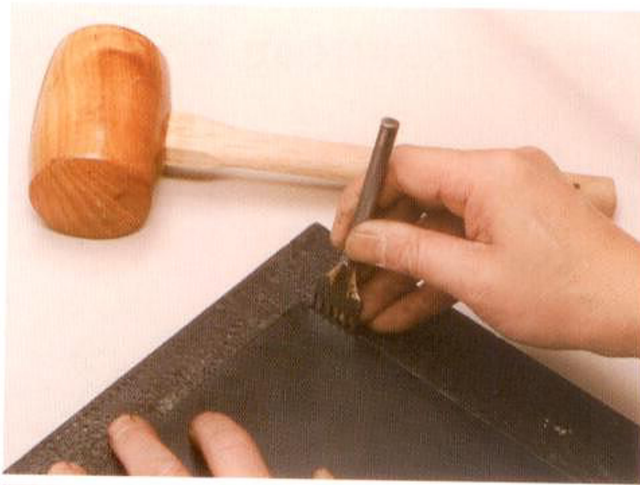
13 縫い線に合わせてヒシ目打ちを打っていく。まずはヒシ目打ちを縫い線に合わせてセット
