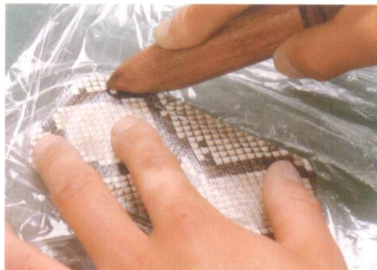
14 剥がれやすいようにビニール袋を敷き、ヘビ革を上にしてウッドスリッカー等で擦って圧着する
