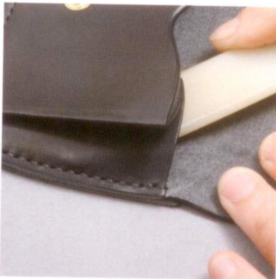
9 袋状になっている縫い目部分は、接着剤が固まっている場合があるので、ヘラで剥がして広げておく
