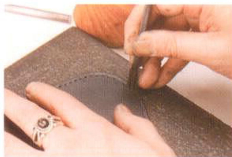
縫い穴を空けていく。カーブしている部分は2本ヒシ目打ちを使い、カーブに沿って穴を空けていく。間隔がずれないように注意すること
