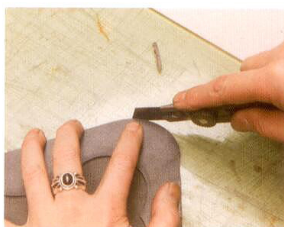
5 はみ出している部分を切り、形を補正する。切りすぎないように注意すること
