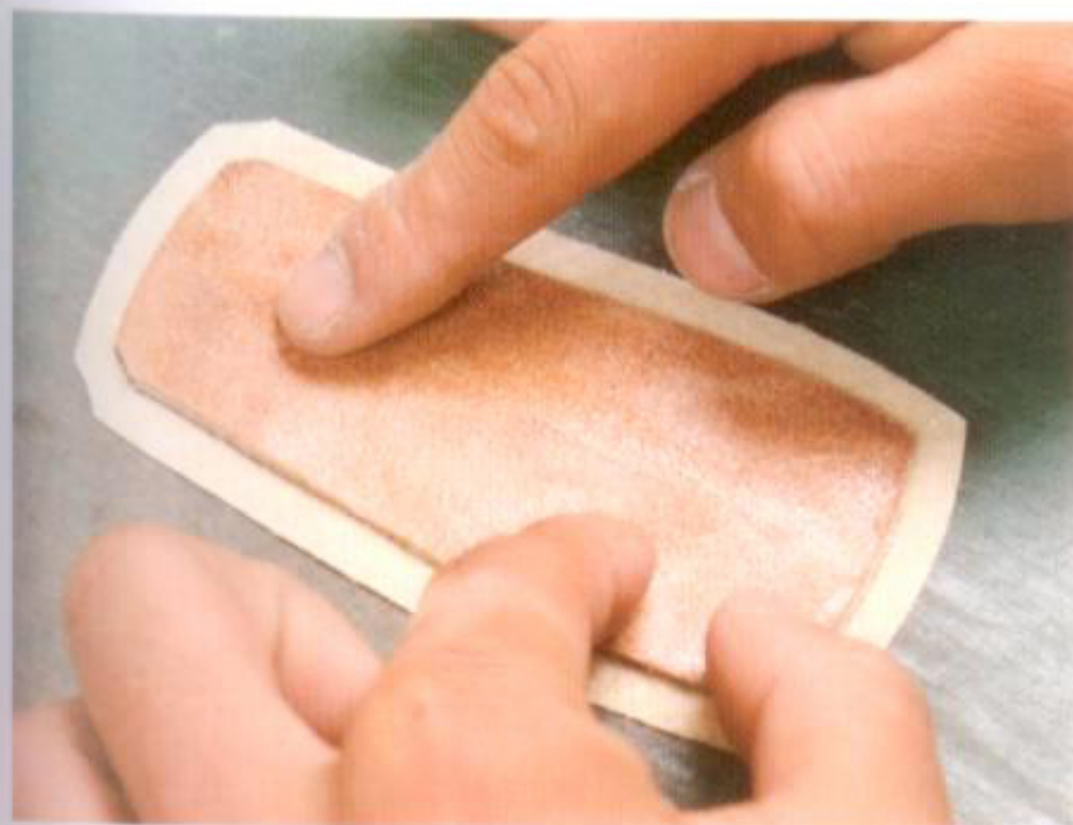
13 アンコをヘビ革に貼り付け、アンコの裏側にも接着剤を塗る
