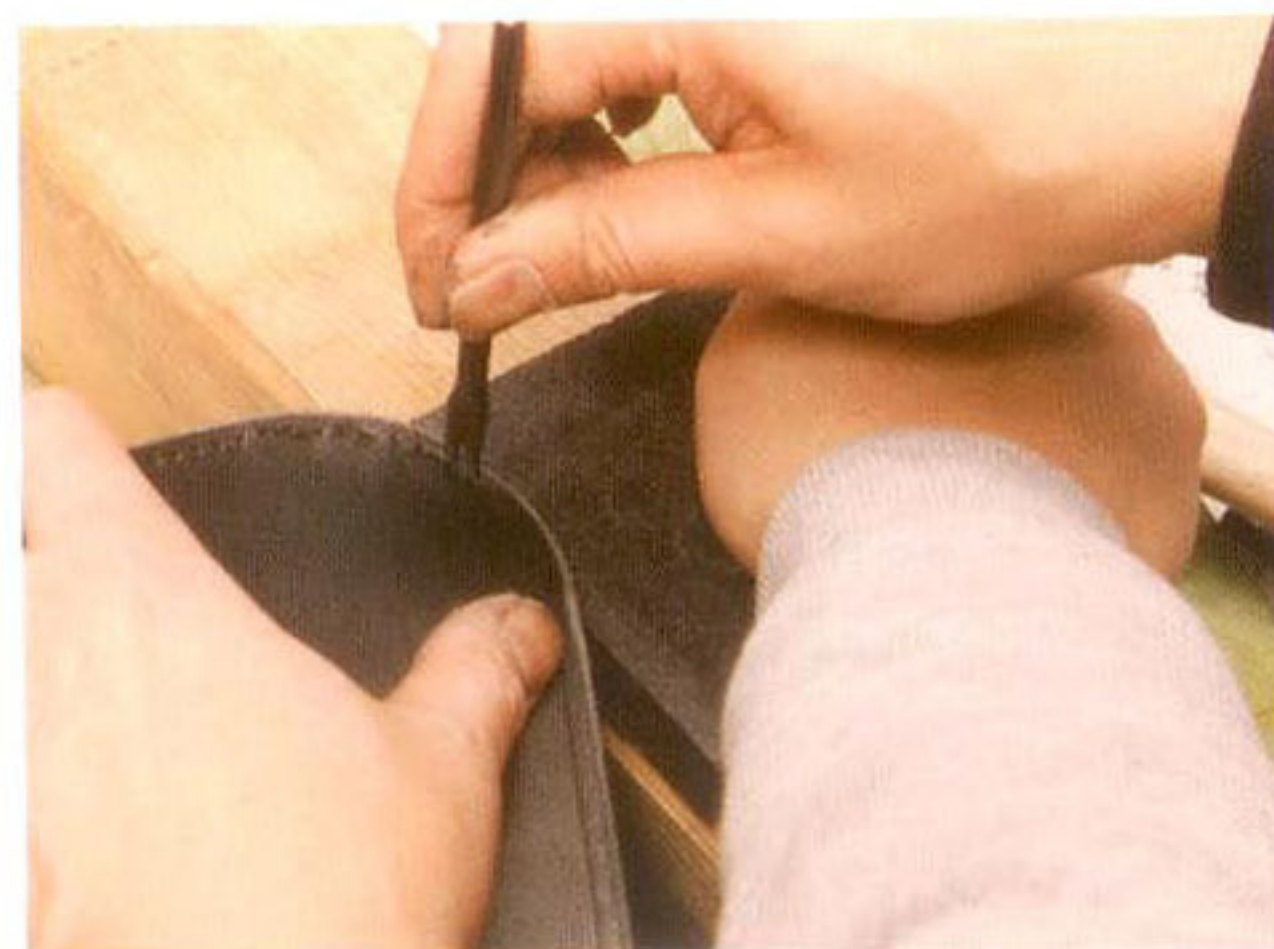
14 台から外れないように、サポートを頼んで押さえつけながらヒシ目を打っていく
