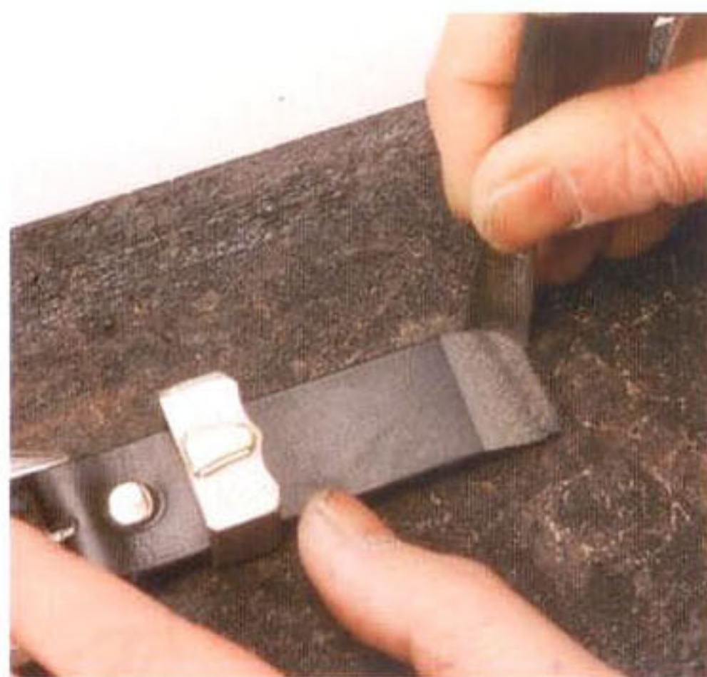
9 バックルのベルト部分の下側は斜めにすき、角を丸く落としておく
