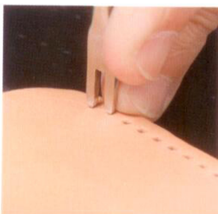
5 カーブしている部分は2本ヒシ目打ちを使用する。これにより、縫い穴や縫い目がきれいな曲線に仕上がる
