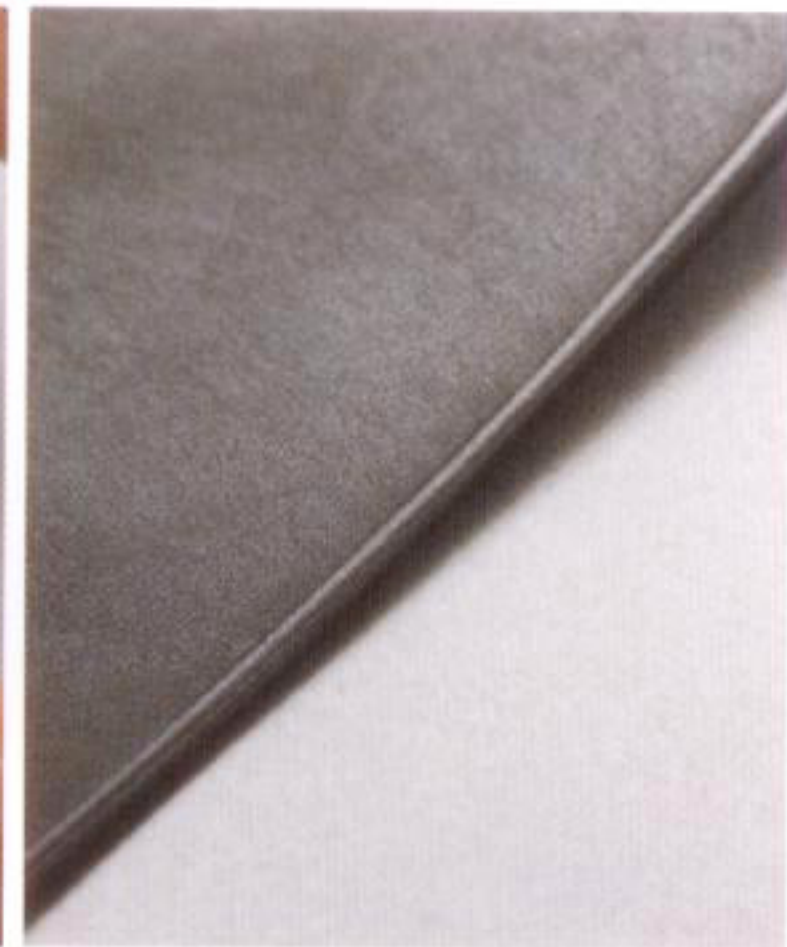
12 ネジ捻と同じようにラインに沿って引く。見た目以外に、 熱によって革の繊維が締まり、補強される効果がある
