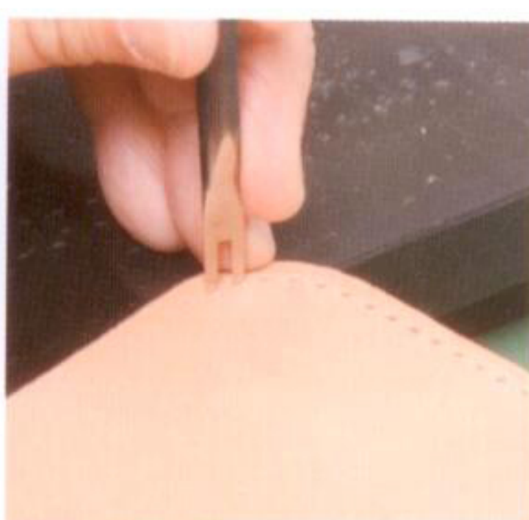
5 カーブしている部分は2本ヒシ目打ちを使用する。これにより、縫い穴や縫い目がきれいな曲線に仕上がる
