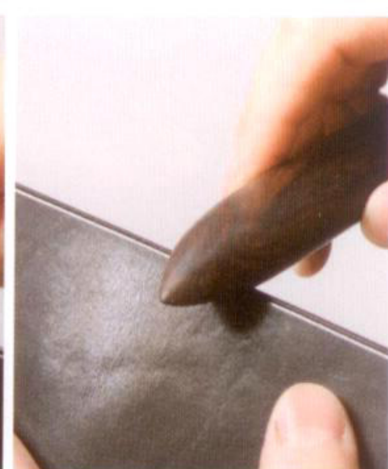
14 トコノールを塗ってウッドスリッカーで磨く。1回目は CMC、2回目はトコノールを使用して磨く
