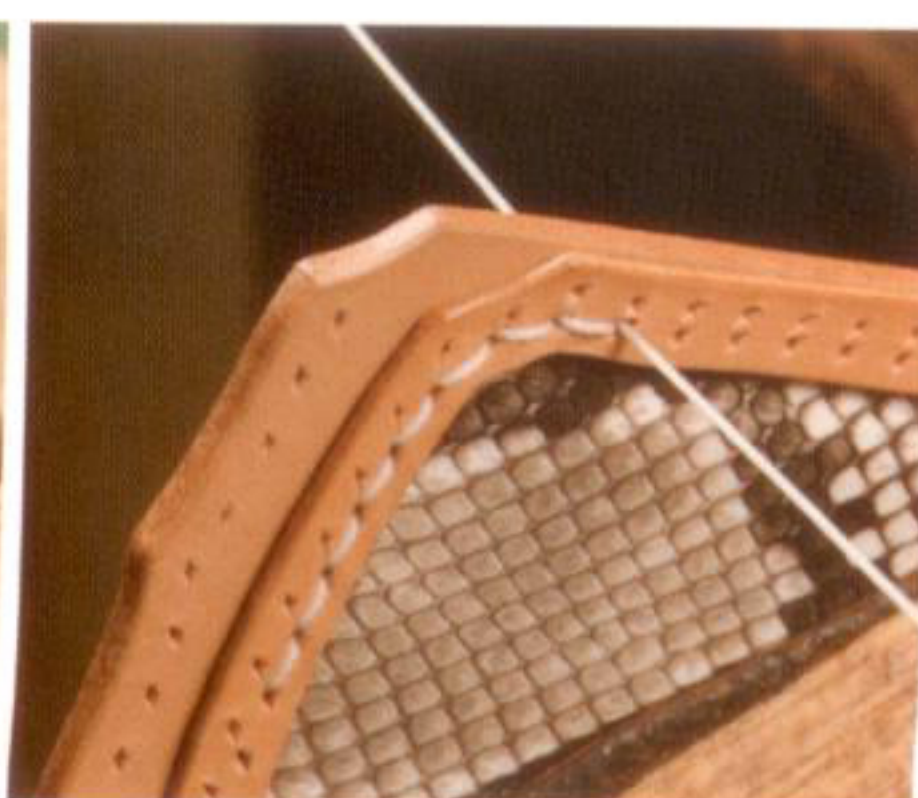
1 最後の3目分を二重に縫うため、縫い目がきれいになるように、センターよりひとつ手前から縫い始める
