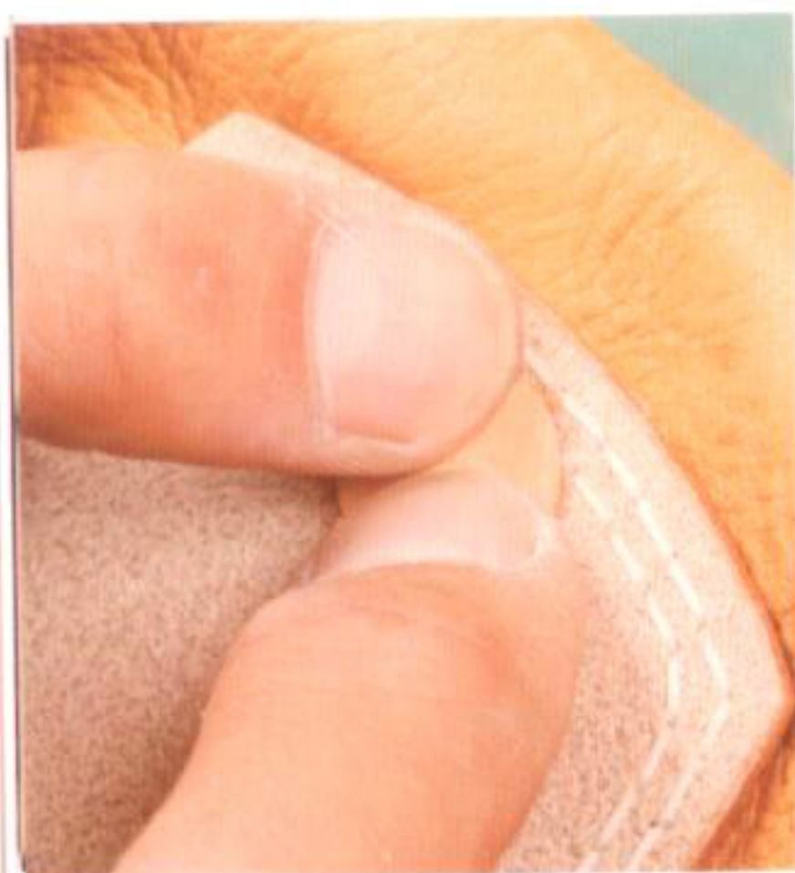
18 目隠しの革を貼り付け、ウッズリッカーで圧着する。指の汗などで汚さないように、柔らかい革をあてて行なう
