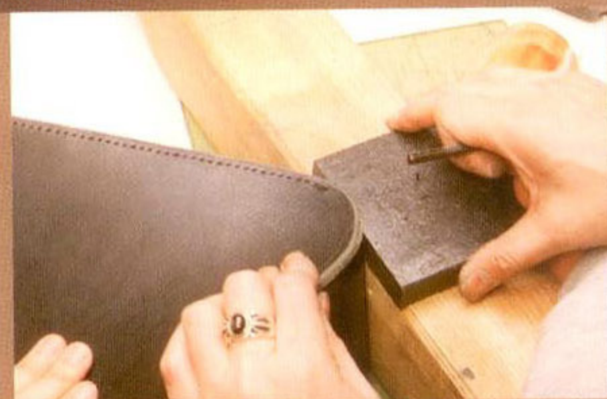
13 マチの高さに合わせた台を用意してから、ヒシ目打ちで縫い穴を空けていく
