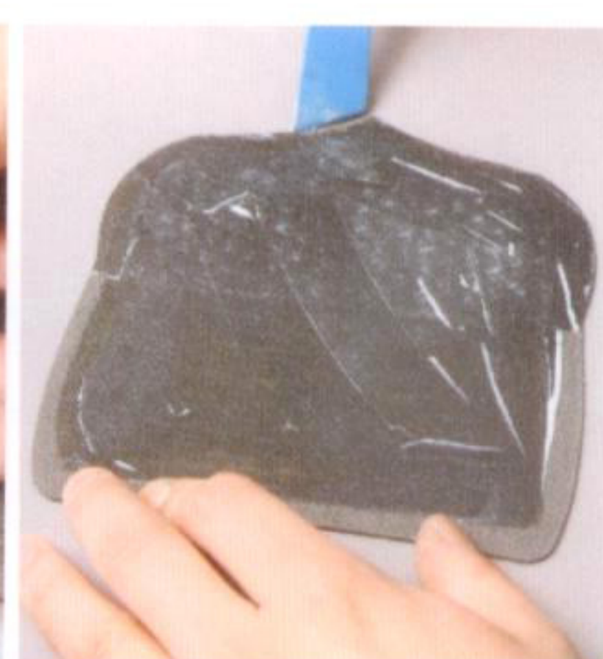
16 コインケースBにコインケースAの縫いしろ位置を印付 け、それ以外の部分にトコノールを塗る
