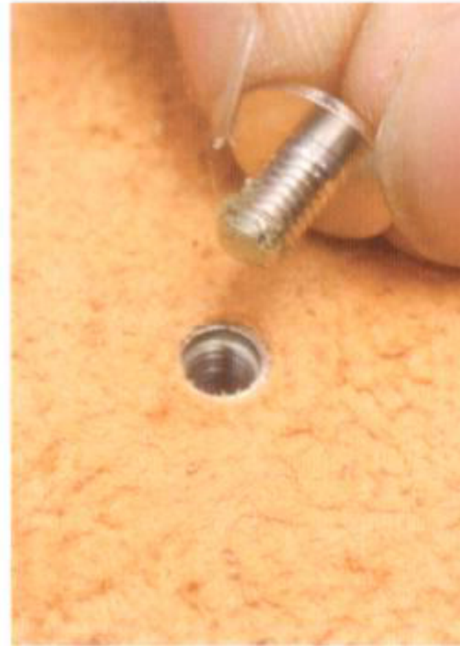
13 ポーチを裏返しにして、コンチョのネジを締め込む
