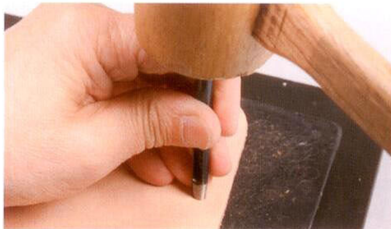
3 センターの位置を決めたら、ハトメ抜きをまっすぐにしたまま木槌で打って穴を開ける
