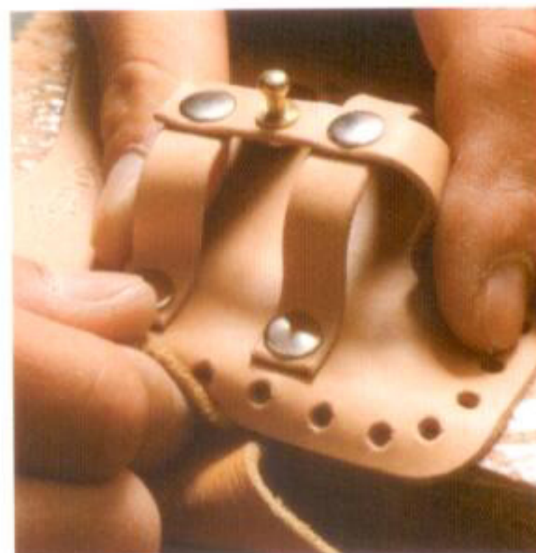
2 かがりやすいように、本体A、B、Cを折り曲げてくせを付ける
