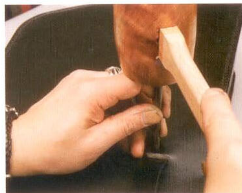
8 本体とベルトにカシメ用の穴を空ける。穴位置がずれないように注意する
