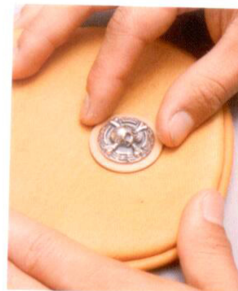
11 コンチョをあて革にはめ、本体の取り付け位置を決める。位置が決まったら、コンチョを押して跡を付ける
