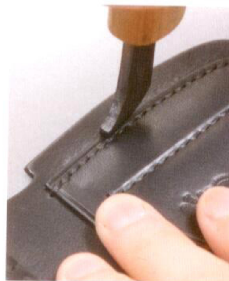
12 巾の異なる飾り捻を縫い目に沿って引き、再びヤスリや染料、トコノールなどで磨き上げる
