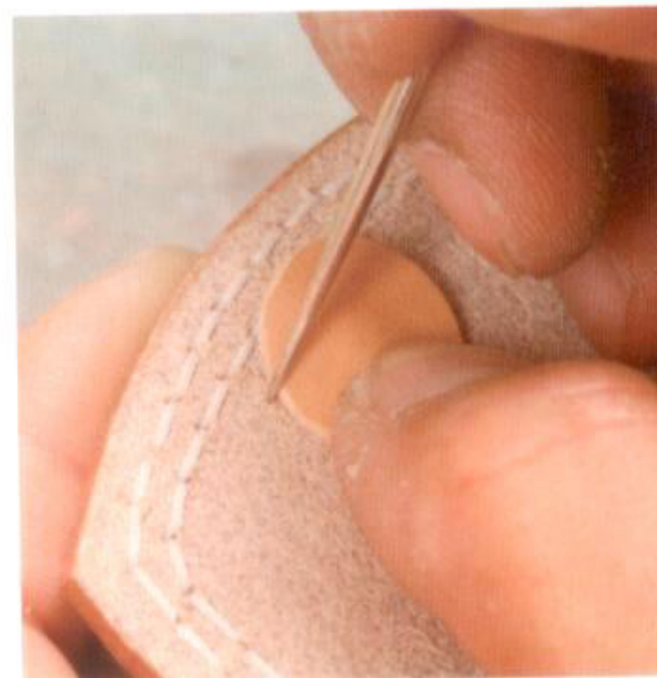
17 目隠しの革をネジの中心に置き、革の外周をけがく。けがいた円の内側と目隠しの革に接着剤を塗る
