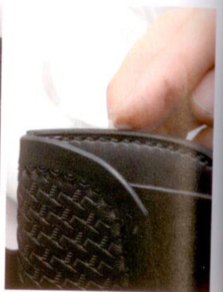
12 巾の異なる飾り捻を縫い目に沿って引き、再びヤスリや染料、トコノールなどで磨き上げる
