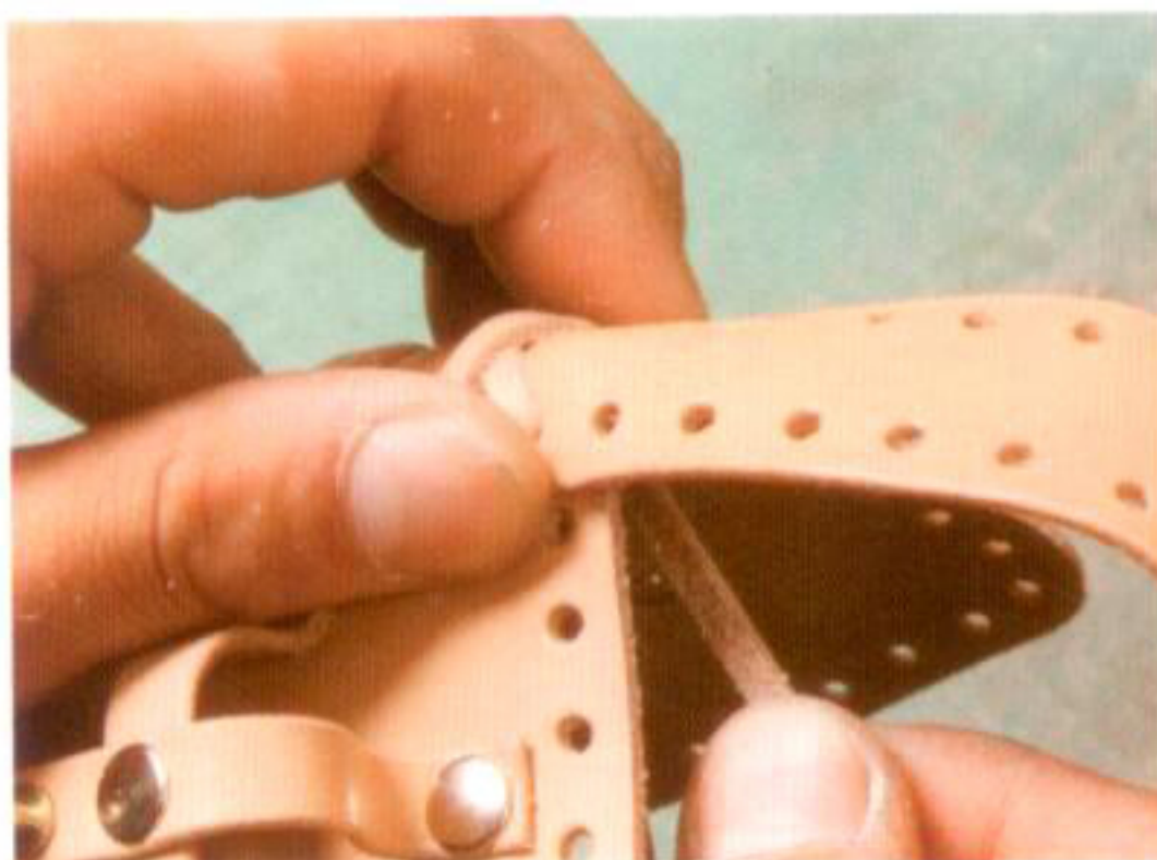
5 カーブしている部分はパーツ同士をしっかりと詰めないで隙間ができてしまう。パーツを曲げながらべべらなどを使ってレースを少しずつ詰めていく。革が傷つく可能性があるため、丸ギリなどでは詰めない方が良いでしょう
