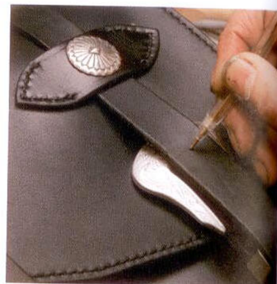
23 ストラップに空ける留め穴の位置を決める。最初に基準となる穴位置を決める
