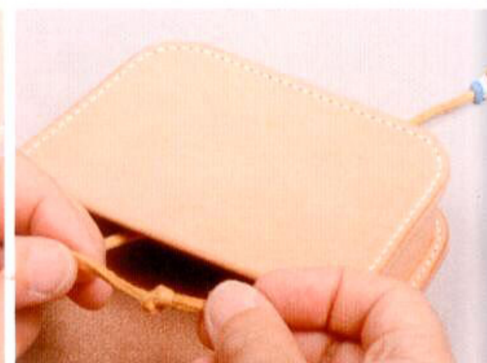
8 本体A下部の穴に鹿ヒモを通し、内側から引っ張り出して片結びをする。これで鹿ヒモが抜けないようになる
