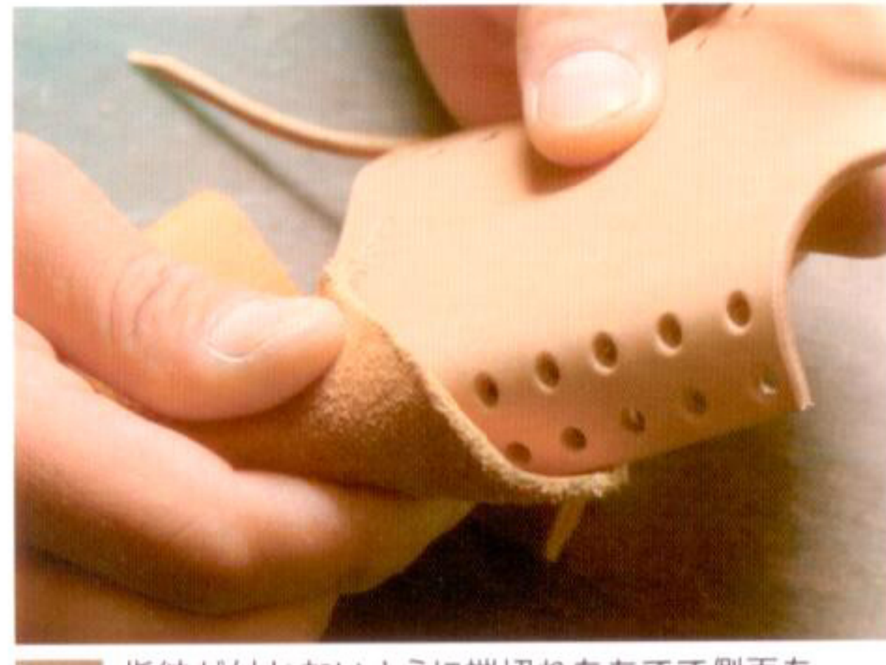
10 指紋が付かないように端切れをあてて側面を折り曲げ、かがりやすいようにくせを付ける
