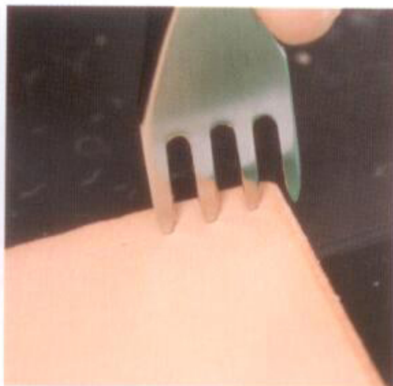
1 デバイダーで付けた線の上に、ヒシ目打ちを合わせる。4本のうちの1本を上部側面に合わせ、軽く押しつける
