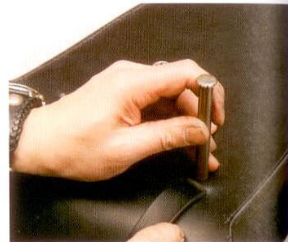
9 カシメを打ってベルトを固定する。ベルトはこのカシメだけで固定される
