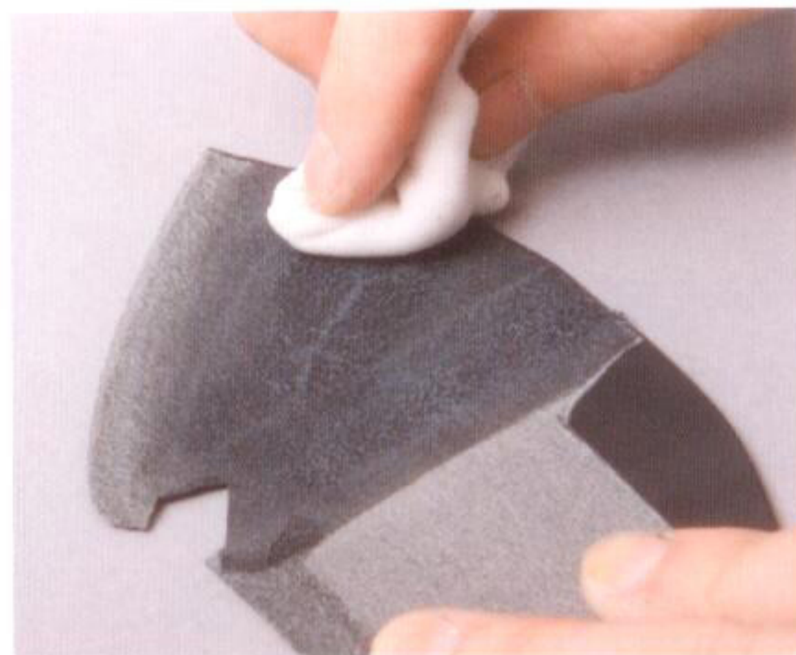
19 コインケースAのマチ部分に水を付ける。ウエスなどに染み込ませ、色が変わる程度含ませる
