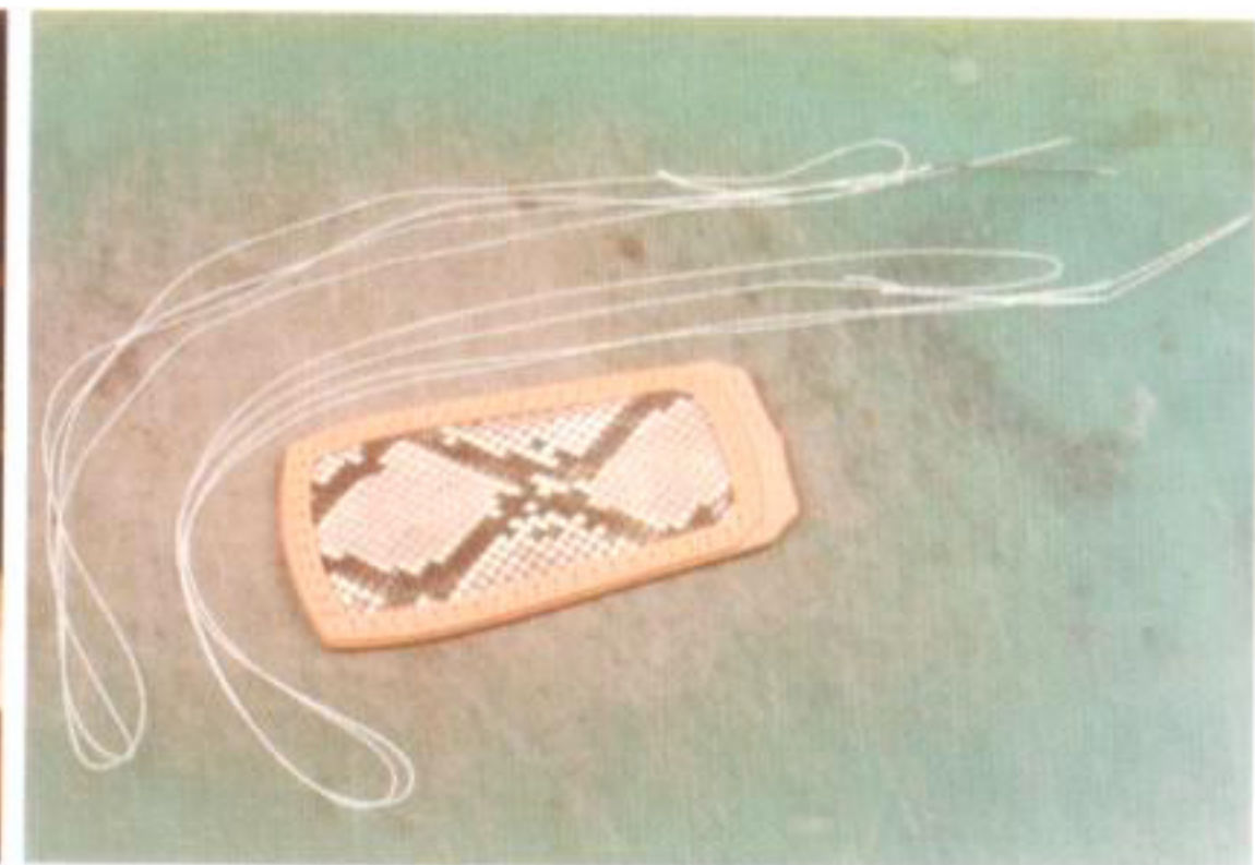
26 ディバイダーで跡を付けたら、菱ギリで穴を空けていく。穴を空け終わったら、針と糸を外周と内周の2セット分用意する
