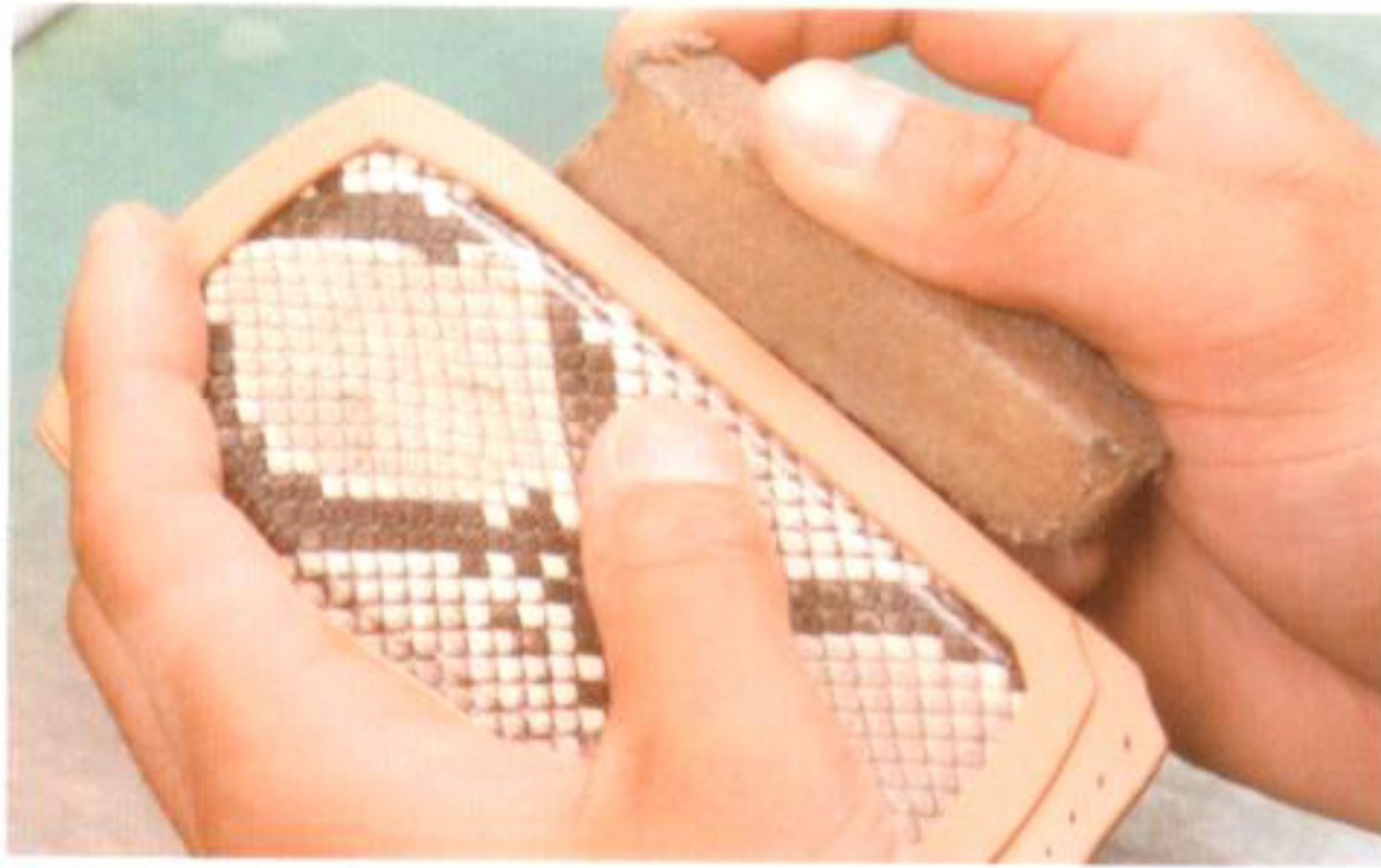
23 ラブラブクリーナー(ゴムのりの固まりでもOK)で側面を擦り、はみ出たゴムのりを取り除く
