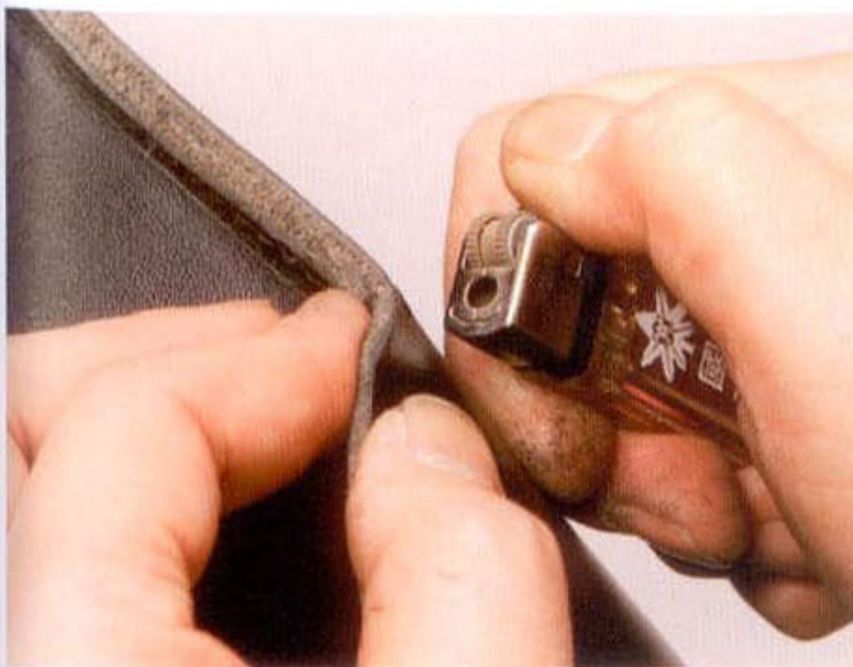
11 縫い終わったら2mm程残して糸を切り、ライター等であぶって焼き留める
