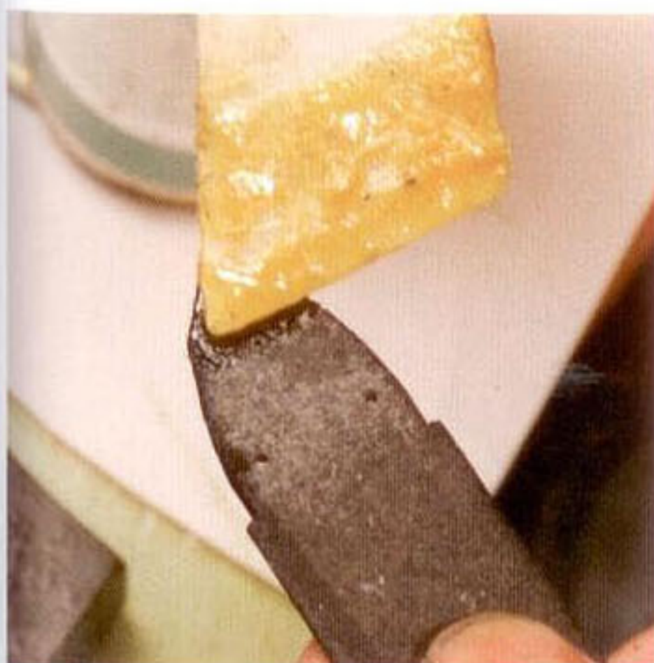
16 穴を空けてベルトの面取りをしたら、チップの中に入る部分にボンドを塗る
