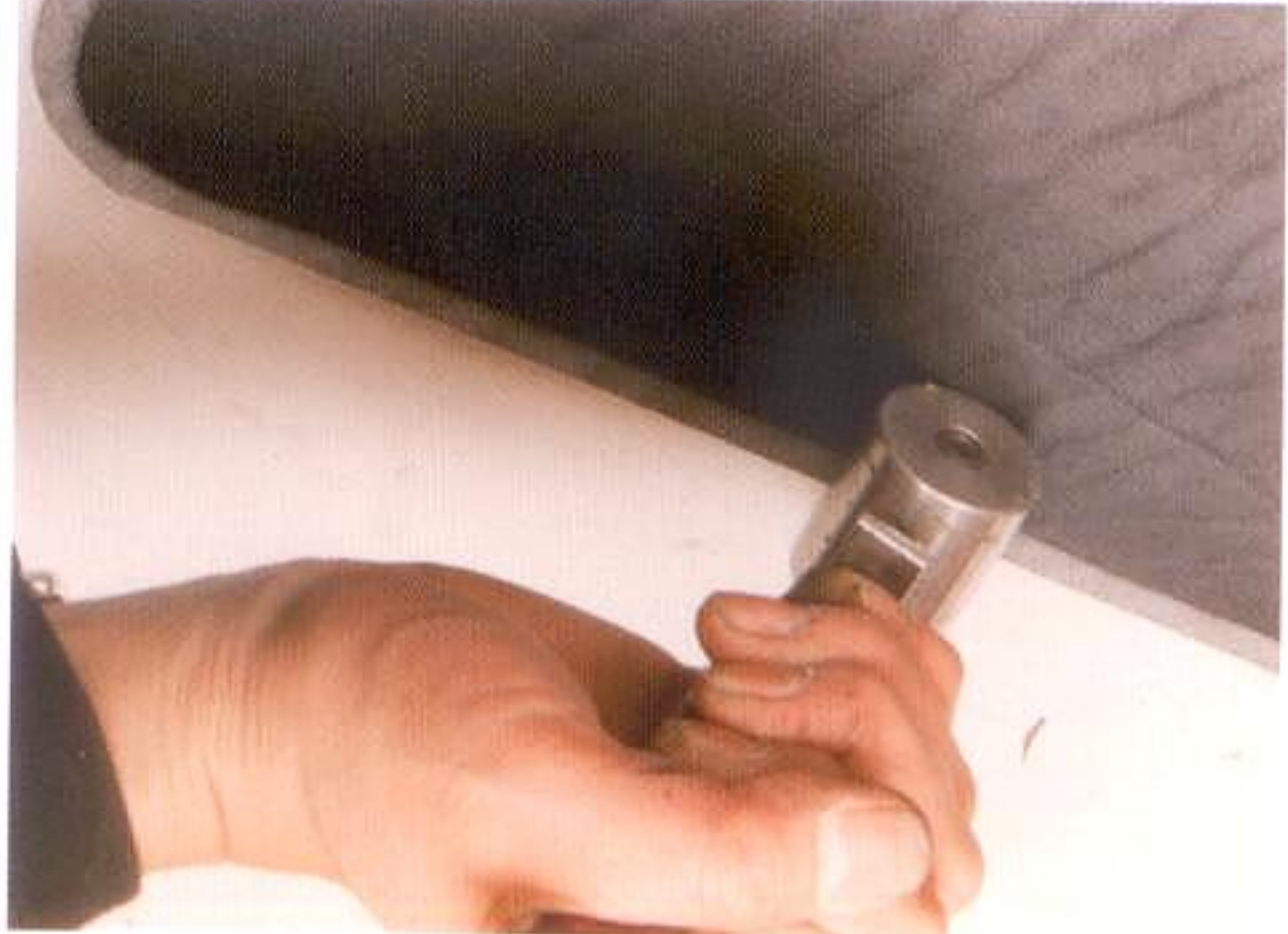
13 パーツを張り合わせたら、ローラーで圧着していく。端までしっかりとローラーをかける
