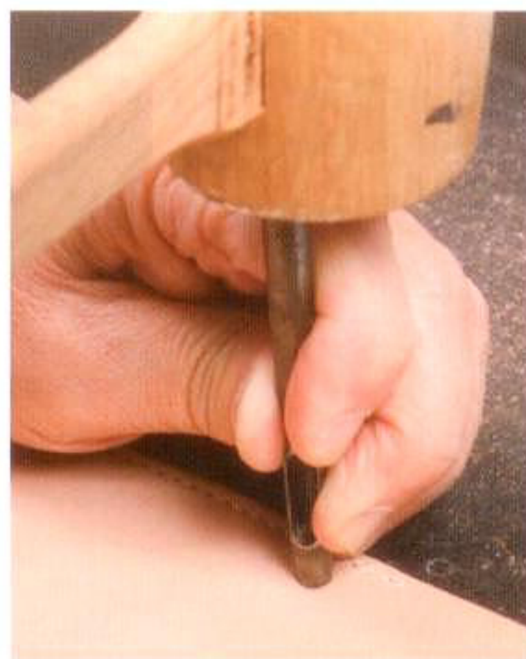
10 本体Aの横に空けた鹿ヒモの穴にハトメ抜きを差し込み、マチを倒しながら打ち付けてマチにも穴を開ける
