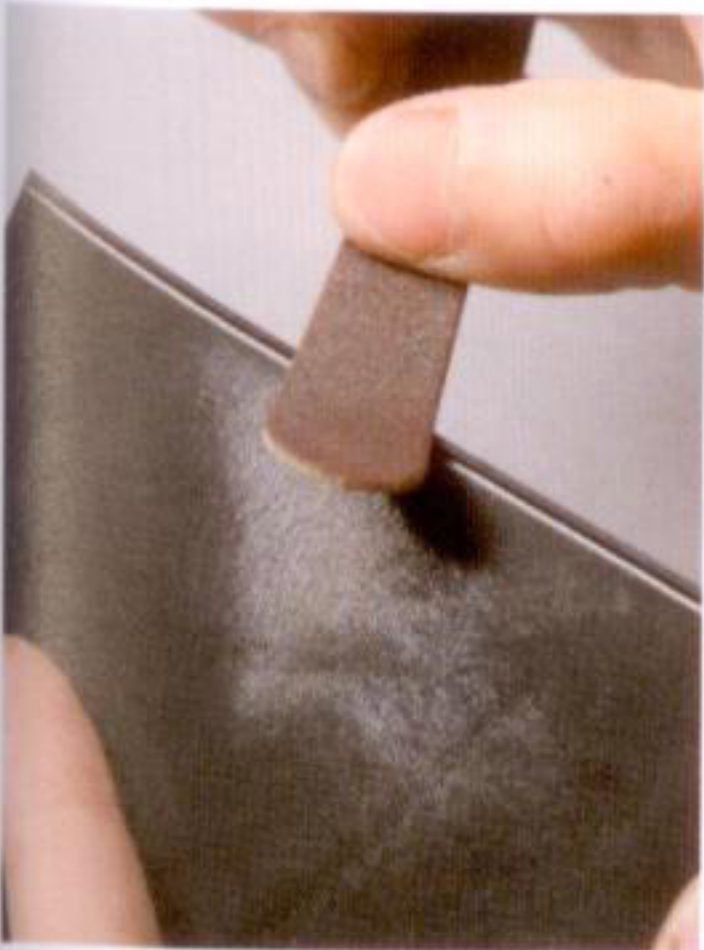
13 再びサンドスティックでヘリとコバを整え、染料を塗る。 染料はフェルトを使って塗っている
