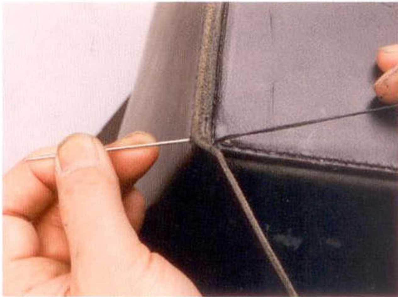
9 縫い始めの部分は、蓋側に2周回してから縫う。 縫う距離が長いので何回かに分けても良い
