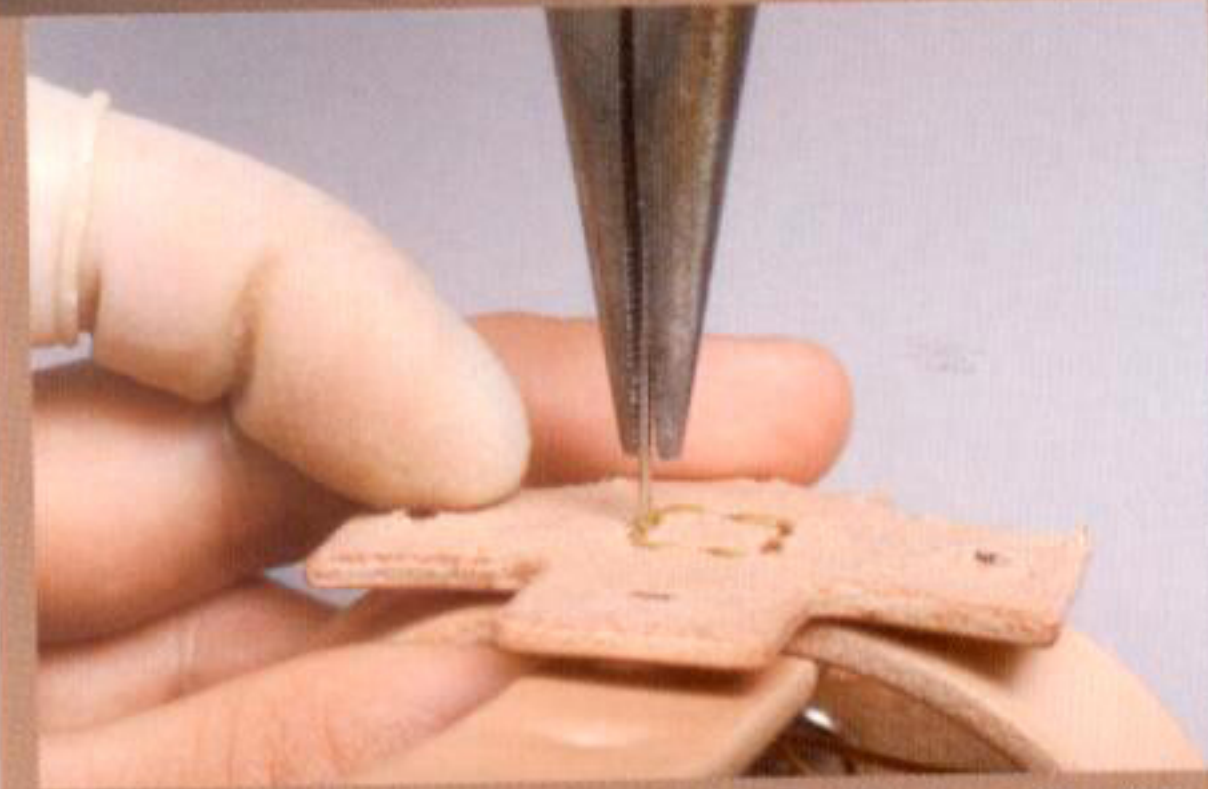
20 3枚の革を二重に縫う場合、目が詰まって針が通りにくいので、ラジオペンチ等で引き抜くと良い
