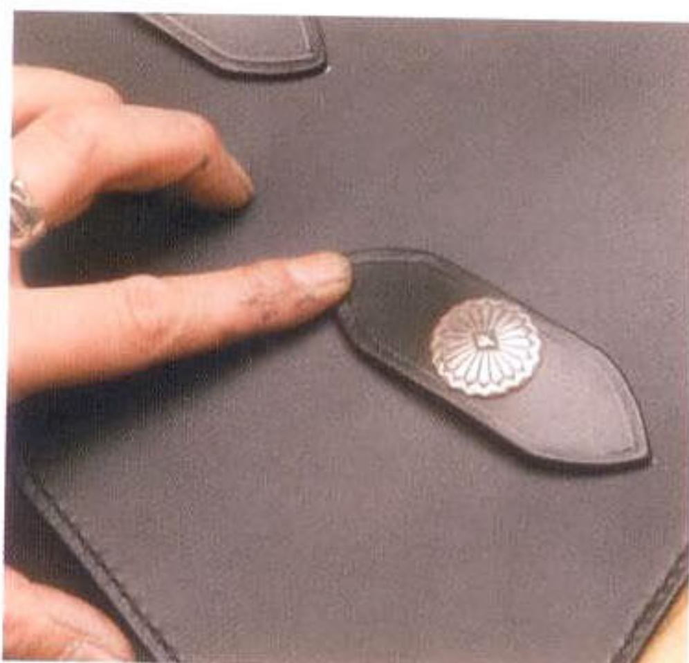
18 ベルト留めの位置を確認しながら銀面を削り、削りすぎないようにする
