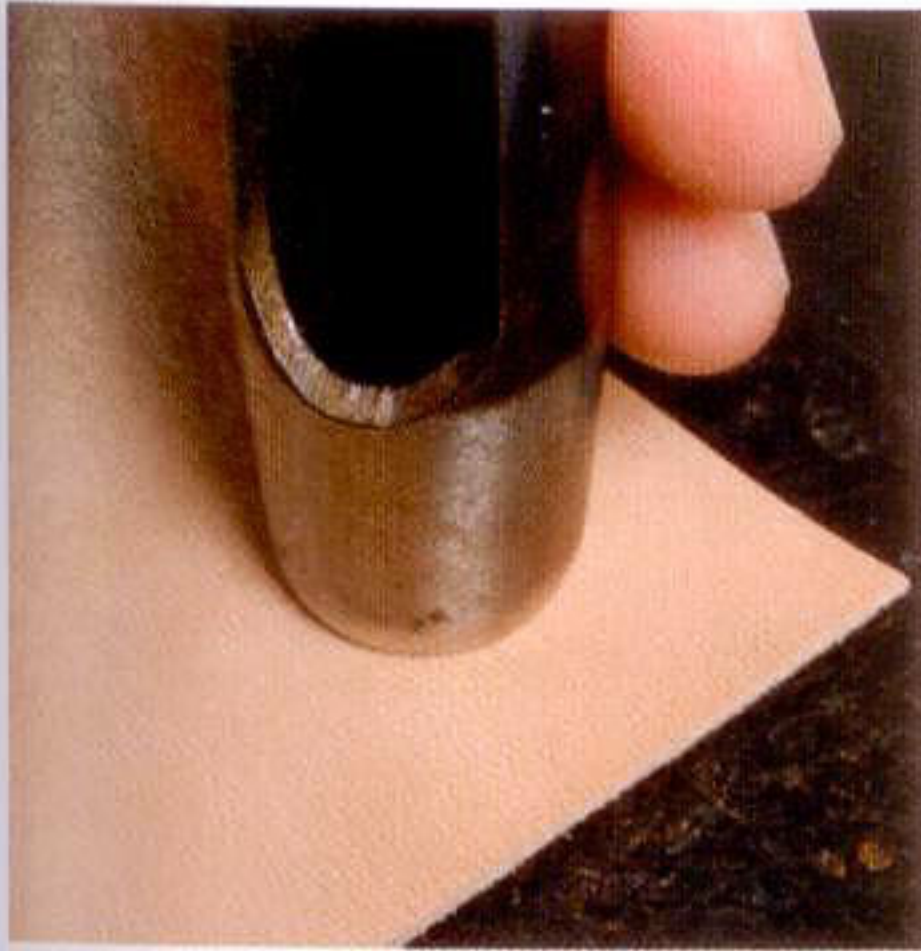
7 60号のハトメ抜きであて革を作る。革包丁で任意のサイズに切り抜いても良い
