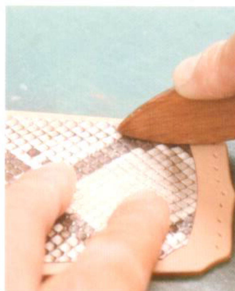
16 ウッドスリッカーでアンコのヘリを擦って凹凸を出す。最後はゴムハンマーでしっかりと圧着する
