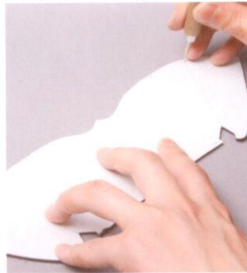
20 型紙を元にして、マチの折り目の基準となる点に丸ギリなどで印を付ける
