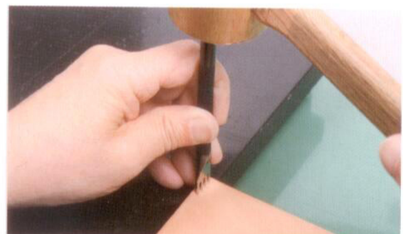
2 軽く押しつけたヒシ目の跡に合わせ、ヒシ目打ちを垂直に立てて木槌で打つ
