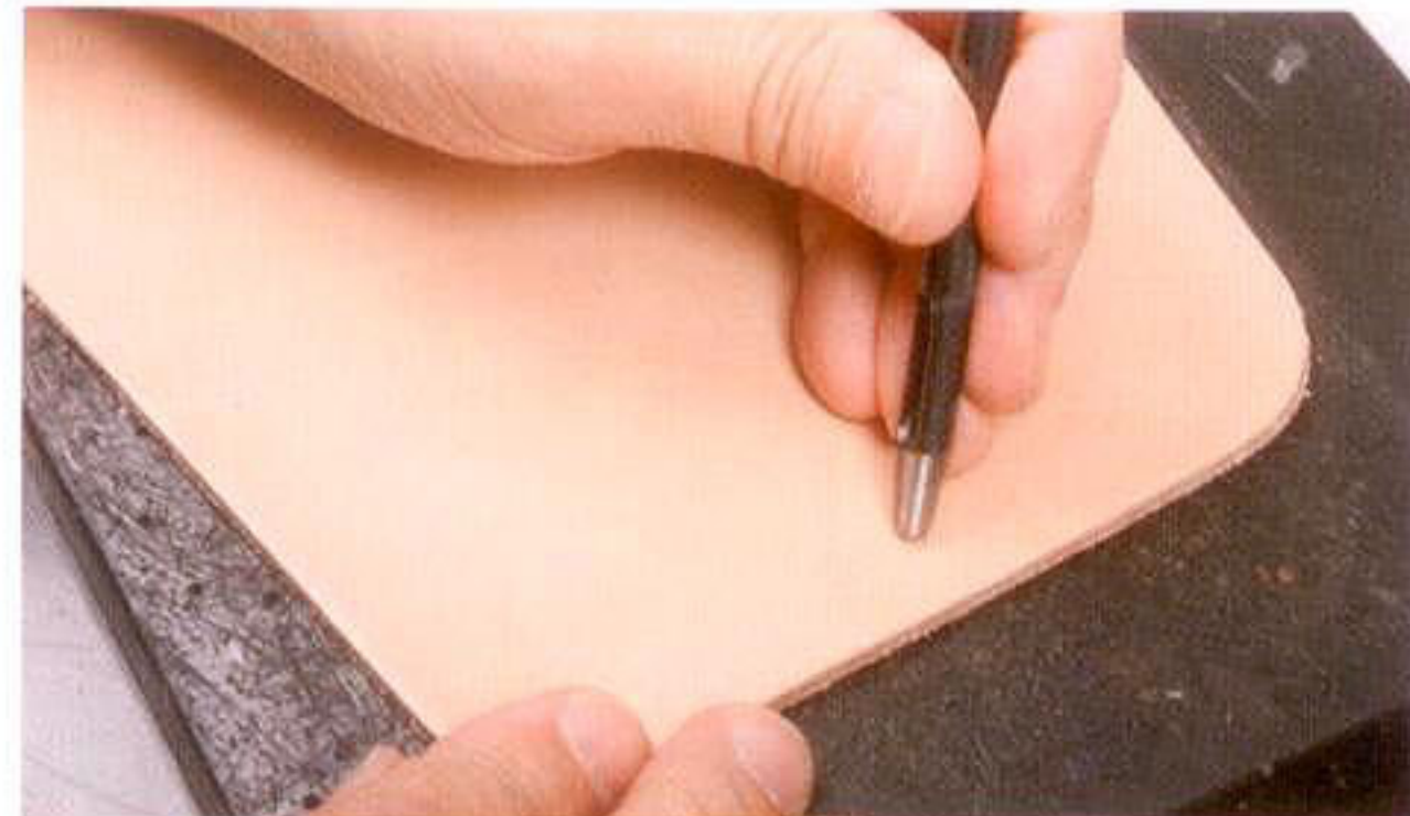
2 丸ギリで印した位置にハトメ抜きを軽くあて、印がセンターに来るように調整する
