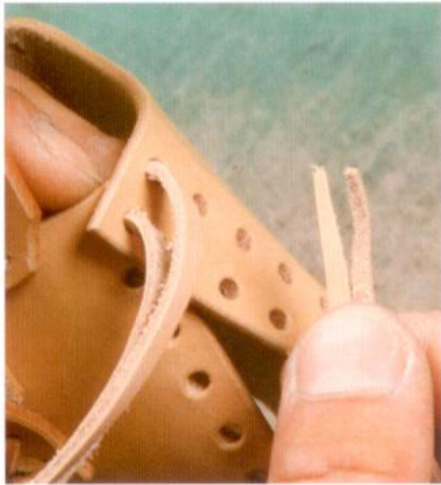
11 上からレースで本体をかがる。穴が2つ空いている面を上にしてサドルレースを通し、左右同じ長さ揃える
