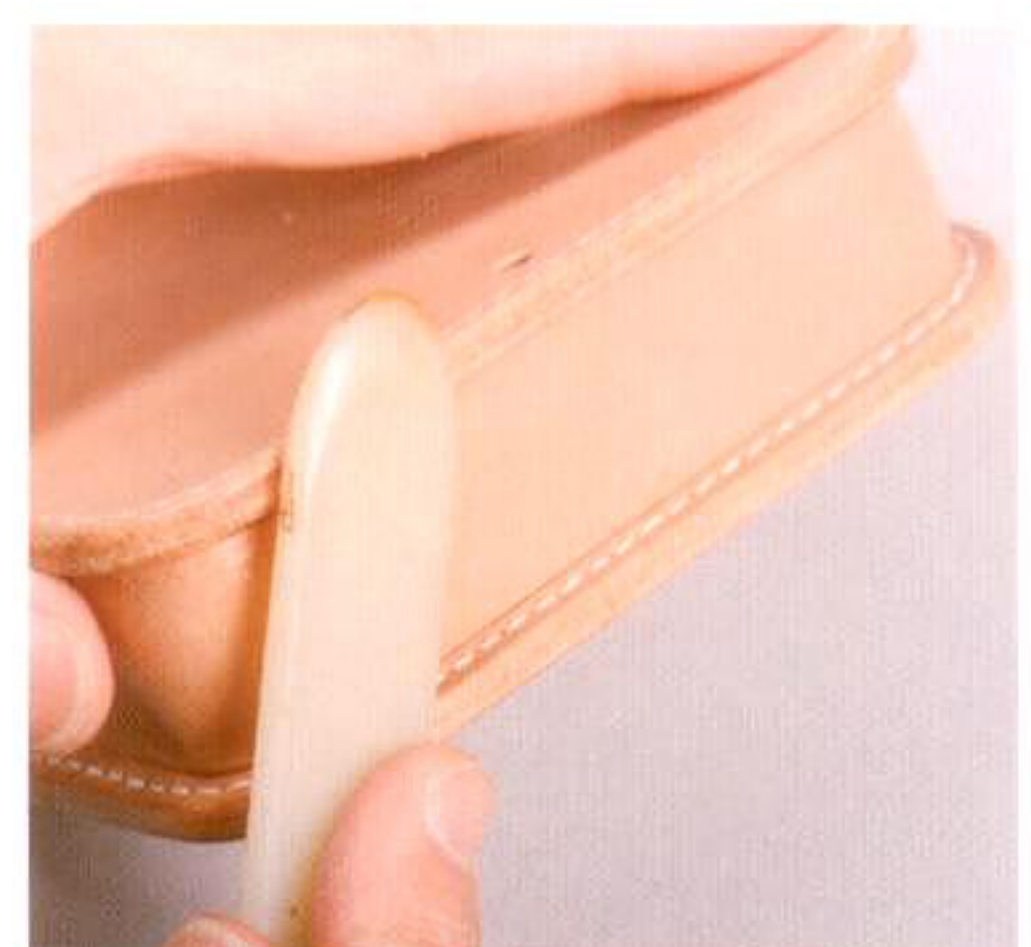
13 ヘラを使ってコバを磨く。ウッドスリッカーやヘリ磨きを使っても良い
