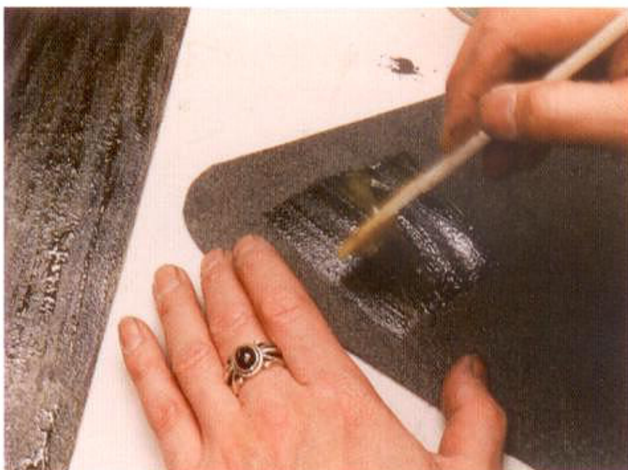
12 内側になるパーツを本体に貼り合わせるために、両方の床面にボンドを塗っていく
