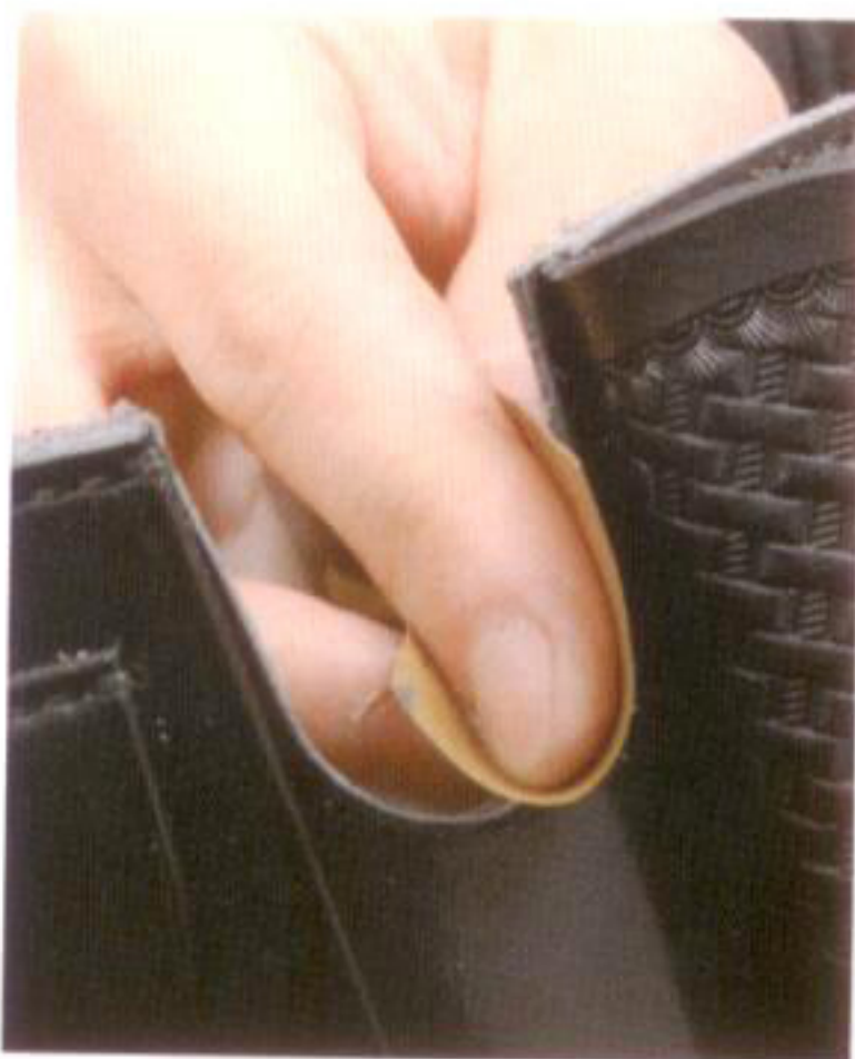
11 118~119ページと同じように、染料やCMCなどを塗ってヘリとコバの処理をする
