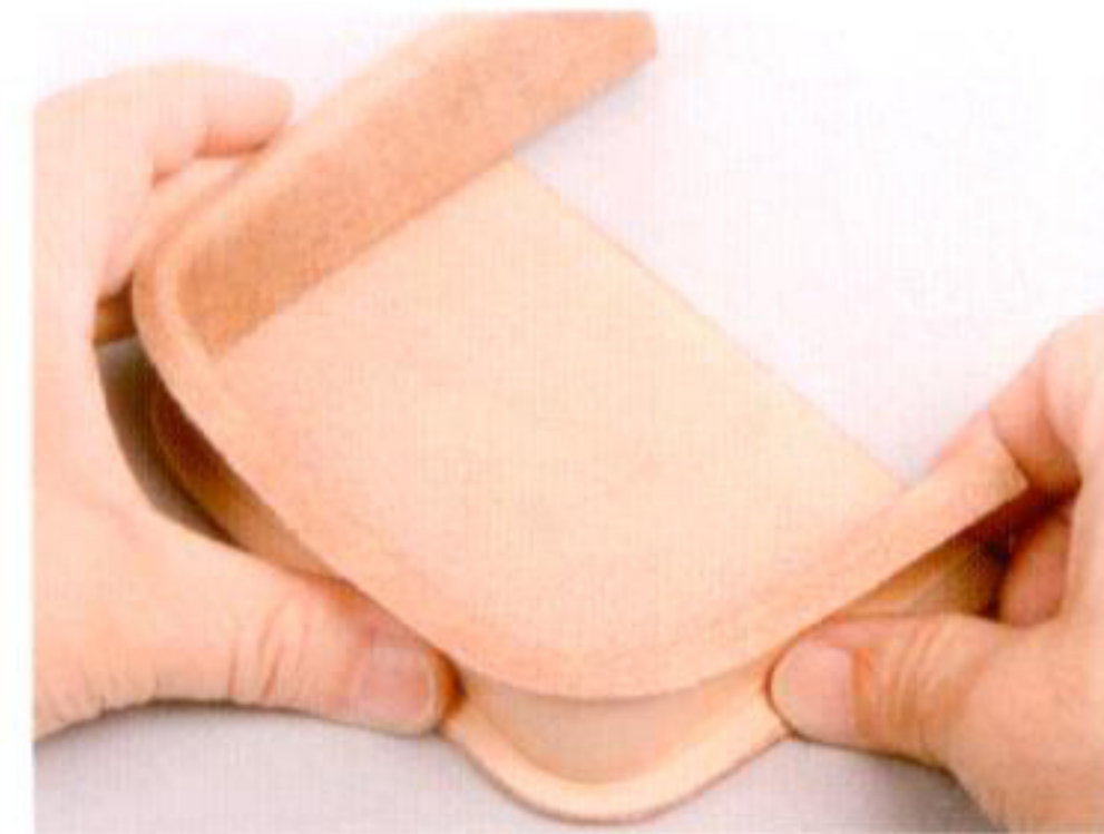
8 成形したらそのまま乾燥させる。本体よりも長い部分は後で切る
