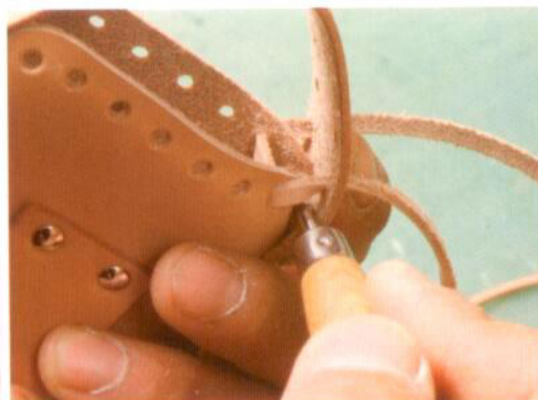
5 カーブしている部分はパーツ同士をしっかりと詰めないで隙間ができてしまう。パーツを曲げながらべべらなどを使ってレースを少しずつ詰めていく。革が傷つく可能性があるため、丸ギリなどでは詰めない方が良いでしょう
