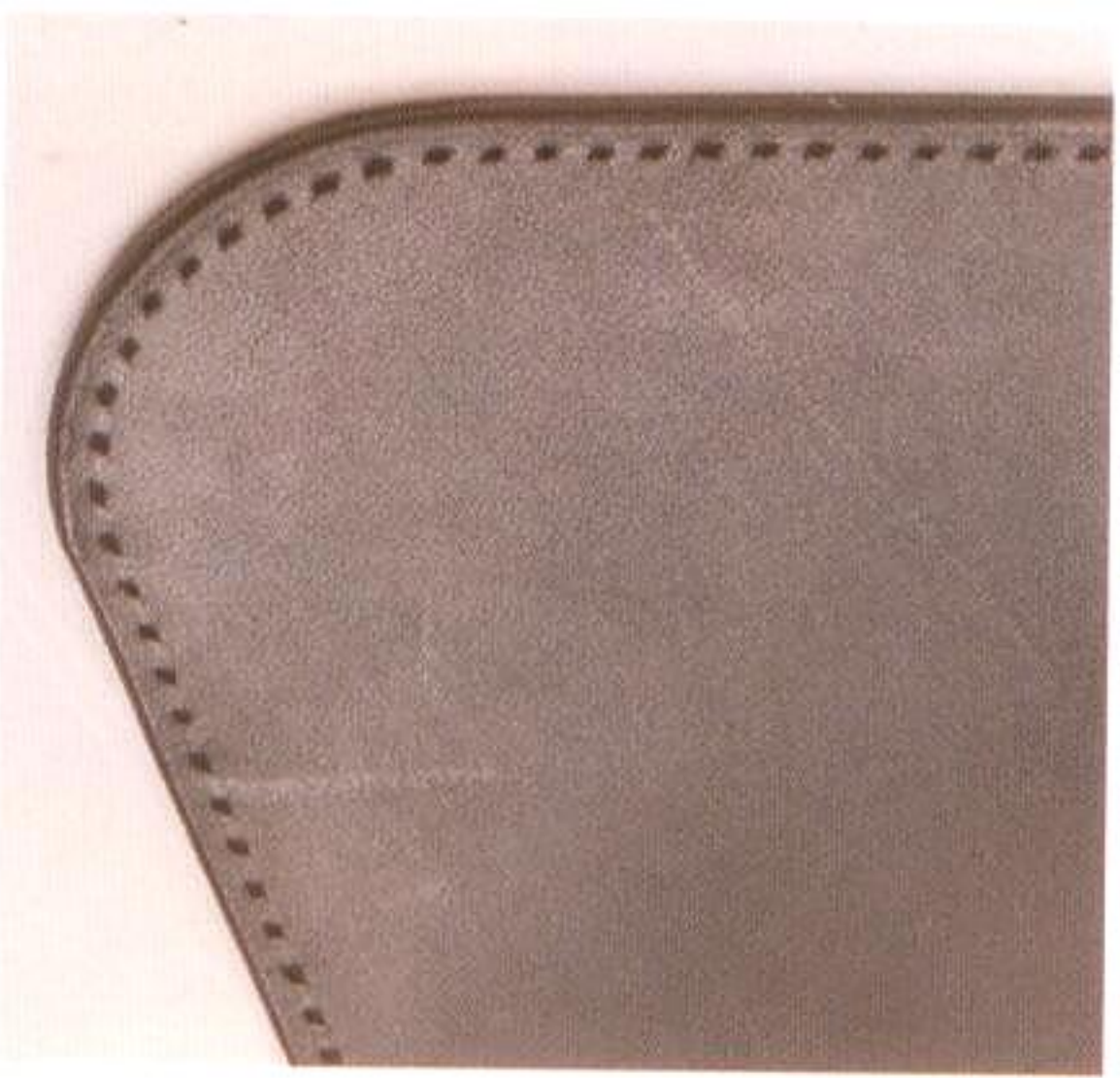
11 縫い穴を空けていく。カーブしている部分は2本ヒシ目打ちを使い、カーブに沿って穴を空けていく。間隔がずれないように注意すること
