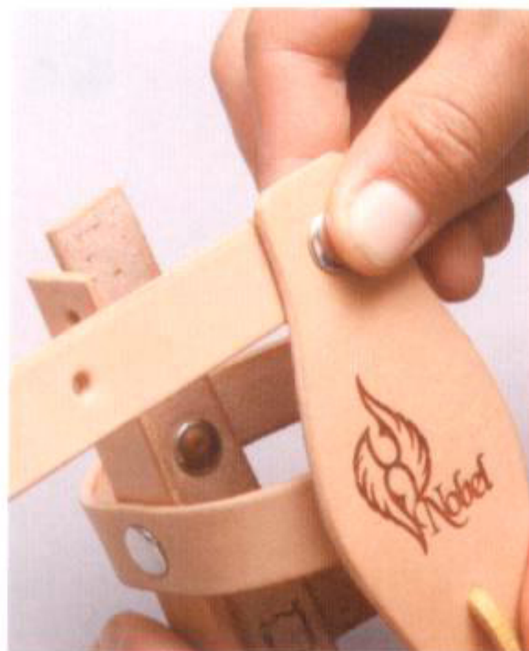
26 最上部をカシメる。プレート部分のカシメは足長を使用する。ベルトの重ね方を間違えないように
