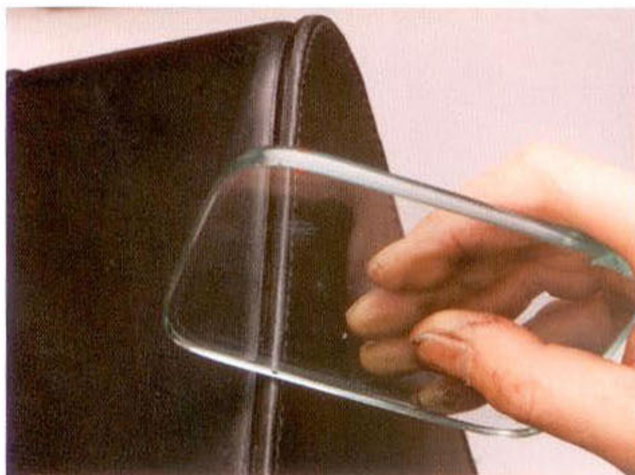
13 ヘチマにトコノールを付けて磨き、ガラスで磨いてコバを仕上げる
