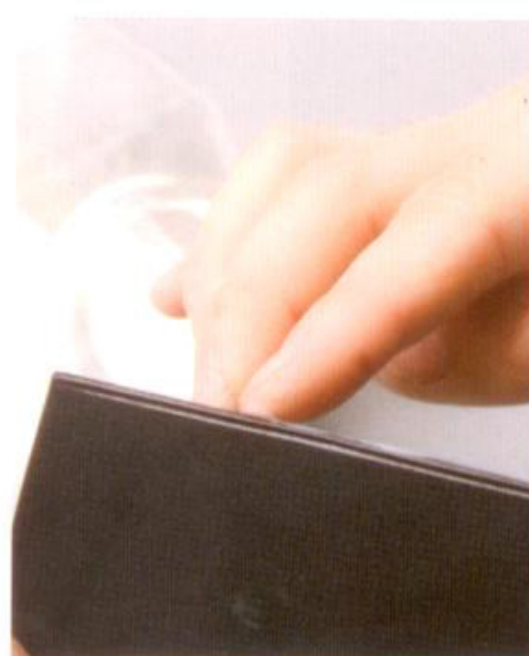
14 トコノールを塗ってウッドスリッカーで磨く。1回目は CMC、2回目はトコノールを使用して磨く
