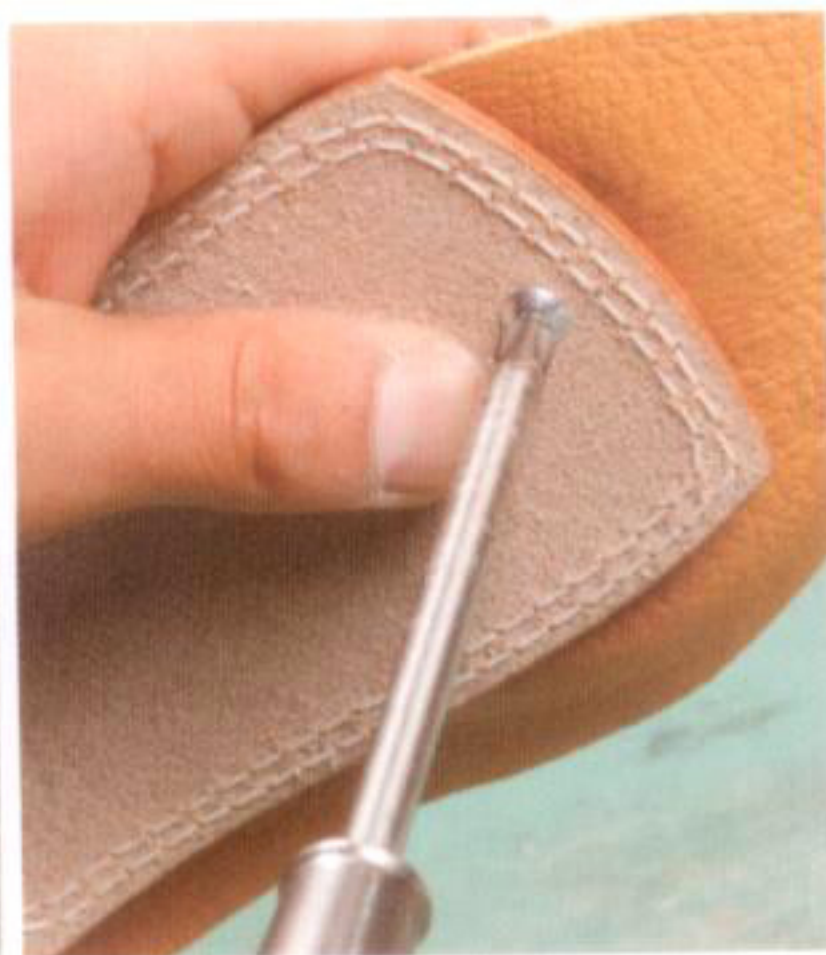
16 蓋のコンチョ穴を元に、アンコとヘビ革にも8号の穴を空け、コンチョにネジロック剤を付けてネジを締める
