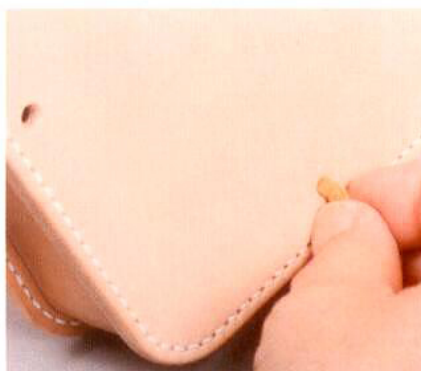
8 本体A下部の穴に鹿ヒモを通し、内側から引っ張り出して片結びをする。これで鹿ヒモが抜けないようになる
