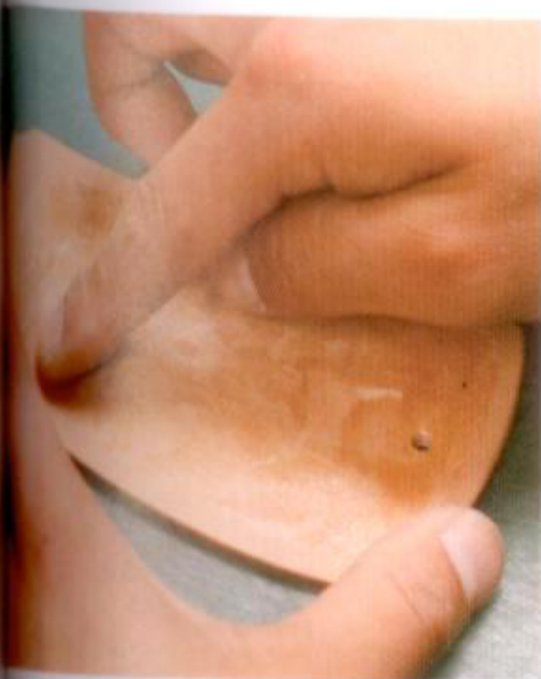
15 蓋のけがいた部分に接着剤を塗り、蓋とヘビ革を貼り合わせる。左右と下の巾が同じになるようにすること
