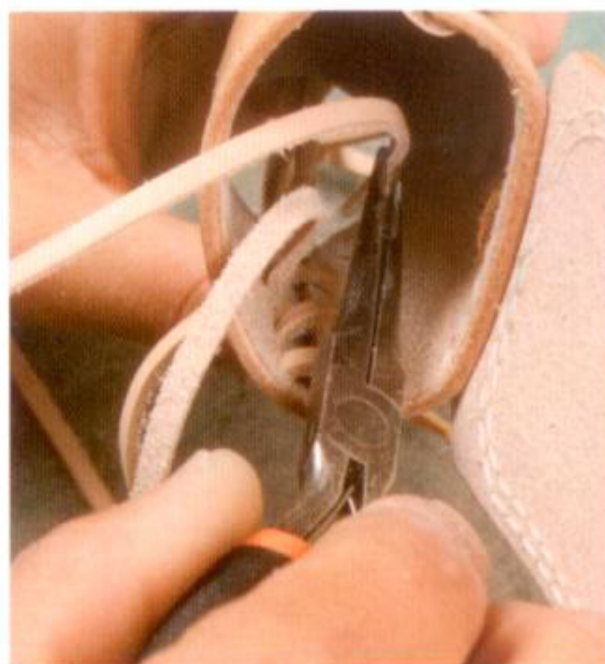
14 もう片方は本体が閉じていくので、レースを差し込みにくくなる。この場合はラジオペンチなどを使うと良い
