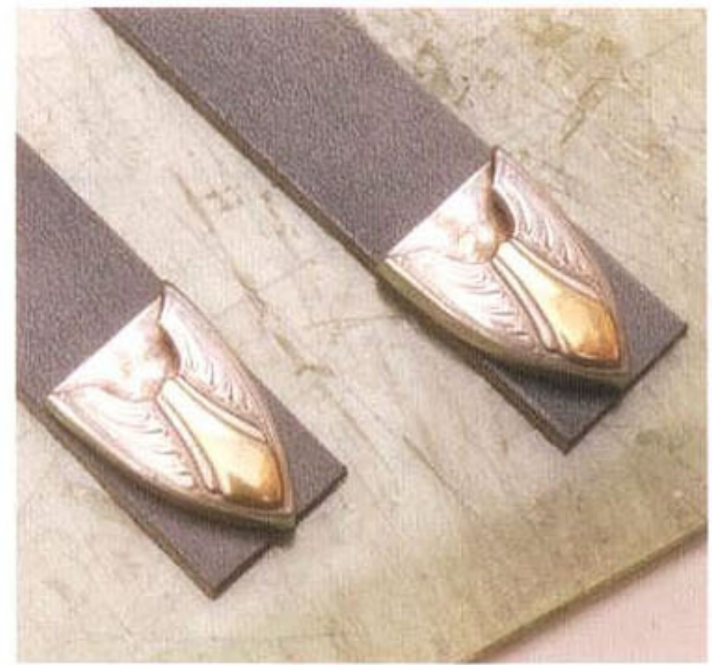
12 続いてストラップ側を製作していく。先端のチップをベルトに合わせる
