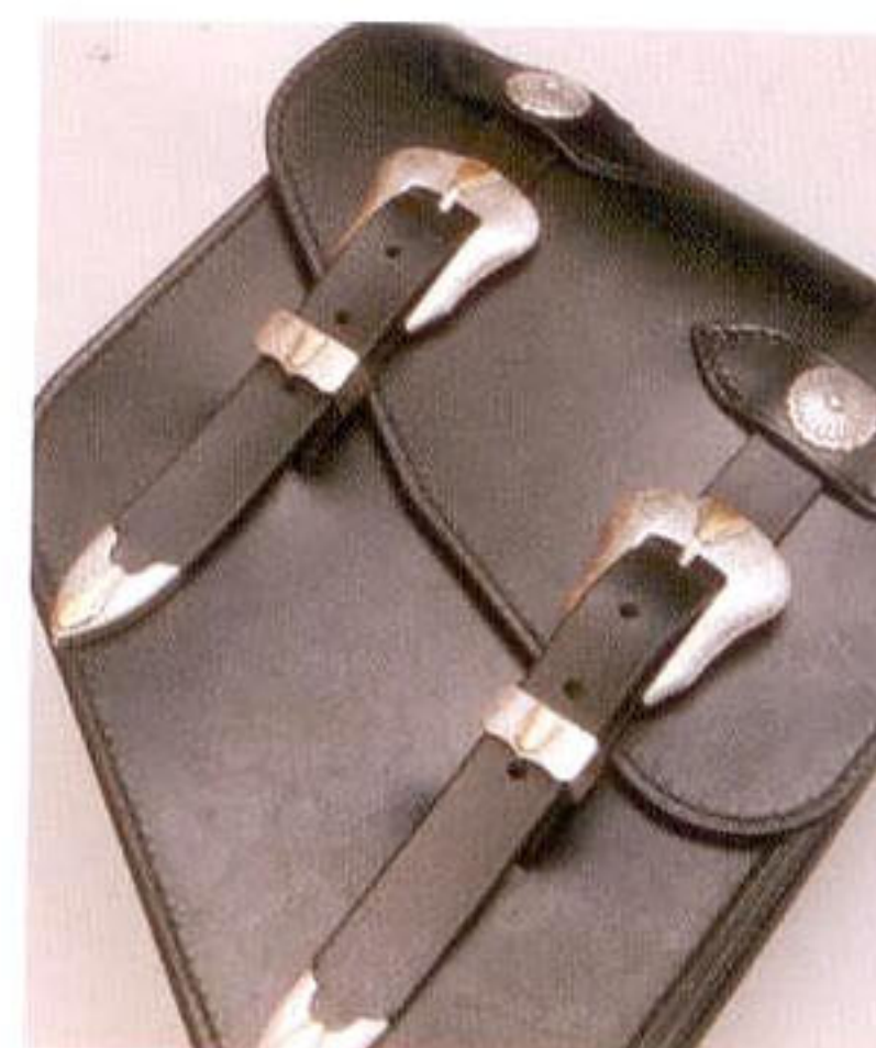
26 穴が空いたらバックルに通し、きちんと閉まることを確認
