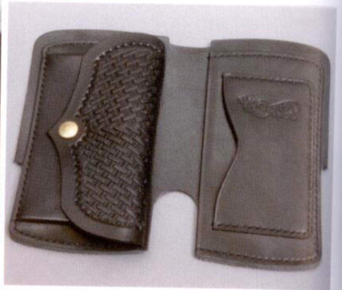
8 2/5のシニュー糸を使って、コインケースとカードケースを縫い合わせる。縫い方は123ページと同じ
