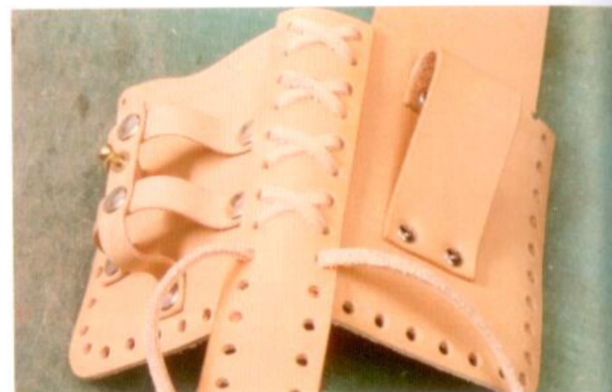
4 レースをクロスさせながらかがっていく。重なる方向が同じになるようにすると良い
