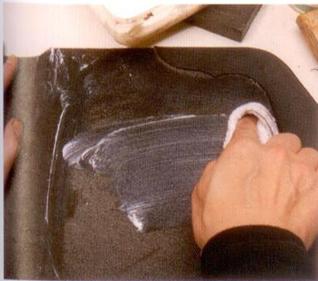
10 トコノールを床面に塗り、床面を仕上げておく。ここでは蓋の裏側だけを磨いておく
