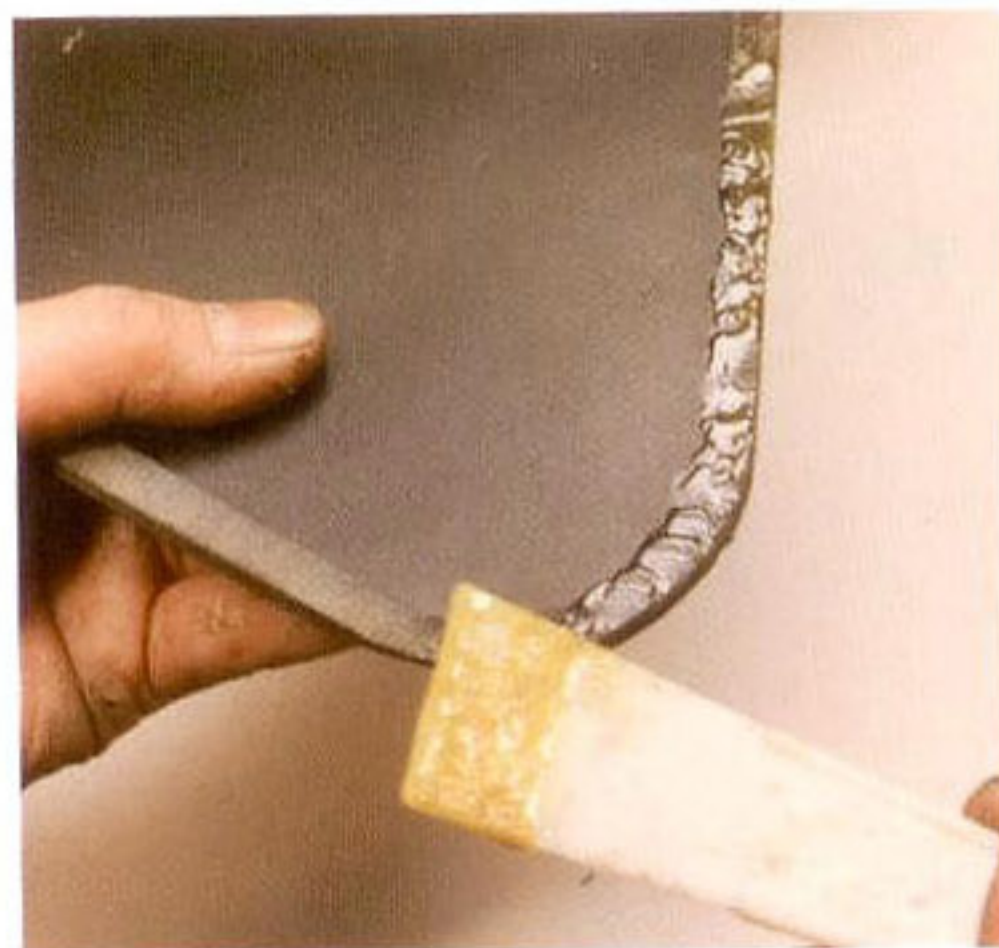
8 本体側の縫いしろにもボンドを塗っていく。厚く塗りすぎないように注意
