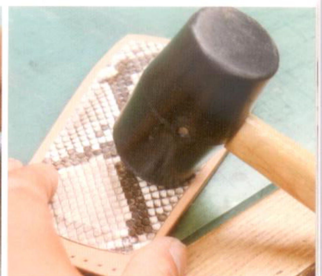
16 ウッドスリッカーでアンコのヘリを擦って凹凸を出す。最後はゴムハンマーでしっかりと圧着する
