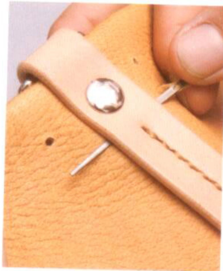
6 ストラップのカシメと縫い目の間に、鹿ヒモを通し、左右の長さを均等に揃える
