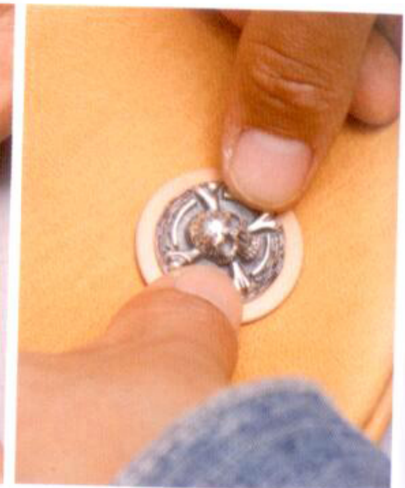
11 コンチョをあて革にはめ、本体の取り付け位置を決める。位置が決まったら、コンチョを押して跡を付ける
