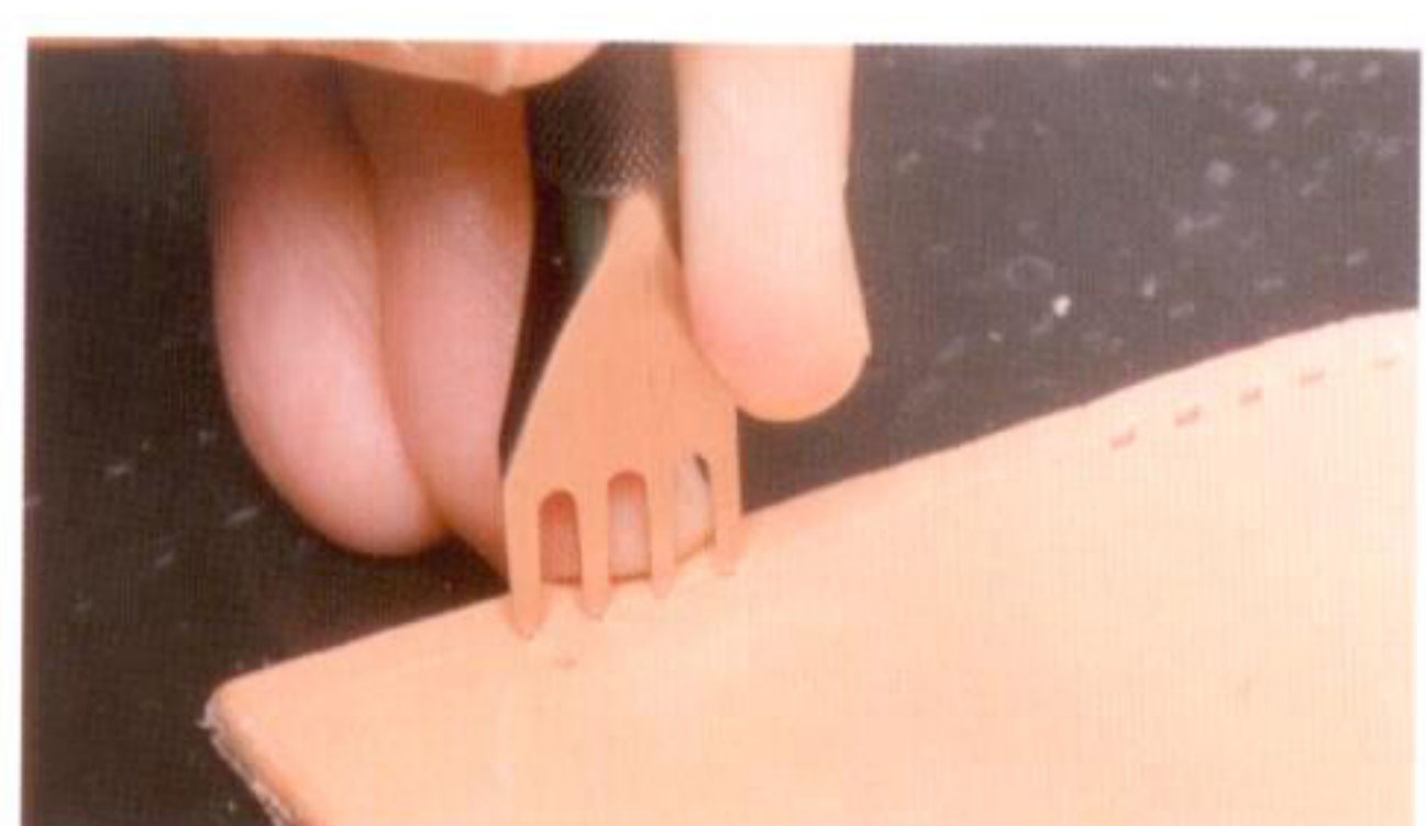
6 終わりに近づいたら一度止まり、ヒシ目打ちを軽く押しつけながら、穴の位置を確認する
