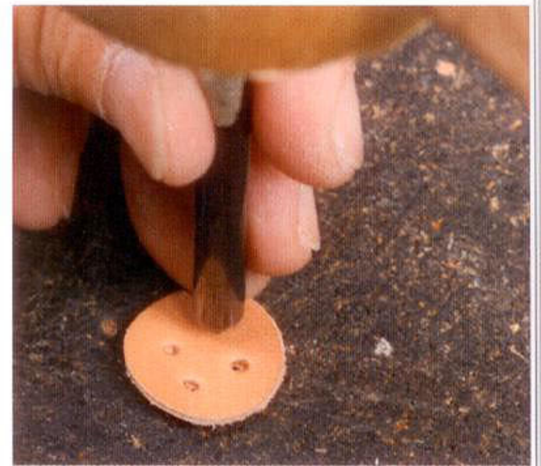
2号のハトメ抜きを打ち、4つの穴を開ける
