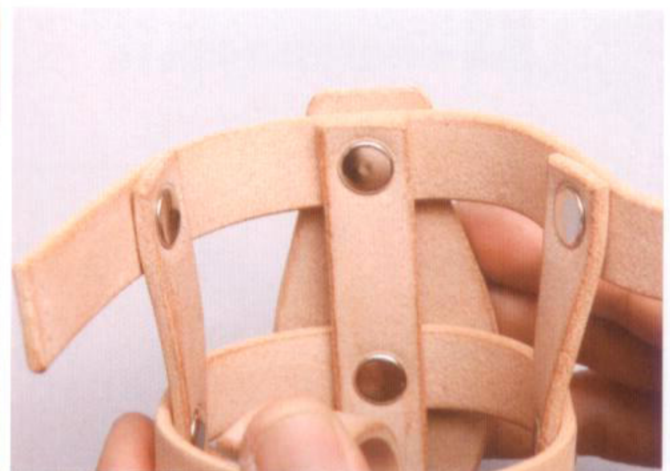
26 最上部をカシメる。プレート部分のカシメは足長を使用する。ベルトの重ね方を間違えないように
