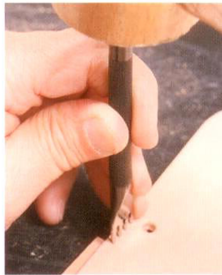
8 ディバイダーで引いた線に沿って、ヒシ目打ちを打っていく。カーブは2本ヒシ目打ちを使う
