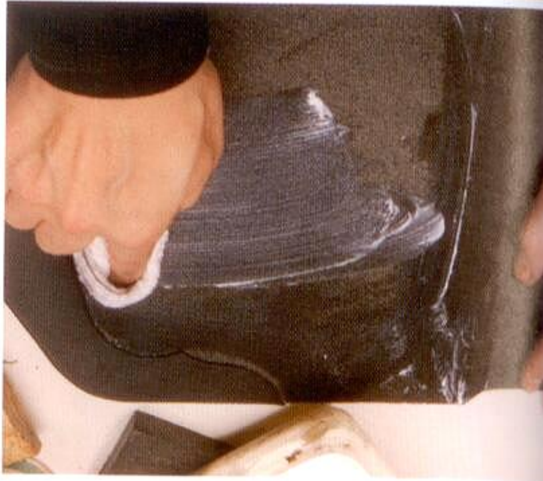
10 トコノールを床面に塗り、床面を仕上げておく。ここでは蓋の裏側だけを磨いておく
