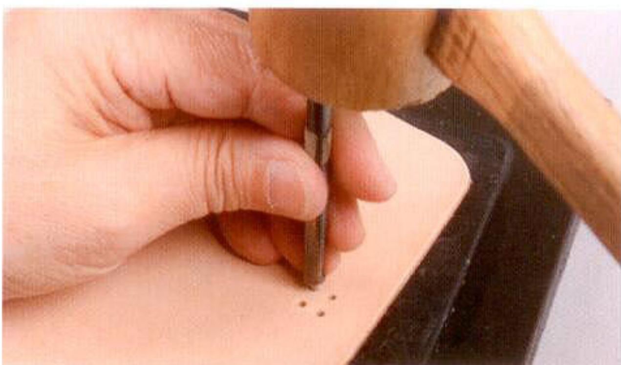
5 コンチョとあて革を縛るための穴は、2号(0.6mm)のハトメ抜きを使用する
