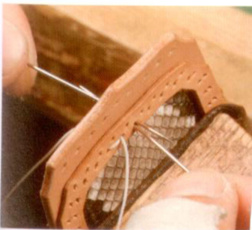
1 最後の3目分を二重に縫うため、縫い目がきれいになるように、センターよりひとつ手前から縫い始める
