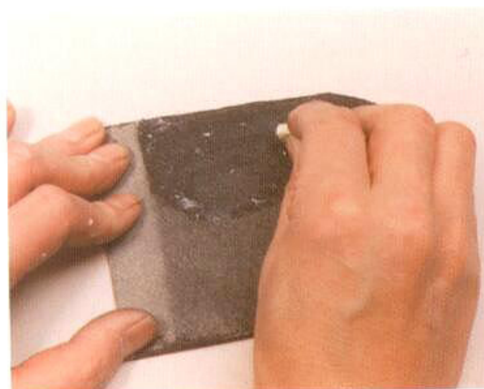
2 床面はマチに貼る部分を残して、トコフィニッシュで仕上げる
