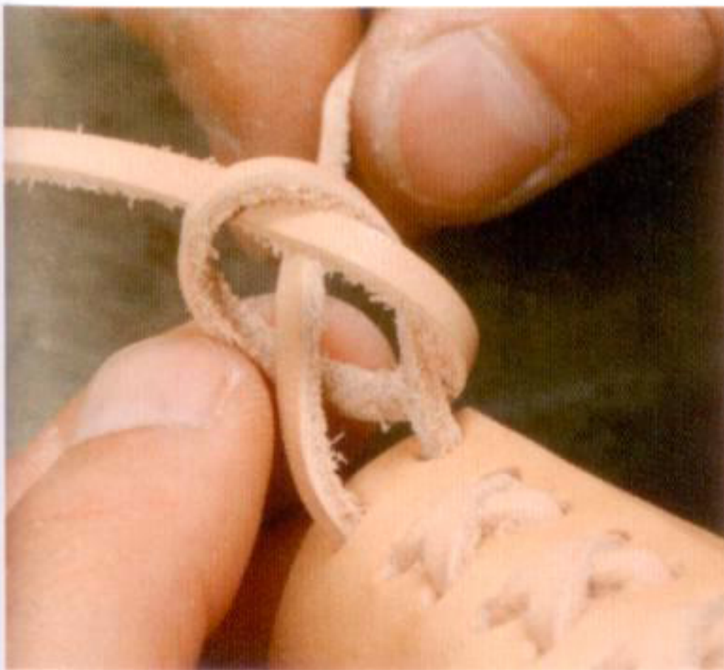
13 最後はベルトループの鹿ヒモと同じように、片方のレースを挟んで片結びをする。グランドゼロでは片方を銀面、もう片方を床面が出るように結んでいる。本体が開かないように、根本で結び目を作るようにする
