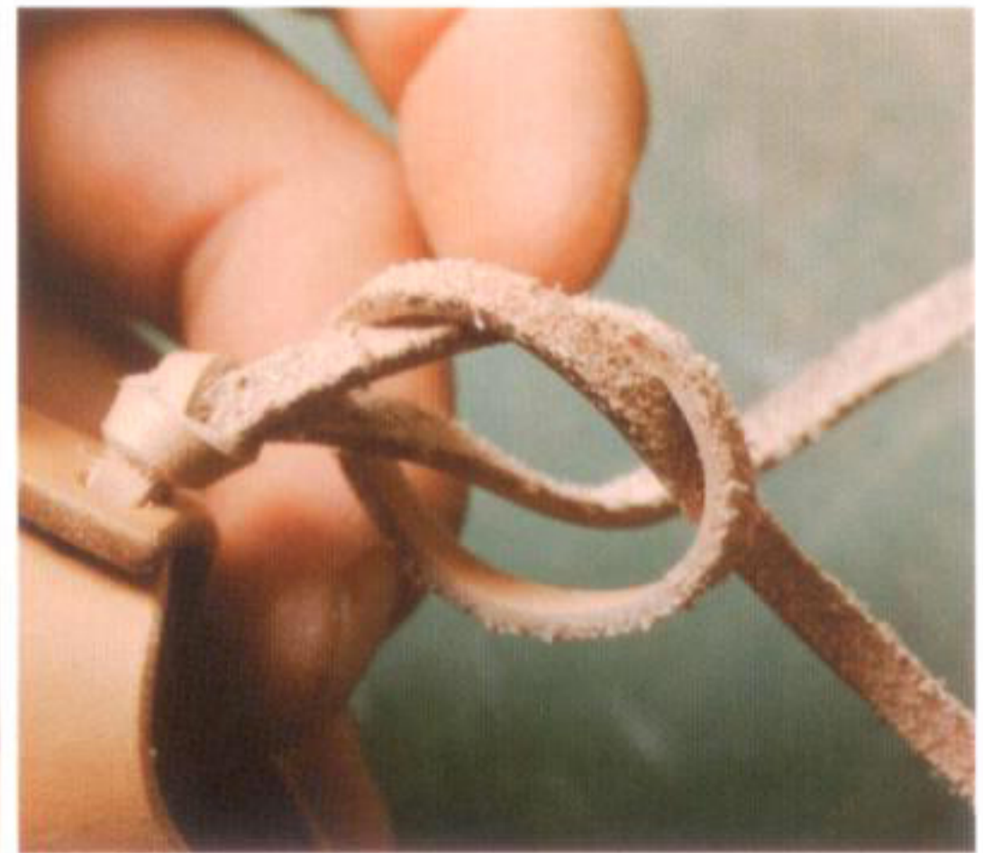
13 最後はベルトループの鹿ヒモと同じように、片方のレースを挟んで片結びをする。グランドゼロでは片方を銀面、もう片方を床面が出るように結んでいる。本体が開かないように、根本で結び目を作るようにする
