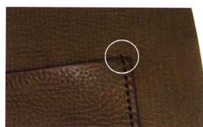
11 口袋兩側頂端各須往上多鑿一個線孔。
