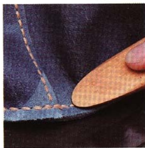
17 使用木製磨緣器等壓整針腳，使縫線能更緊密。接著將包底推入包身內側約至一半，再將包身上下倒轉由開口處拉出包底以便將主體翻至正面。
