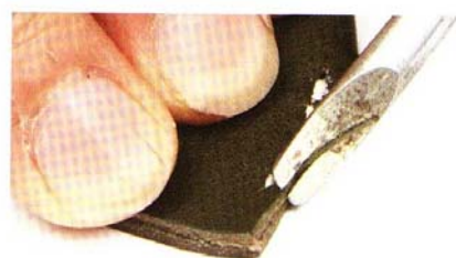
11 以削邊器削去切口正反兩面邊角。
