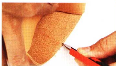
01 包底開口兩側肉面層邊緣各須刮出約4mm寬的粗糙面。
