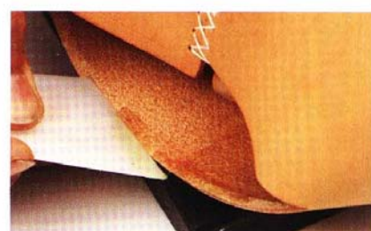
02 使用上膠板於粗糙面塗上DIABOND強力膠。
