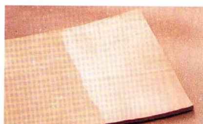
03 右半側為經過磨擦加工的樣態。僅是磨擦便能使皮革表面產生如此的變化。
