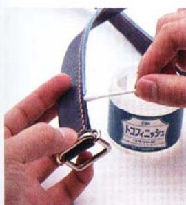
14 塗上床面處理劑後再使用木製磨緣器或帆布修整。
