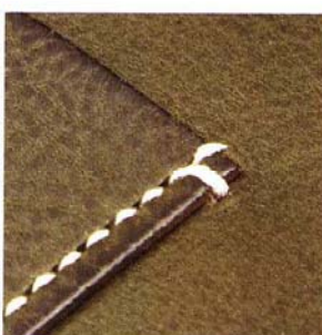
12 平縫縫合口袋。兩端的起針與收尾皆須繞縫2次以做補強。兩端的第一個線孔側邊須各鑿開一個線孔，再將縫線繞縫至此線孔2次以做補強。
