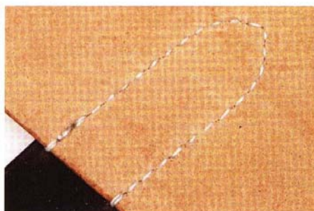
16 用紙張夾住縫合處的正反面再以鐵鎚敲打使其與主體密合。
