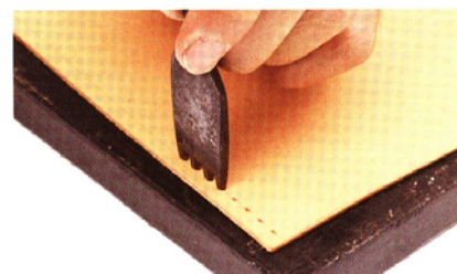
03 使用木槌敲打菱斬（斬腳間距6mm）以鑿出線孔。
