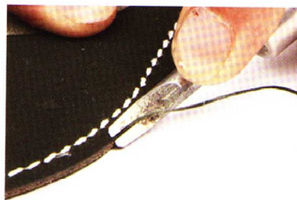
10 使用削邊器削去翻蓋正反面的邊角。
