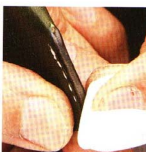
12 使用砂紙磨平切口並塗上邊油再以布磨整。重複2次作業將側邊打磨光亮。
