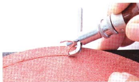
02 使用拉溝器於肉面層周邊8mm處拉出溝槽，共須重複2次作業。
