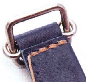
10 先朝基準點2的方向以平縫法縫合，縫至尾端時再朝向基準點1進行返縫。回到基準點1後便可沿著步驟08中鑿開的線孔，以平縫法依序縫製；最後再自尾端往回縫3個針腳後便可以收線結尾。
