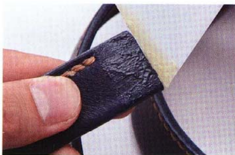
10 於背帶頭15mm處與補強邊的磨粗面塗上DIABOND強力膠，接著將背帶對準基準點並確認帶身無扭轉現象後再貼至補強邊上。
