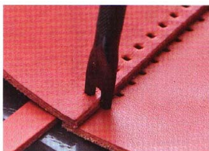
11 使用雙菱斬依照皮革上的線孔記號同時鑿開左右兩側的線孔。
