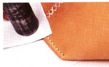
10 用紙夾住上下兩側再用鐵鎚輕敲以壓平針腳。
