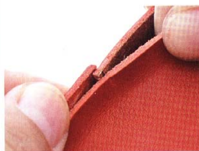
06 將主體上的安裝位置（p65步驟01中所記）與包底上的貼合位置對齊並貼合。
