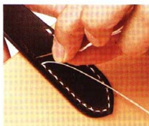
14 縫至最後三個線孔時改為單線以一般縫布的平縫法繼續縫合，於最終線孔重複縫2次後往回縫至第2個線孔，另一條縫線則須縫至第2個線孔後再往回縫一個針腳。詳細縫法請參考Check圖片。
