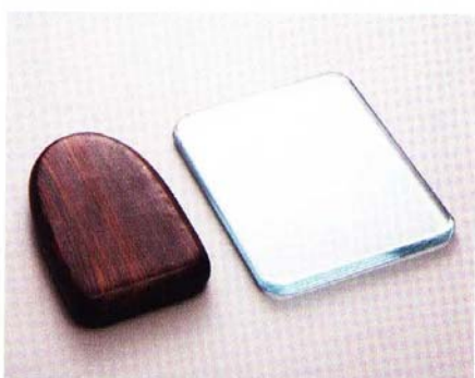
磨擦加工須使用磨整用木塊與玻璃板。
