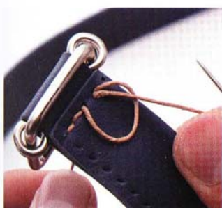
10 先朝基準點2的方向以平縫法縫合，縫至尾端時再朝向基準點1進行返縫。回到基準點1後便可沿著步驟08中鑿開的線孔，以平縫法依序縫製；最後再自尾端往回縫3個針腳後便可以收線結尾。
