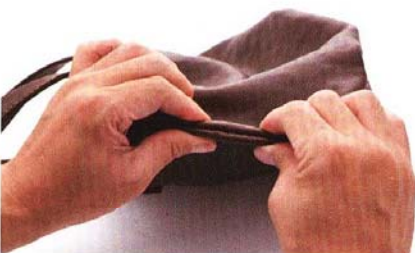
15 包身兩端及包底等採用內縫縫製的部分須以手和推輪壓平針腳。
