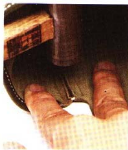
14 以鐵鎚盡量敲平包口兩端（安裝背帶處）的縫份。
