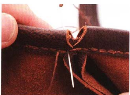
13 接著將皮面層側縫針穿過肉面層側縫線的右方線孔。
