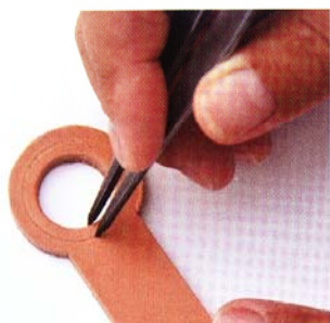
15 使用間距規沿著內圓圖過拉出幅度4mm寬的縫線。
