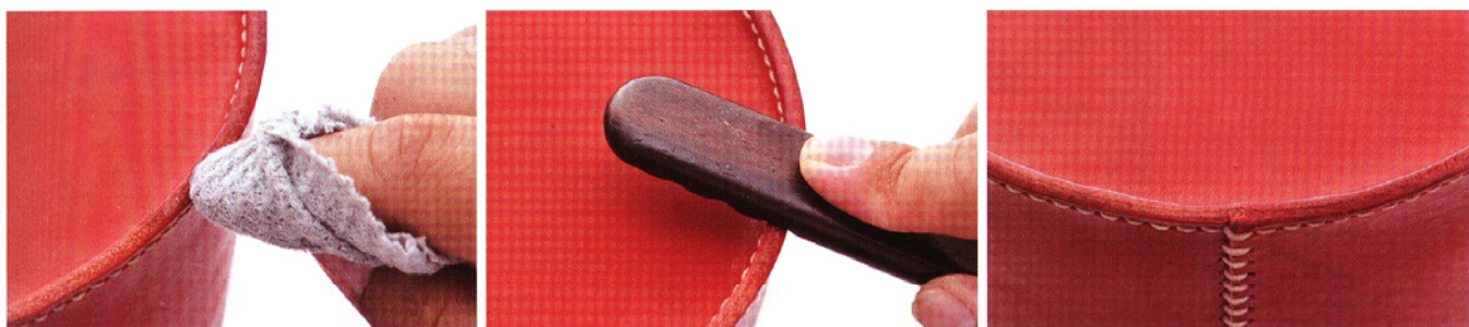
21 使用床面處理劑磨整側邊。於側邊塗上床面處理劑並用碎布磨擦使皮革吸收，完成後再以木製磨緣器仔細磨整即可。
