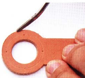
21 以削邊器削去提把整體側邊正反面的邊角。
