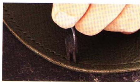
08 使用間距3mm的菱斬鑿出線孔。圓弧部分使用雙菱斬，直線部分則改用四菱或六菱等腳數較多的菱斬鑿孔便能鑿得快又漂亮。
