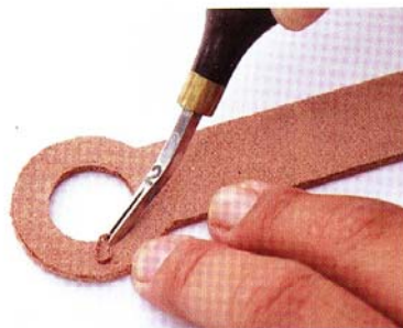
22 削去圓洞內側正反面的邊角。
