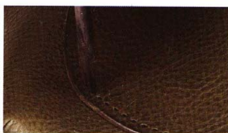
10 使用間距3mm的菱斬沿著前面於口袋邊緣拉出的3mm寬縫線鑿出線孔，鑿至圓弧處則須換用雙菱斬鑿孔。
