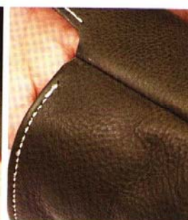
14 以鐵鎚盡量敲平包口兩端（安裝背帶處）的縫份。
