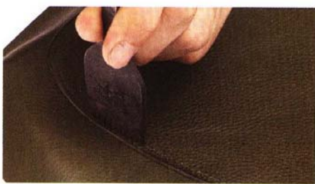
10 使用間距3mm的菱斬沿著前面於口袋邊緣拉出的3mm寬縫線鑿出線孔，鑿至圓弧處則須換用雙菱斬鑿孔。
