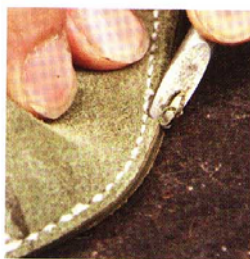
09 使用削邊器削去兩面的邊角。
