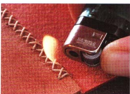
15 於底部保留12mm的距離並做結尾。預留大約1mm的線頭並剪掉多餘的縫線，以打火機燒過線頭使縫線固定即可。
