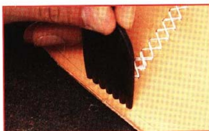
08 使用間距5mm的菱斬鑿開線孔。須先將斬腳橫跨於側包身連接線的兩側以鑿出正中央的線孔，之後再往兩旁鑿開其餘線孔。
