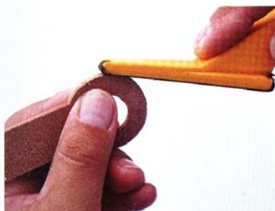
18 使用三角研磨器做進一步修整。
