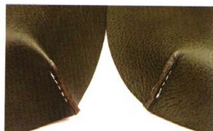
15 左側為敲打前的包底，右側為敲打後的包底。可以看出原本突出的銳角已完全與主體密合、形成圓角了。
