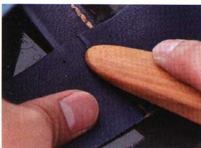
11 使用木製磨緣器將黏貼面壓緊。
