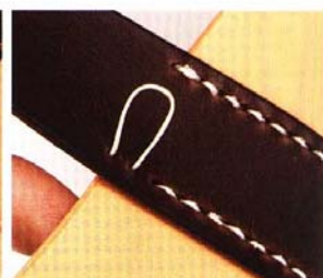
14 縫至最後三個線孔時改為單線以一般縫布的平縫法繼續縫合，於最終線孔重複縫2次後往回縫至第2個線孔，另一條縫線則須縫至第2個線孔後再往回縫一個針腳。詳細縫法請參考Check圖片。
