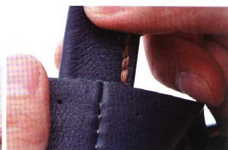
10 於背帶頭15mm處與補強邊的磨粗面塗上DIABOND強力膠，接著將背帶對準基準點並確認帶身無扭轉現象後再貼至補強邊上。
