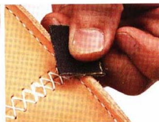
11 使用削邊器削去側邊正反面的邊角並以砂紙磨整。
