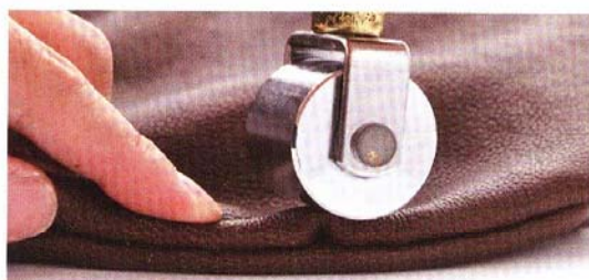
16 隆起處須集中推動推輪以壓平原有的凹凸感。
