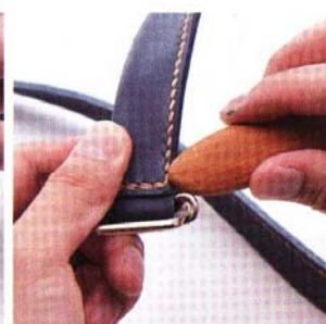
14 塗上床面處理劑後再使用木製磨緣器或帆布修整。
