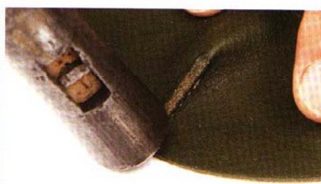
14 以鐵鎚敲打肉面層便能壓平銳角以營造出柔軟的圓形。翻面後繼續輕敲皮面層，以免留下鐵鎚痕跡。
