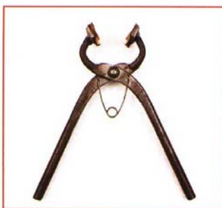
06 另外也可於鐵鉗（鉗頭為橫長平面的款式）的鉗頭貼上碎皮革再夾緊黏合處。此款鐵鉗可運用於多種作業中，因此準備一支會較方便。
