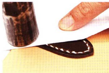
16 用紙張夾住縫合處的正反面再以鐵鎚敲打使其與主體密合。
