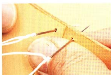
04 將兩根縫針由同一方向分別穿過左右兩側第一個線孔，再將縫線各自從對側第一個線孔穿回。接著將縫線從各自斜下方的第二個線孔穿至背面，並於背面自對側橫向的線孔穿回。交叉縫詳細縫法請參照p66的說明。
