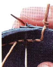
15 縫合剩下的半個橢圓。起針後須重複縫製步驟13中最後的3個針腳；於第3個針腳重複縫上2層縫線後，便可將步驟14中未做收線、只以打結固定的線頭剪斷。接著繼續縫合剩下的半個橢圓，縫製尾端後也須記得往前再重複縫3個針腳。
