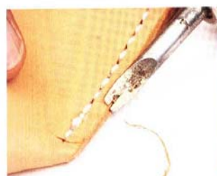
11 使用削邊器削去側邊正反面的邊角並以砂紙磨整。
