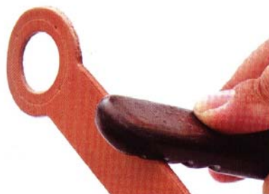
24 使用木製磨緣器磨整。
