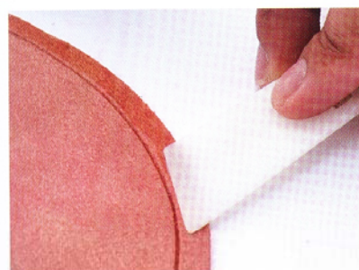
03 於溝槽外側塗上生膠糊。
