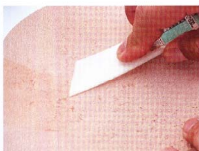
22 中底榔皮面與主體內側包底須整面塗滿生膠糊。
