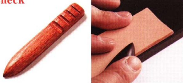
07 木製磨緣器為木製的磨整工具。特色為較容易施力，同時並用尖端與溝槽便能完成多種磨整方式。
