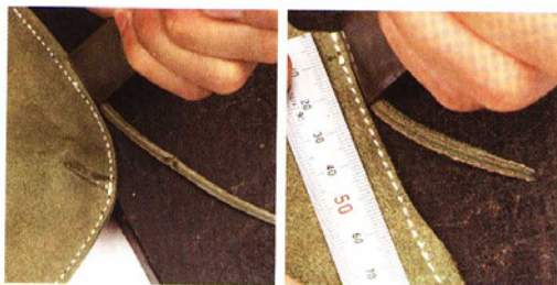
08 切除包底和兩端（安裝背帶處）多餘的皮革；須盡可能靠近縫線裁切。
