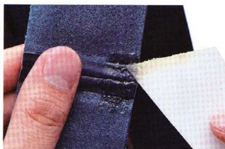
10 於背帶頭15mm處與補強邊的磨粗面塗上DIABOND強力膠，接著將背帶對準基準點並確認帶身無扭轉現象後再貼至補強邊上。
