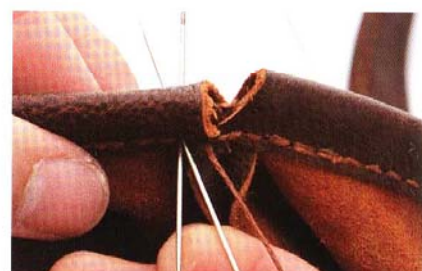
12 將分別位於皮面層與肉面層的縫針於左側線孔交叉成十字，並同時朝外拉緊縫線。
