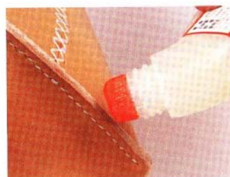
12 塗上邊油後以碎布再磨整一次；完成後再用砂紙或銼刀做最後磨整。
