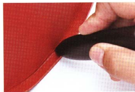
07 使用木製磨緣器的尖端壓緊主體與包底。
