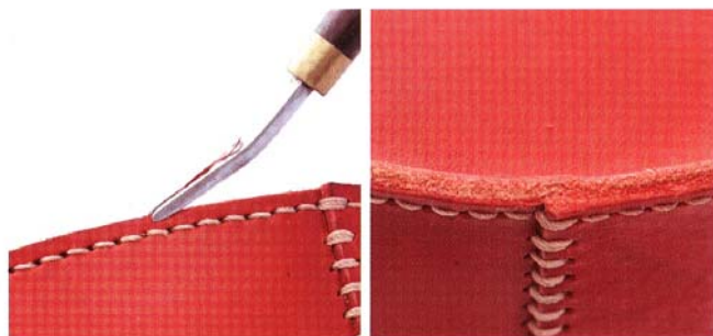
20 使用削邊器削去內側及外側的邊角。
