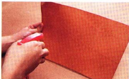
01 若要提升磨擦的效果可於皮面層上噴灑些水份；噴灑時只須於表面輕輕噴上一層薄薄的水氣即可。
