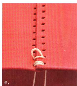
13 準備縫合距離6倍長的縫線。a.首先須自皮面層同時將縫線穿過左右兩側線孔。b.將右側針自左側線孔穿出，左側針自右側線孔穿出。c.於相同的線孔再次自皮面層將右側針穿入左側線孔，左側針穿入右側線孔。d.接著往前一個線孔，自肉面層將右側針穿過左斜前的線孔，左側針穿過右斜前的線孔。e.於相同的線孔自皮面層將右側針穿入左側線孔，左側針穿入右側線孔。重複b~e的步驟。
