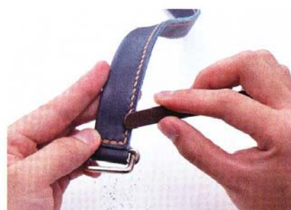
13 磨整側邊。使用研磨片磨整側邊。
