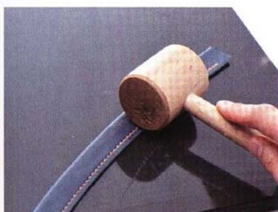
11 使用木槌輕輕敲打針腳，使縫線能更加緊實。
