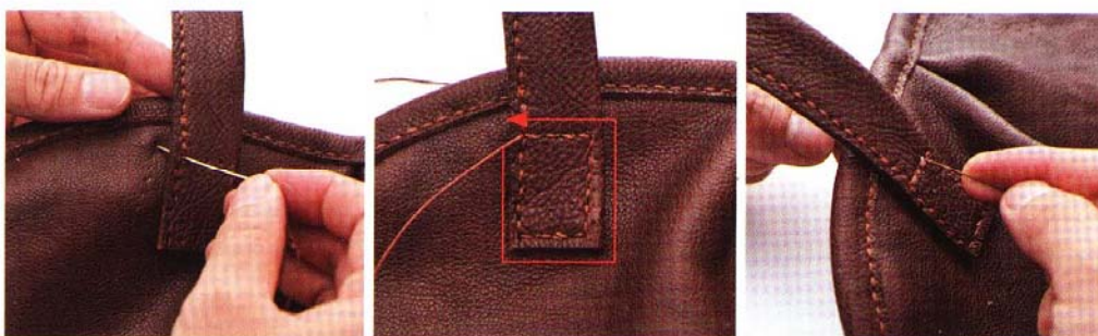
12 以平縫的方式自提把左上方線孔開始往下依序縫合4邊。縫至末端線孔時須於上側邊進行返縫後再做結尾。
