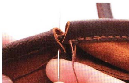
11 接著將右側針穿過左側線孔，並從皮面層拉出縫線。
