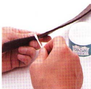
07 側邊塗上床面層處理劑並磨整。
