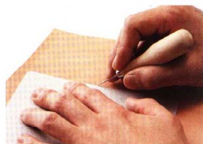
使用圓錐於皮料上轉描零件輪廓時須用力壓緊紙型，以避免紙型滑動。
