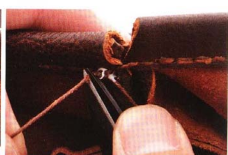
14 於兩線間塗上少許白膠後打結，並剪斷剩餘的縫線。最後以相同順序縫合另一側的包口端即可。
