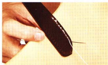
13 縫合主體與提把。由第二個線孔起針並往回縫一個針腳後再以平縫縫合。
