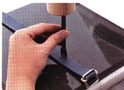
08 沿著步驟05中拉出的縫線以菱斬自基準點1依序鑿開線孔。
