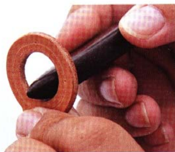
25 圓洞內側的側邊也須磨整。此處較不易磨整，因此可用木製磨緣器的尖端部分處理便能順利進行作業。
