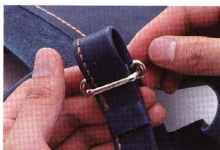
09 以山折方式將背帶穿過日字環另一側。接著便須將形成一個大環的背帶安裝至補強邊上。
