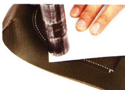
13 用紙張上下夾住縫合處再以鐵鎚敲打針腳使縫線能更緊實。
