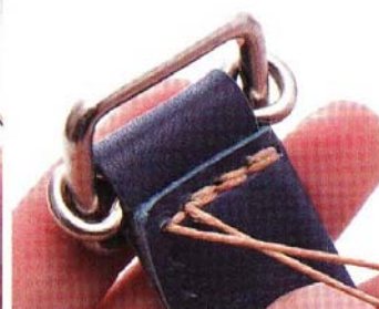
10 先朝基準點2的方向以平縫法縫合，縫至尾端時再朝向基準點1進行返縫。回到基準點1後便可沿著步驟08中鑿開的線孔，以平縫法依序縫製；最後再自尾端往回縫3個針腳後便可以收線結尾。
