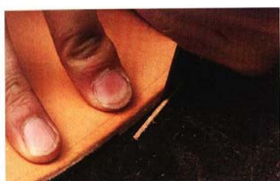
07 使用裁皮刀切除貼合後向外突出的部分。
