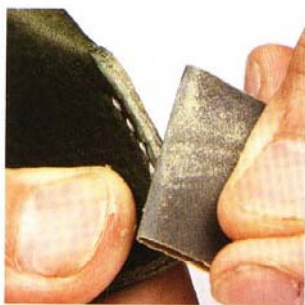
12 使用砂紙磨平切口並塗上邊油再以布磨整。重複2次作業將側邊打磨光亮。
