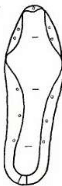
Рис. IV.16. Схема перетяжки пучковой и геленочной частей
