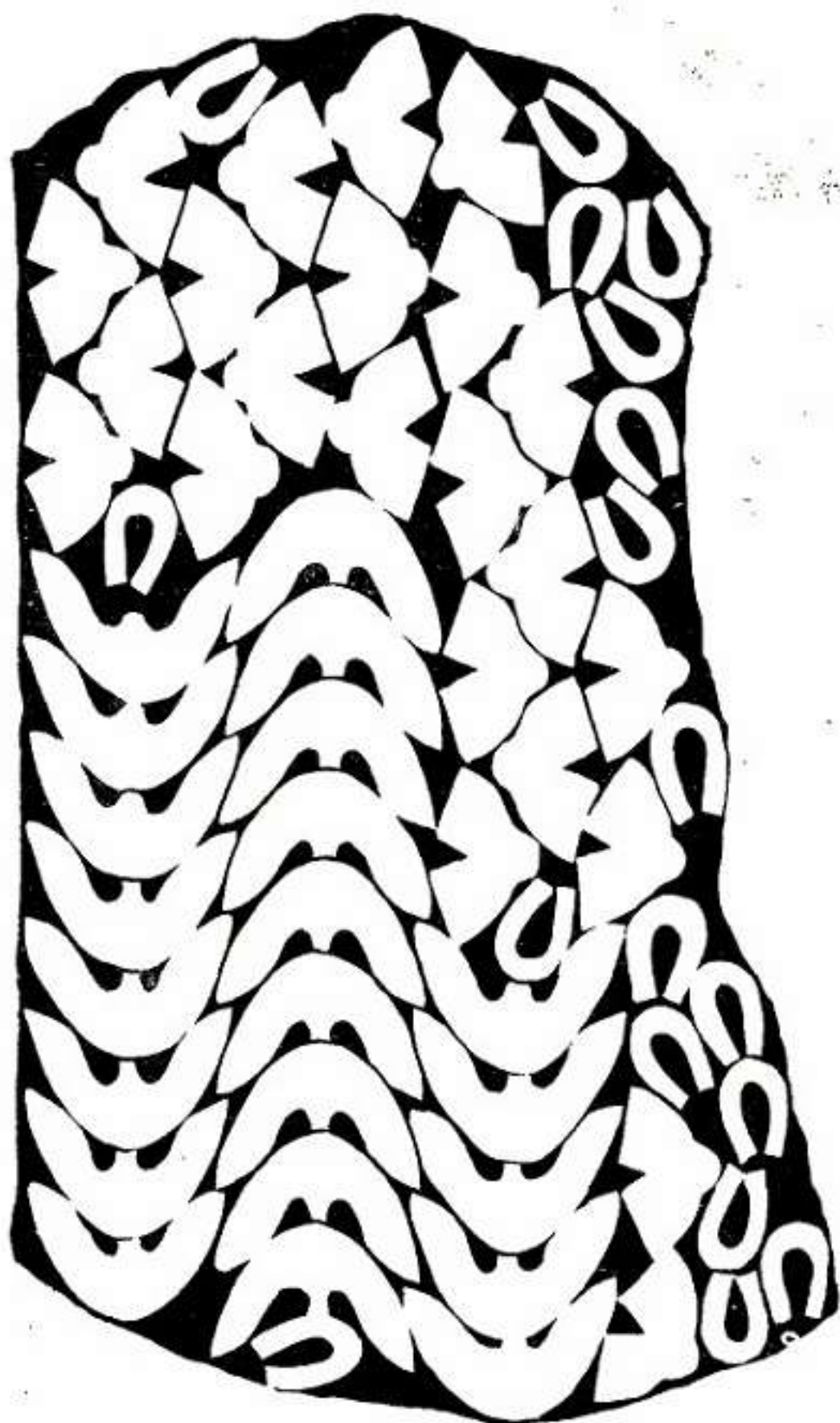
Рис. 1.12. Схема раскроя спилка-велюра I сорта на детали мальчи- вых комбинированных полуботинок (составлена В. Я. Баркане)
