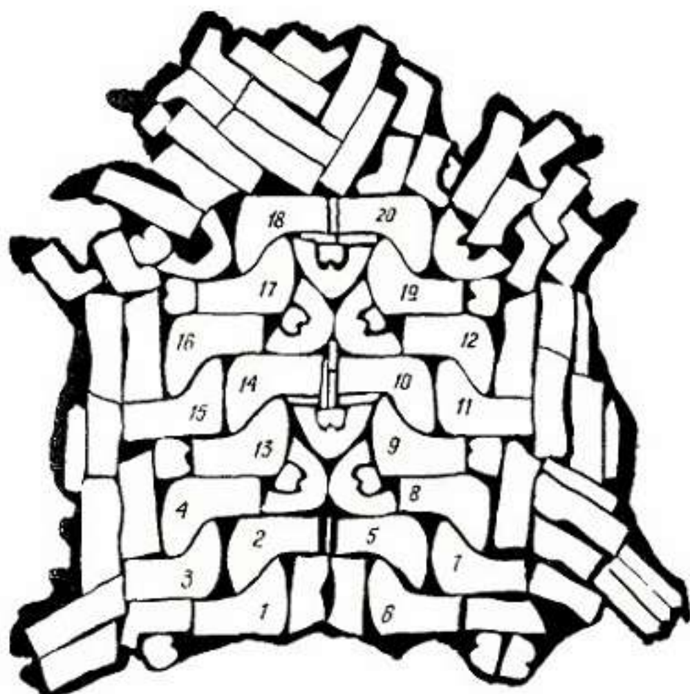
Рис. 1.9. Схема раскроя полукожника II сорта на детали женских модельных сапожек в комбинации с деталями туфель (составлена объединением «Заря»)
