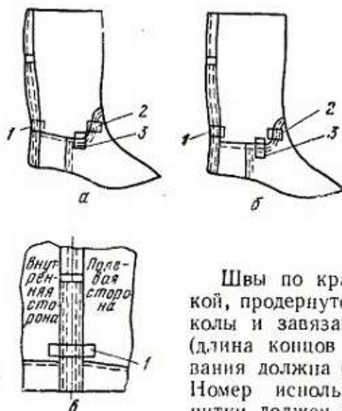
Рис. VIII.4. Расположение на внутренней (а) и внешней (б) стороне, на заднем наружном ремне (в) заготовки верха сапог образцов для определения прочности швов:
