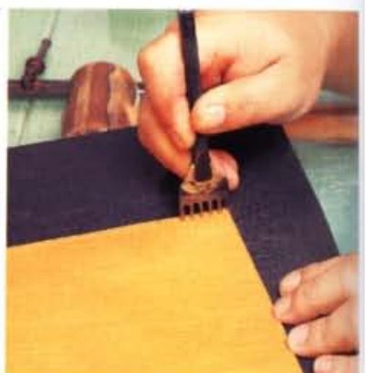
13 使用6孔菱斬，打到最後1個菱形孔後，以相同要領，先將菱斬的1根刀刃靠在另一側的邊上，然後開始打上菱形孔。
