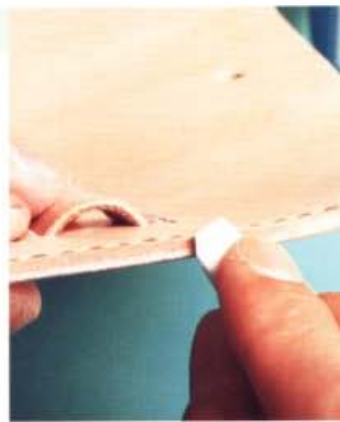
3 塗抹透明肉面層處理劑，利用帆布或磨緣器等工具，將裁切面打磨的非常光滑。
