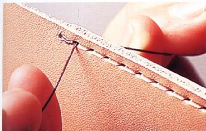
7 拉緊左、右側的縫線，調整針目後，反覆步驟 3~7，繼續縫合。避免縫針戳到縫線，拉線力道務必均等。
