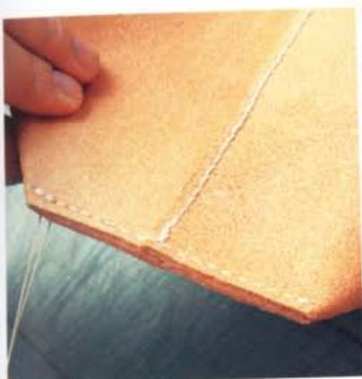
32 縫到最後時也必須回縫2個縫孔，再利用剪刀剪斷縫線，並以強力膠固定住線頭。翻面後就看不到這部分，所以不必太在意回縫針數。
