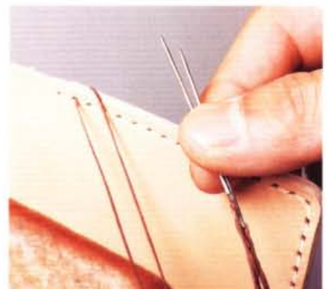
15 留下第一個縫孔，先將縫針穿過縫孔，再將縫線整理出均等長度。
