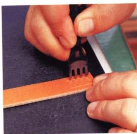
6 利用四孔菱斬和雙孔菱斬，在步驟 4、5 描好的線上打上縫孔。打孔數錯誤的話，就無法和本體上的菱形孔對齊，因此打孔時務必留意。
