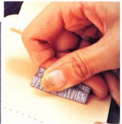
11 在基座安裝部位描上縫合位置，以該描線痕跡為準，基座部位也磨粗。
