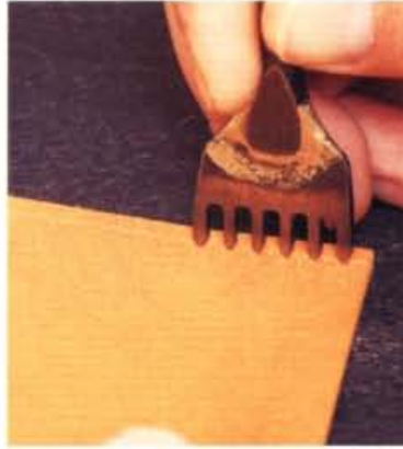
17 從口袋的開口部位到最後為止，在描好的線上壓出記號。從基點到第 6 孔為止不打穿孔洞，從第 7 孔起才貫穿縫孔。
