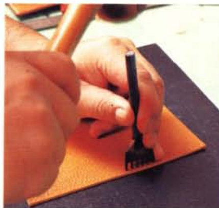
13 使用6孔菱斬，打到最後1個菱形孔後，以相同要領，先將菱斬的1根刀刃靠在另一側的邊上，然後開始打上菱形孔。
