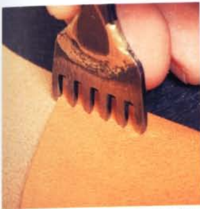
20 將菱斬的一個刀刃靠在折返部位的邊緣上，然後沿著導引線打上菱形孔。緊接著，空下1個縫孔，瞄準事先描在皮面層上的記號，依序打上菱形孔。
