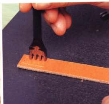
6 利用四孔菱斬和雙孔菱斬，在步驟 4、5 描好的線上打上縫孔。打孔數錯誤的話，就無法和本體上的菱形孔對齊，因此打孔時務必留意。
