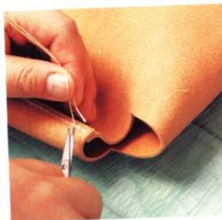
23 於皮革翻面後，剪掉位於左右側的縫線並抹上強力膠以固定住線頭。
