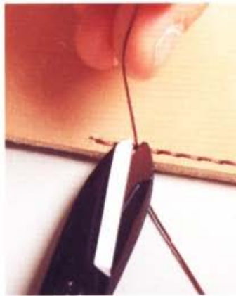
8 縫好後，將縫線剪短。抹上強力膠亦可。
