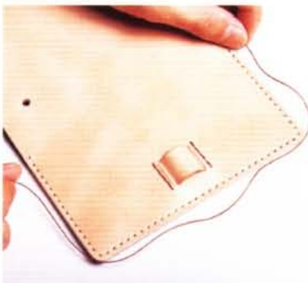
14 打好縫孔後準備縫線。縫線長度以縫合距離的4倍為大致基準。
