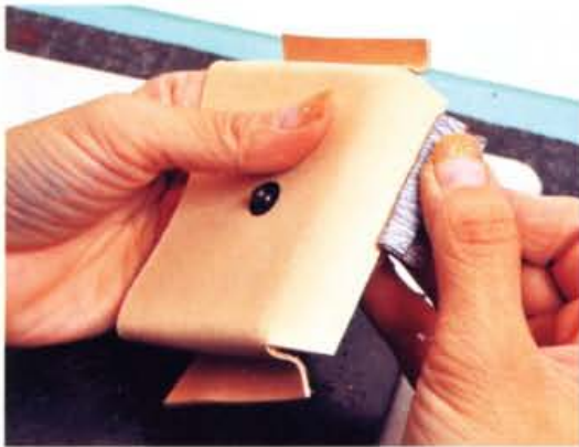
10 打磨零錢袋的縫合部位，將距離皮邊約3mm處磨粗。
