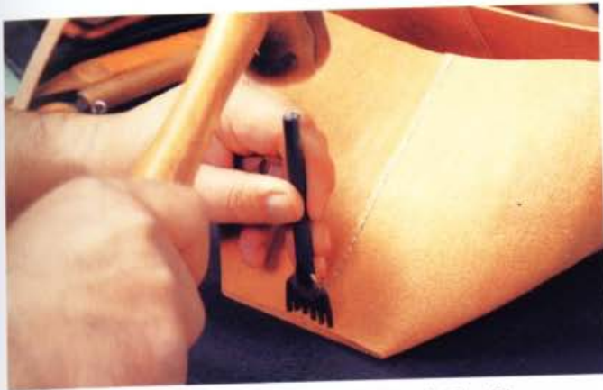
30 反覆步驟 24~29，以相同的步驟，在另一側的皮革上打上菱形孔。
