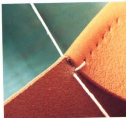
23 返回第一個縫孔，將縫線鉤在重疊在一起的皮革邊緣似地，縫上2道線以便提升強度。
