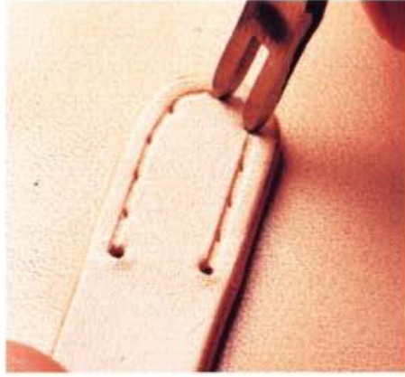
16 在扣帶上打孔。靠近曲線部位時，利用雙菱斬調整縫孔間距，打洞時使用單菱斬即可。
