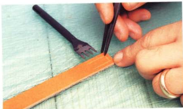
4 從長邊的邊緣開始描線，一直描到步驟 2 做記號的位置為止。只描上縫合長度部分（5 個縫孔份）。
