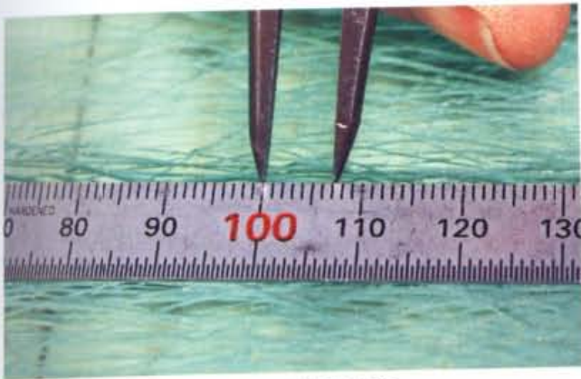
18 將間距規設定為距離7mm以便描上斬打菱形孔的導引線。
