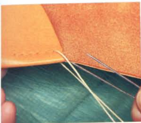
22 從步驟20斬打的縫孔開始縫起。將縫線穿過兩片皮革重疊在一起的縫孔。
