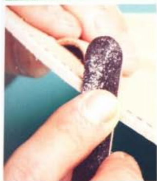
1 利用研磨棒打磨裁切面，磨得非常平整。
