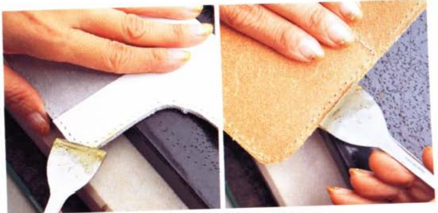
12 內、外側部位的皮革上分別塗抹橡皮膠，一直塗抹到距離裁切面3mm處。先從內側夾層開始塗抹。
