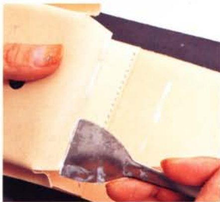
12 零錢袋、基座都塗抹白膠，塗到距離邊緣3mm處。
