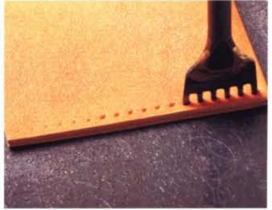
17 從口袋的開口部位到最後為止，在描好的線上壓出記號。從基點到第 6 孔為止不打穿孔洞，從第 7 孔起才貫穿縫孔。
