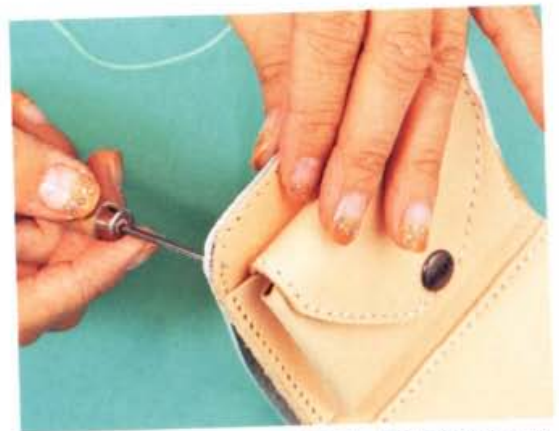
15 將圓錐插入基點的縫孔，對齊縫孔後調整黏合位置。
