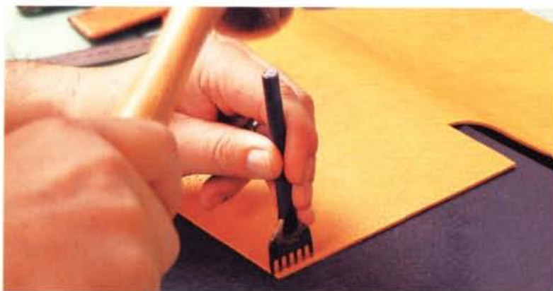
14 襠部的另一側也和步驟 12、13 一樣，敲入菱斬，打上縫孔。在長長的直線部位打孔時，使用刀刃數較多的菱斬更方便。
