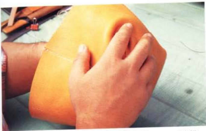
34 避免太用力拉扯，小心地整形，以免皮革上出現奇怪的皺紋。此時，底面必須確實成型。
