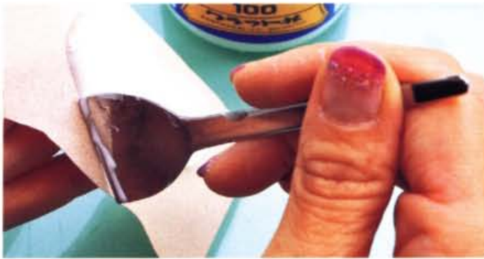
11 將白膠塗抹在鑰匙包襯裡材料上以便黏合海綿襯裡和胎牛皮。
