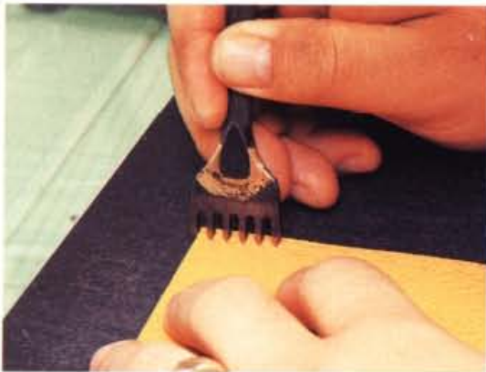
12 沿著步驟 11 描好的線打上菱形孔。將菱斬的1根刀刃靠在開口部位邊緣上打孔。
