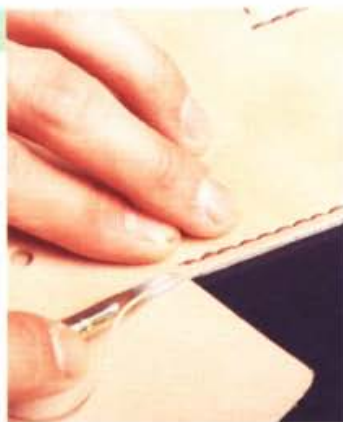
2 利用削邊器削掉裁切面上的邊角。
