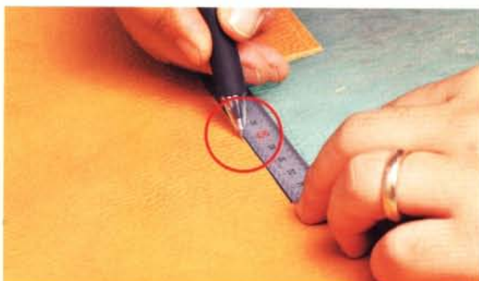
16 縫合前，量好本體部位下凹處中心點並做記號。作品完成後掩蓋住這部分，所以以原子筆做記號也沒關係。
