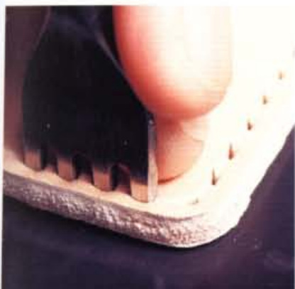
13 打好曲線部位的縫孔後，再換上四菱斬，繼續打好其他縫孔。
