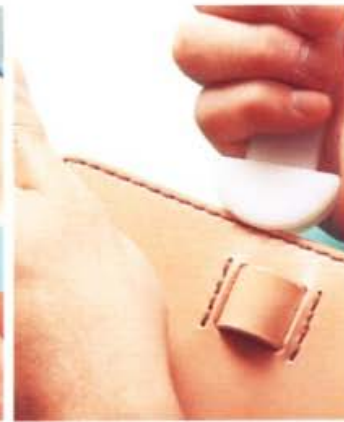
3 塗抹透明肉面層處理劑，利用帆布或磨緣器等工具，將裁切面打磨的非常光滑。
