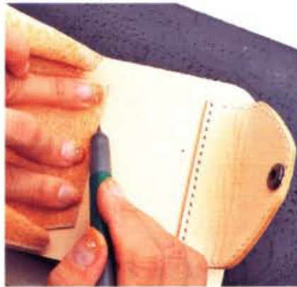
11 在基座安裝部位描上縫合位置，以該描線痕跡為準，基座部位也磨粗。
