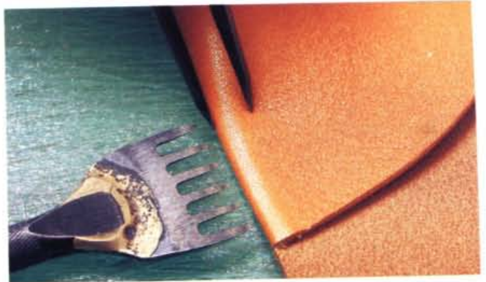
19 利用間距規，描線距離為斬打菱形孔的部分。上圖中斬打菱形孔距離為一只菱斬的寬度（約30mm）。
