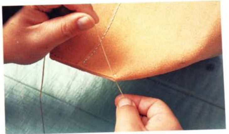
31 以麻線縫合。從縫孔的端部開始縫起，起頭的2個縫孔縫上2道線後才開始縫合。
