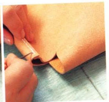
23 於皮革翻面後，剪掉位於左右側的縫線並抹上強力膠以固定住線頭。
