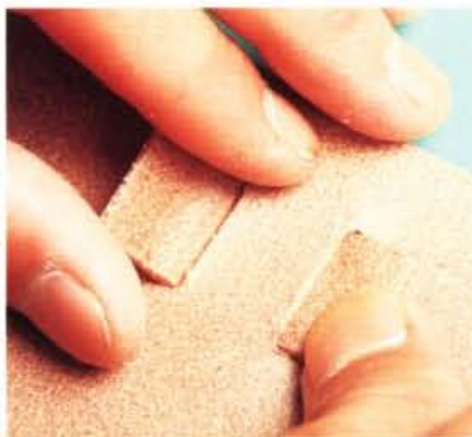
6 將白膠塗抹在扣帶環端部的皮面層上，對齊黏合導引線後黏合。對好位置後用力按壓以促使緊密黏合。
