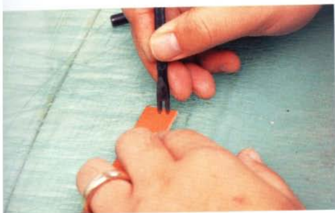
3 將雙菱斬的刀刀瞄準步驟 2 做好的記號，左右各 1 孔，在描好的線上做記號。
