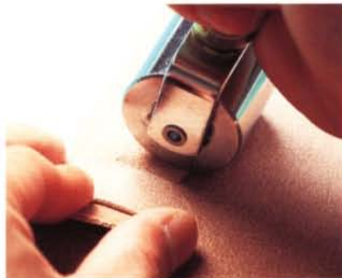
7 利用滾輪，用力地滾壓，即可避免貼合部位綻開。
