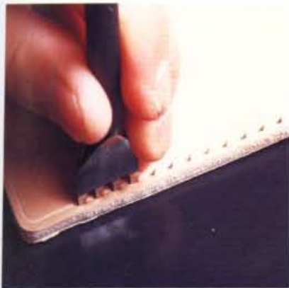
11 直線部分使用四菱斬，重疊前1孔，每次打上3個縫孔。
